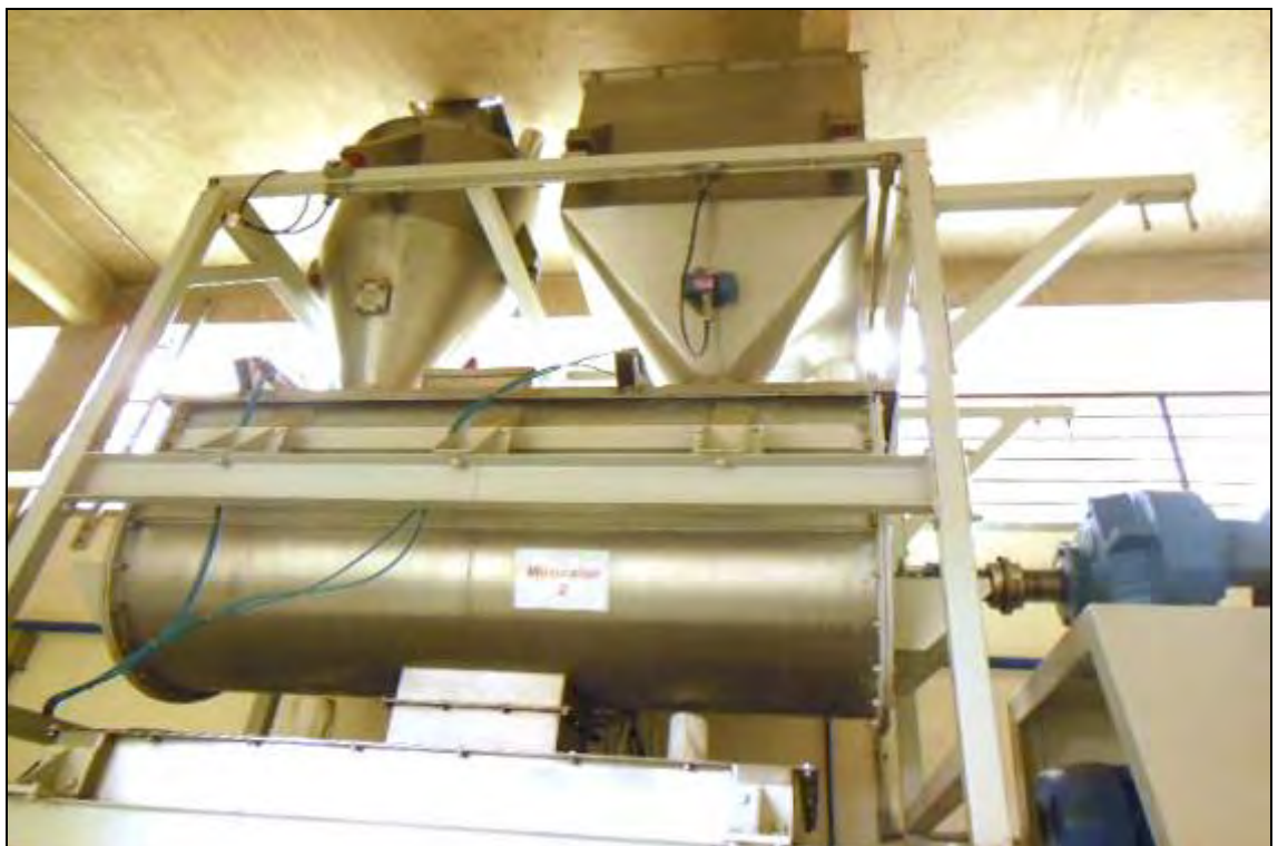
ITEM 1,013 – VISTA DO MISTURADOR II EM ALUMINIO ACIONADO POR MOTOR E REDUTOR
