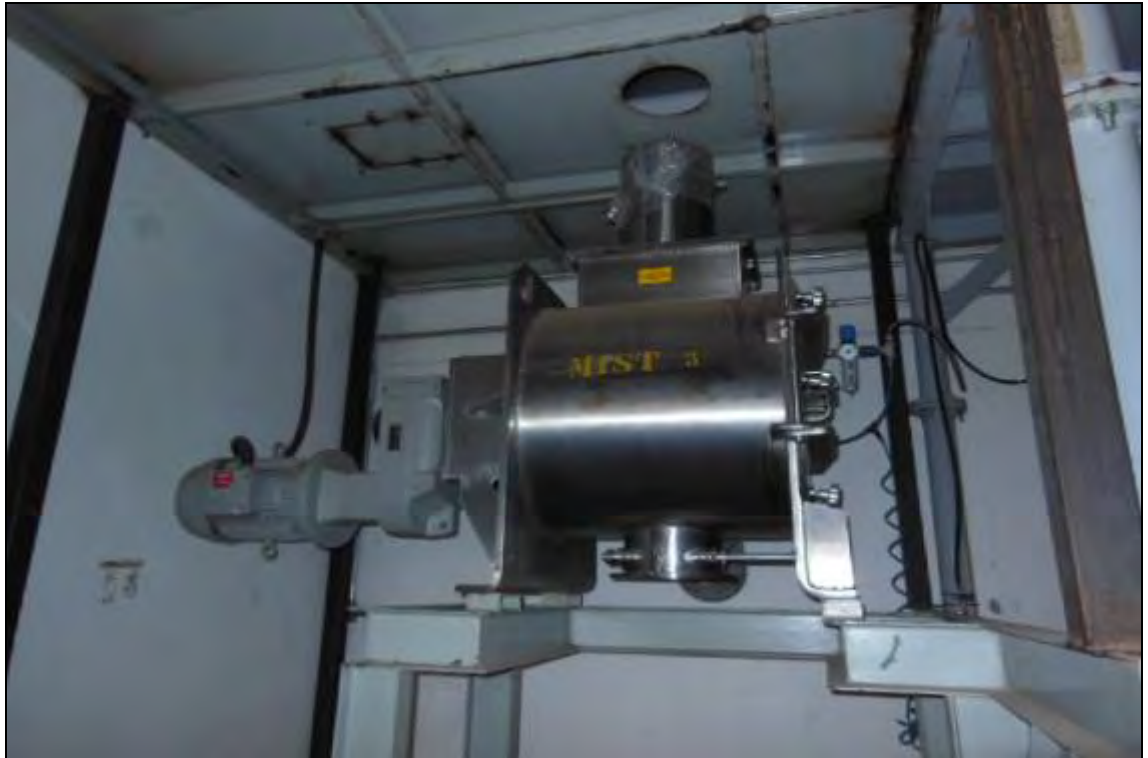
ITEM 1,067 – VISTA DO MISTURADOR III MARCA: SEMCO FA-35 MODELO: CONIMIX CAP: 990LTS EM MEZANINO EM ACO CARBONO E ESCADA
