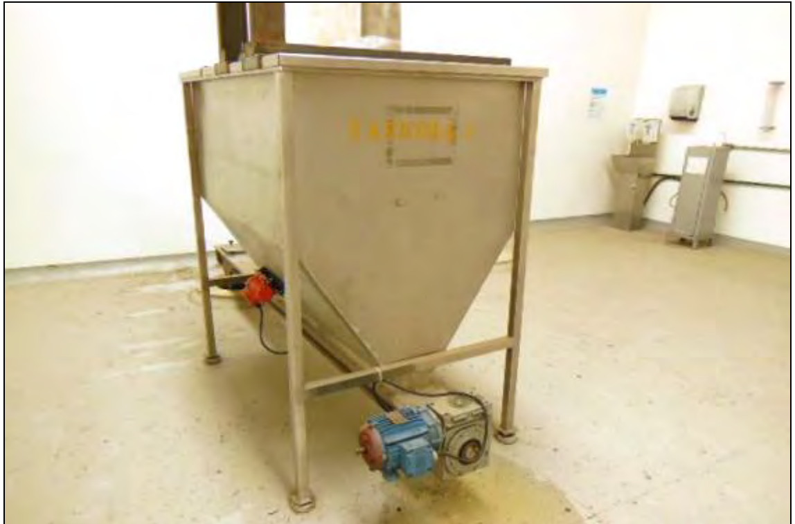
ITEM 1,034 – VISTA DO SILO FABRIMA III EM ALUMINIO COM VIBRADOR E ROSCA NA SAÍDA
