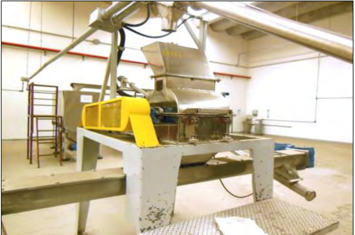
ITEM 1,028 – VISTA DO MOINHO 2 MARCA: TRIGRE MODELO: EL-35 360 RPM POTENCIA: 30CV SÉRIE: 13049 COM ROSCA NA SAÍDA DO MOINHO, ACIONADO POR MOTOR REDUTOR 5 HP COM 2 SAÍDAS
