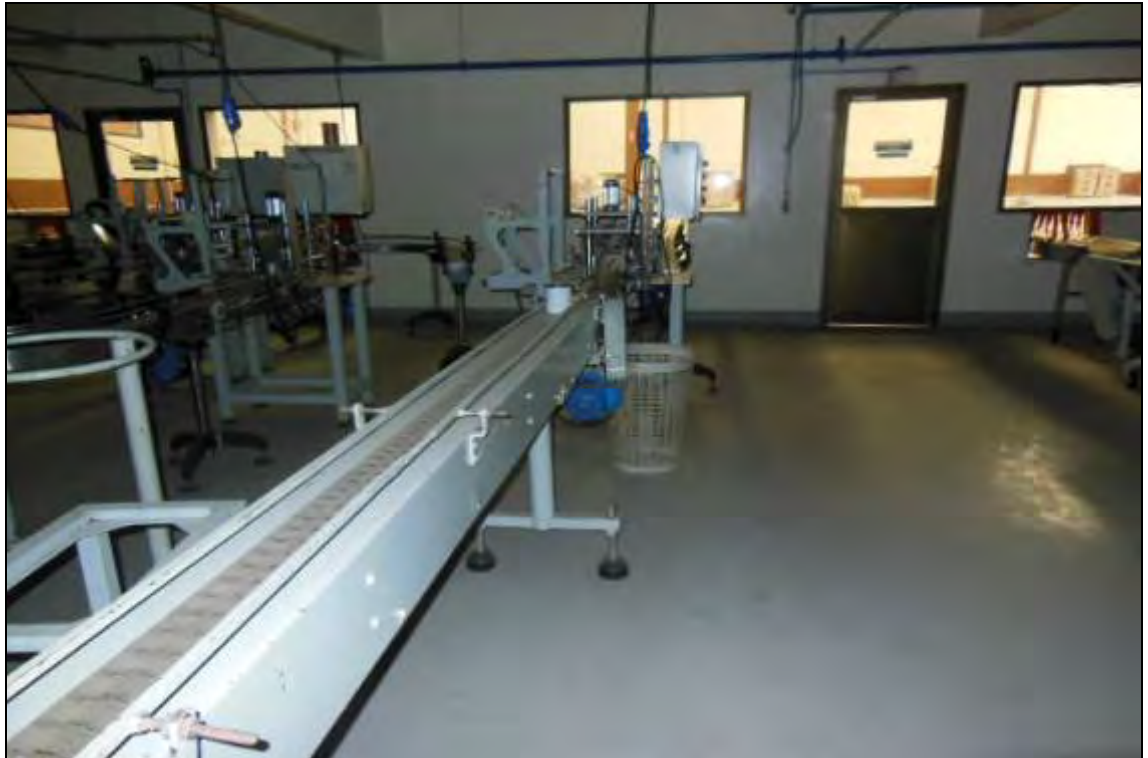
ITEM 1,041 – VISTA DA EMPACOTADEIRA MASIPACK I MARCA: ARV COMPOSTA POR SUPORTE INCLINADO EM ALUMINIO, ESTEIRA TRANSPORTADORA COMPRIMENTO 2,5 M, ESTEIRA TRANSPORTADORA COMPRIMENTO: 3 M, MÁQUINA DE TERMOSELAGEM 5 MARCA: TEKPACK E ESTEIRA DE SAÍDA
