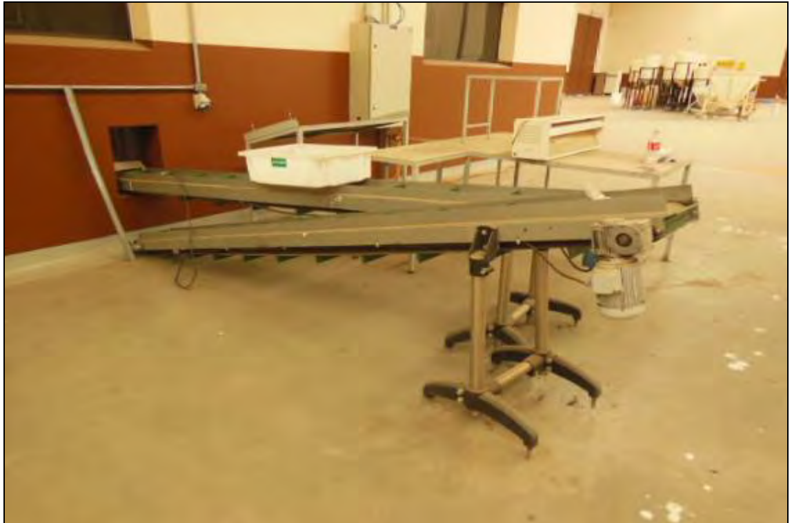
ITEM 1,079 / ITEM 1,080 – VISTA DAS DUAS ESTEIRAS TRANSPORTADORA DE TALISCADA COMPRIMENTO: 300 MM
