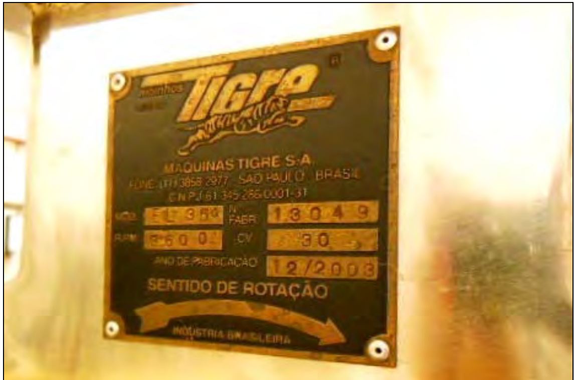
ITEM 1,028 – VISTA DA PLACA DE IDENTIFICAÇÃO O MOINHO 2 MARCA: TIGRE MODELO: EL-35 360 RPM POTENCIA: 30CV SÉRIE: 13049 COM ROSCA NA SAÍDA DO MOINHO, ACIONADO POR MOTOR REDUTOR 5 HP COM 2 SAÍDAS
