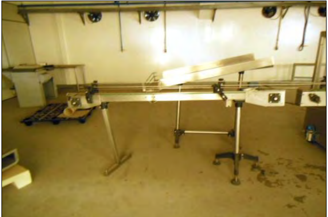
ITEM 1,075 – VISTA DA ESTEIRA TRANSPORTADORA DE ENTRADA NA EMBALADORA COMPRIMENTO: 2000 MM ACIONAMENTO POR MOTOR REDUTOR
