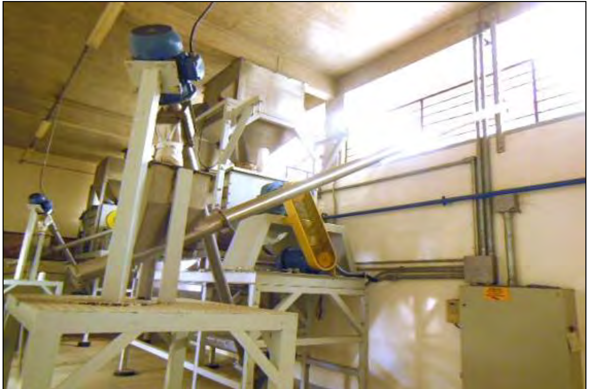
ITEM 1,016 – VISTA DA ROSCA TRANSPORTADORA INCLINADA EM ALUMINIO PARA ALIMENTAÇÃO DO MOINHO
