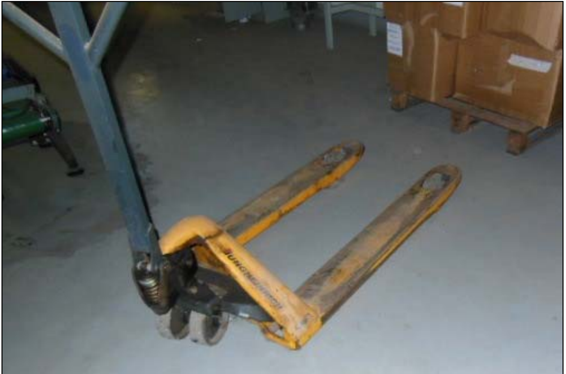
ITEM 1,052 – VISTA DO CARRO PALLET MARCA: JUNGHEINRICH CAP: 2000 KG
