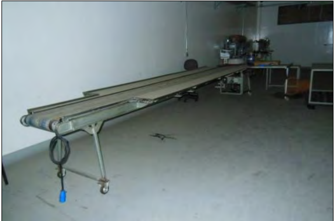
ITEM 1,060 – VISTA DA ESTEIRA TRANSPORTADORA COM MOTOR REDUTOR
