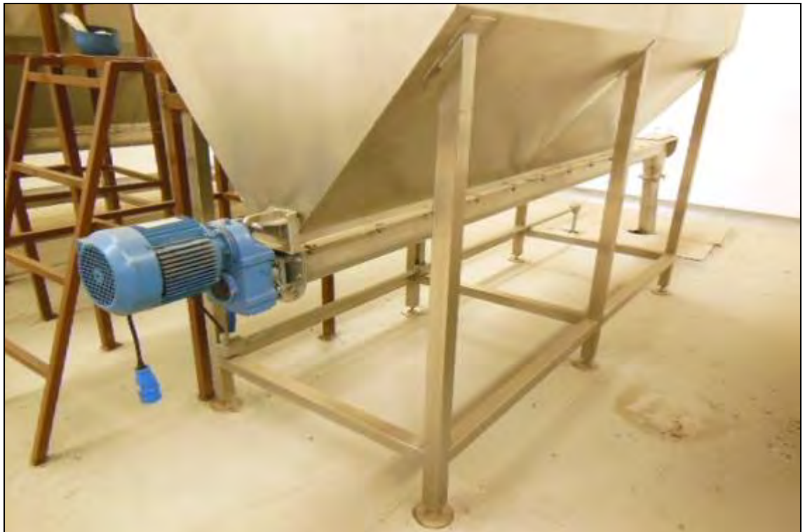
ITEM 1,024 – VISTA DO SILO ARV Nº2 EM ALUMINIO COM VIBRADOR MARCA: DONAR E ROSCA TRANSPORTADORA NA SAÍDA, ACIONAMENTO POR MOTOR REDUTOR MARCA: SEW-EURODRIVE
