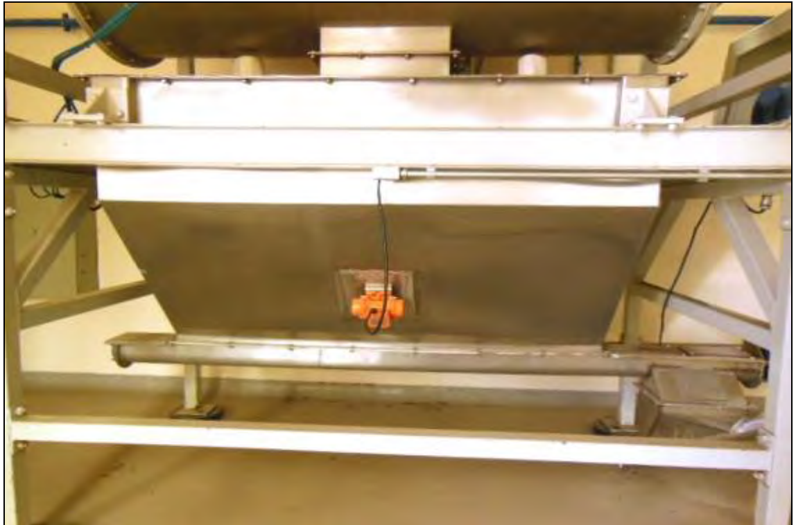
ITEM 1,014 – VISTA DA CAIXA COLETORA EM ALUMINIO COM VIBRADOR MARCA: DONAR E ROSCA TRANSPORTADORA NA SAÍDA, ACIONADA POR MOTOR E REDUTOR
