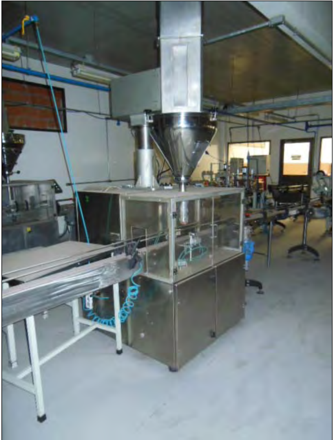
ITEM 1,040 – VISTA DA EMPACOTADEIRA ARV II MARCA: ARV MODELO: AV2000 D40 SÉRIE: 8 COMPOSTA POR ALIMENTADOR INCLINADO DE POTES, ESTEIRA TRANSPORTADORA COMPRIMENTO: 3 M ESTEIRA TRANSPORTADORA COMPRIMENTO: 4,5 M, DUAS ESTEIRAS CURVAS, ESTEIRA DE SAÍDA, MÁQUINA PARA TERMOSELAGEM MARCA: TEK PACK E MÁQUINA PARA TERMOSELAGEM MARCA: TEK NIZA SÉRIE: 4337-2226
