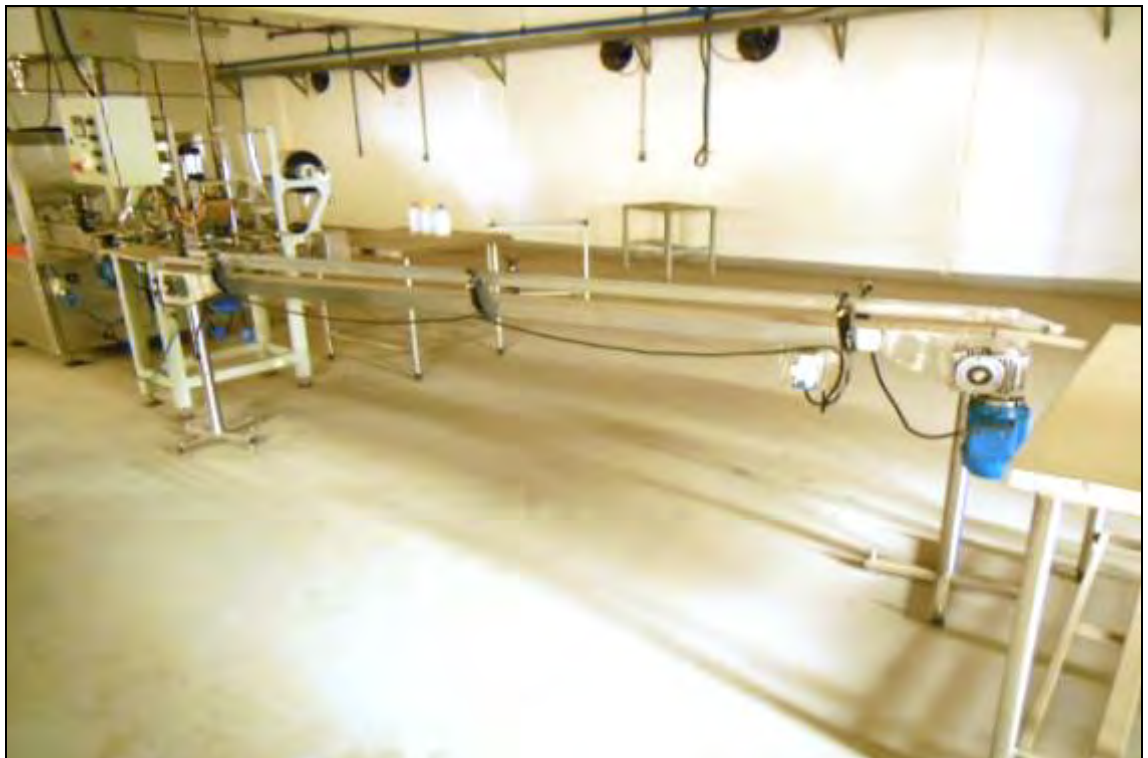
ITEM 1,076 – VISTA DA ESTEIRA TRANSPORTADORA DE ENTRADA NA EMBALADORA COMPRIMENTO: 3000 MM ACIONAMENTO POR MOTOR REDUTOR
