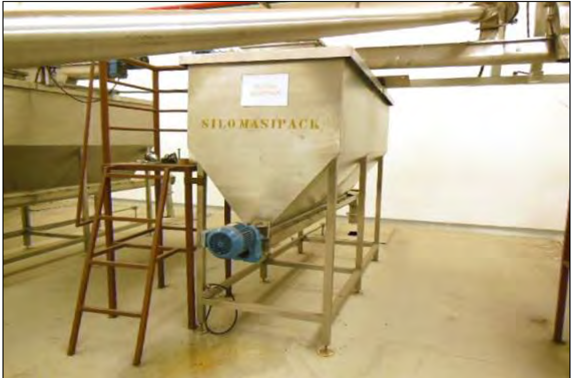
ITEM 1,026 – VISTA DO SILO MASIPACK EM ALUMINIO COM VIBRADOR MARCA: DONAR E ROSCA TRANSPORTADORA NA SAÍDA, ACIONAMENTO POR MOTOR REDUTOR MARCA: SEW-EURODRIVE
