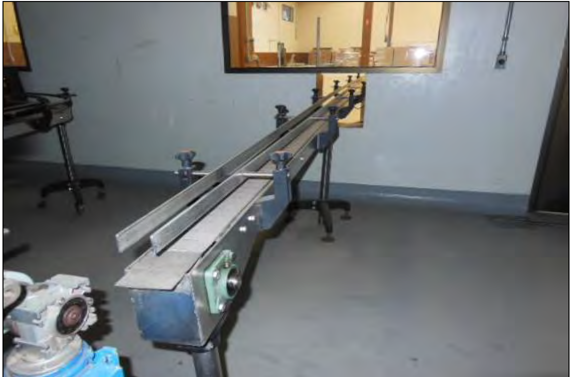
ITEM 1,042 – VISTA DA EMPACOTADEIRA MARCA: BOSH I COMPOSTA POR CORREIA TRANSPORTADORA COM RODIZÍOS COMPRIMENTO 5 M, ACIONAMENTO POR MOTOR REDUTOR E ESTEIRA DE SAÍDA
