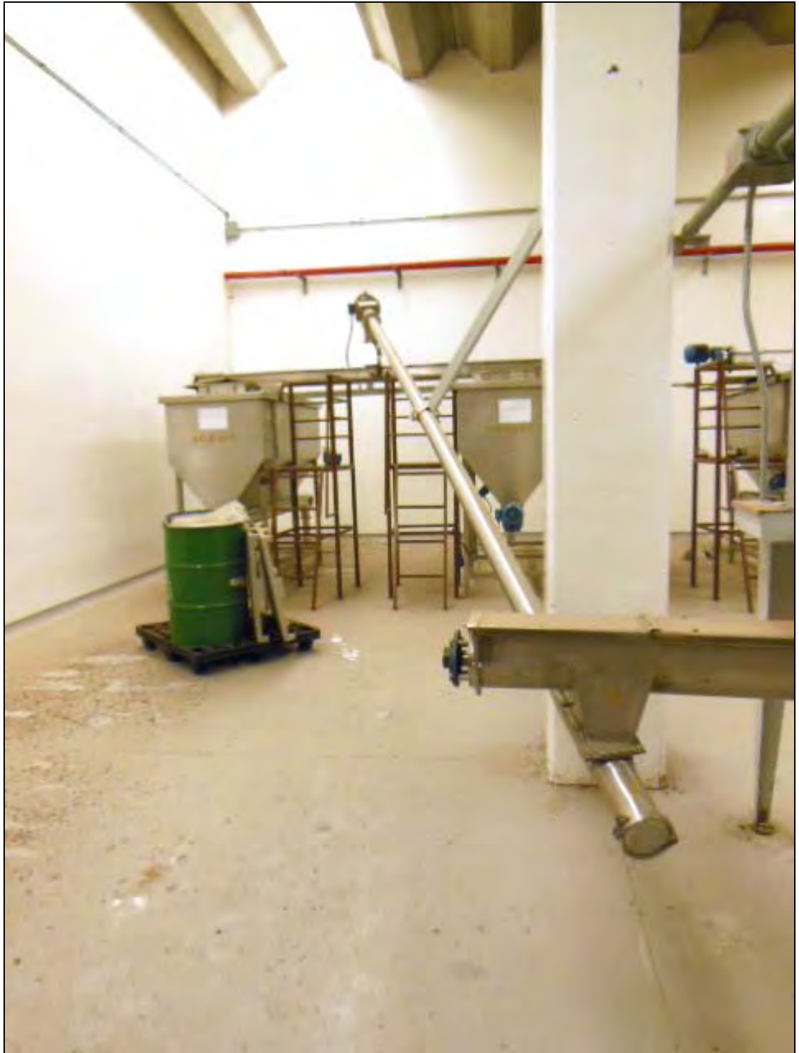
ITEM 1,019 – VISTA DA ROSCA TRANSPORTADORA INCLINADA EM ALUMINIO PARA ALIMENTAÇÃO DA ROSCA Nº 7
