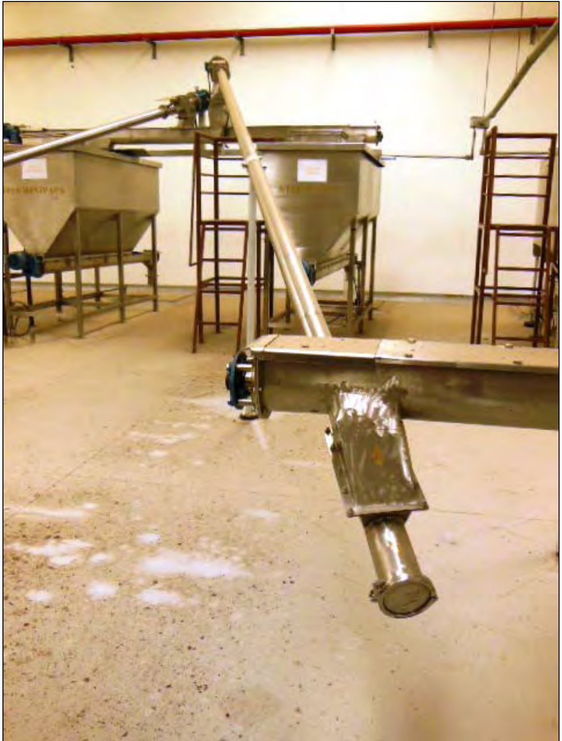
ITEM 1,029 – VISTA DA ROSCA TRANSPORTADORA INCLINADA EM ALUMINIO PARA ALIMENTAÇÃO DA ROSCA N°8
