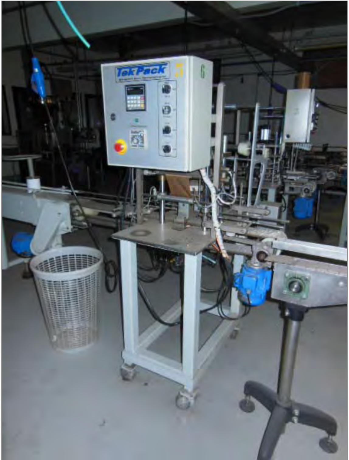
ITEM 1,041 – VISTA DA EMPACOTADEIRA MASIPACK I MARCA: ARV COMPOSTA POR SUPORTE INCLINADO EM ALUMINIO, ESTEIRA TRANSPORTADORA COMPRIMENTO 2,5 M, ESTEIRA TRANSPORTADORA COMPRIMENTO: 3 M, MÁQUINA DE TERMOSELAGEM 5 MARCA: TEKPACK E ESTEIRA DE SAÍDA
