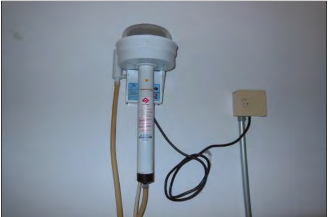
ITEM 1,064 – VISTA DO DESTILADOR DE AGUA MARCA: QUIMIS MODELO: Q-341-25
