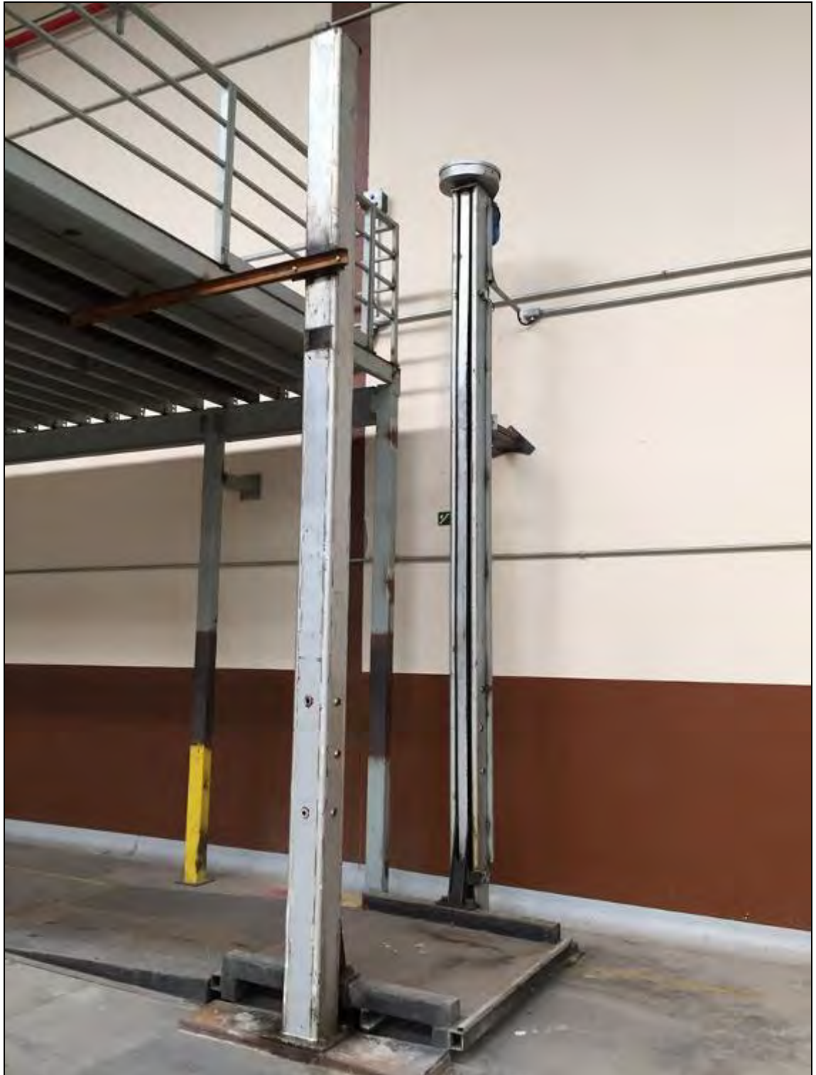
ITEM 1,093 – VISTA DA PLATAFORMA ELEVATORIA ALTURA: 7 M
