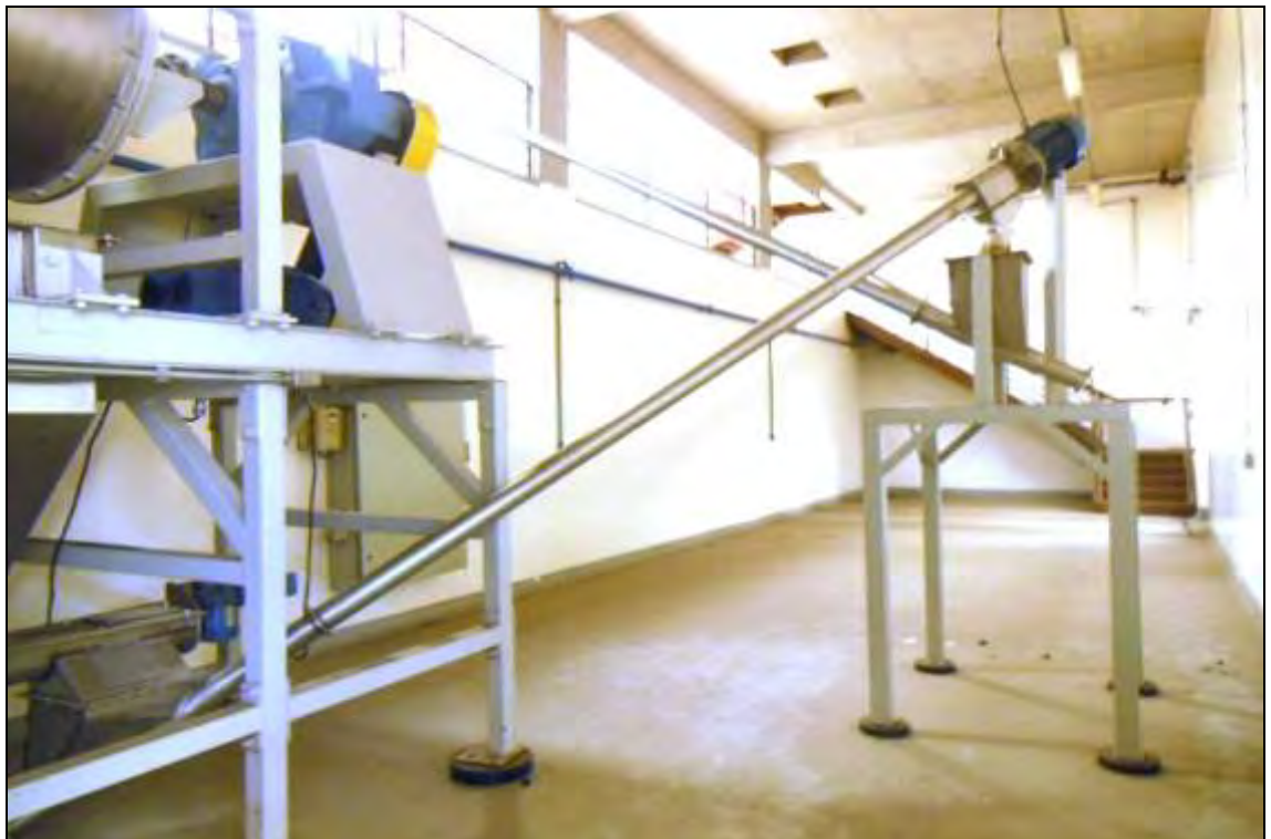
ITEM 1,015 – VISTA DA ROSCA TRANSPORTADORA INCLINADA EM ALUMINIO
