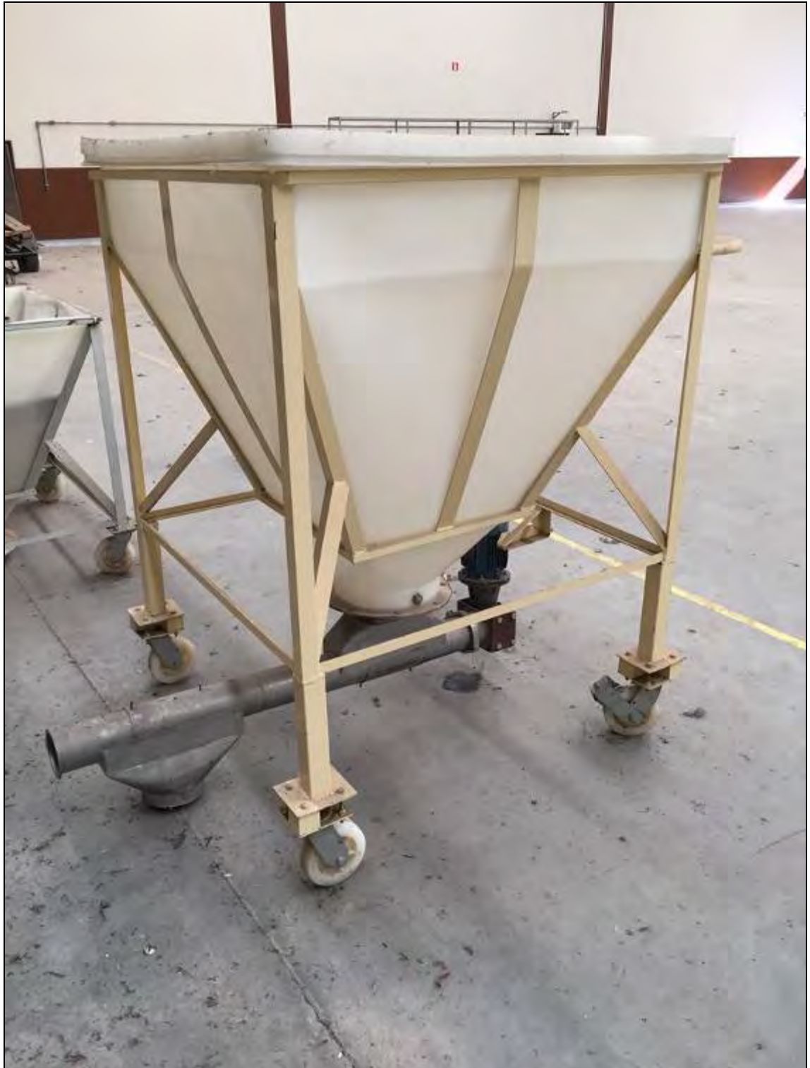
ITEM 2,238 – VISTA DO CARRO PARA TRANSPORTE DE PRODUTO COM ROSCA TRANSPORTADORA NA SAÍDA E RODIZÍO
