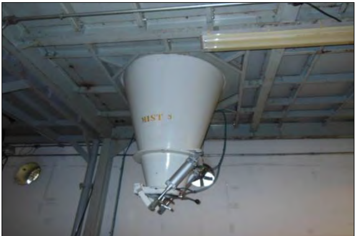
ITEM 1,065 – VISTA DO MISTURADOR V MARCA: SEMCO FA-35 MODELO: CONIMIX CAP: 990LTS EM MEZANINO EM ACO CARBONO E ESCADA SERIE: FA-35/019/86
