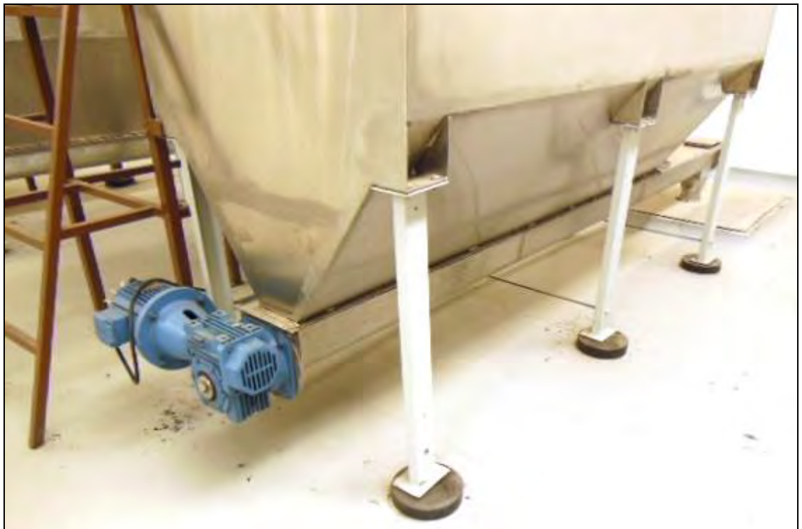
ITEM 1,033 – VISTA DO SILO FABRIMA II EM ALUMINIO COM VIBRADOR E ROSCA NA SAÍDA
