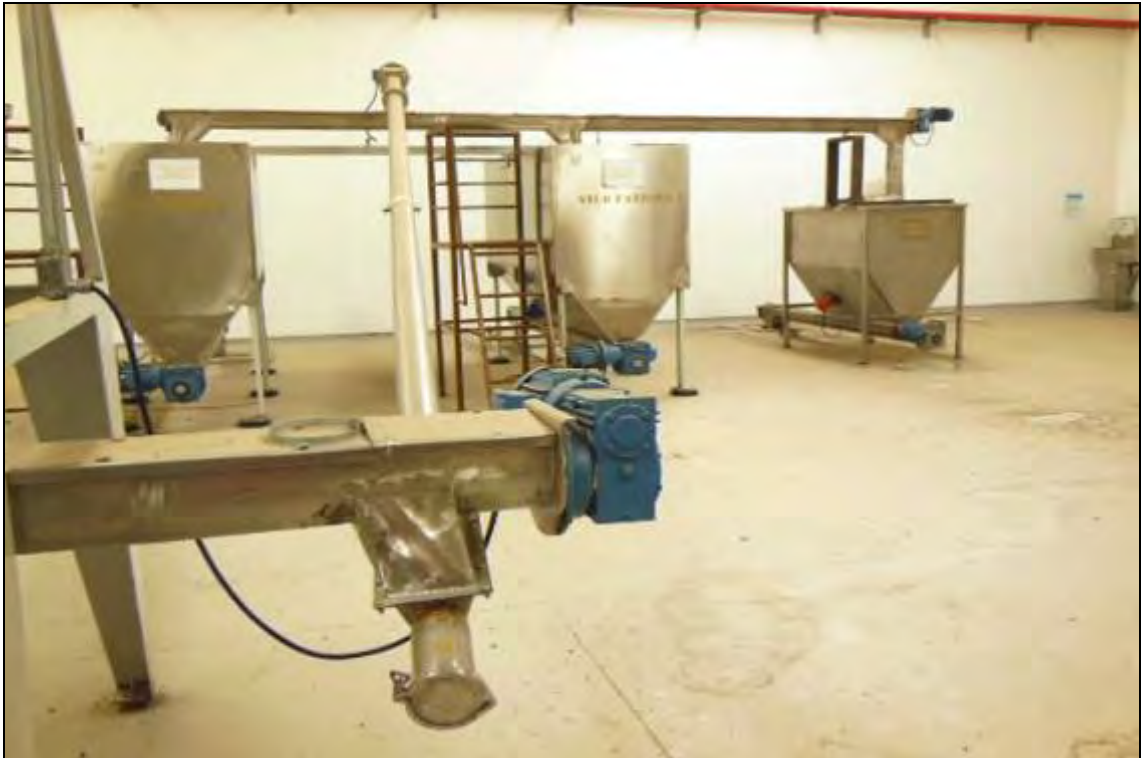
ITEM 1,030 – VISTA DA ROSCA TRANSPORTADORA INCLINADA EM ALUMINIO PARA ALIMENTAÇÃO DA ROSCA N°8
