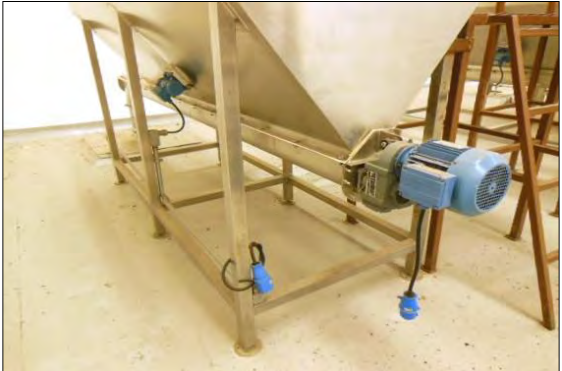
ITEM 1,023 – VISTA DO SILO ARV Nº1 EM ALUMINIO COM VIBRADOR MARCA: DONAR E ROSCA TRANSPORTADORA NA SAÍDA, ACIONAMENTO POR MOTOR REDUTOR MARCA: SEW-EURODRIVE
