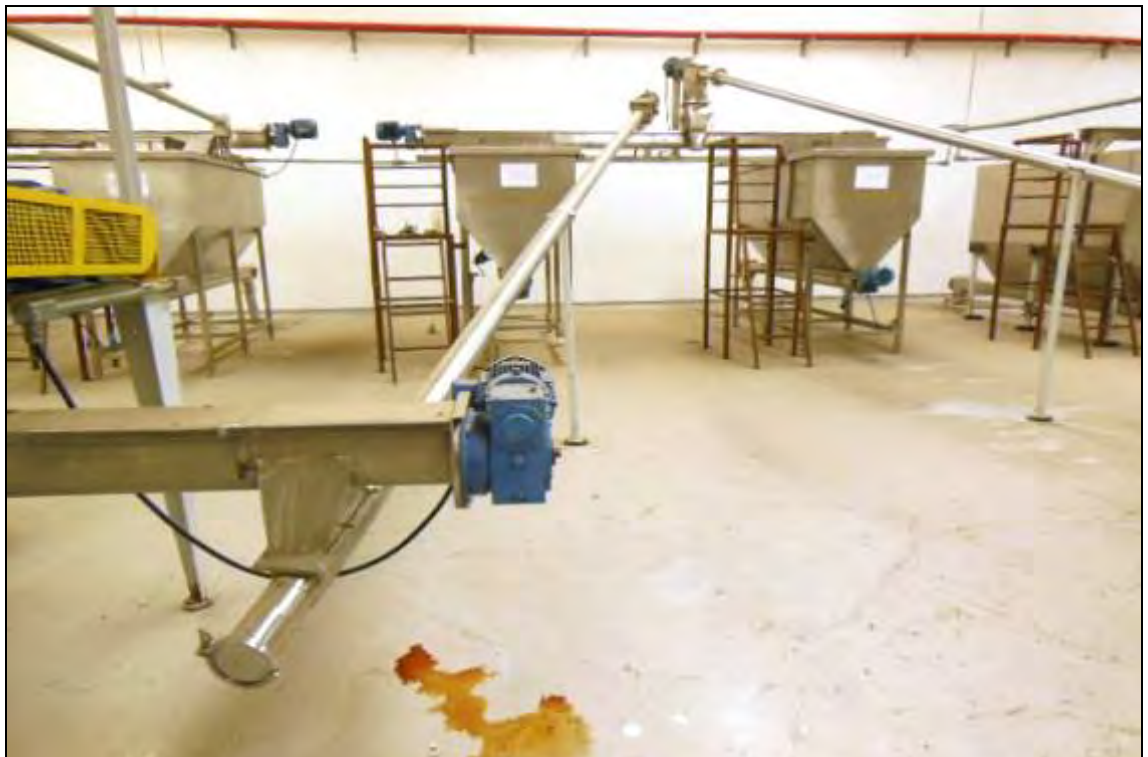
ITEM 1,021 – VISTA DA ROSCA TRANSPORTADORA INCLINADA EM ALUMINIO PARA ALIMENTAÇÃO DA ROSCA Nº8
