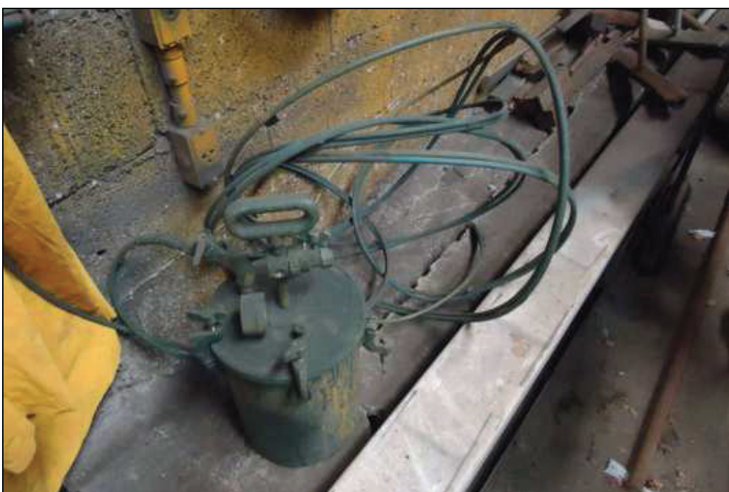
ITEM 1,029 - VISTA DO BUJÃO C/ MANGUEIRA DA PISTOLA DE ALTA PRESSÃO PARA PINTURA MARCA: GAMA
