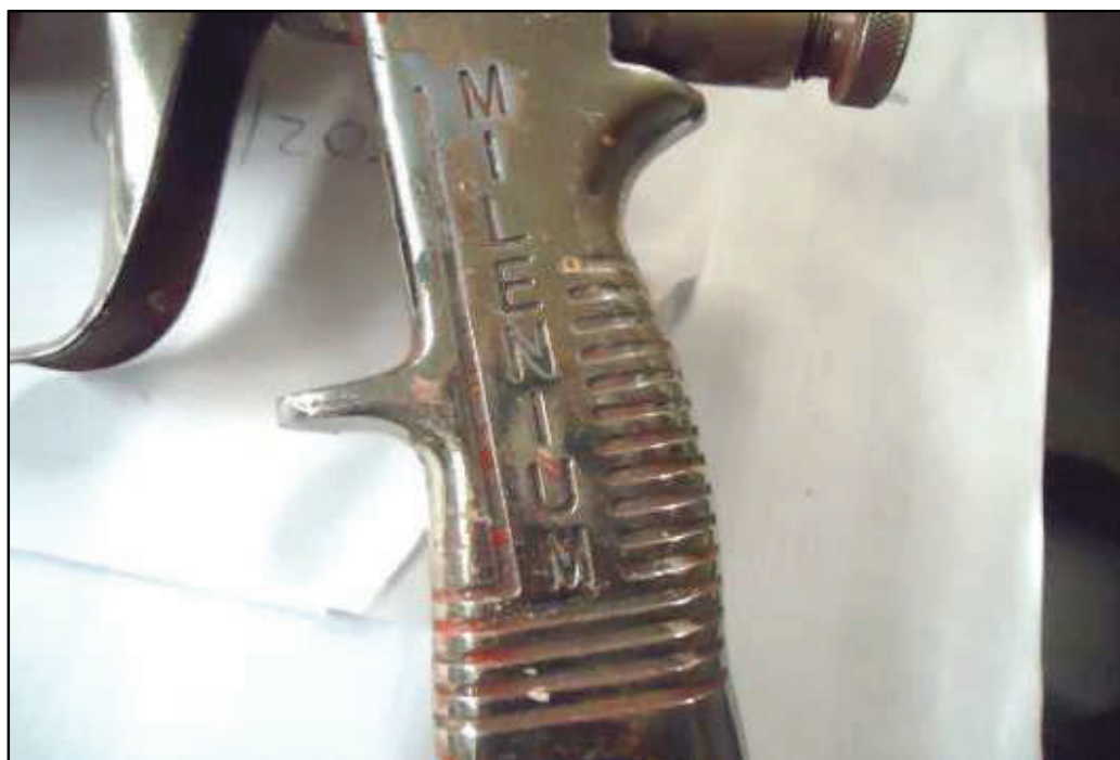
ITEM 1,030 - VISTA DA IDENTIFICAÇÃO DA PISTOLA MARCA: MILENIUM MODELO: HVLP 1,4MM C/ REG. (5405)
