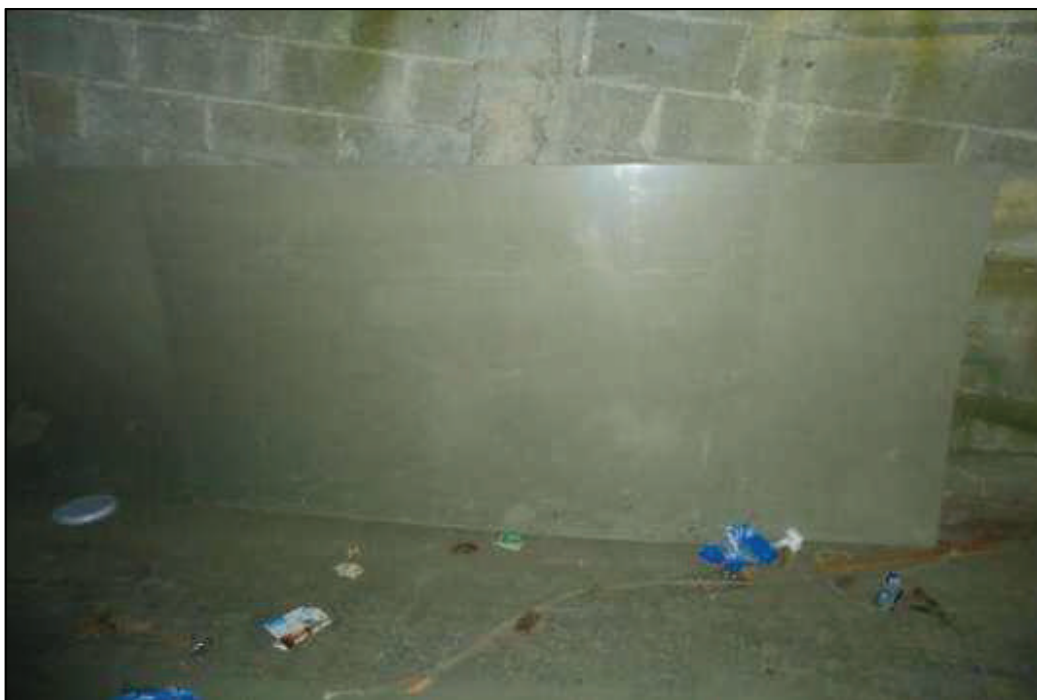
ITEM 5,005 - VISTA DA CHAPA DE POLIPROPILENO DIM:4,00X1,30X5MM (COMPRIMENTO X LARGURA X ESPESSURA)
