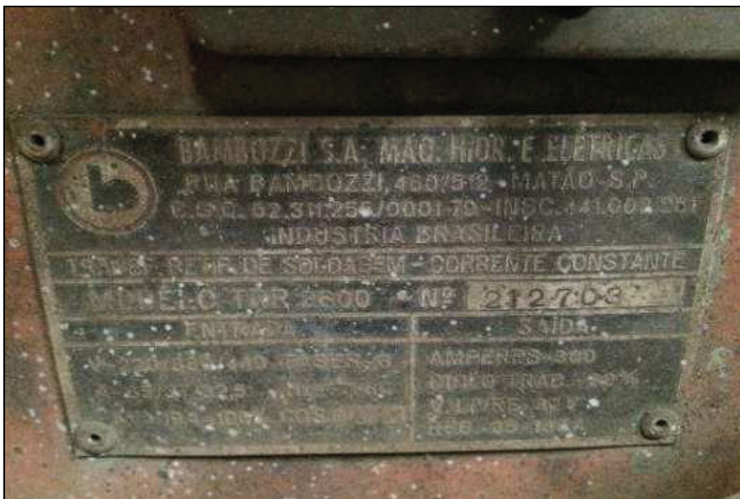
ITEM 1,021 - VISTA DA PLACA DE IDENTIFICAÇÃO DA MÁQUINA DE SOLDA MARCA: BAMBOZZI MODELO: TRR 2600 N°212703
