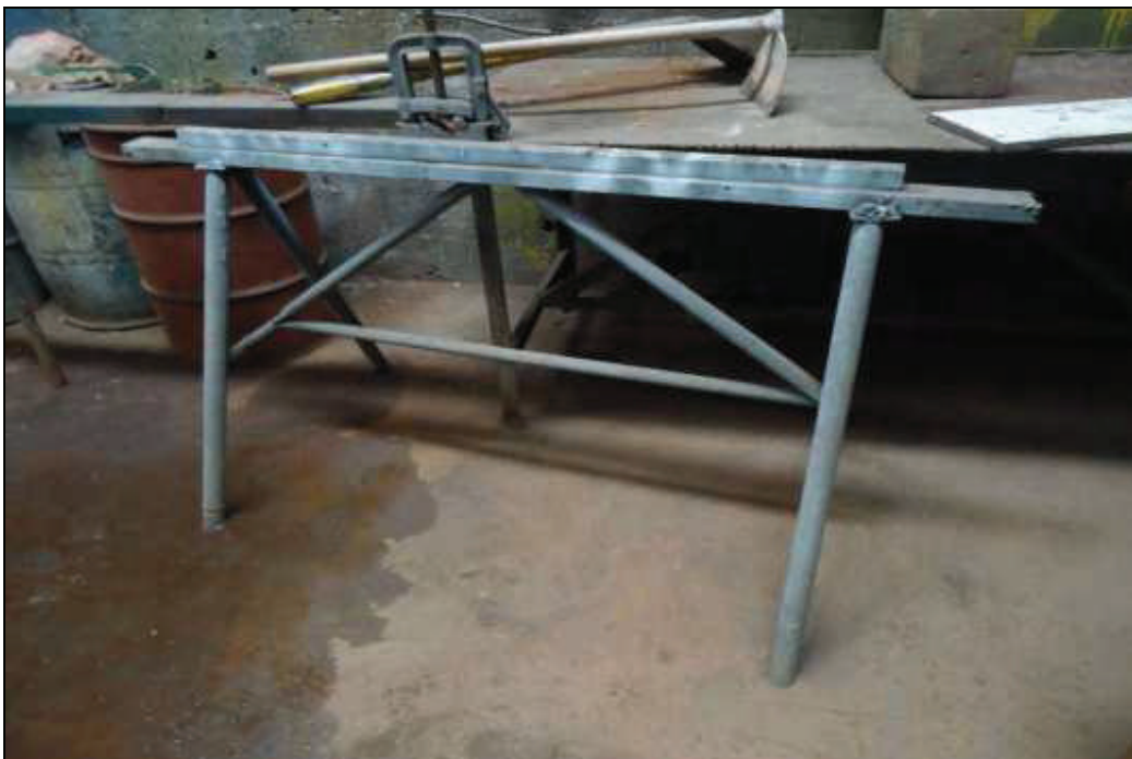
ITEM 5,003 - VISTA DO CAVALETE DIM: 1,00X 2,00M (ALTURA X LARGURA) (FABRICAÇÃO PRÓPRIA)
