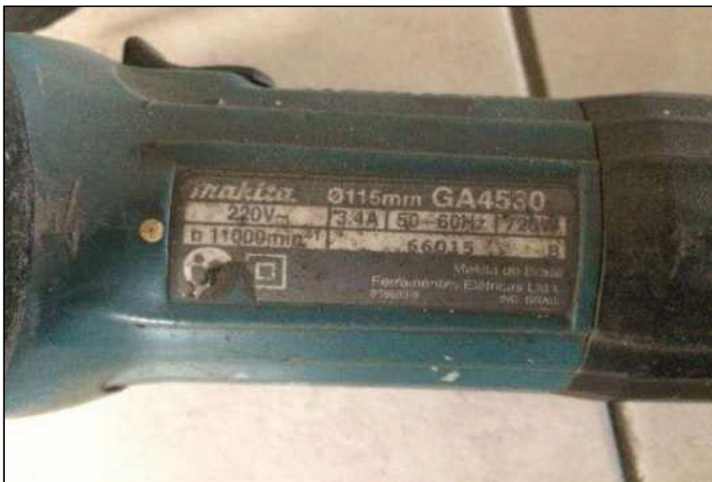
ITEM 1,011 - VISTA DA PLACA DE IDENTIFICAÇÃO DA ESMERILHADEIRA ANGULAR MARCA: MAKITA DIM: 4.1/2" VOLT: 220 V
