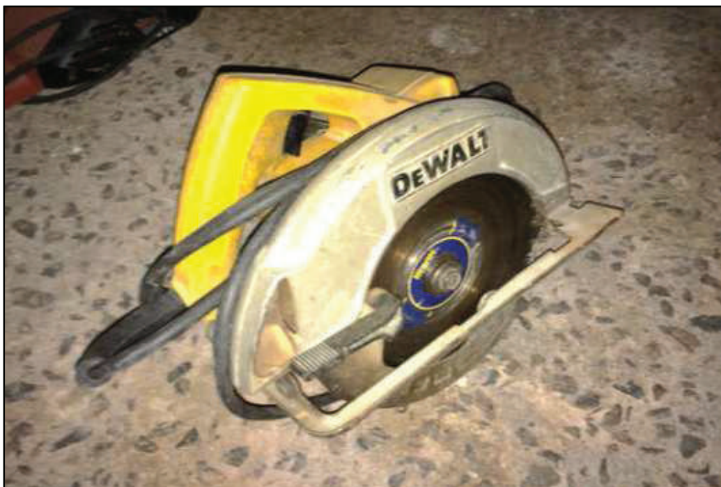
ITEM 1,038 - VISTA DA SERRA CIRCULAR MARCA: DEWALT MODELO: DW352B2 DIM: 71/4" VOLT: 220V
