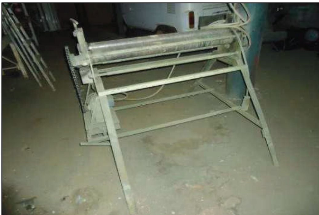
ITEM 1,002 - VISTA DA CALANDRA MECÂNICA PARA CHAPA DE DIM: 1,50 LARG.X 2MM ESPESSURA
