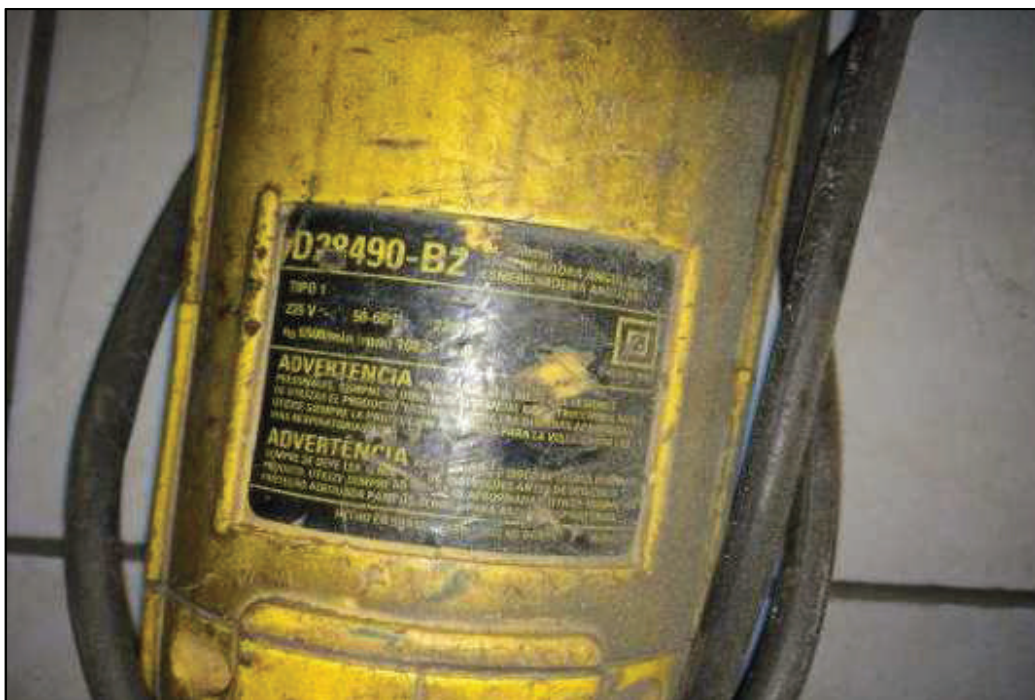
ITEM 1,013 - VISTA DA PLACA DE IDENTIFICAÇÃO DA ESMERILHADEIRA MARCA: DEWALT MODELO: D28490 ANGULAR DIM: 9" VOLT: 220 V
