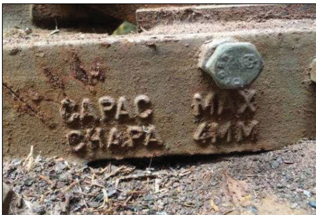
ITEM 1,034 - VISTA DA IDENTIFICAÇÃO DA TESOURA DE BANCADA PARA CORTE DE CHAPA
