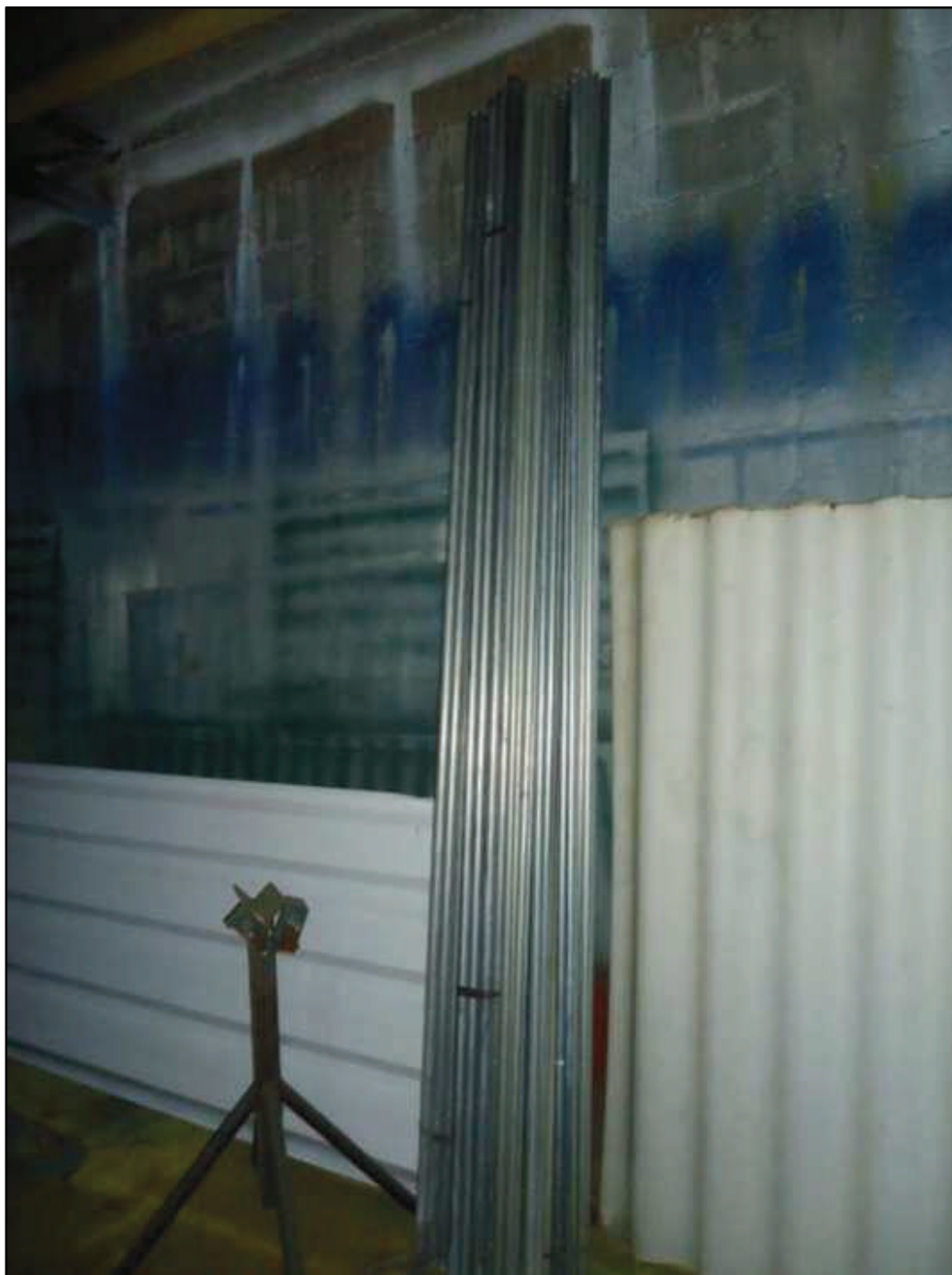
ITEM 5,006 - VISTA DOS CONDUTES ELÉTRICOS GALVANIZADOS DIM: 3/4"X3,00M DE COMPRIMENTO
