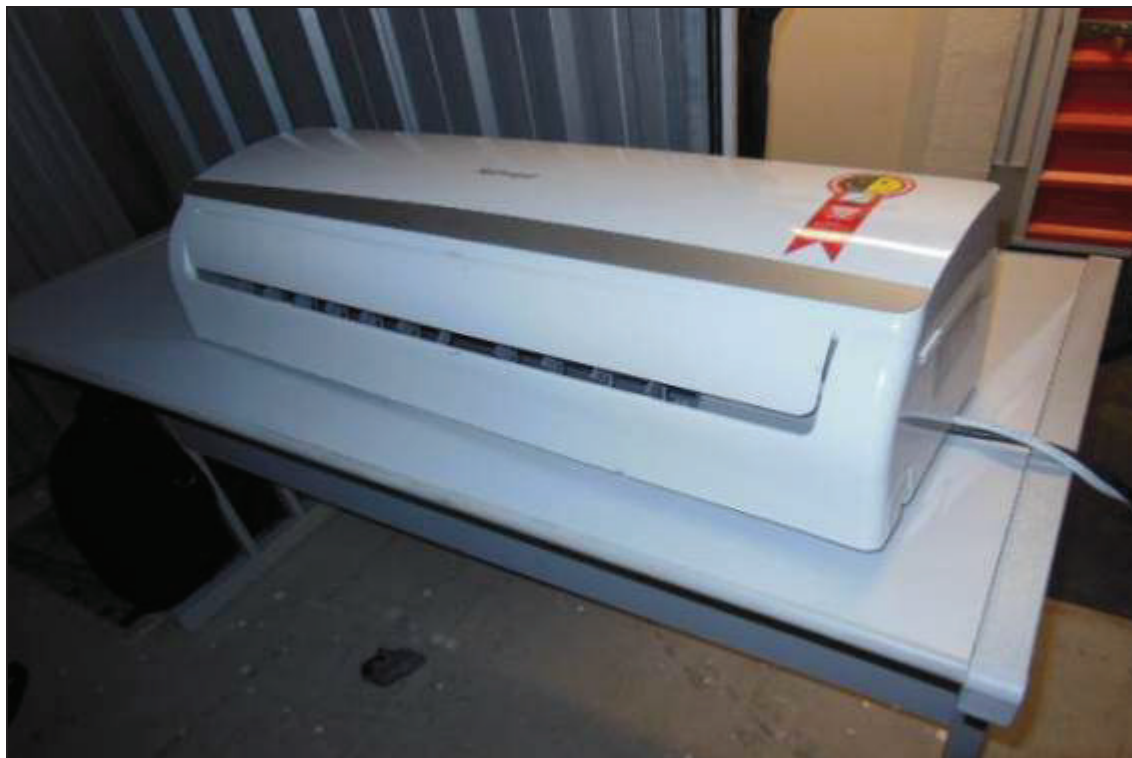
ITEM 1,011 – VISTA DO AR CONDICIONADO MARCA: SPRINGER CARRIER MODELO: SPLIT HI WALL POTÊNCIA: 12.000BTU SÉRIE: 42FNCA12S5
