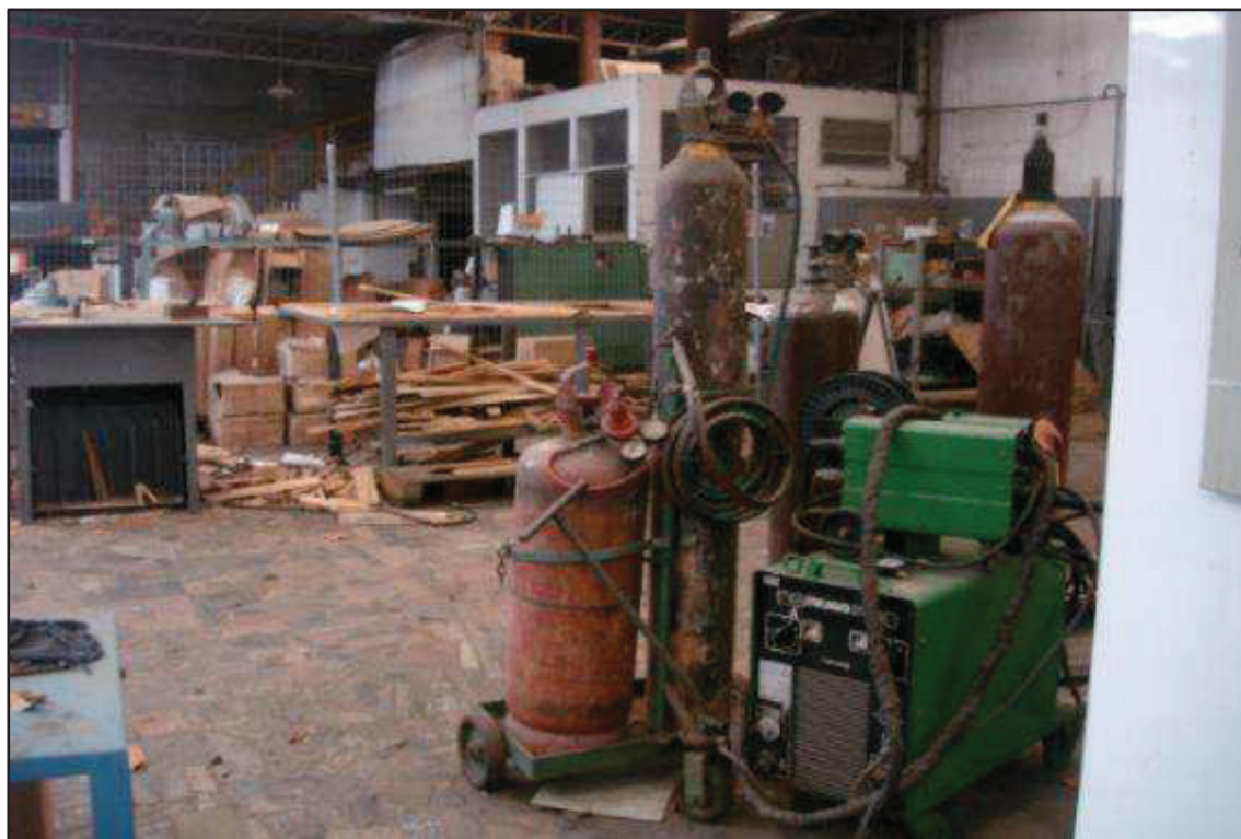
ITEM 1,014 - VISTA DO CONJUNTO DE SOLDA OXIACETILENO
