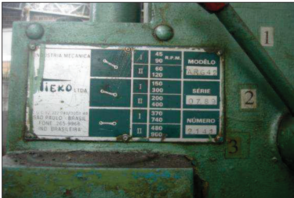
ITEM 1,020 - VISTA DA PLACA DE IDENTIFICAÇÃO DA FURADEIRA DE COLUNA MARCA: TIEKO MODELO: ARG 42 SERIE:0789 N°2141
