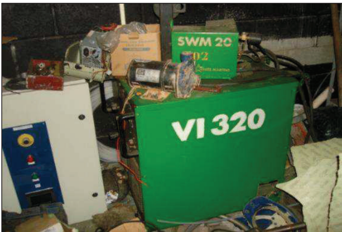
ITEM 1,016 - VISTA DA MAQUINA DE SOLDA MIG MARCA: WHITE MARTINS MODELO: VI320
