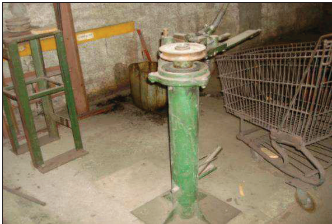
ITEM 1,059 - VISTA DO CURVADOR DE TUBOS DE ALAVANCA
