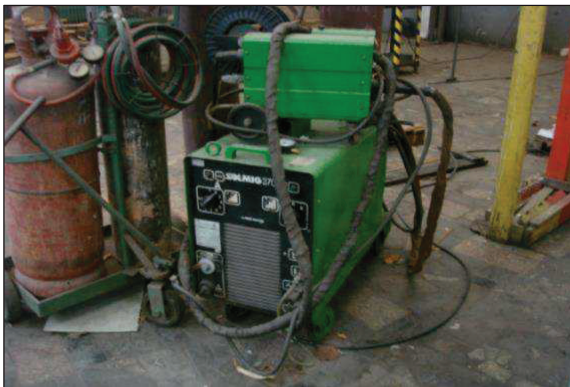
ITEM 1,013 - VISTA DA MAQUINA DE SOLDA MIG MARCA: WHITE MARTINS MODELO: SOLMIG 370
