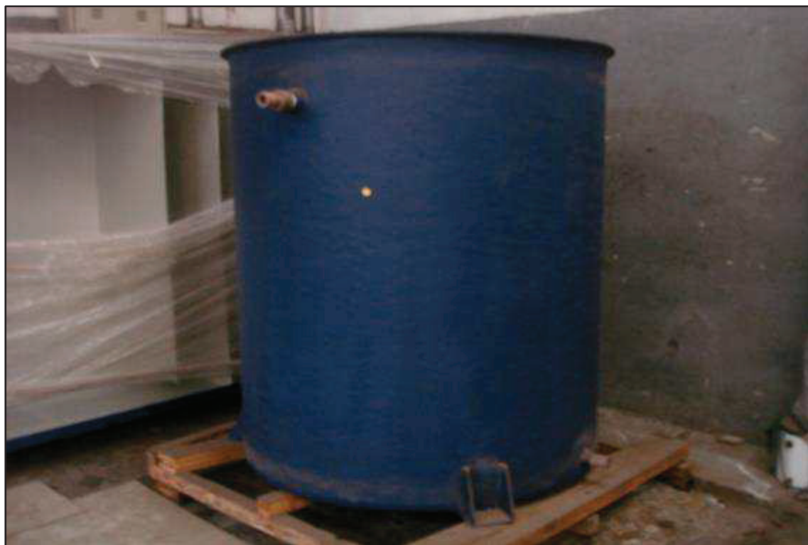
ITEM 5,341 - VISTA DO TANQUE DE FIBRA 3000 L
