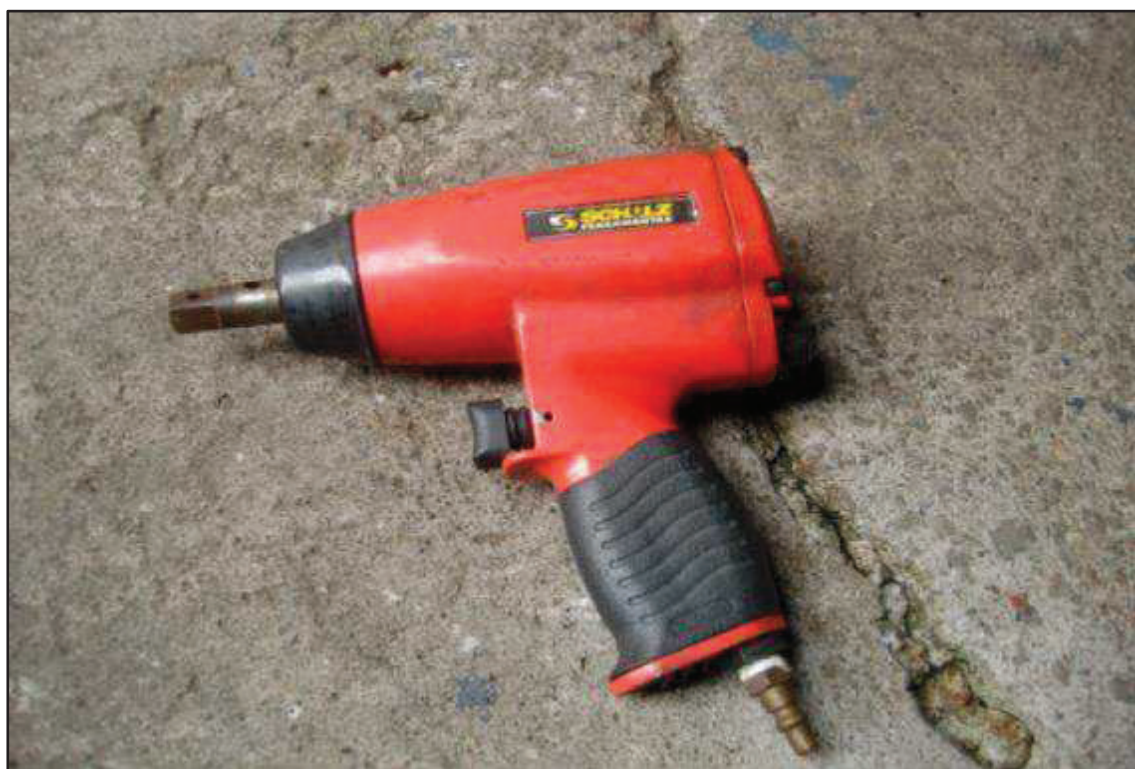
ITEM 1,063 - VISTA DA PARAFUSADEIRA PNEUMÁTICA MARCA: SCHULTZ
