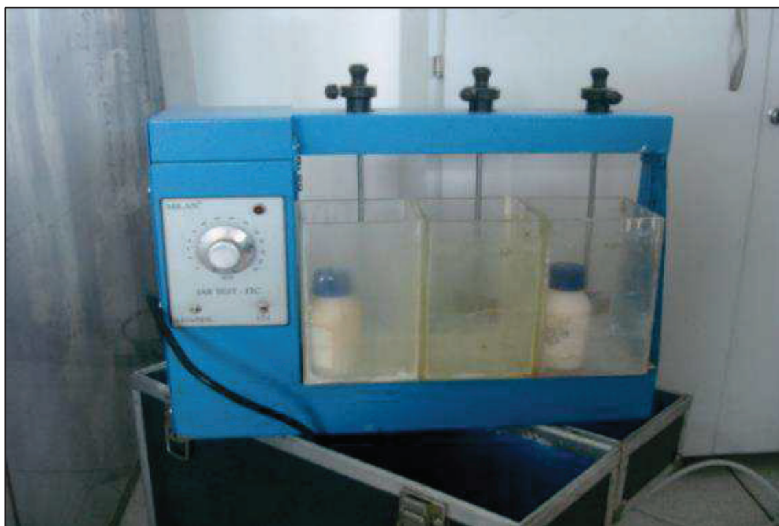
ITEM 1,068 - VISTA DO JAR TEST ANALÓGICO COM 3 PROVAS MARCA: MILAN MODELO: JTC
