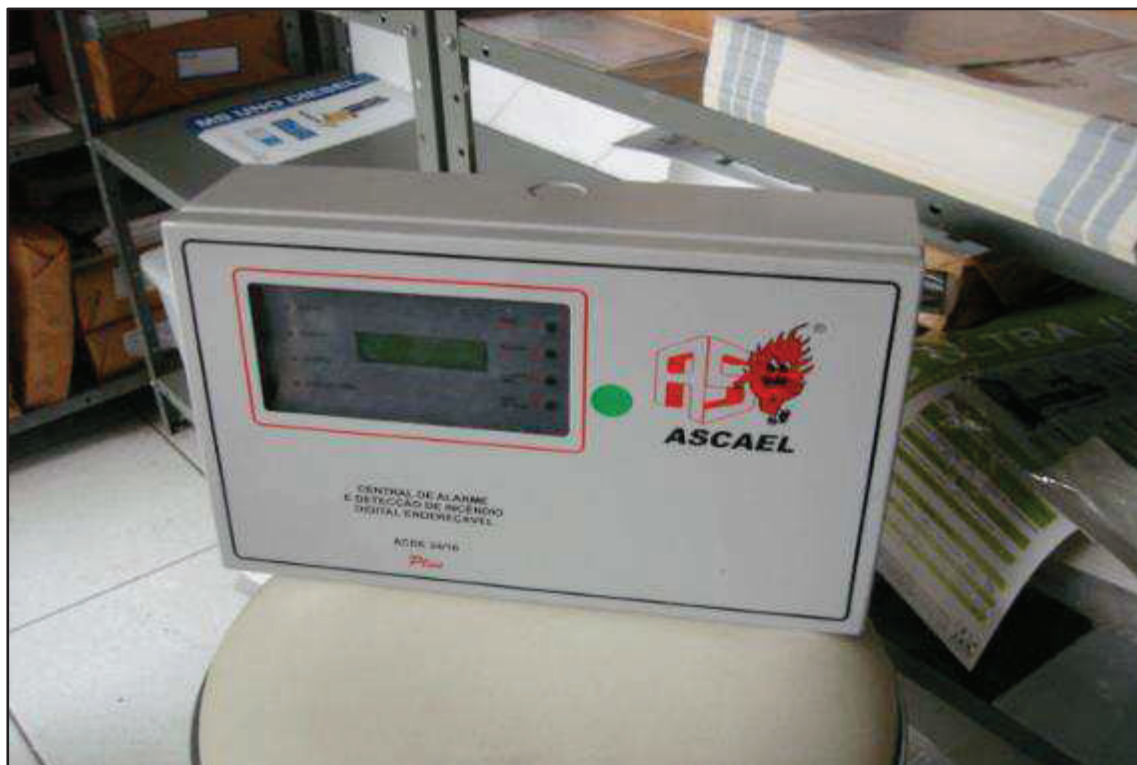
ITEM 5,001 - VISTA DA CENTRAL DE ALARME DIGITAL ENDEREÇÁVEL MARCA: ASCAEL MODELO: ACDE 24/16 PLUS
