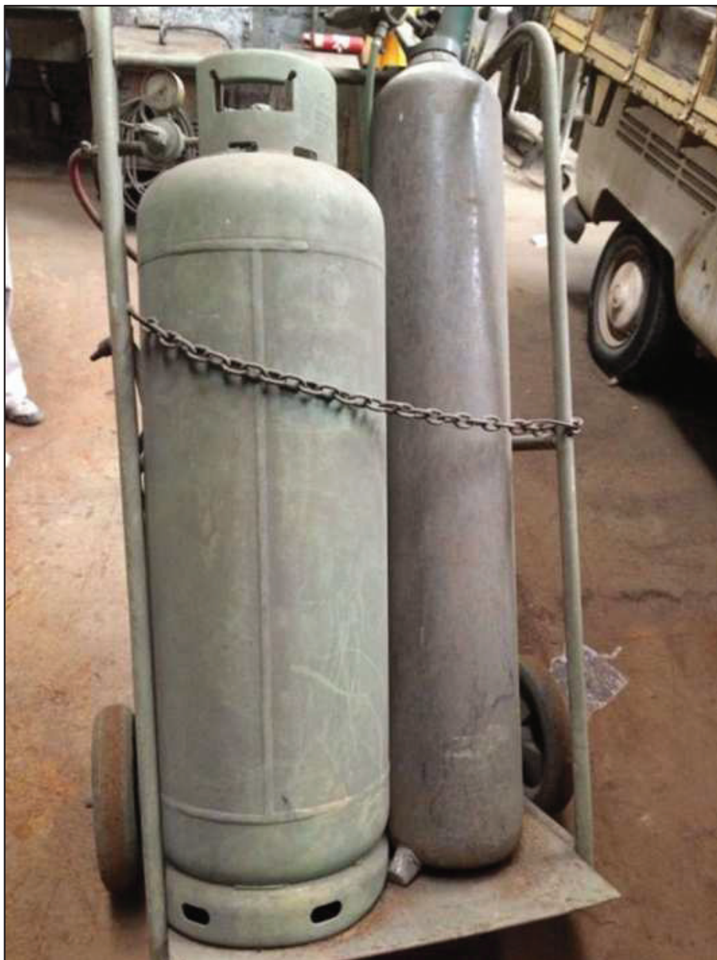
ITEM 1,006 / 1,007 - VISTA DO CILINDRO DE GÁS MARCA: COPAGAZ E DO CILINDRO DE OXIGÊNIO MARCA: OXICAN
