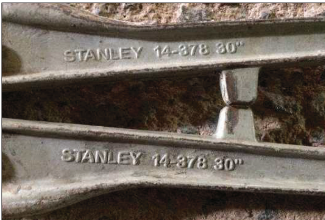
ITEM 1,037 - VISTA DA IDENTIFICAÇÃO DO ALICATE TESOURARIA CORTA VERGALHÃO MANUAL MARCA: STANLEY DIM: 30"
