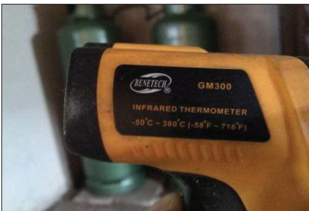
ITEM 1,042 - VISTA DA PLACA DE IDENTIFICAÇÃO DO TERMÔMETRO DIGITAL MARCA: BENETECH MODELO: GM 300
