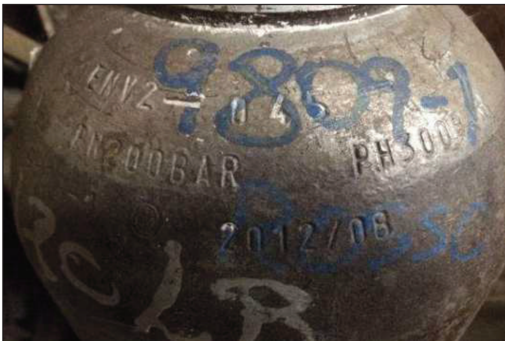
ITEM 1,008 - VISTA DA IDENTIFICAÇÃO DO CILINDRO DE OXIGÊNIO
