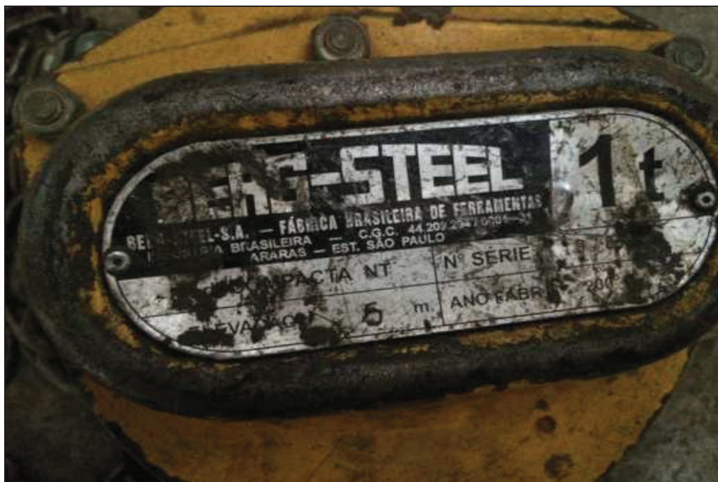
ITEM 1,033 - VISTA DA PLACA DE IDENTIFICAÇÃO DA TALHA MANUAL CAP: 1,0 TON. COM 3,0 METROS
