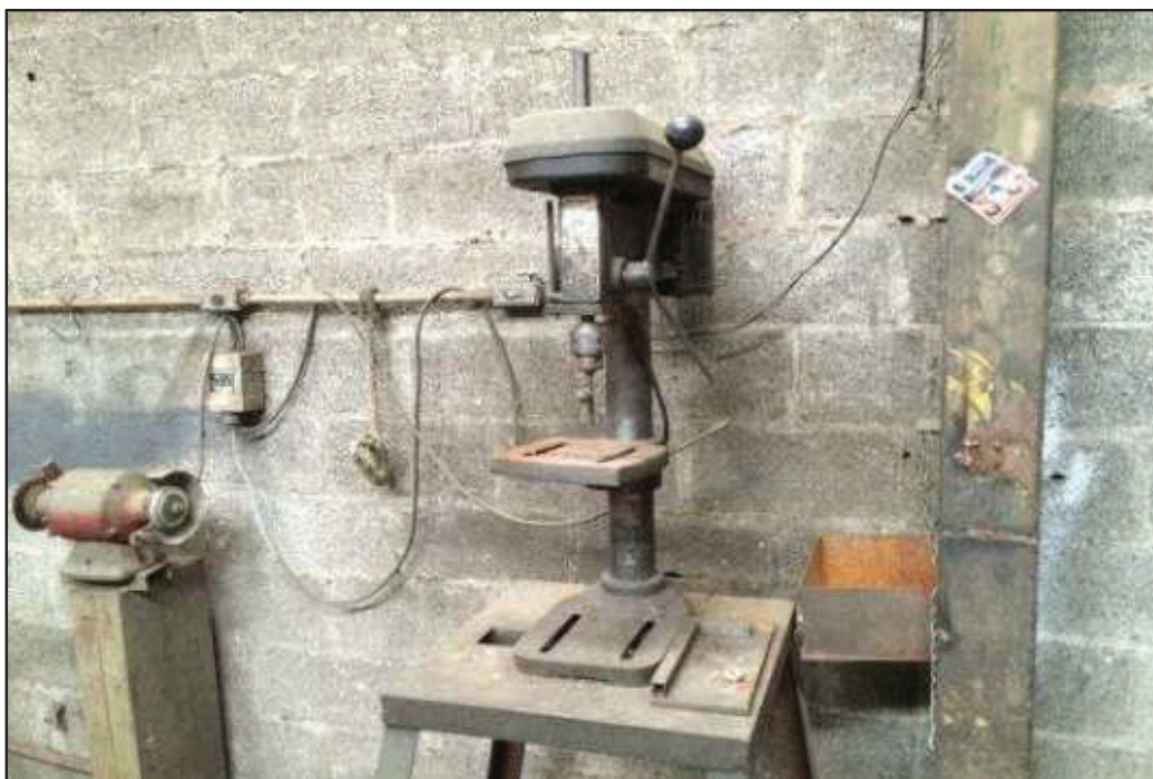
ITEM 1,016 - VISTA DA FURADEIRA DE BANCADA MARCA: MOTOMIL MODELO: FB160 DW DIM: 5/8"
