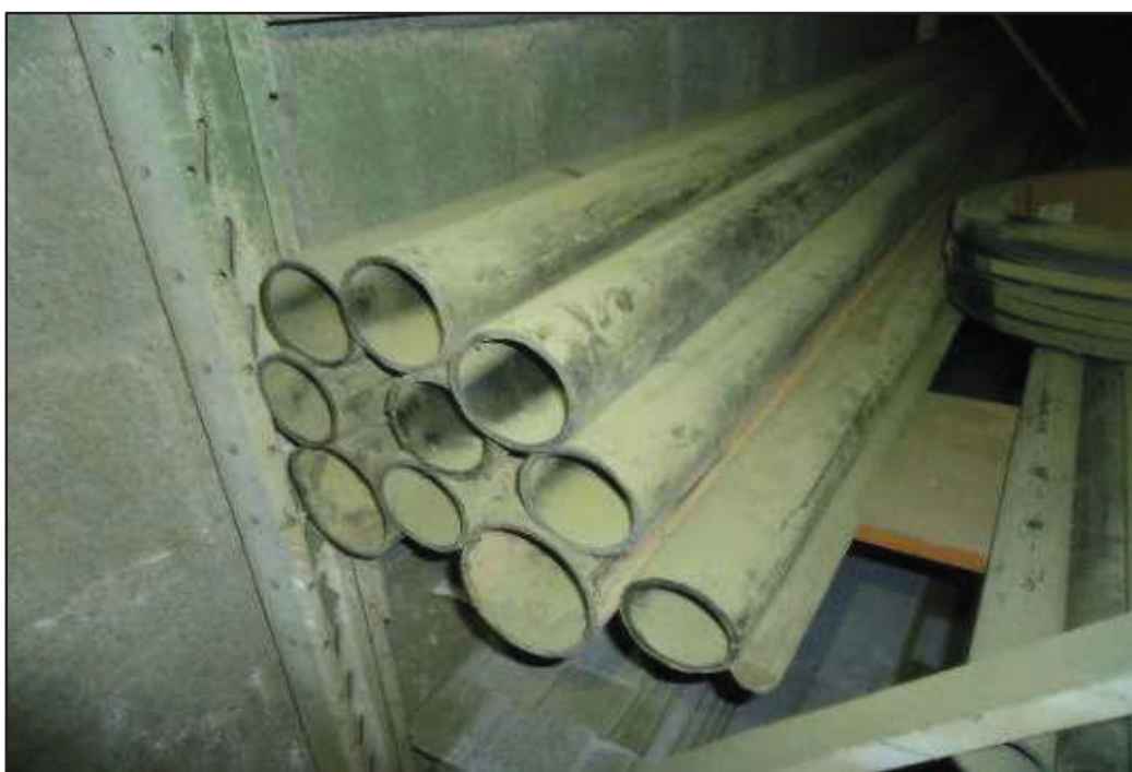
ITEM 5,011 / ITEM 5,012 VISTA DOS TUBOS DE POLIPROPILENO DIM: 3" X 6,0M COR: PRETO E DO TUBO DE POLIPROPILENO DIM: 4" X 6,0M COR: PRETO
