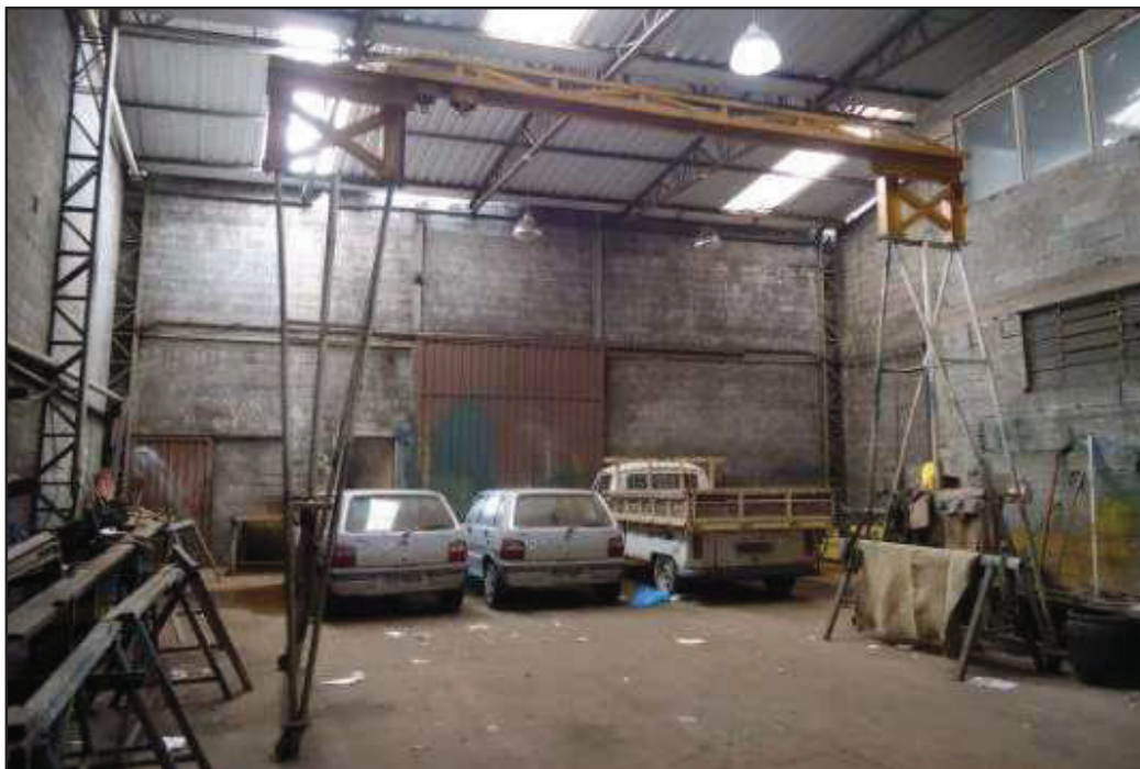
ITEM 1,031 - VISTA DO PÓRTICO PARA TALHA DIM: 4,00X5,00M (ALT X LARG) PARA 3000KG (FABRICAÇÃO PRÓPRIA)
