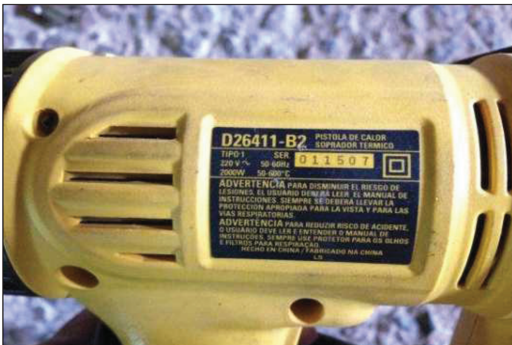
ITEM 1,040 - VISTA DA PLACA DE IDENTIFICAÇÃO DO SOPRADOR TÉRMICO MARCA: DEWALT MODELO: D26411 HL 1800 2200
