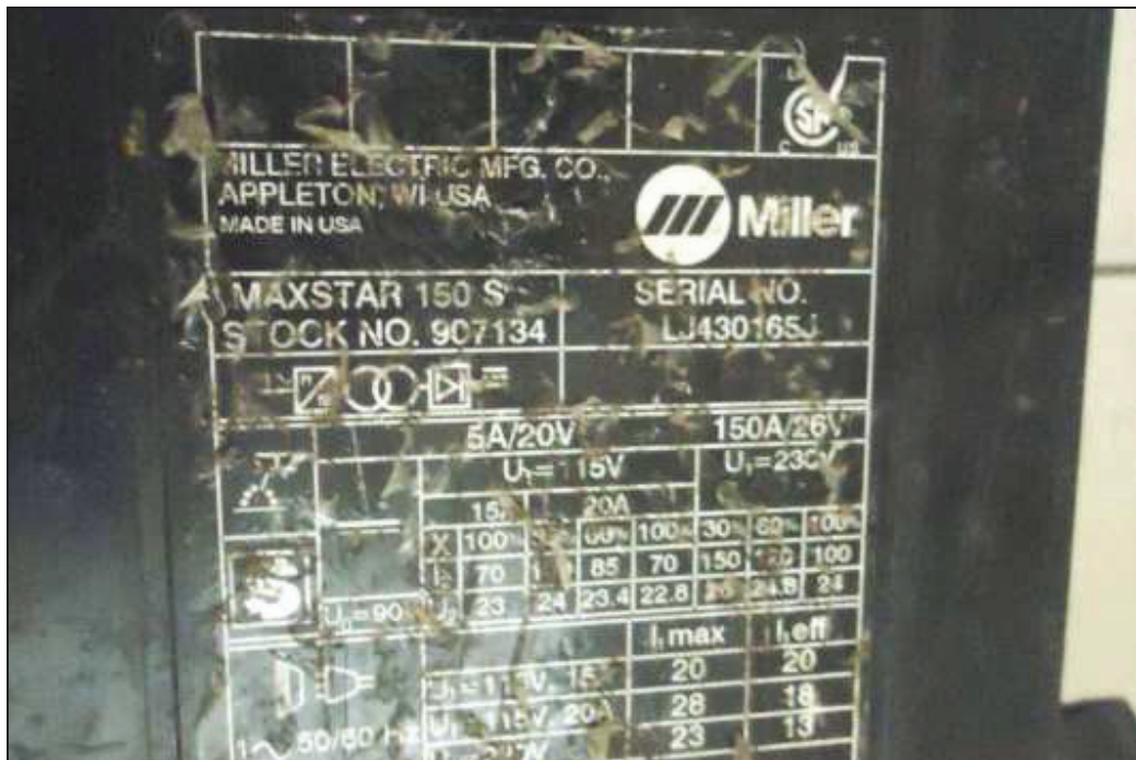
ITEM 1,026 - VISTA DA PLACA DE IDENTIFICAÇÃO DA MÁQUINA DE SOLDA MARCA: MILLER MODELO: FONTE MAXSTAR 150 S STICK ONLY- 907134
