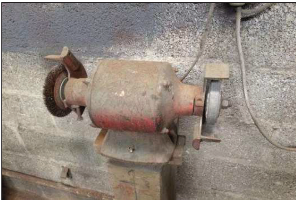
ITEM 1,010 - VISTA DO ESMERIL DE BANCADA
