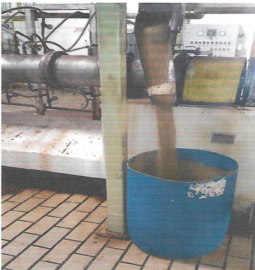
EXTRUSORA MARCA FERRAZ - MODELO E - 200 A EM FUNCIONAMENTO, PRODUZINDO RAÇÃO ANIMAL
