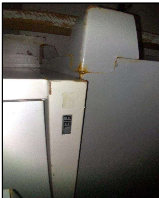
FOTO 03 e 04 – Detalhes de oxidação
