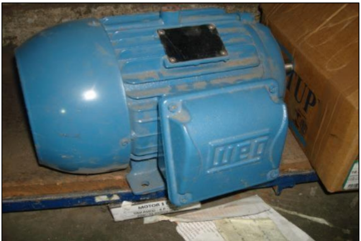
ITEM 1,027 - VISTA DO MOTOR 1 CV
