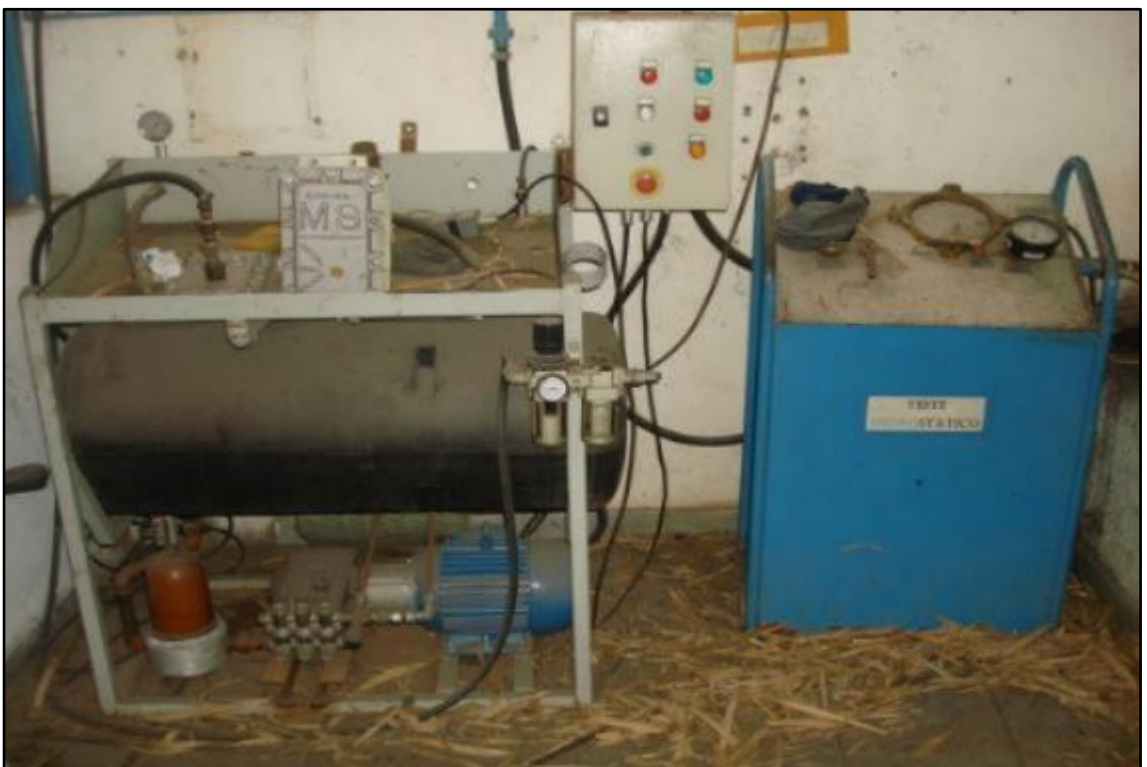
ITEM 1,060 - VISTA DO EQUIPAMENTO PARA TESTE HIDROSTÁTICO COM MARCADOR DE PRESSÃO, BOMBA HIDRÁULICA E RESERVATÓRIO
