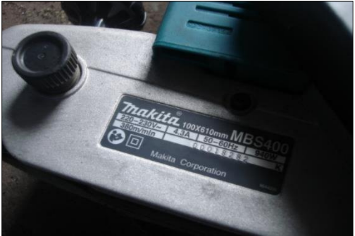
ITEM 1,047 - VISTA DA PLACA DE IDENTIFICAÇÃO DA LIXADEIRA DE CINTA MARCA: MAKITA MODELO: MBS400
