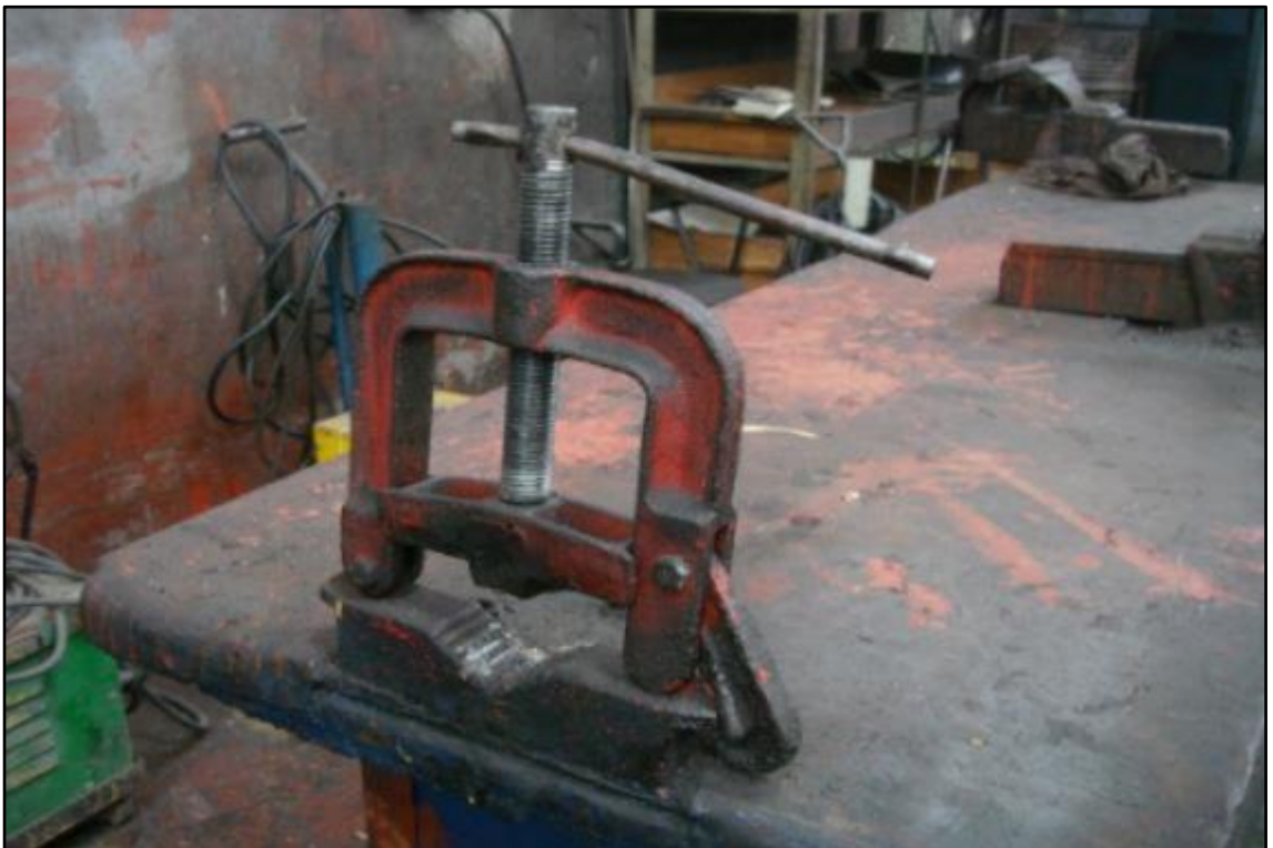
ITEM 1,042 - VISTA DA MORSA PARA CANOS
