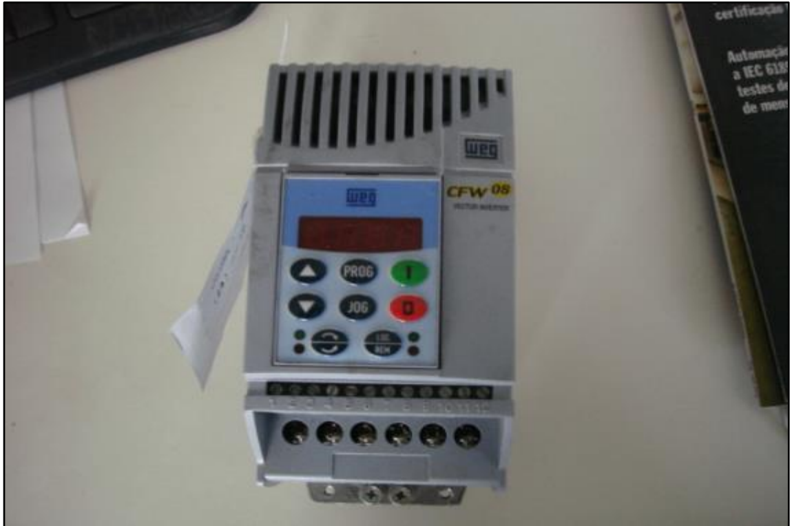
ITEM 5,331 - VISTA DO INVERSOR DE FREQUÊNCIA MARCA: WEG MODELO: CFW 08
