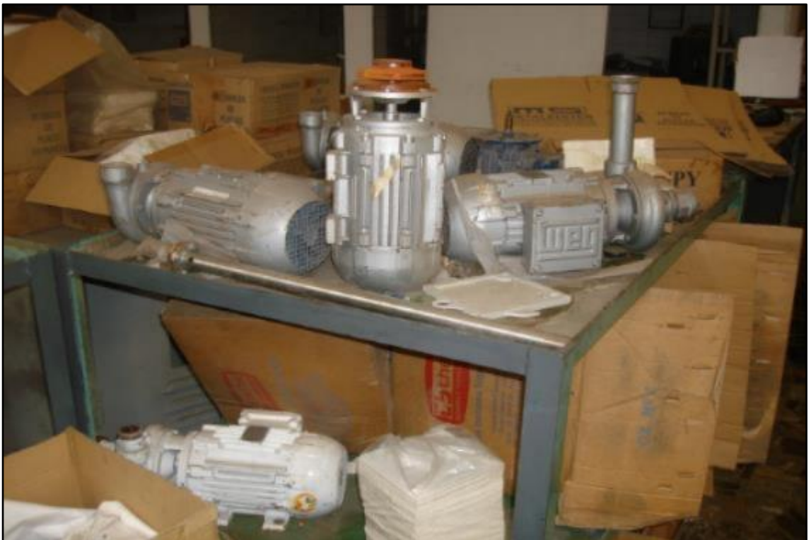
ITEM 1,075 - VISTA DA BOMBA CENTRIFUGA COM MOTOR ELÉTRICO
