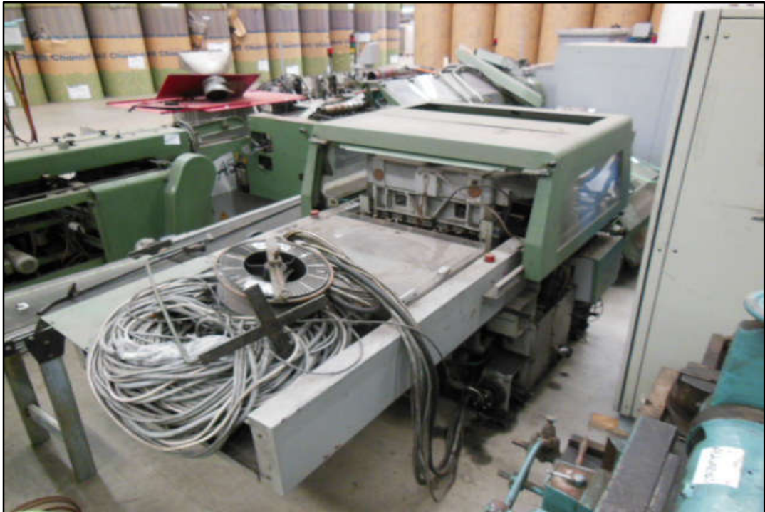
ITEM 1,039 - VISTA DA GRAMPEADEIRA "1" MARCA: MULLER MARTINI MODELO: PRIMA – 321/335/H-300 (GUILHOTINA MARCA: MULLER MARTINI MODELO: 036.0405/09)
