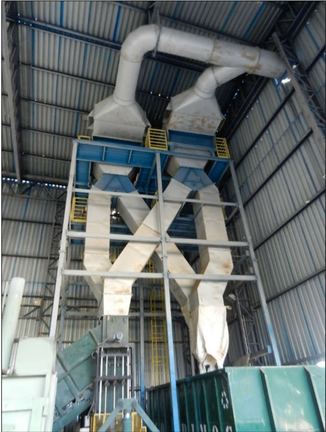
ITEM 1,146 - VISTA DA LINHA DE Prensagem de Aparas de Papel compreendendo os itens (2 MOEGAS para recebimento das aparas com duto de descarga para alimentação de prensa ou de container e plataforma metálica)
