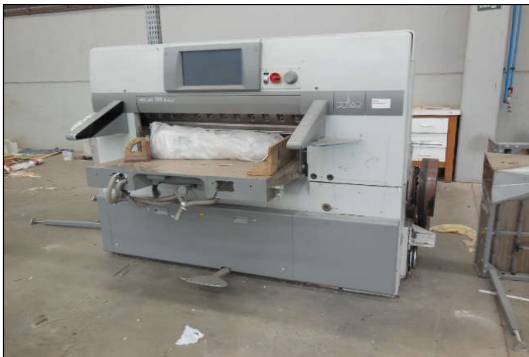
ITEM 1,008 - VISTA DA GUILHOTINA MARCA: POLAR MODELO: 115XPLUS /M115-11 Nº 8131404 COM 2 MESAS LATERAIS
