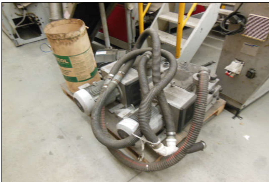
ITEM 1,041 - VISTA DAS 3 BOMBAS DE VÁCUO
