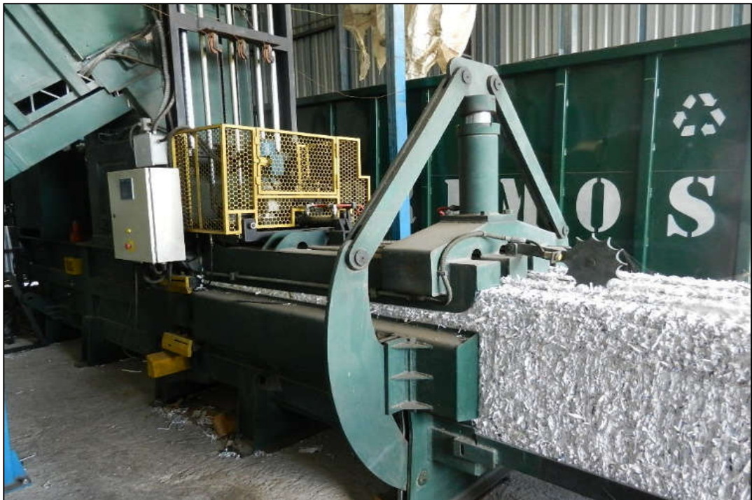
ITEM 1,146 - VISTA DA LINHA DE PENSAGEM DE APARAS DE PAPEL COMPREENDENDO OS ITENS (Prensa enfardadeira horizontal hidraulica (PP-40) com alimentador de arame
