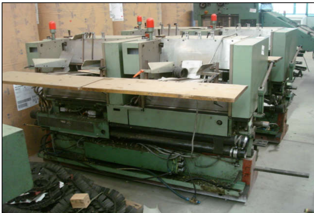
ITEM 1,040 - VISTA DAS 4 UNIDADES DE ALCEAMENTO
