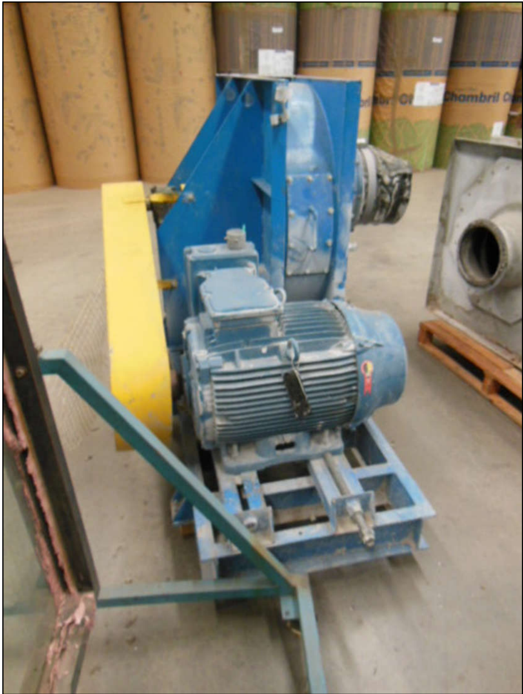
ITEM 1,074 - VISTA DO EXAUSTOR MARCA: ENVITECH COM MOTOR ELÉTRICO DE 75 CV
