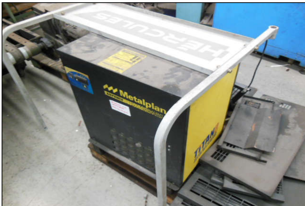
ITEM 1,068 - VISTA DO SECADOR DE AR COMPRIMIDO MARCA: TITAN MODELO: A40 PLUS
