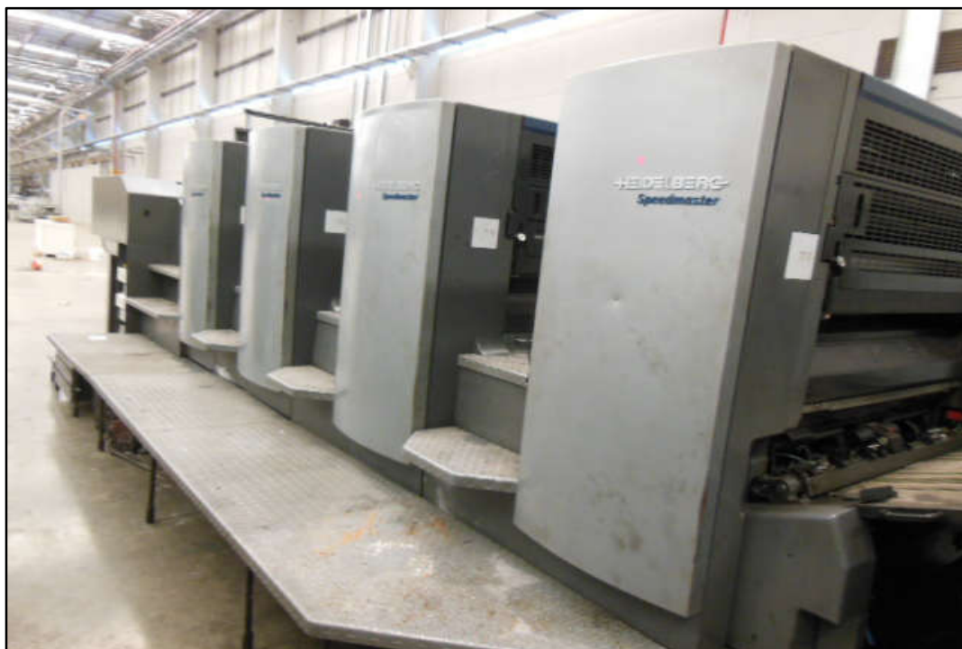
ITEM 1,022 - VISTA DA IMPRESSORA OFF-SET MARCA: HEIDELBERG MODELO: SPEEDMASTER MODELO: SM-102-4-P3 DE 4 CORES, N° 546652 COM ALIMENTADOR, MESA DE SAÍDA E PAINEL DE COMANDO
