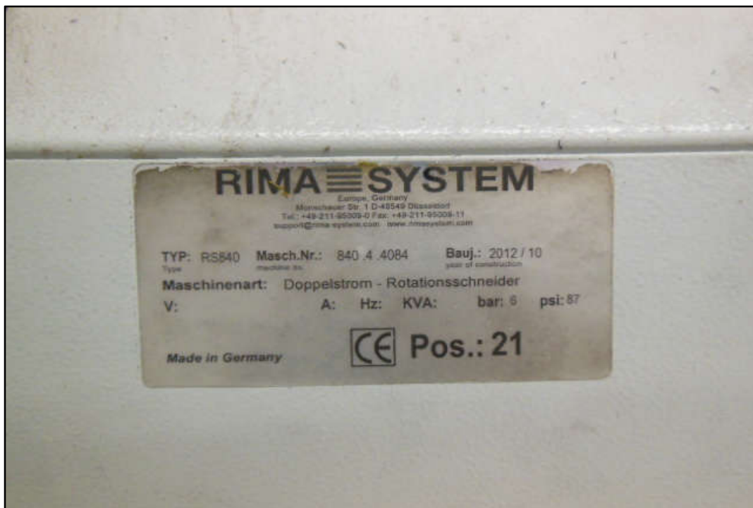
ITEM 1,028 - VISTA DA PLACA DE IDENTIFICAÇÃO DA CORTADEIRA ROTATIVA DE FLUXO DUPLO MARCA: RIMA-SYSTEM MODELO: RS-840 N° 840.4.4075
