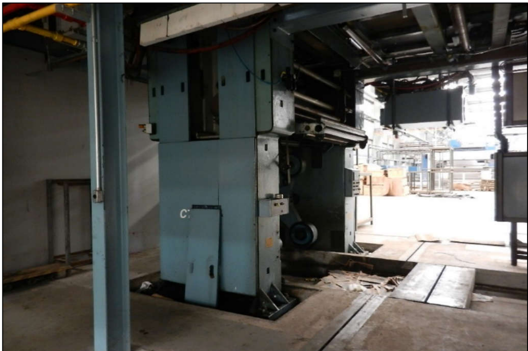
ITEM 1,094 - VISTA DA IMPRESSORA DE JORNAL MARCA: HEIDELBERG OLYMPIAN (TORRE DE IMPRESSÃO)
