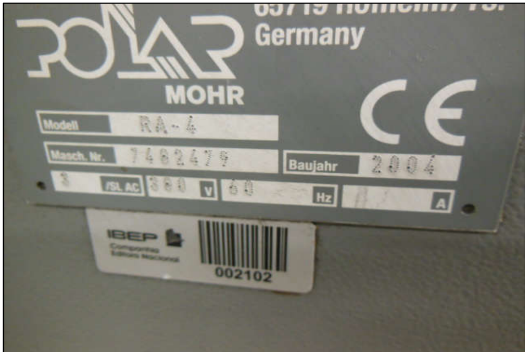
ITEM 1,012 E 1,013- VISTA DA PLACA DE IDENTIFICAÇÃO DO AUTOMATIC AIR JOGGER (REMOVEDOR DE AR) MARCA: POLAR MODELO: RA-4 SÉRIE 7482479 ANO 2004
