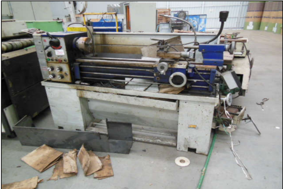
ITEM 1,063 - VISTA DO TORNO MECÂNICO MARCA: ROMI ENTRE PONTAS 2000 MM
