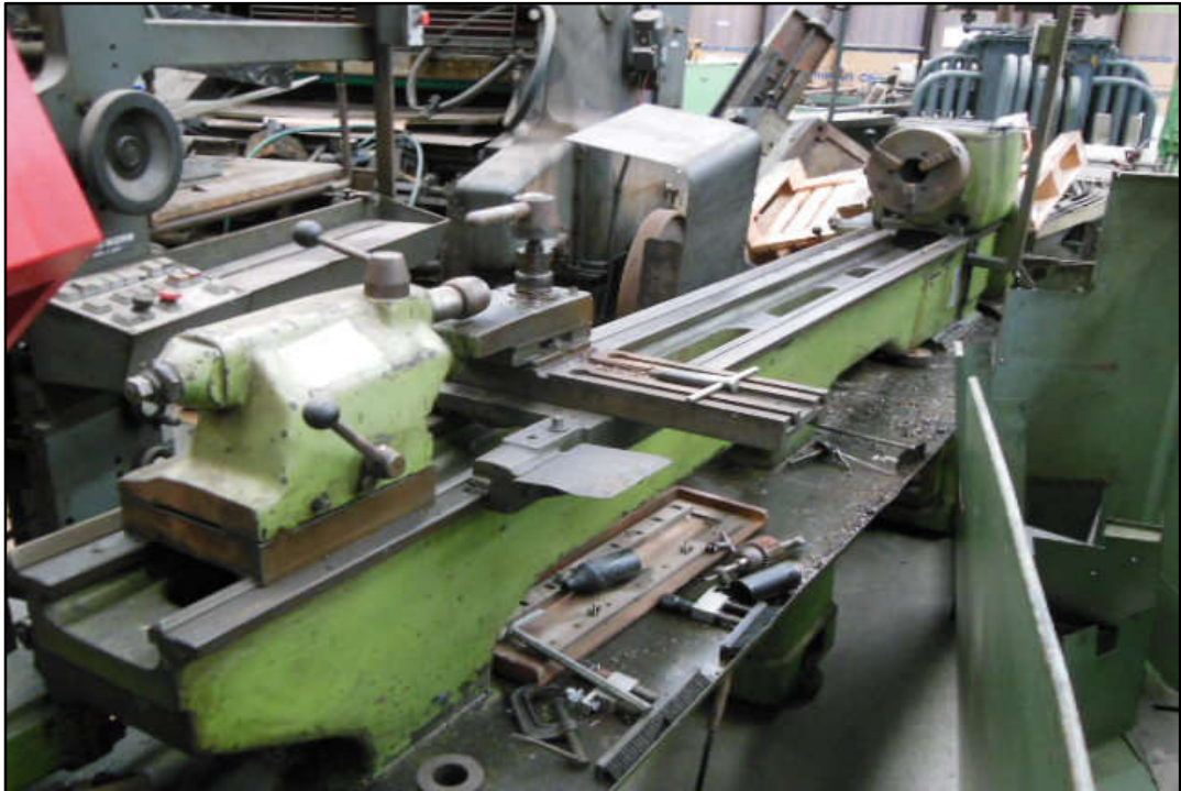
ITEM 1,053 - VISTA DO TORNO MECÂNICO MARCA: ROMI ENTRE PONTAS 2000 MM
