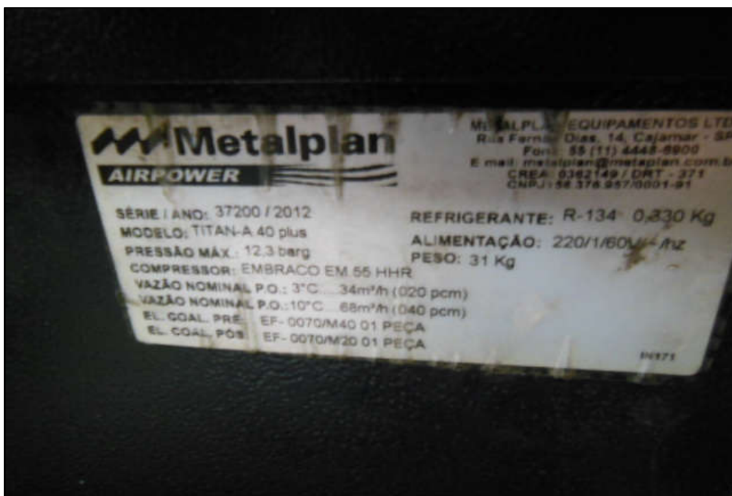
ITEM 1,068 - VISTA DA PLACA DE IDENTIFICAÇÃO DO SECADOR DE AR COMPRIMIDO MARCA: TITAN MODELO: A40 PLUS
