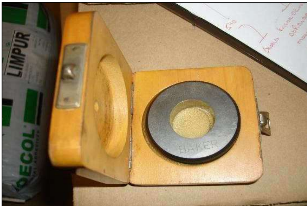
ITEM 0944 - VISTA DO ANEL PADRÃO MARCA: BAKER MOD: AIR PLUG GAUGE 25MM
