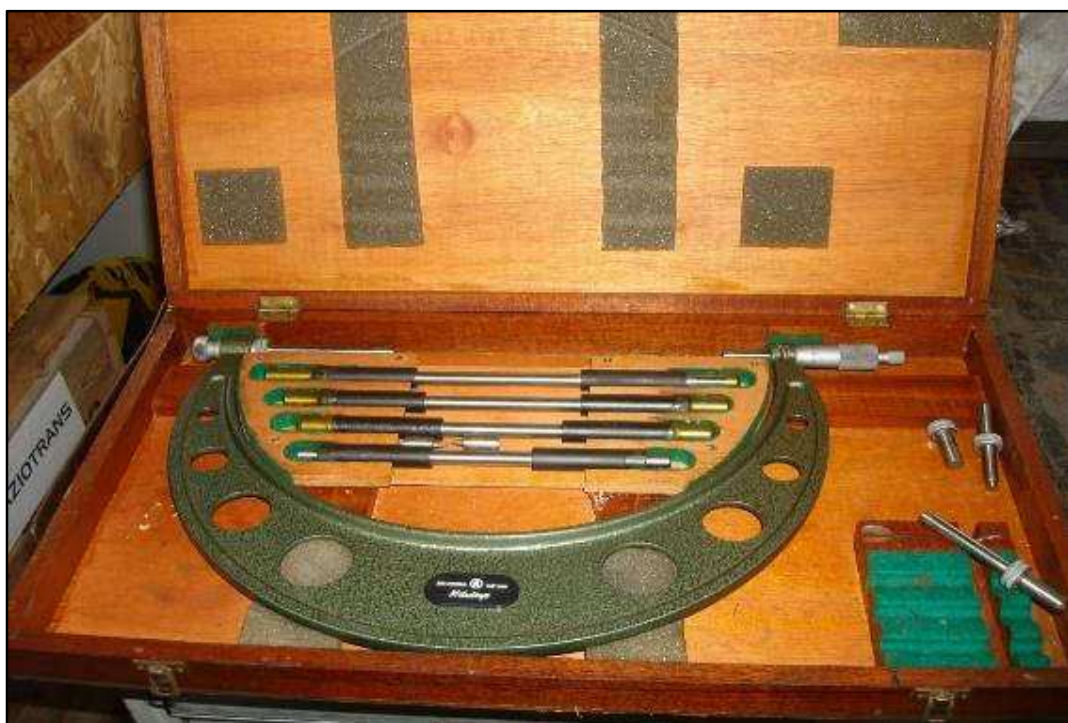
ITEM 0945 - VISTA DO MICRÔMETRO EXTERNO 200-300MM. X 0,0001 MARCA: MITUTOYO
