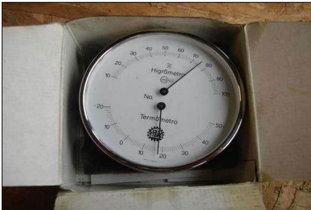
ITEM 0887 - VISTA DO TERMO HIGRÔMETRO MARCA: BARIGO
