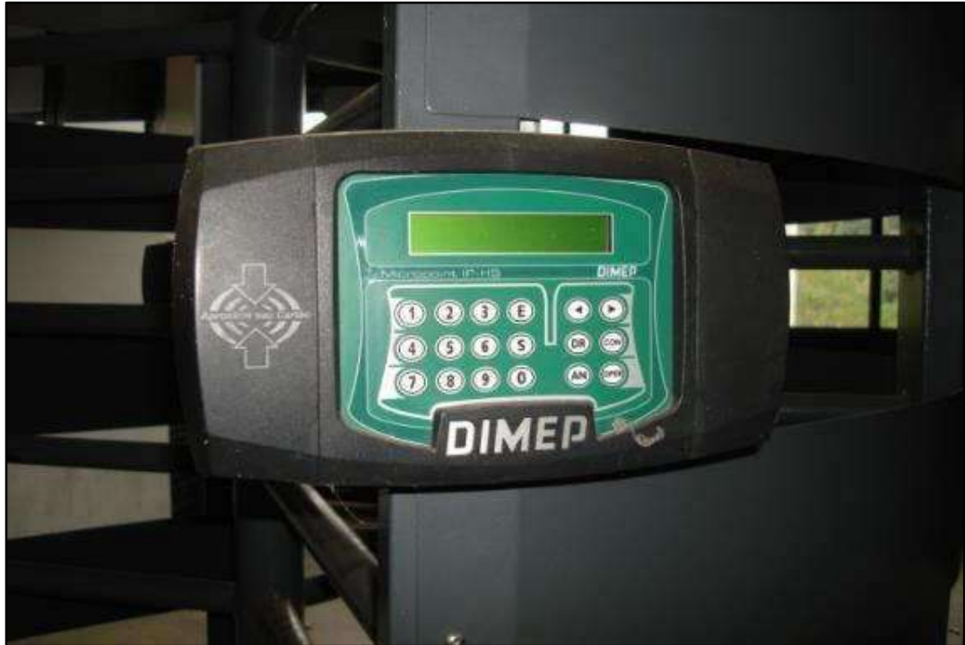
ITEM 0228 - VISTA DO CONTROLE DE ACESSO MARCA: DIMEP MOD: MICROPOINT IP HS
