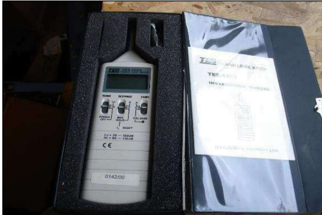
ITEM 0883 - VISTA DO DECIBELÍMETRO MARCA: TES MOD: TES 1350
