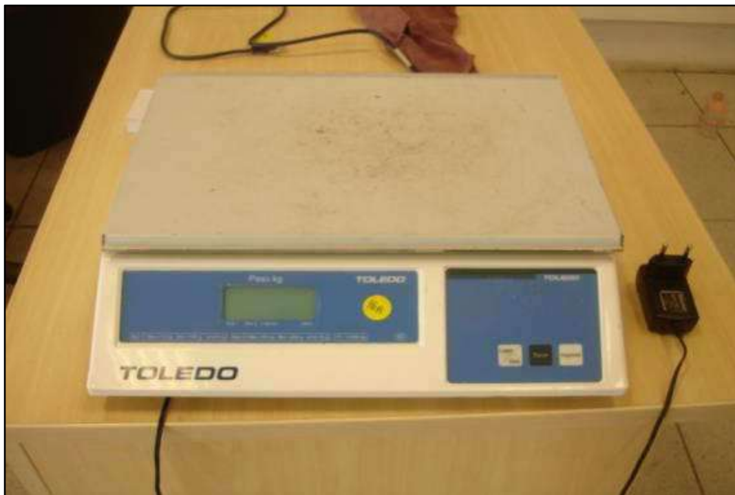
ITEM 0028 - VISTA DA BALANÇA DIGITAL CAPACIDADE 200G/30KG MARCA: TOLEDO MOD: 9094C/6
