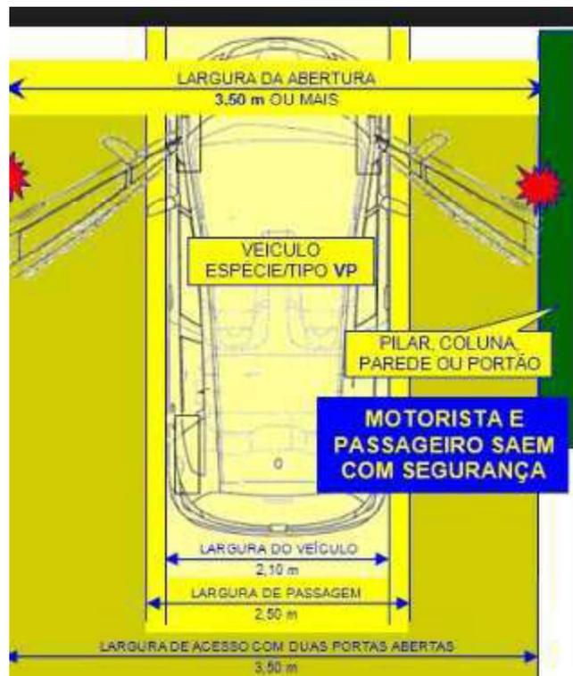
Portanto teremos uma vaga de garagem com **10,34m<sup>2</sup>** de área sendo 2,10m x 4,7m de área de estacionamento (9,87m<sup>2</sup>) mais 1,4m x 4,7m (6,58m<sup>2</sup>) de área de abertura de portas, totalizando uma área de **16,45m<sup>2</sup>** ou **15,685m<sup>2</sup>** de escritura
