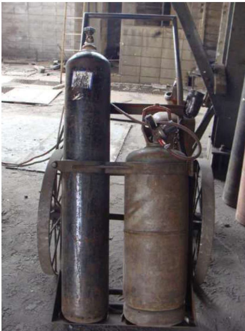
Cilindros de solda de oxigênio e acetileno
