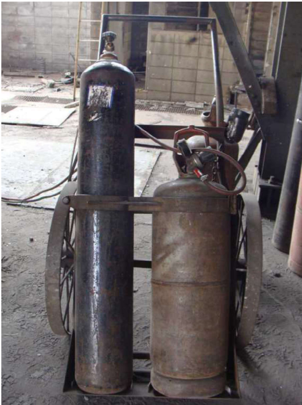
Cilindro de acetileno para solda Cilindro de oxigênio para solda
