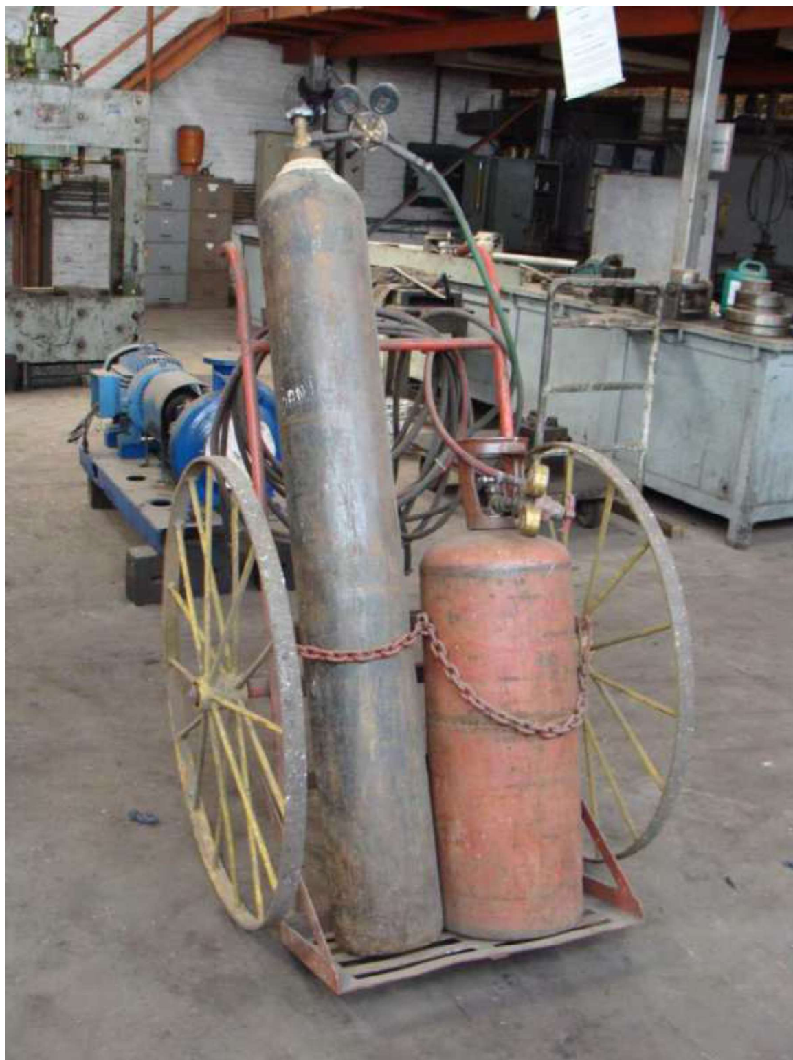
Cilindros de solda de oxigênio e acetileno
