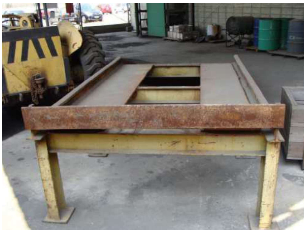
Plataforma (rampa) de aço
