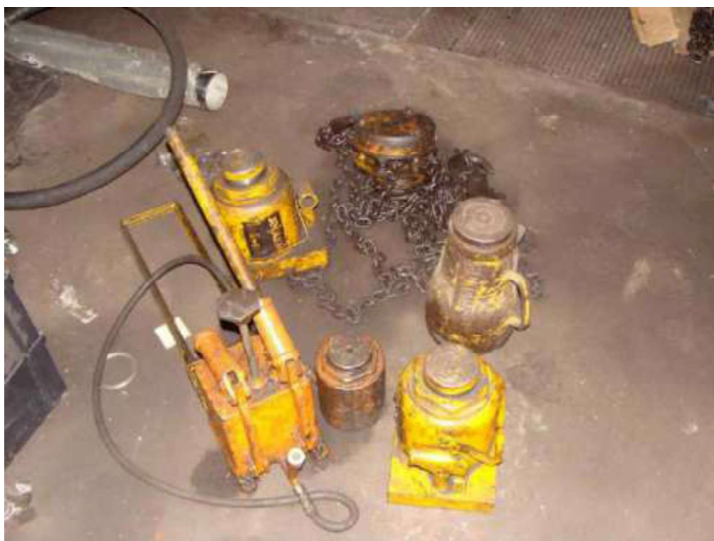
Macacos hidráulicos - s/ marca aparente
