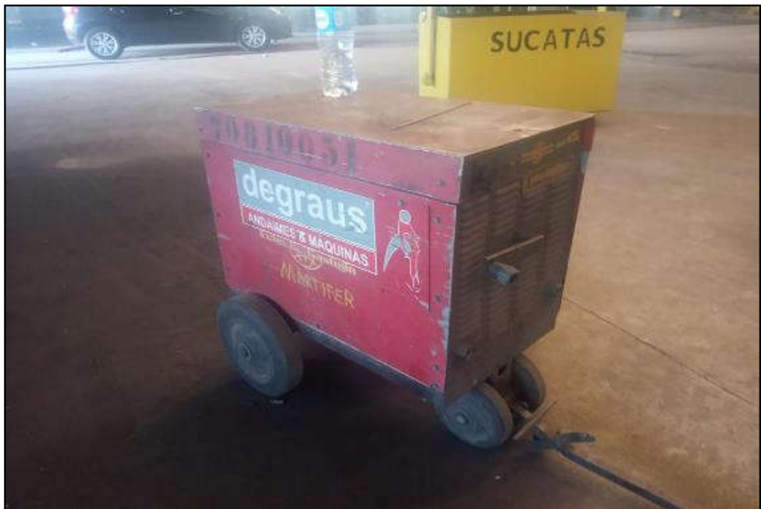
ITEM 1,069 - VISTA DA MÁQUINA DE SOLDA CASTOLIN EUTECTIC GSX 4500
