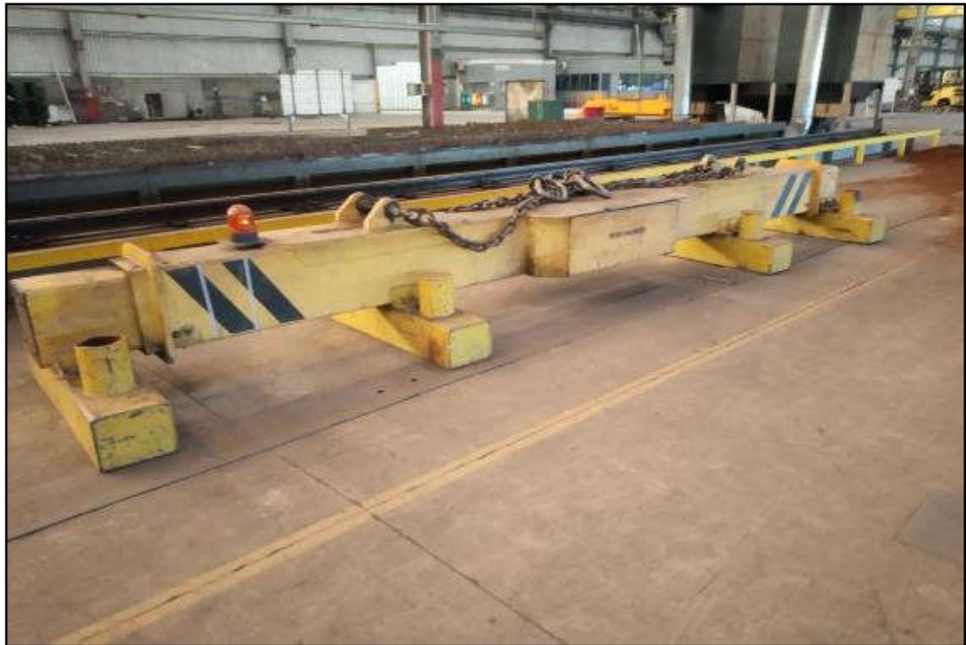
ITEM 1,068 - VISTA DO ELEVADOR MAGNÉTICO TECNOMAGNETE
