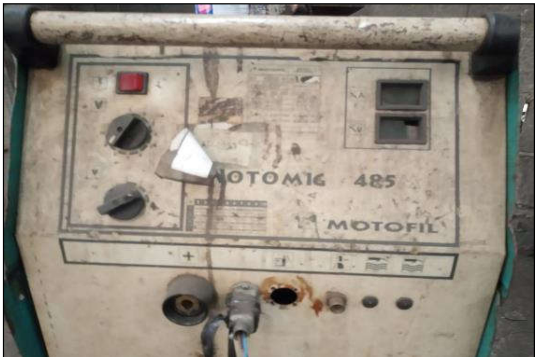
ITEM 1,033 - VISTA DA PLACA DE IDENTIFICAÇÃO DA SOLDA MIG MOTOFIL MOTOMIG 485 M
