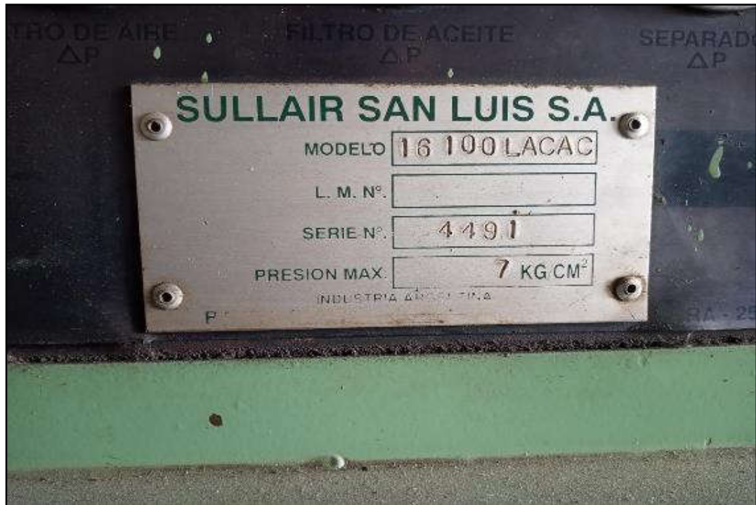
ITEM 1,072 - VISTA DA PLACA DE IDENTIFICAÇÃO DO COMPRESSOR SULLAIR SAN LUIS S.A. 16100 LACAC
