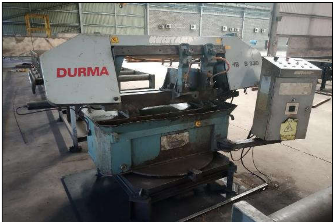
ITEM 1,004 - VISTA DA SERRA DE FITA COM ESTEIRA E CILINDROS DURMA HB S330
