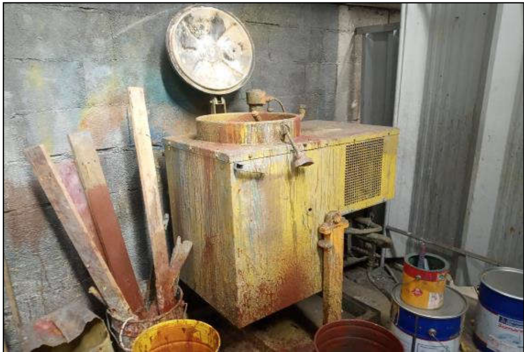
ITEM 5,002 - VISTA DO MISTURADOR DE TINTA
