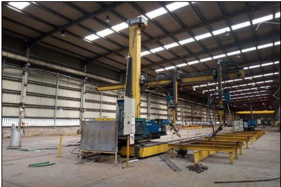
ITEM 1,010 - VISTA DO MANIPULADOR DE SOLDA ARCO SUBMERSO COM PLASMA MOTOFIL ROBOTICS/MILLER
