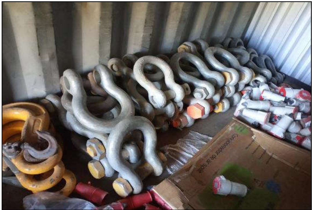
ITEM 4,035 - VISTA DA MANILHA CURVA 1.3/4 Q-FIX WLL 25T
