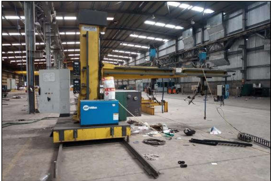
ITEM 1,020 - VISTA DO MANIPULADOR DE SOLDA ARCO SUBMERSO MOTOFIL ROBOTICS / MILLER
