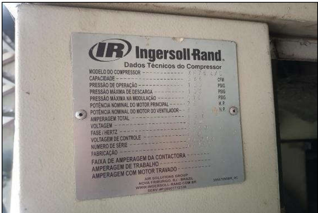
ITEM 1,073 - VISTA DA PLACA DE IDENTIFICAÇÃO DO COMPRESSOR INGERSOLL RAND XF75 AC
