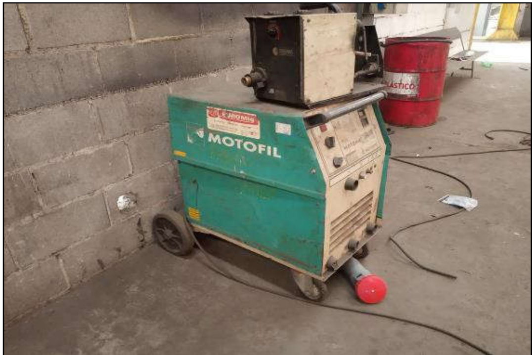
ITEM 1,030 - VISTA DA SOLDA MIG MOTOFIL MOTOMIG 485
