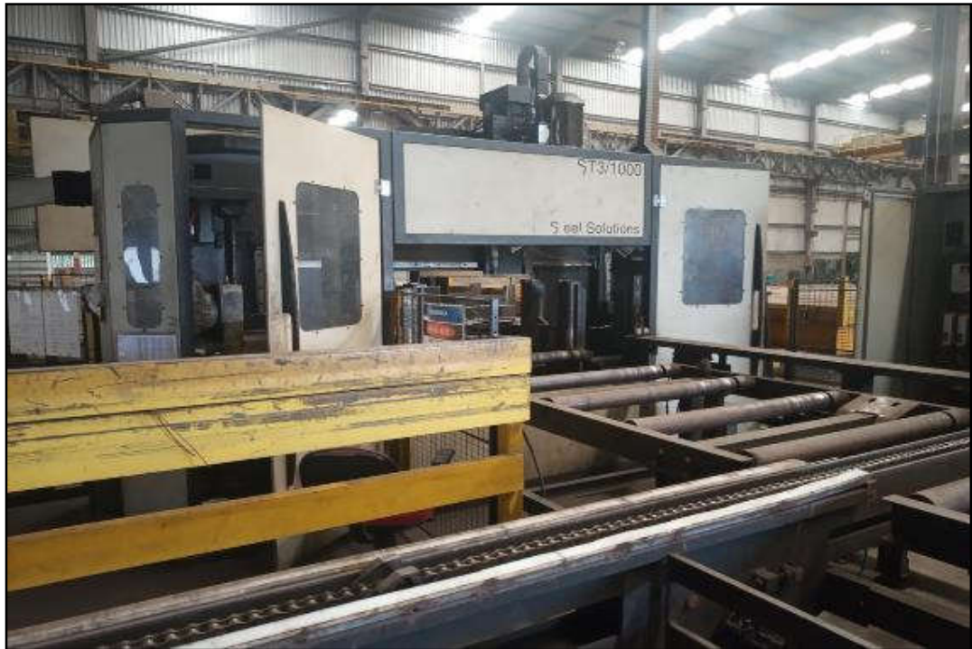
ITEM 1,002 - VISTA DA SERRA CORTE E PERFURAÇÃO STEEL SOLUTIONS ST3/1000
