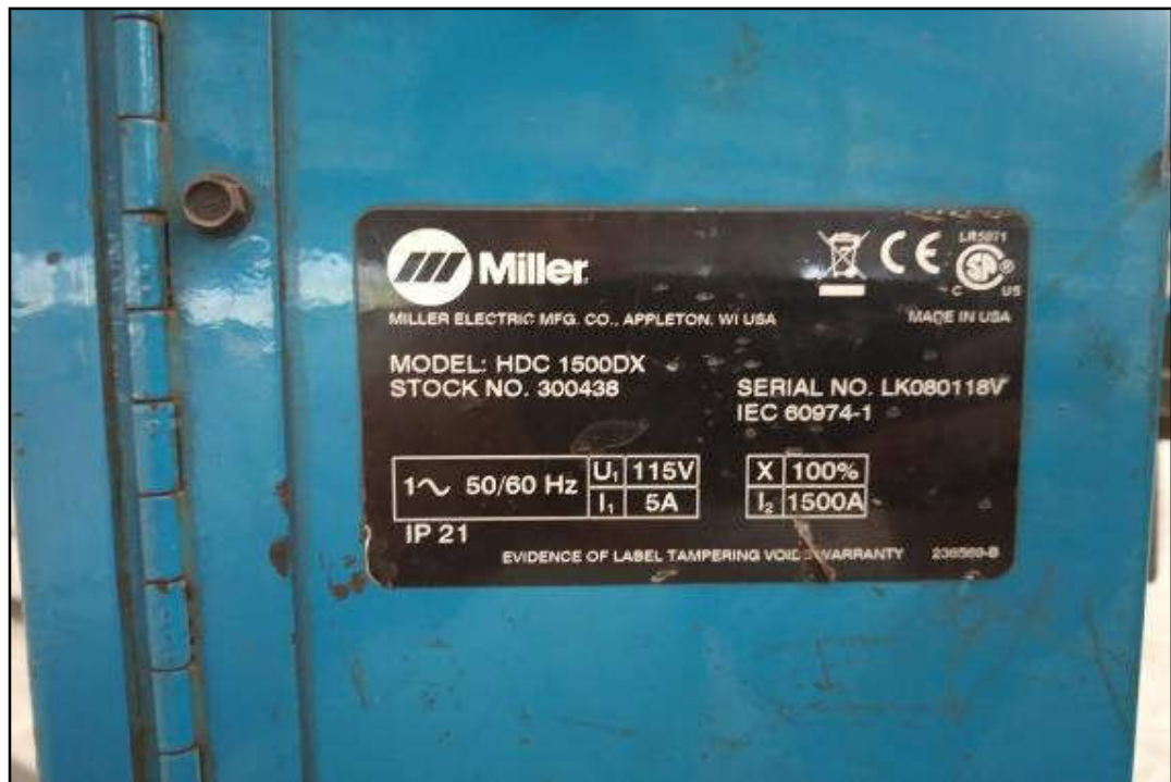
ITEM 1,009 - VISTA DA PLACA DE IDENTIFICAÇÃO DO MANIPULADOR DE SOLDA ARCO SUBMERSO COM PLASMA MILLER/MOTOFIL
