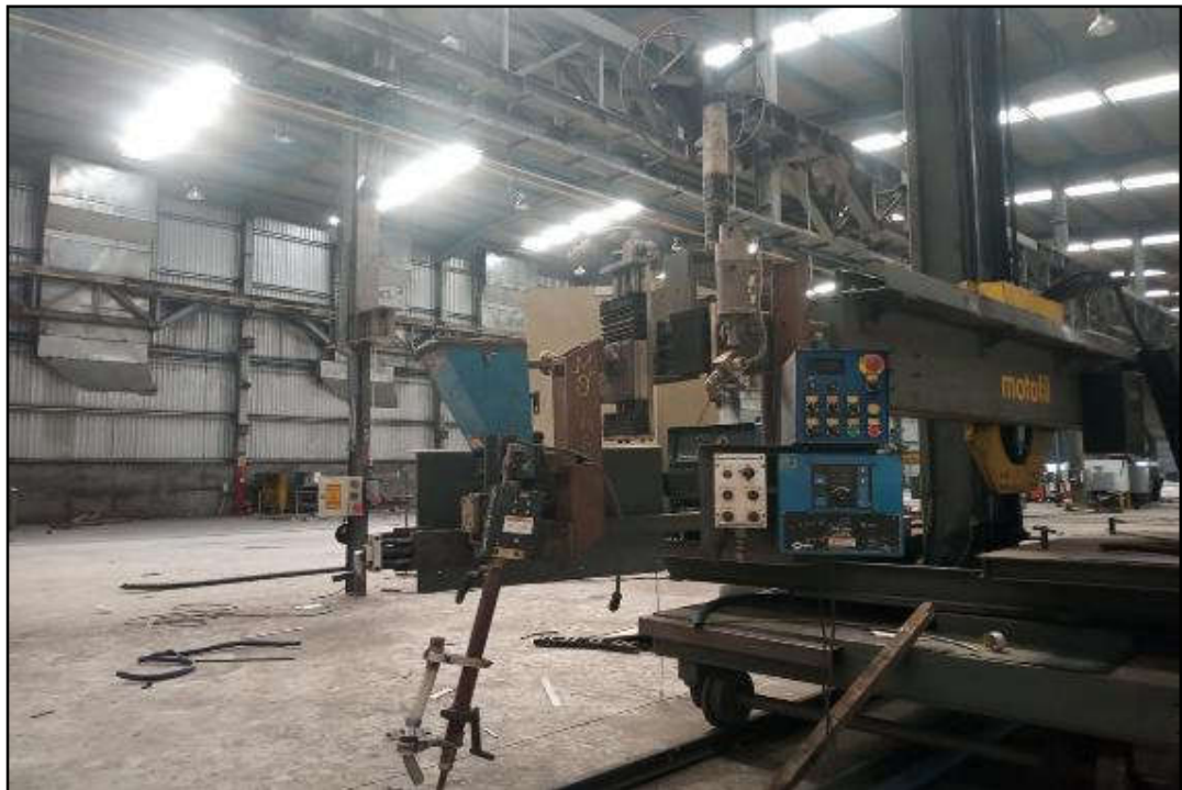
ITEM 1,009 - VISTA DO MANIPULADOR DE SOLDA ARCO SUBMERSO COM PLASMA MILLER/MOTOFIL
