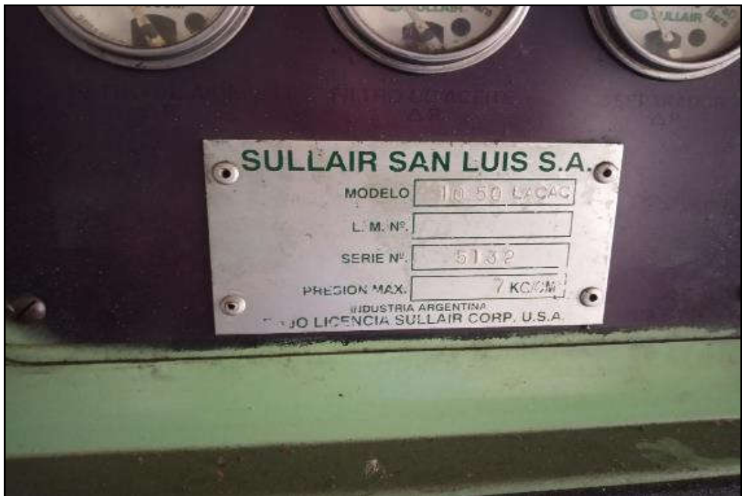
ITEM 1,071 - VISTA DA PLACA DE IDENTIFICAÇÃO DO COMPRESSOR SULLAIR SAN LUIS S.A. 1050 LACAC
