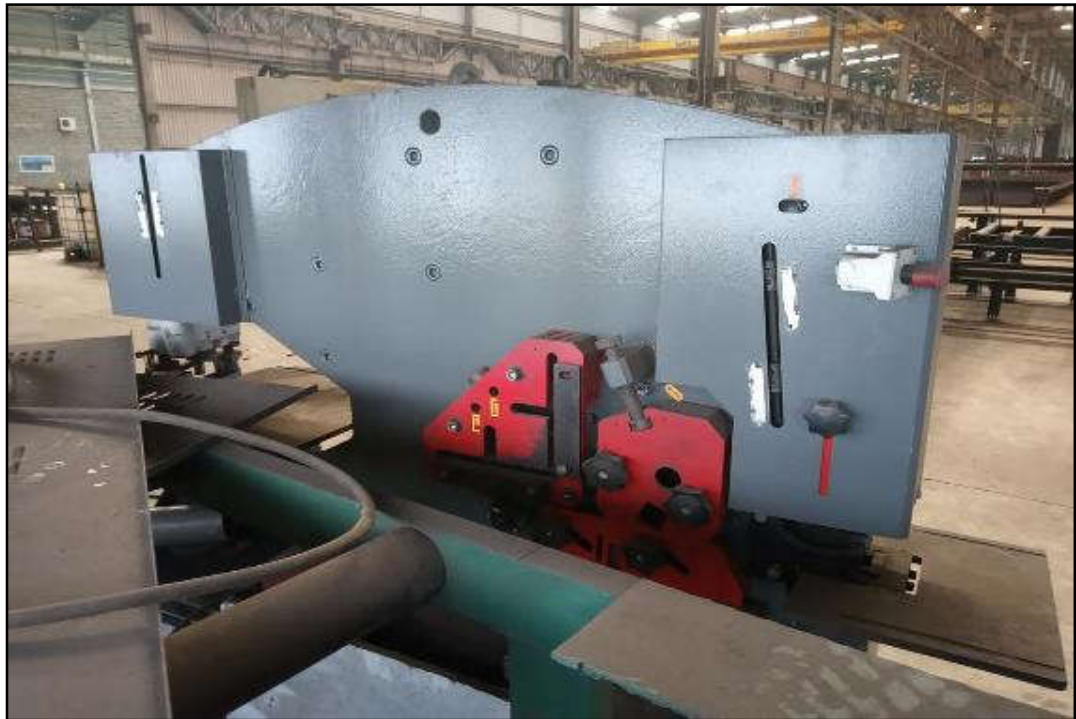
ITEM 1,003 - VISTA DA METALEIRA CORTE E FURO HIDRAULICO
