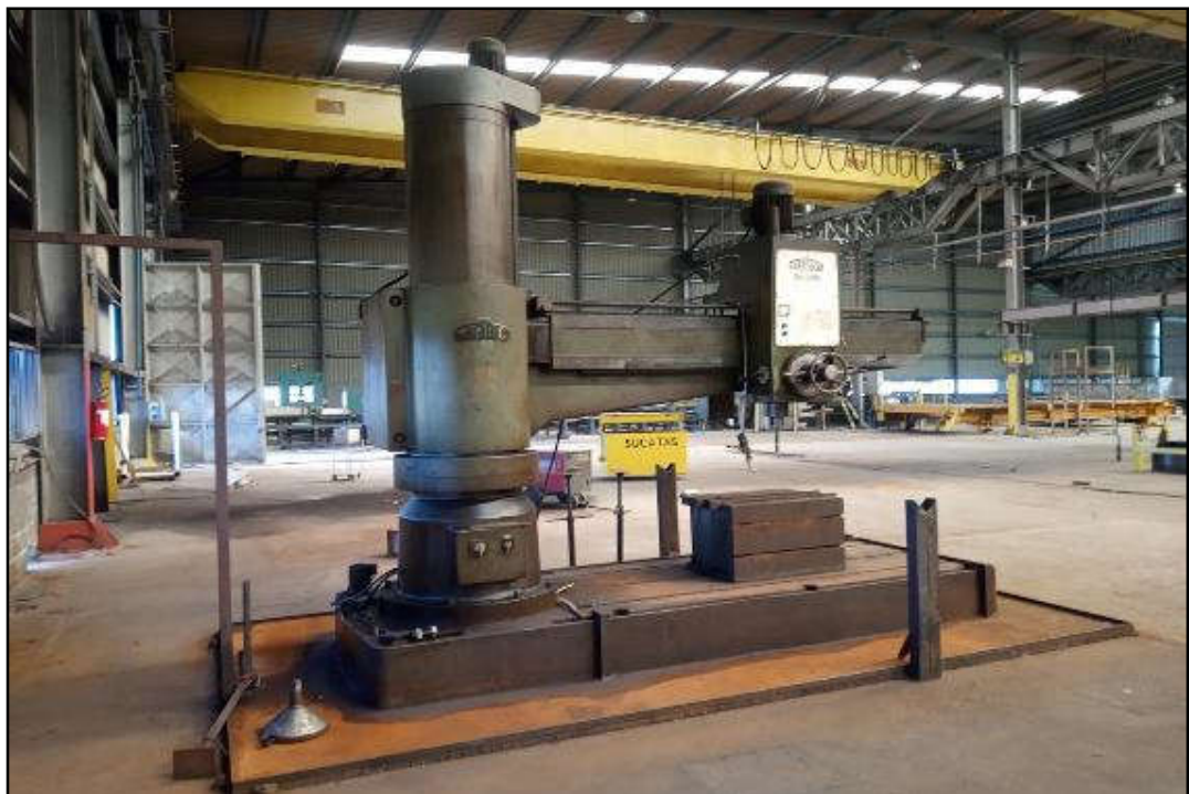
ITEM 1,006 - VISTA DA FURADEIRA RADIAL SORALUCE TR3-2500
