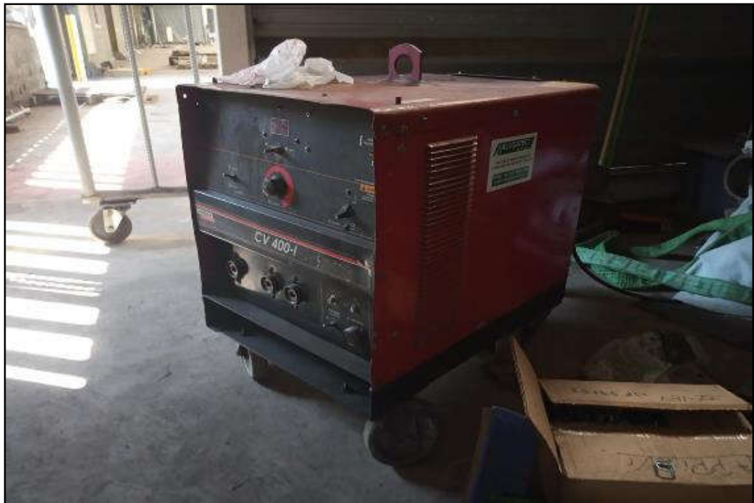
ITEM 1,005 - VISTA DA MÁQUINA DE SOLDA MIG LINCOLN ELECTRIC CV 400-1
