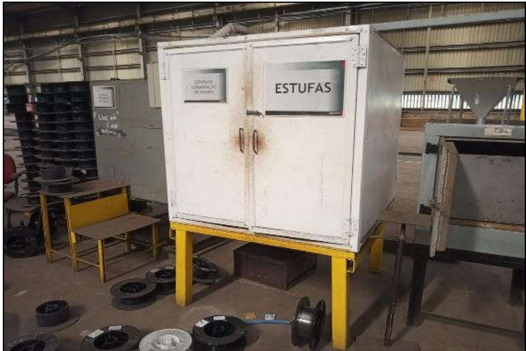
ITEM 1,022 - VISTA DA ESTUFA DE CONSERVAÇÃO DE ARAMES
