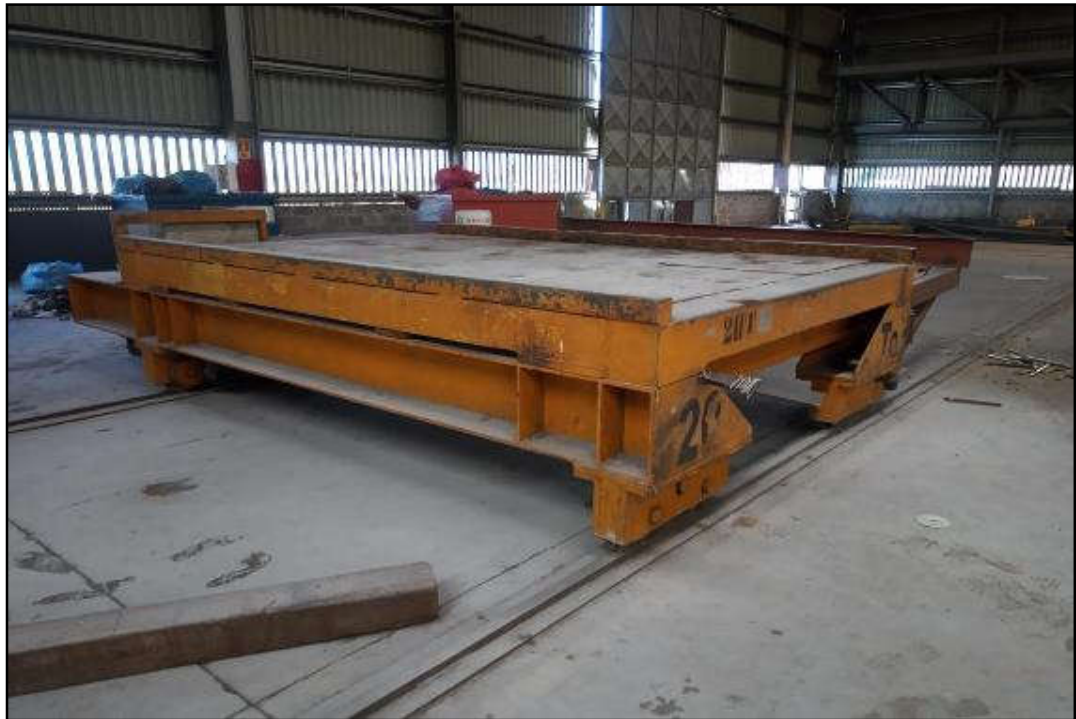
ITEM 1,011 - VISTA DO CARRO DE TRANSPORTE MOTORIZADO 20T
