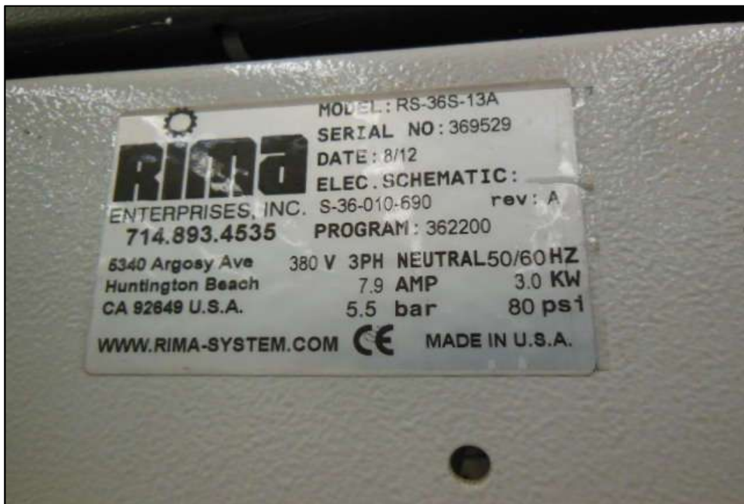
ITEM 1,028 - VISTA DA PLACA DE IDENTIFICAÇÃO DO STACKER DE ALTA VELOCIDADE MARCA: RIMA-SYSTEM MODELO: RS-36S 13A N° 369529
