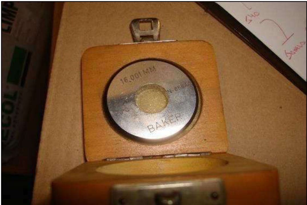
ITEM 0941 - VISTA DO ANEL PADRÃO MARCA: BAKER MOD: AIR PLUG GAUGE 16MM
