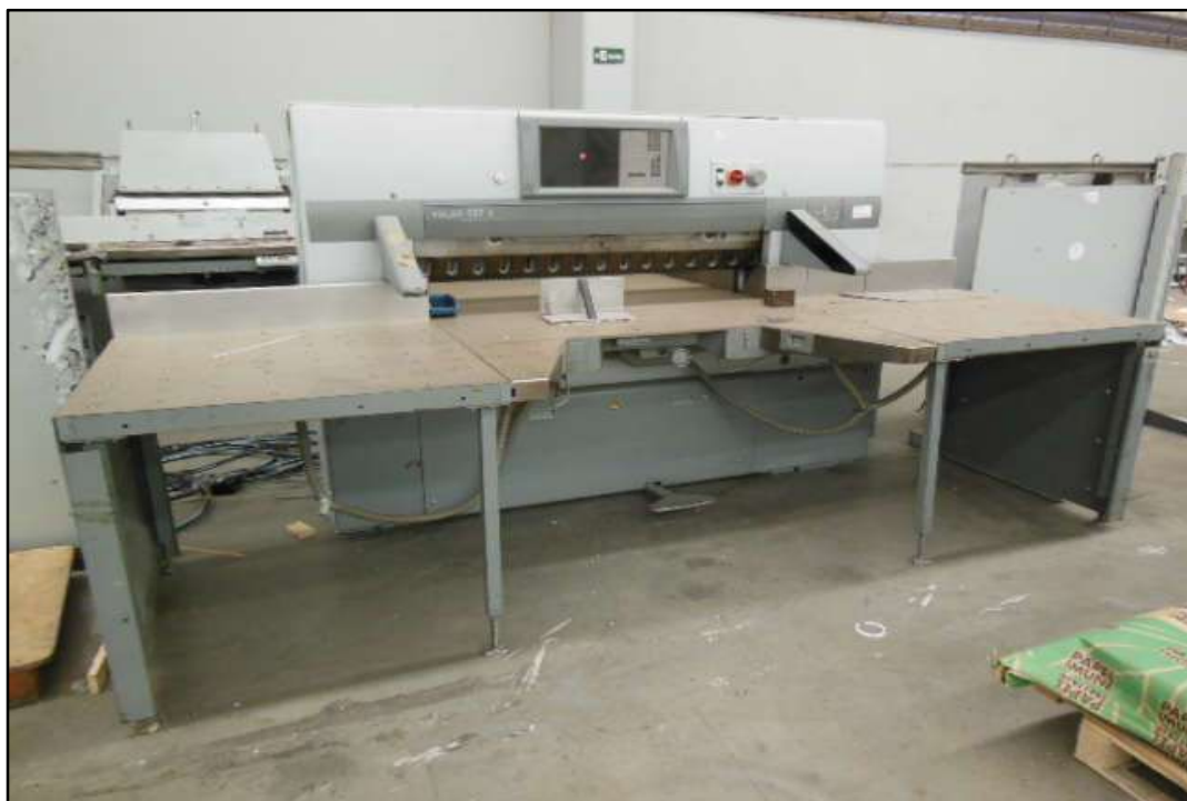
ITEM 1,009 - VISTA DA GUILHOTINA MARCA: POLAR MODELO: 137X N°: 7441313 COM 2 MESAS LATERAIS
