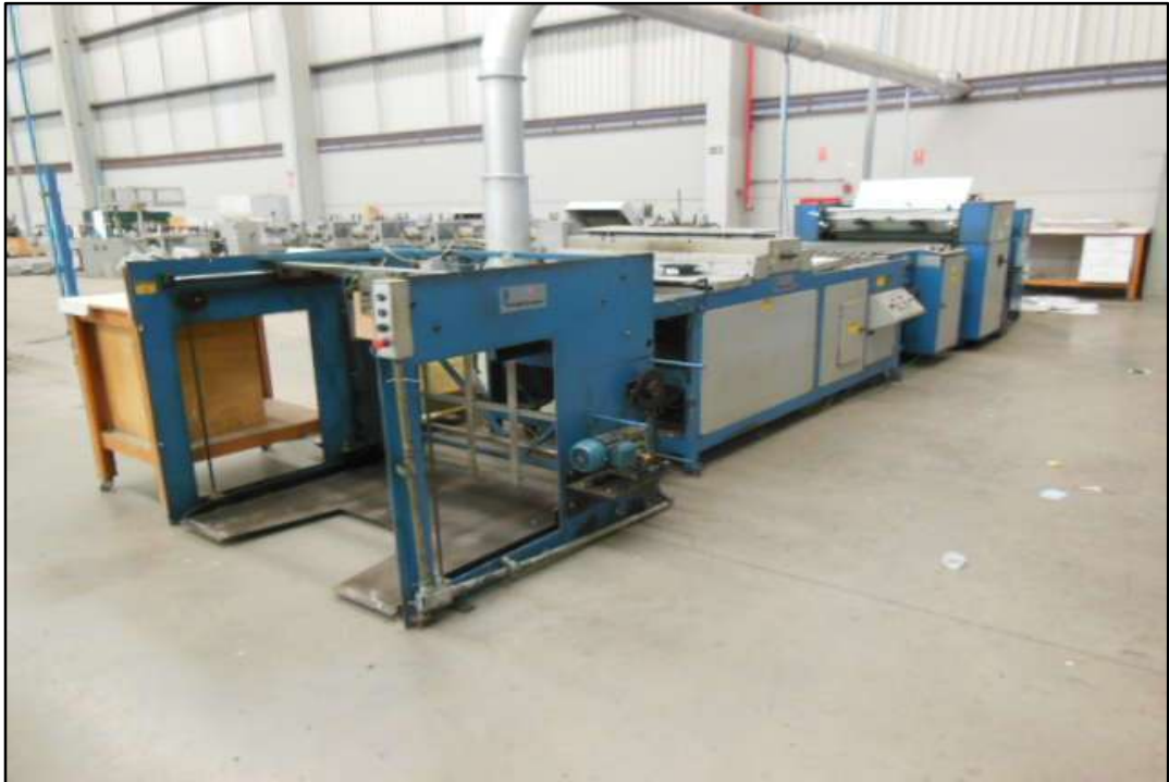
ITEM 1,001 - VISTA DA ENVERNIZADORA MARCA: RADIAL TECHNOGRAF MODELO: VERNIPAPER VPRTB 1020 SÉRIE: 2010 OF: 849 COM ALIMENTADOR DE PAPEL, ENVERNIZADORA, FORNO PARA SECAGEM E MESA DE SAÍDA
