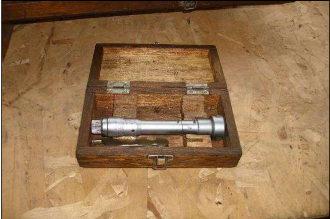
ITEM 0879 - VISTA DO MICROMETRO INTERNO 0,005 35MM
