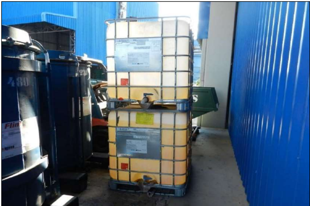
ITEM 1,151 - VISTA DOS 2 RECIPIENTES PLASTICO COM ESTRUTURA METALICA COM VALVULA CAP: 1.000 L
