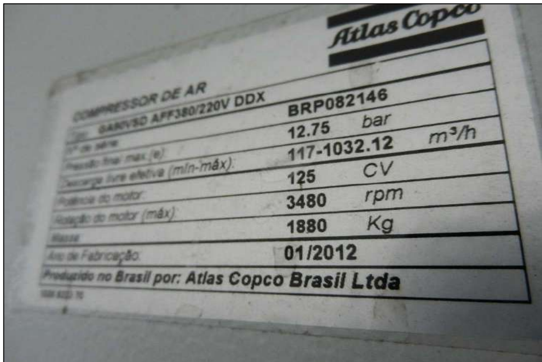
ITEM 1,111 - VISTA DO COMPRESSOR DE AR MARCA: ATLAS COPCO MODELO: GA90VSDFF 380/220 V SERIE: BRP082146 (PLACA DE IDENTIFICAÇÃO)
