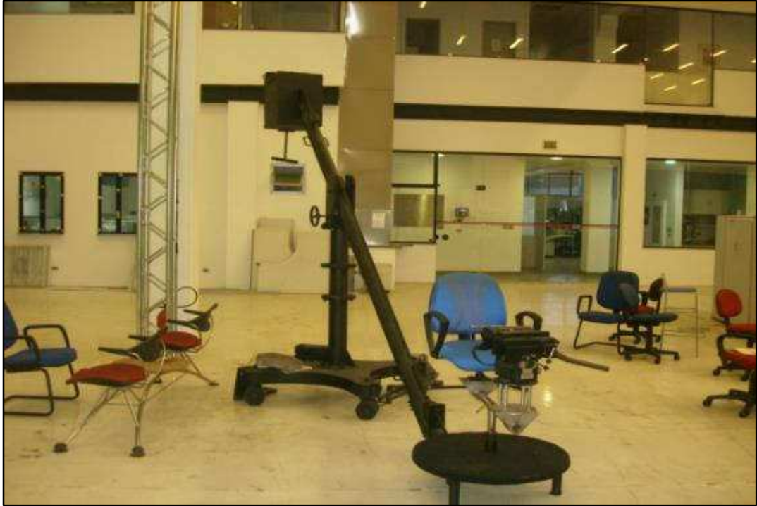
ITEM 1,004 - VISTA DO SUPORTE MÓVEL PARA OPERAÇÃO DE CÂMERA (GRUA)
