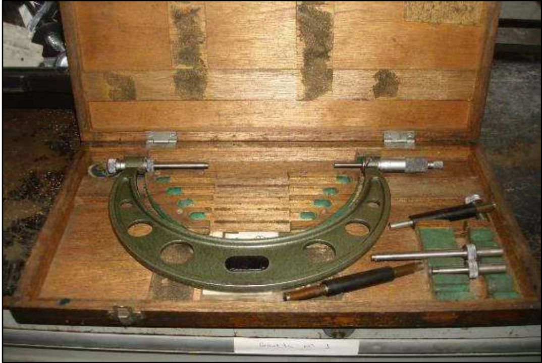
ITEM 0948 - VISTA DO MICRÔMETRO EXTERNO 100-200MM. X 0,0001 MARCA: MITUTOYO
