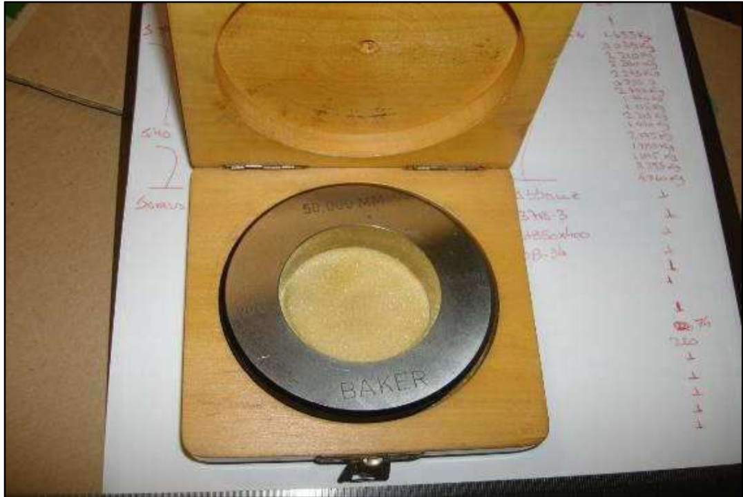
ITEM 0942 - VISTA DO ANEL PADRÃO MARCA: BAKER MOD: AIR PLUG GAUGE 50MM
