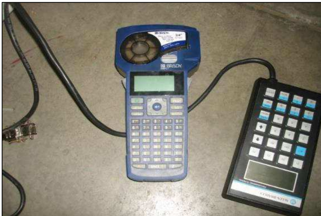
ITEM 2974 E ITEM 2975 - VISTA DA ETIQUETADORA MARCA: BRADY MOD: BYP21 E DO PROGRAMADOR DE TERMINAL MARCA: ALLAN BRADLEY MOD: 1300 DIT
