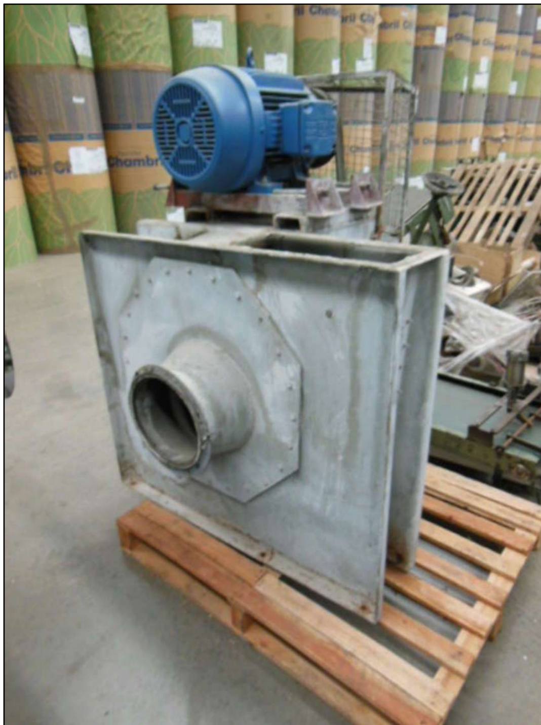
ITEM 1,075 - VISTA DO EXAUSTOR MARCA: ENVITECH COM MOTOR ELÉTRICO DE 30 CV
