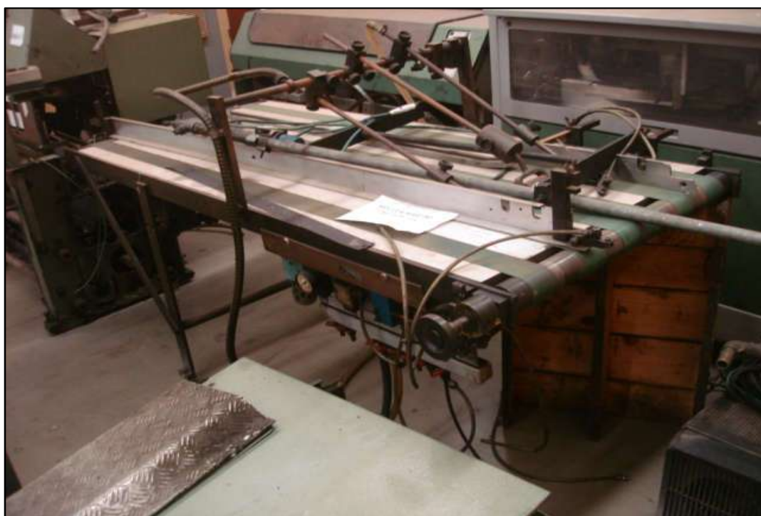
ITEM 1,042 - VISTA DA ESTEIRA DO ALIMENTADOR DE CAPA COM BOMBA
