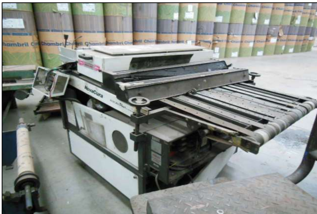
ITEM 1,065 - VISTA DO FORNO CURADORA UV MARCA: NOVACURA MODELO: ADDCURA PLUS GC-1020-2A/300
