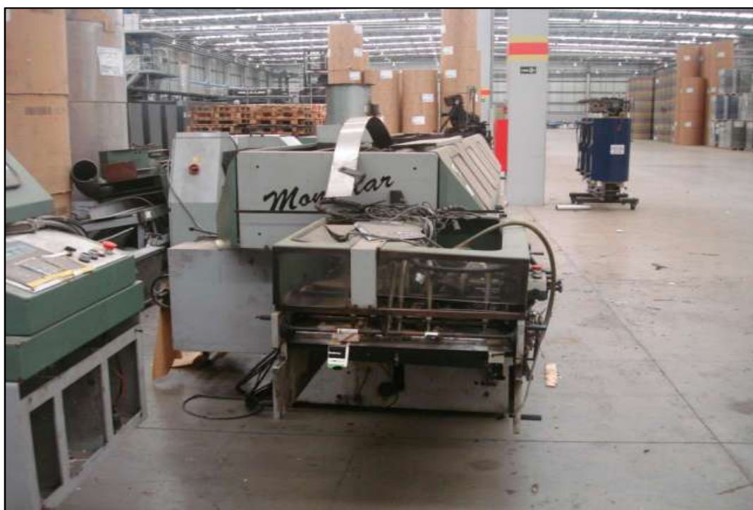
ITEM 1,042 - VISTA DA COLADEIRA (3016) COM 18 GARRAS
