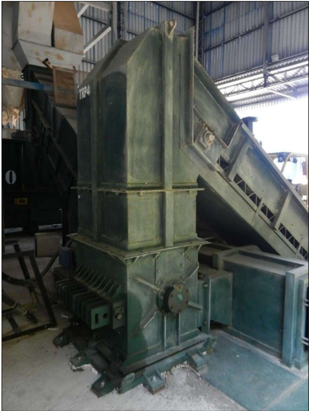
ITEM 1,146 - VISTA DA LINHA DE PENSAGEM DE APARAS DE PAPEL COMPREENDENDO OS ITENS (TRITURADOR (TRP-40) COM MOTOR ELETRICO DE 40 CV
