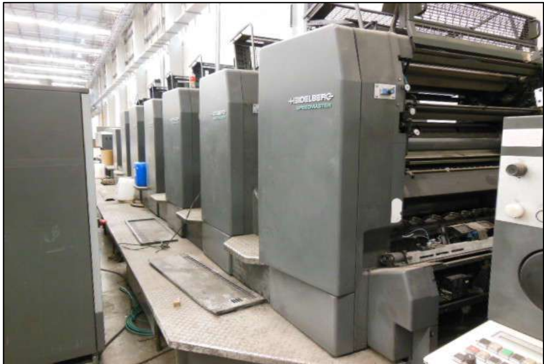
ITEM 1,023 - VISTA DA IMPRESSORA OFF-SET MARCA: HEIDELBERG MODELO: SPEEDMASTER S DE 6 CORES, COM ALIMENTADOR, MESA DE SAÍDA E PAINEL DE COMANDO
