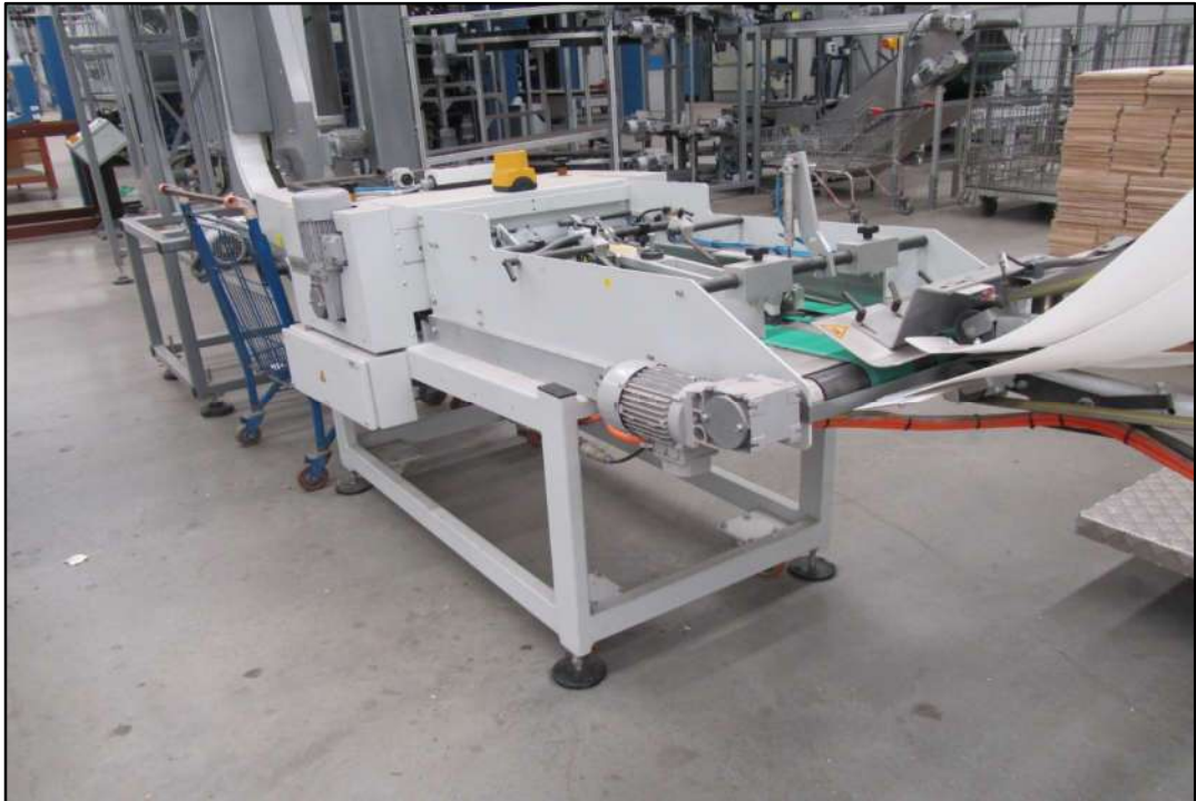
ITEM 1,028 - VISTA DO EQUIPAMENTO ENTRADA DA PRENSA/LOG STACKER MARCA: RIMA-SYSTEM MODELO: RS-257 N°257-502-0491
