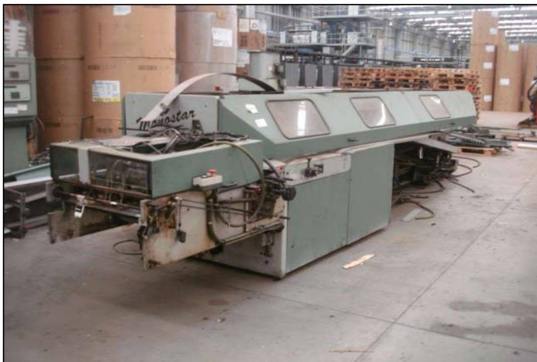
ITEM 1,042 - VISTA DA COLADEIRA (3016) COM 18 GARRAS
