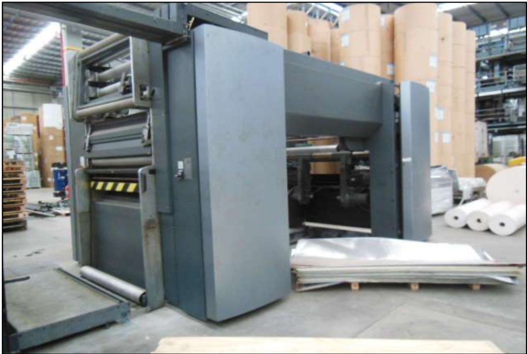
ITEM 1,032 - VISTA DOS ALIMENTADORES DE BOBINA DUPLO MARCA: GOSS MODELO: CS-13-146R N° CS-01189
