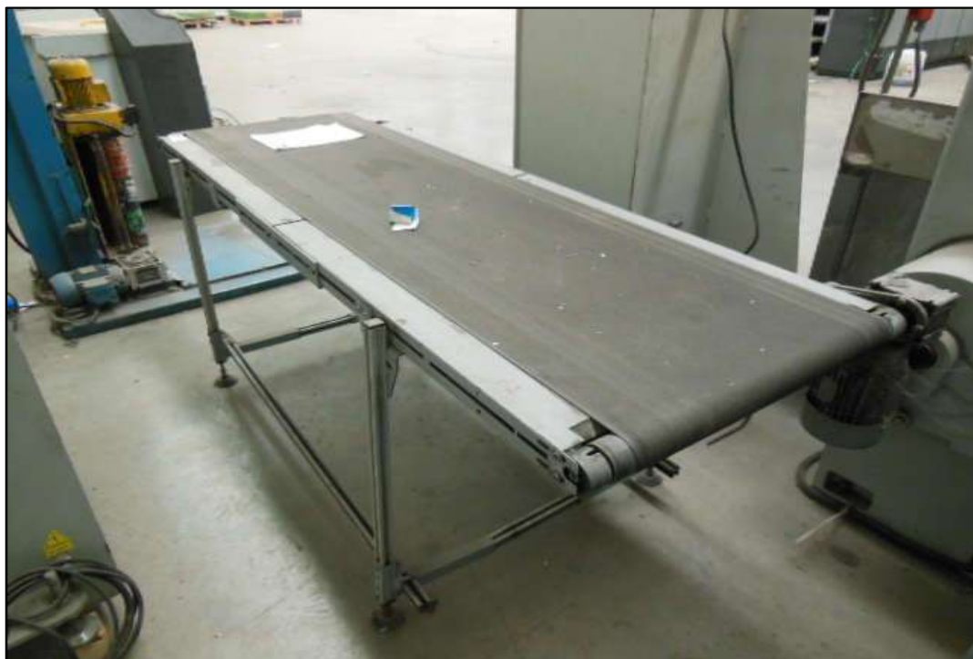
ITEM 1,019 - VISTA DA ESTEIRA DE ALIMENTAÇÃO
