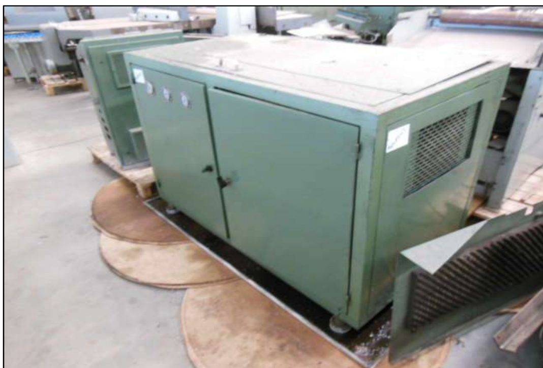
ITEM 1,082 - VISTA DA UNIDADE HIDRÁULICA MARCA: KOLBUS
