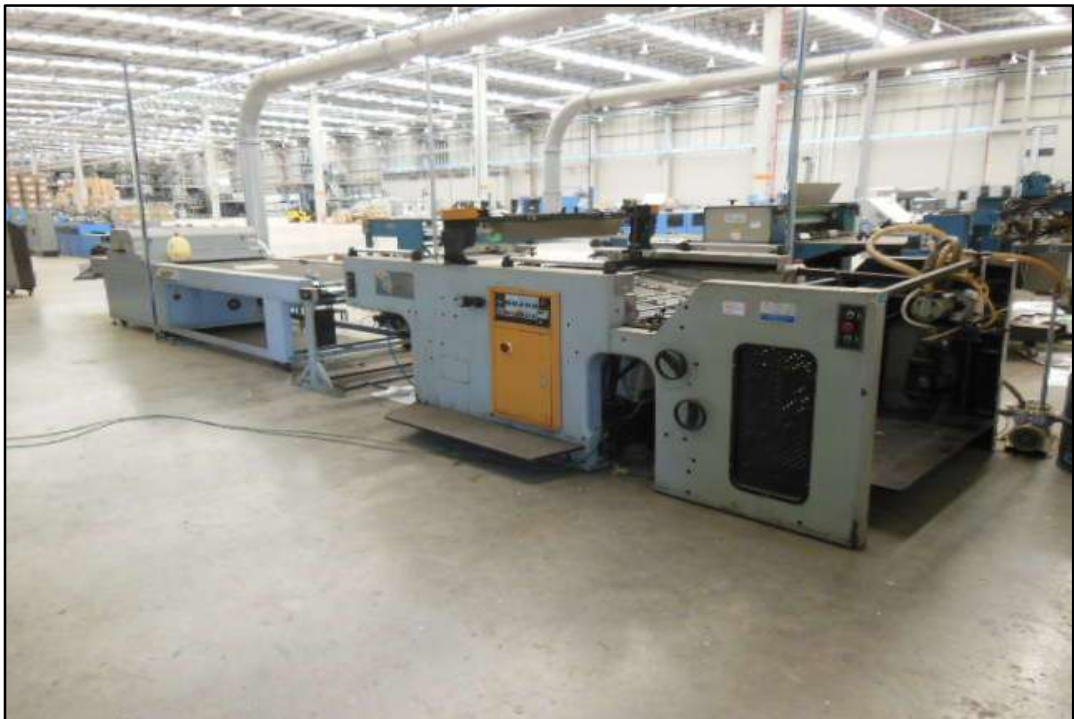
ITEM 1,002 - VISTA DA LAMINADORA/ENVERNIZADORA MARCA: FURNAX MODELO: JSP-1020 SÉRIE:272010 COM MESA ALIMENTADORA, LAMINADOR AUTO SCREEN, FORNO UV LIGHT MODELO: GT-1302COT Nº 0906008
