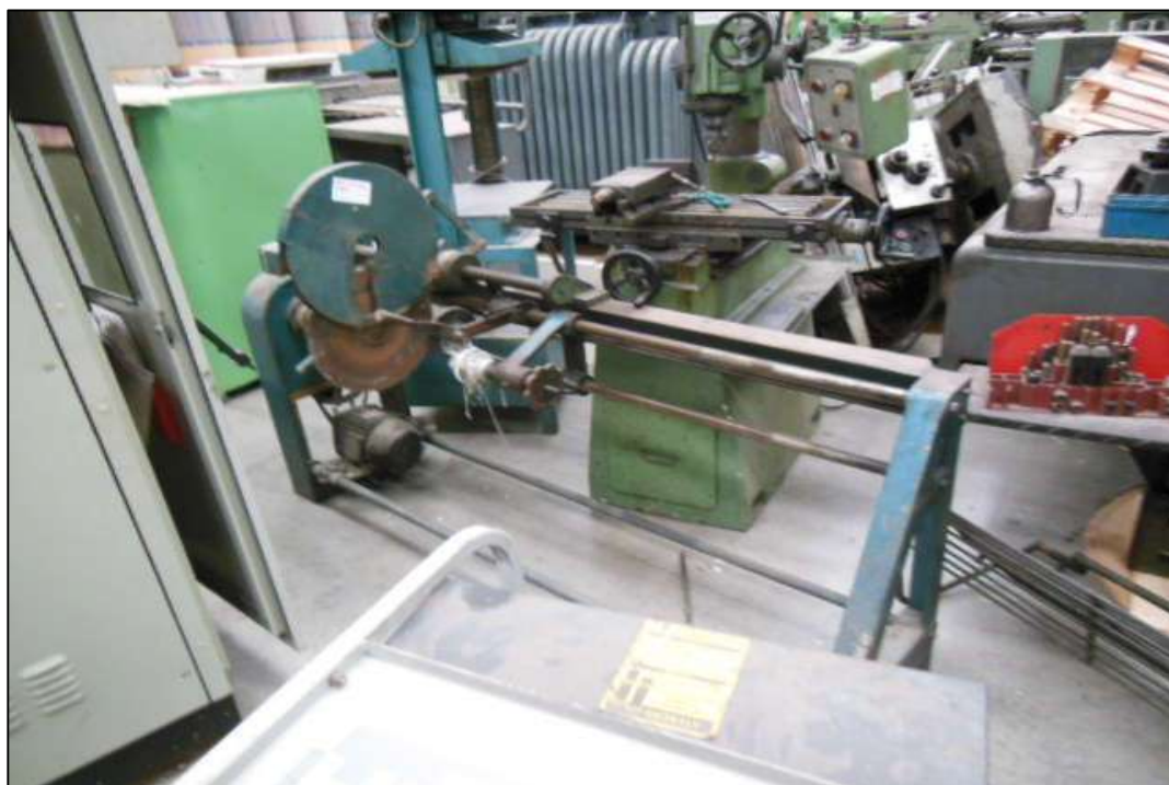
ITEM 1,069 - VISTA DA SERRA PARA CORTE DE TUBOS COM MOTOR ELETRICO
