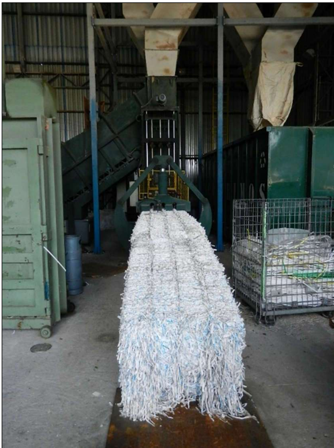
ITEM 1,146 - VISTA DA LINHA DE Prensagem de APARAS DE PAPEL COMPREENDENDO OS ITENS (ESTEIRA DE SAÍDA DE APARA)
