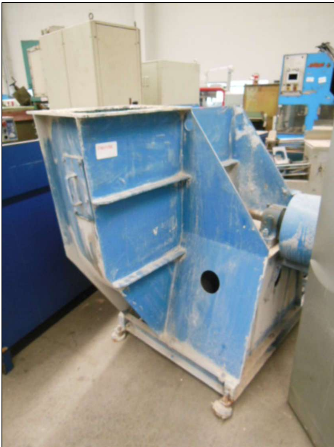
ITEM 1,076 - VISTA DO EXAUSTOR MARCA: ENVITECH COM MOTOR ELÉTRICO DE 25 CV
