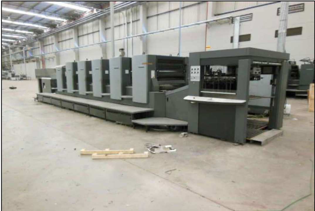
ITEM 1,021 - VISTA DA IMPRESSORA OFF-SET MARCA: HEIDELBERG MODELO: SPEEDMASTER CD 102 5+L DE 5 CORES N° 547 840 COM ALIMENTADOR, MESA DE SAÍDA E PAINEL DE COMANDO
