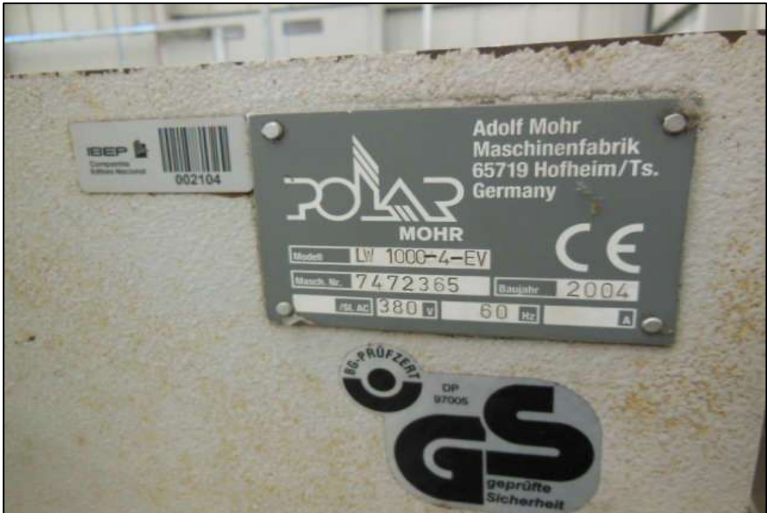
ITEM 1,010 - VISTA DA PLACA DE IDENTIFICAÇÃO DA PLATAFORMA ELEVADORA DE PAPEL MARCA: POLAR MODELO: LW 1004 EV SÉRIE:7472365
