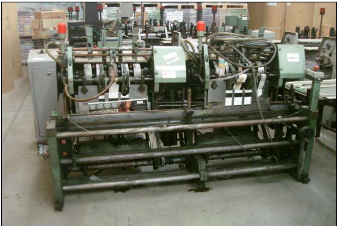
ITEM 1,042 - VISTA DO COLOCADOR DE GUARDA
