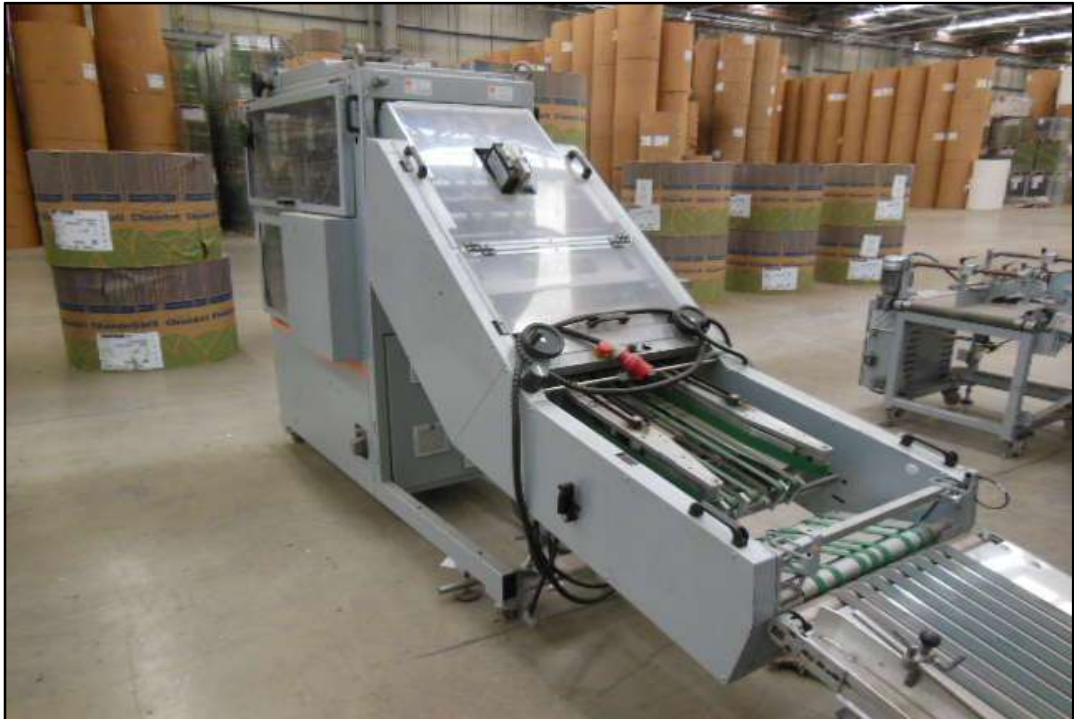
ITEM 1,033 - VISTA DA STACKER MARCA: GAMMERLER MODELO: KL 550 N° 5064 SÉRIE: 10596 COM ESTEIRAS INCLINADAS, (STEIGBAND)
