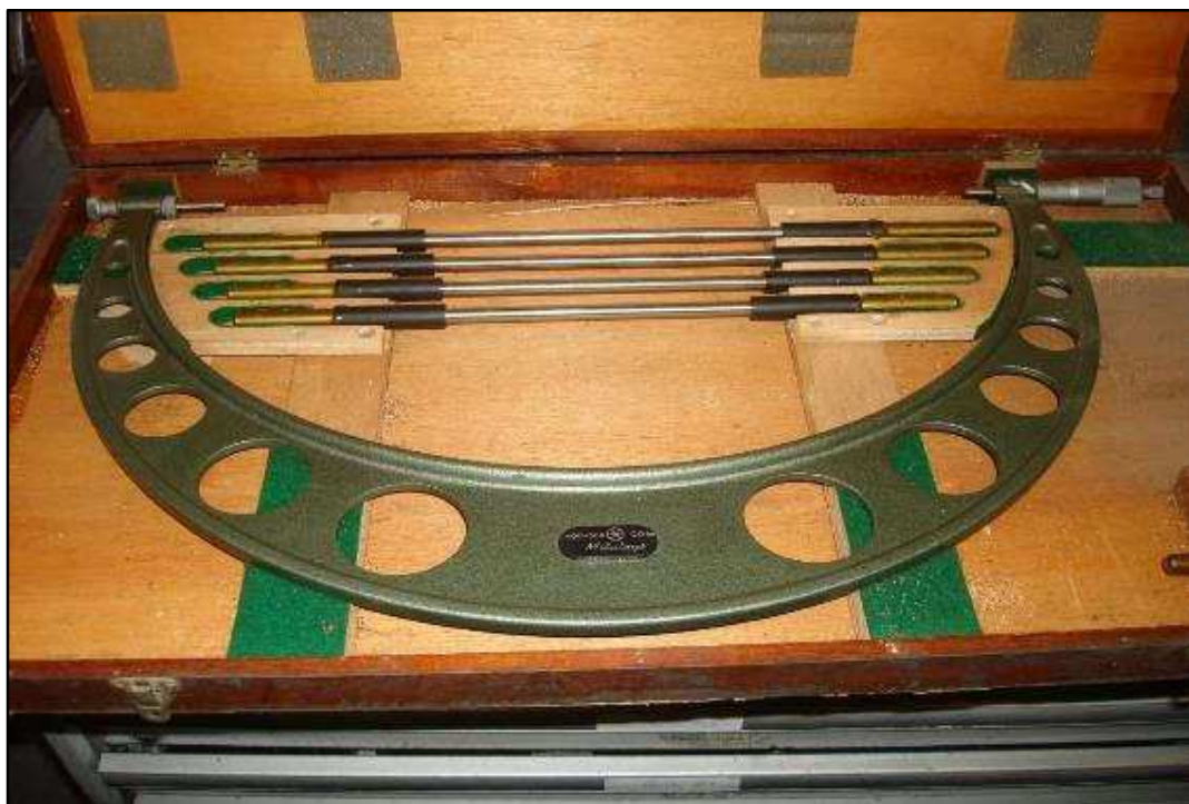
ITEM 0947 - VISTA DO MICRÔMETRO EXTERNO 400-500MM. X 0,0001 MARCA: MITUTOYO
