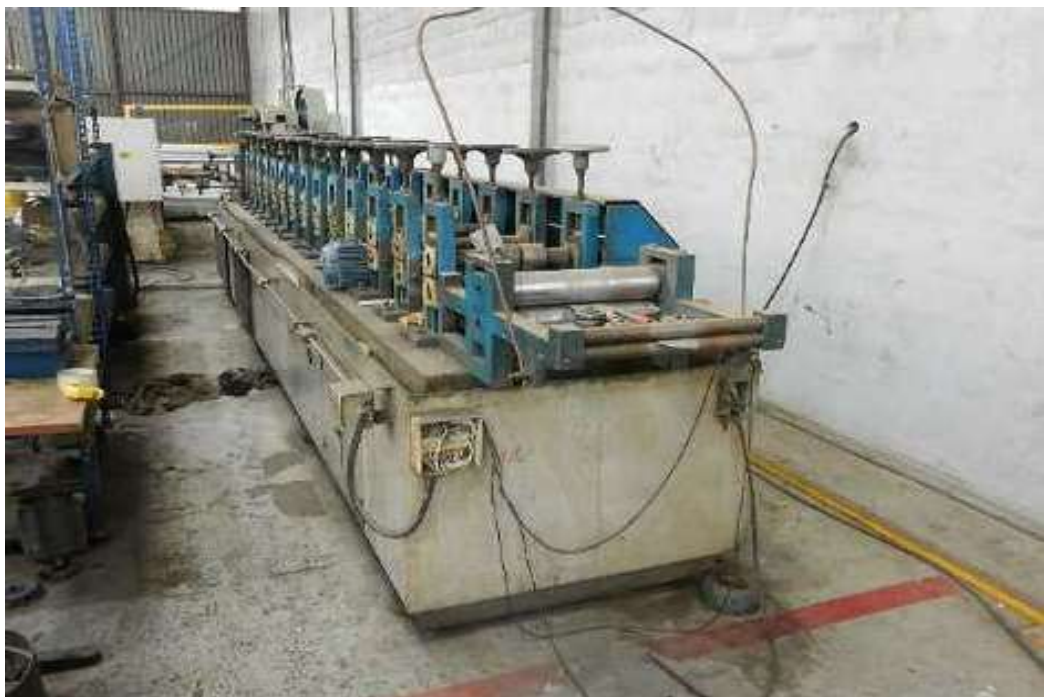
ITEM 1,008 - VISTA DA MÁQ Nº 1 – DESBOBINADOR COM MOTOR E REDUTOR E PERFILADEIRA COM 14 CASTELOS
