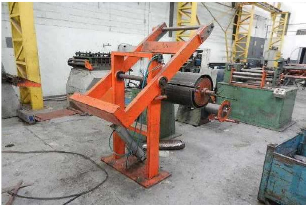
ITEM 1,018 - VISTA DO TENSIONADOR PNEUMATICO, E DESBOBINADOR, DA LINHA DE CORTE
