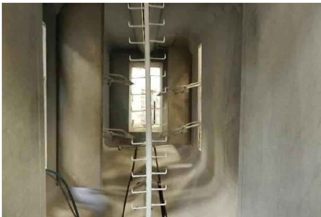
ITEM 1,038 - VISTA DA CABINE DE PINTURA MODELO: CPPE-ACGFD Nº 2367-003 DIM: 1.600 X 700 MM COM 4 BICOS MODELO: AUTOPLUS DA LINHA DE PINTURA A PO MARCA: ERZINGER,
