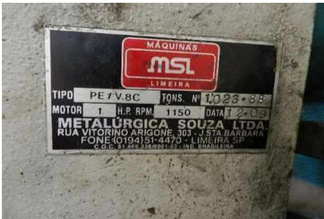
ITEM 1,046 - VISTA DA PLACA DE IDENTIFICAÇÃO DA PRENSA EXCENTRICA CAP: 8 TON MSL PE/V.8C
