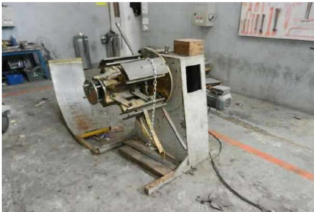
ITEM 1,045 - VISTA DO DESBOBINADOR COM MOTOR E REDUTOR DA MAQ Nº 4
