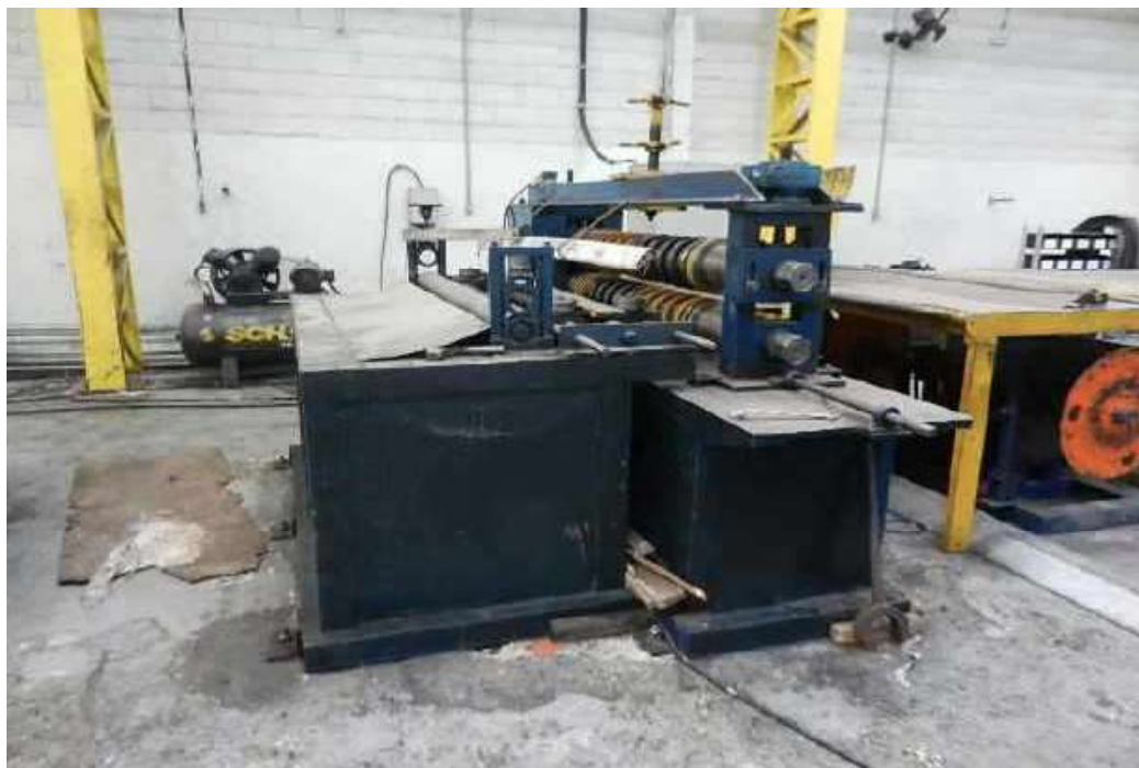
ITEM 1,022 - VISTA DA UNIDADE DE CORTE COM 2 ROLOS DA LINHA DE CORTE
