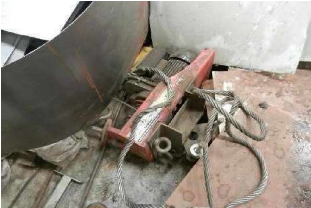
ITEM 1,031 - VISTA DO GUINCHO DE COLUNA ELETRICO MARCA: MOTOMIL
