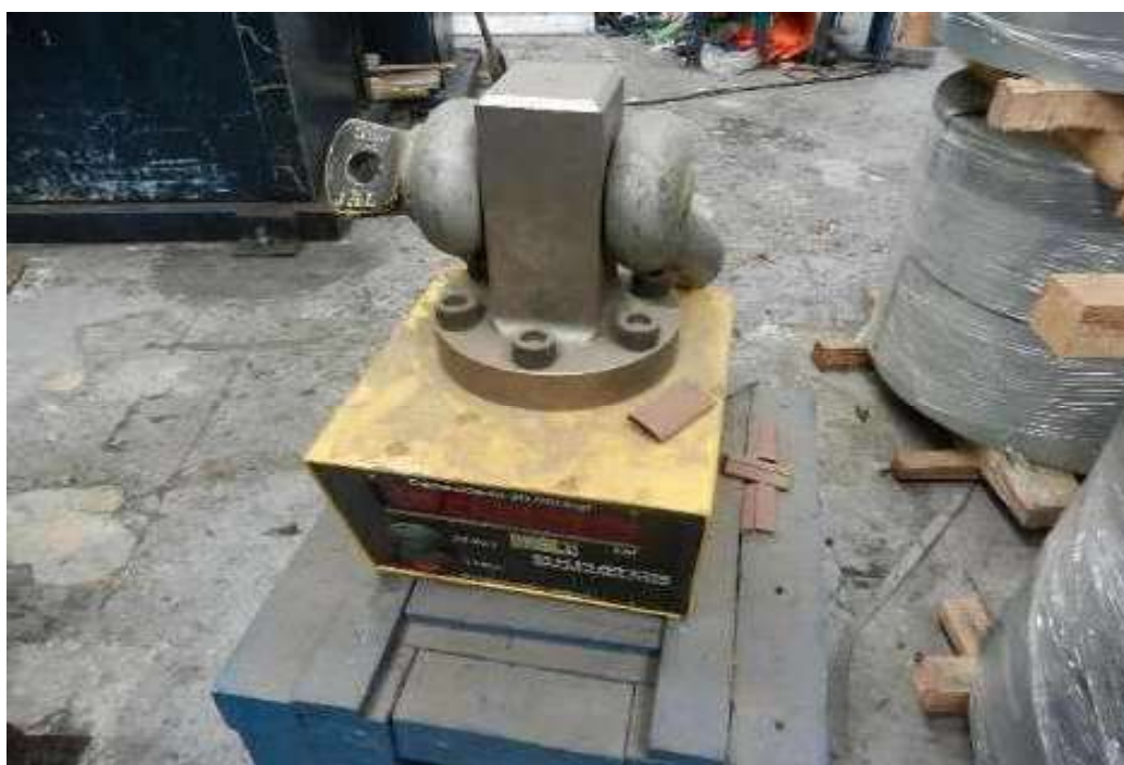
ITEM 1,029 - VISTA DO DINAMOMETRO ELETRONICO CAP: 20.000 KGF MARCA: KRATOS DMK
