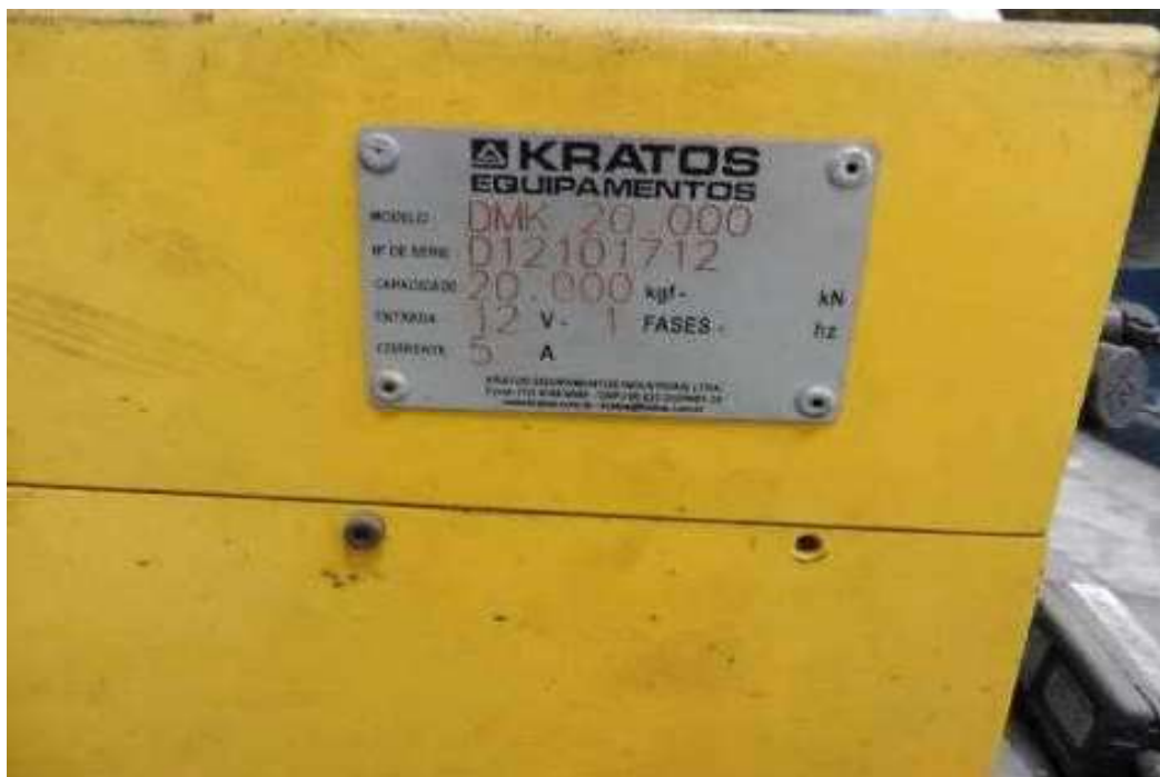
ITEM 1,029 – VISTA DA PLACA DE IDENTIFICAÇÃO DO DINAMOMETRO ELETRONICO CAP: 20.000 KGF KRATOS DMK
