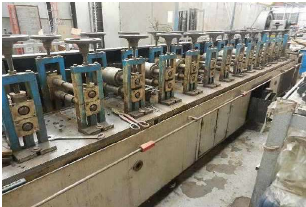
ITEM 1,045 - VISTA DA PERFILADEIRA COM 13 CASTELOS DA MAQ Nº 4
