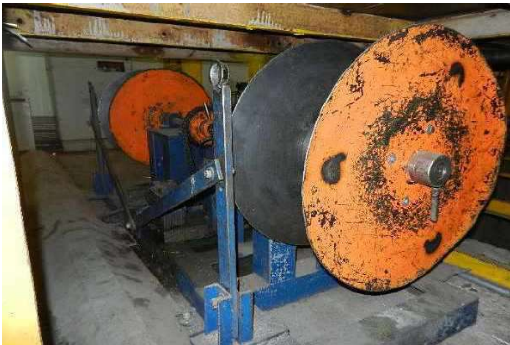
ITEM 1,022 - VISTA DA UNIDADE PARA ENROLAR APARAS SOB A MESA DE SAIDA DA LINHA DE CORTE
