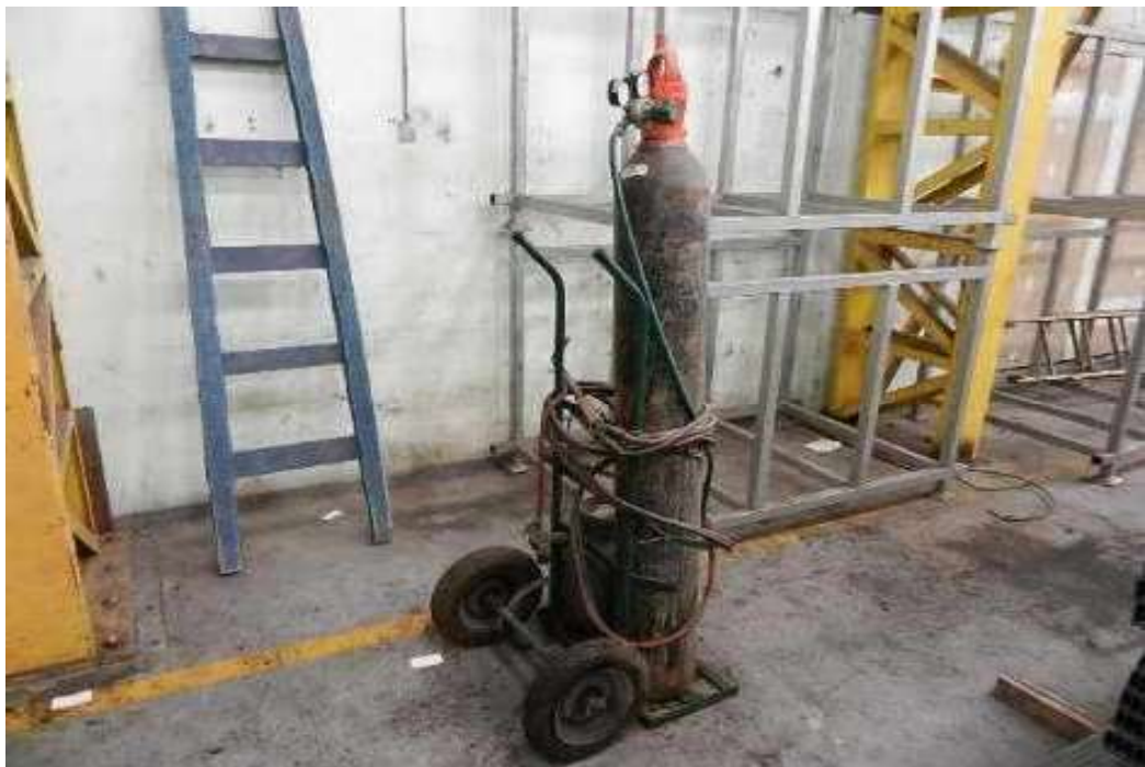
ITEM 1,019 - VISTA DO CONJUNTO OXI ACETILENO COM CILINDRO DE OXIGENIO E BUTIJAO DE GAS
