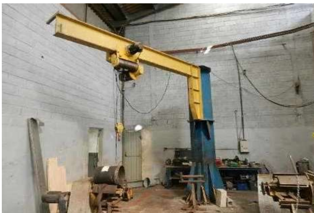
ITEM 1,042 - VISTA DO BRAÇO GIRATÓRIO COM TALHA ELETRICA MARCA: ROVELA COMANDO POR BOTOEIRA
