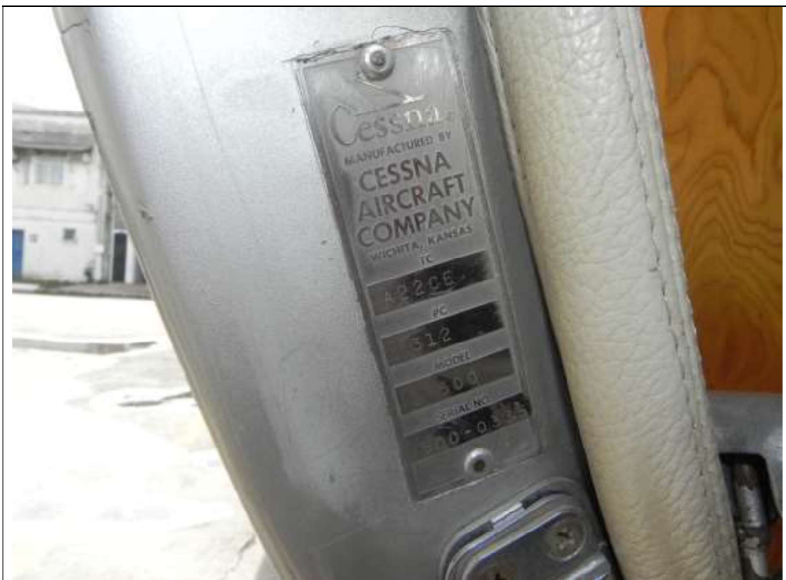
Foto 37 – Plaqueta de identificação do fabricante com número de série
