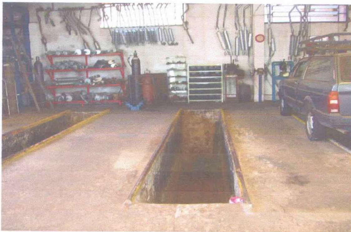
FOTO 18 - Vista das "valetas" de trabalho.
