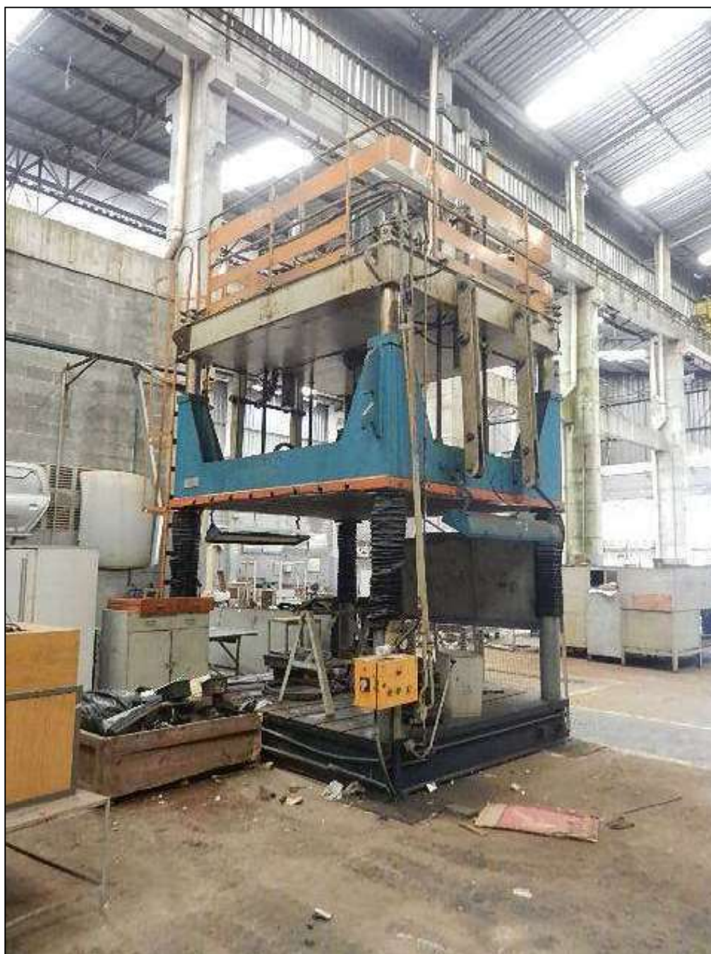
1,004 – VISTA DA PRENSA HIDRAULICA 4 COLUNAS CAP: 100 TON DIM: MESA: 2.410 X 2.300 MM
