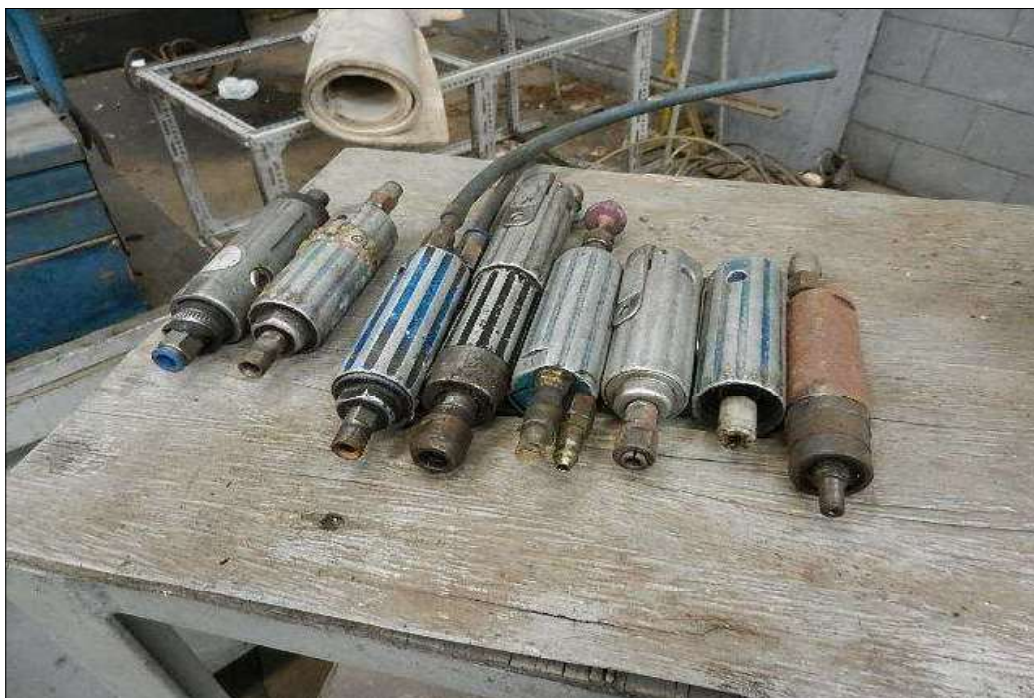
1.006 – VISTA DAS ESMERILHADEIRAS PNEUMÁTICAS
