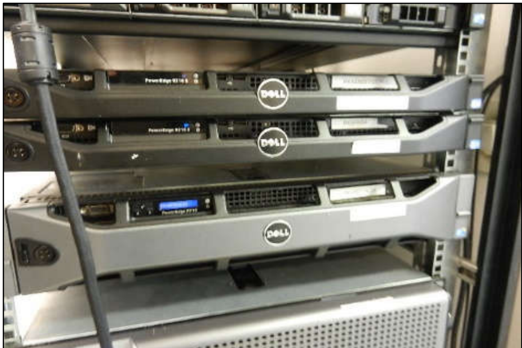
ITENS 0056/0057/0060 - SERVIDORES DELL POWER EDGE R210 II, POWER EDGE R410 , POWER EDGE R710,
