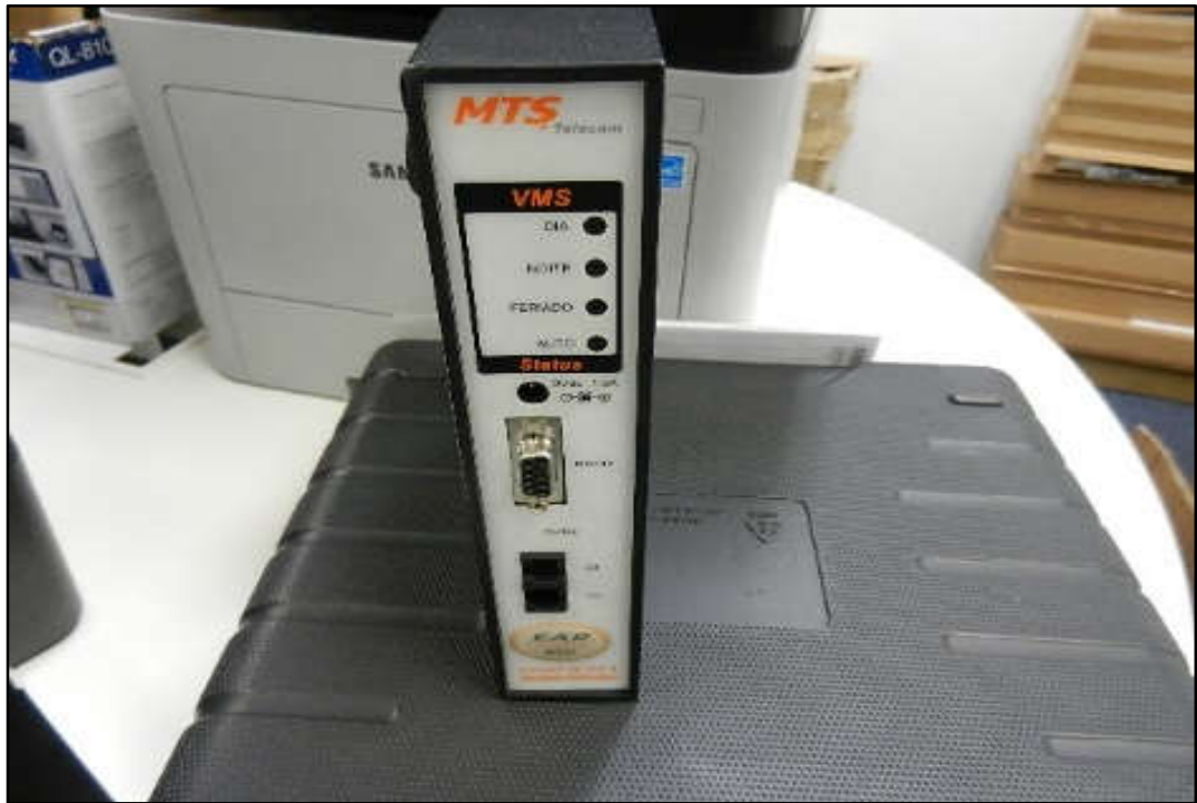
ITEM 0138 - ATENDEDOR AUTOMÁTICO DE CHAMADAS MTS TELECOM EAR-4000
