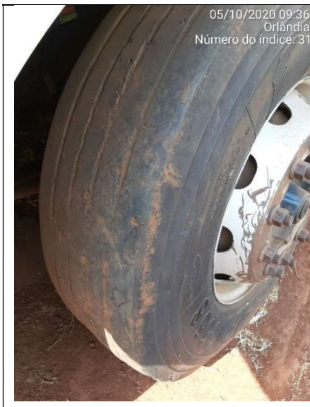
Fotos 16 e 17 – Pneus dianteiros desgastados e sem condições de utilização.
