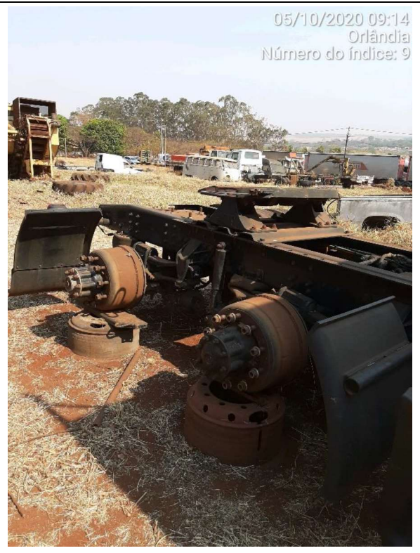
Fotos 14 e 15 – Eixos traseiros do veículo faltando: 01 roda do lado esquerdo (foto 14) e as 02 rodas do lado direito (foto 15).
