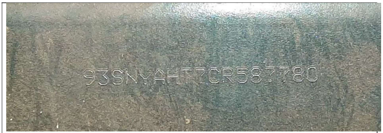
Foto 03 – Nº Chassis estampado na longarina do Chassis: 93SNYAHT7CR587780
