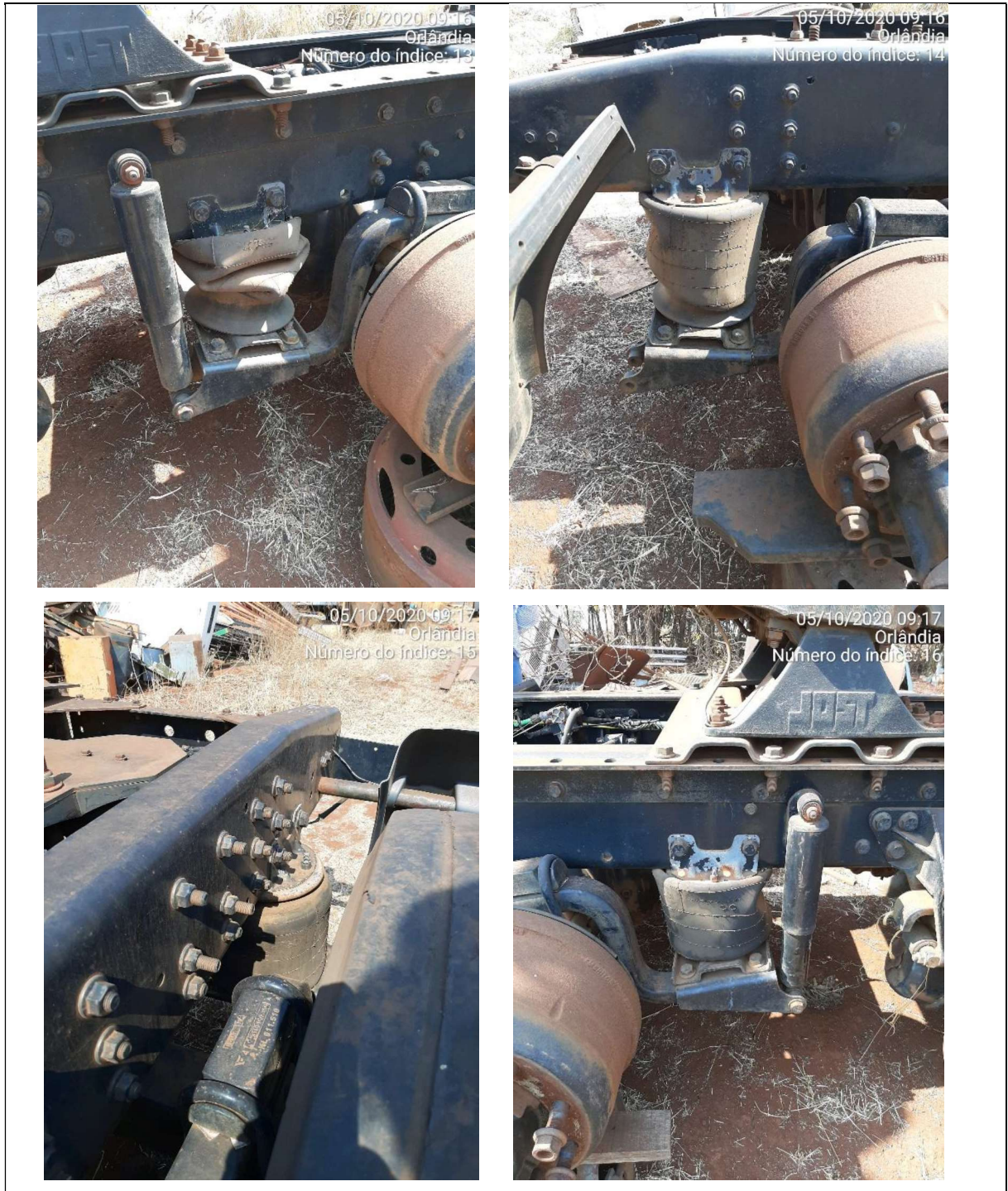
Fotos 20, 21, 22 e 23 – Sistema de amortecimento necessita de manutenção.
