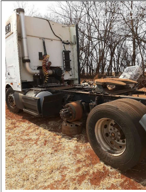
Fotos 14 e 15 – Eixos traseiros do veículo faltando: 01 roda do lado esquerdo (foto 14) e as 02 rodas do lado direito (foto 15).
