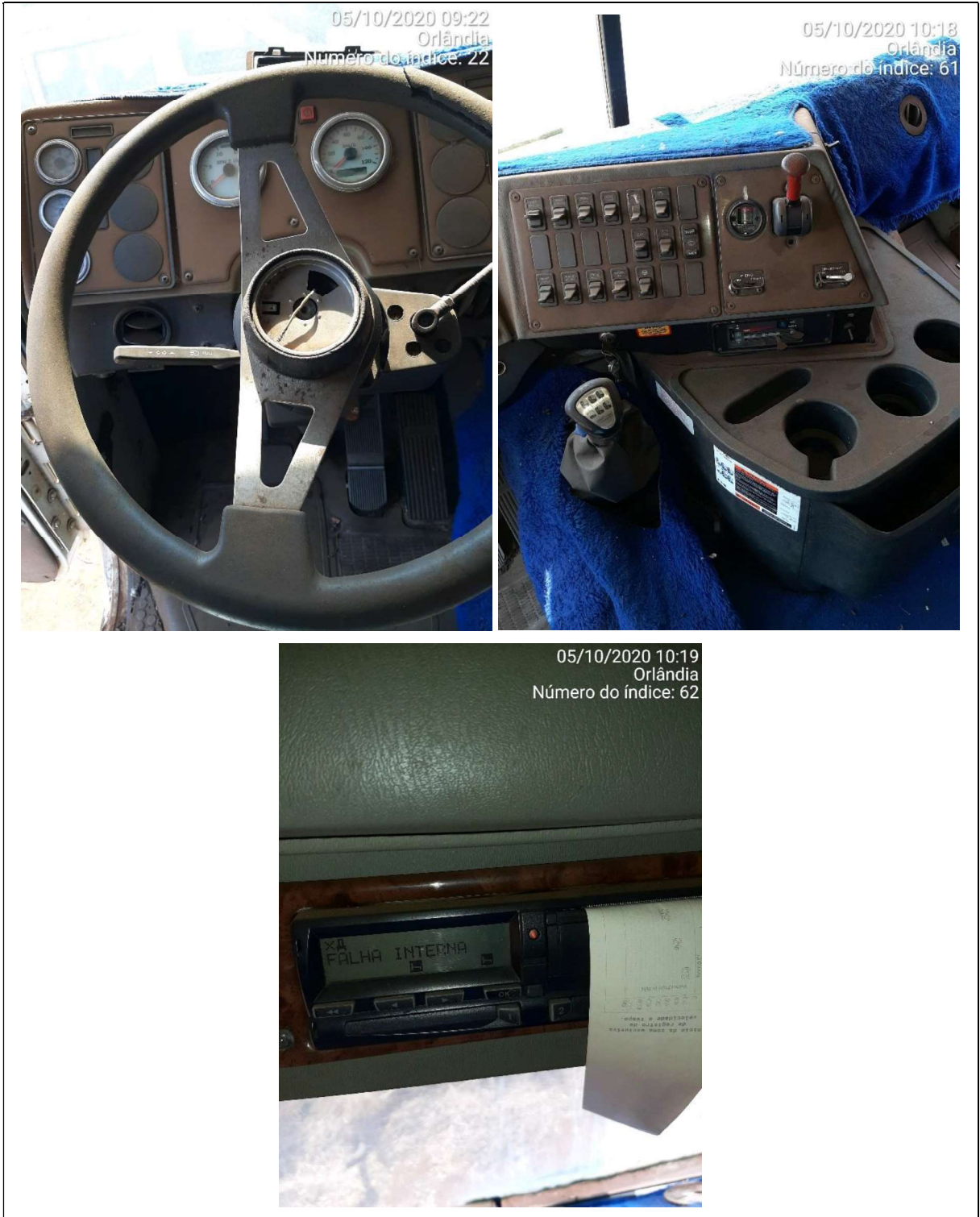
Fotos 08, 09 e 10 – Imagens do painel de comando e equipamento registro de velocidade (Tacógrafo)
