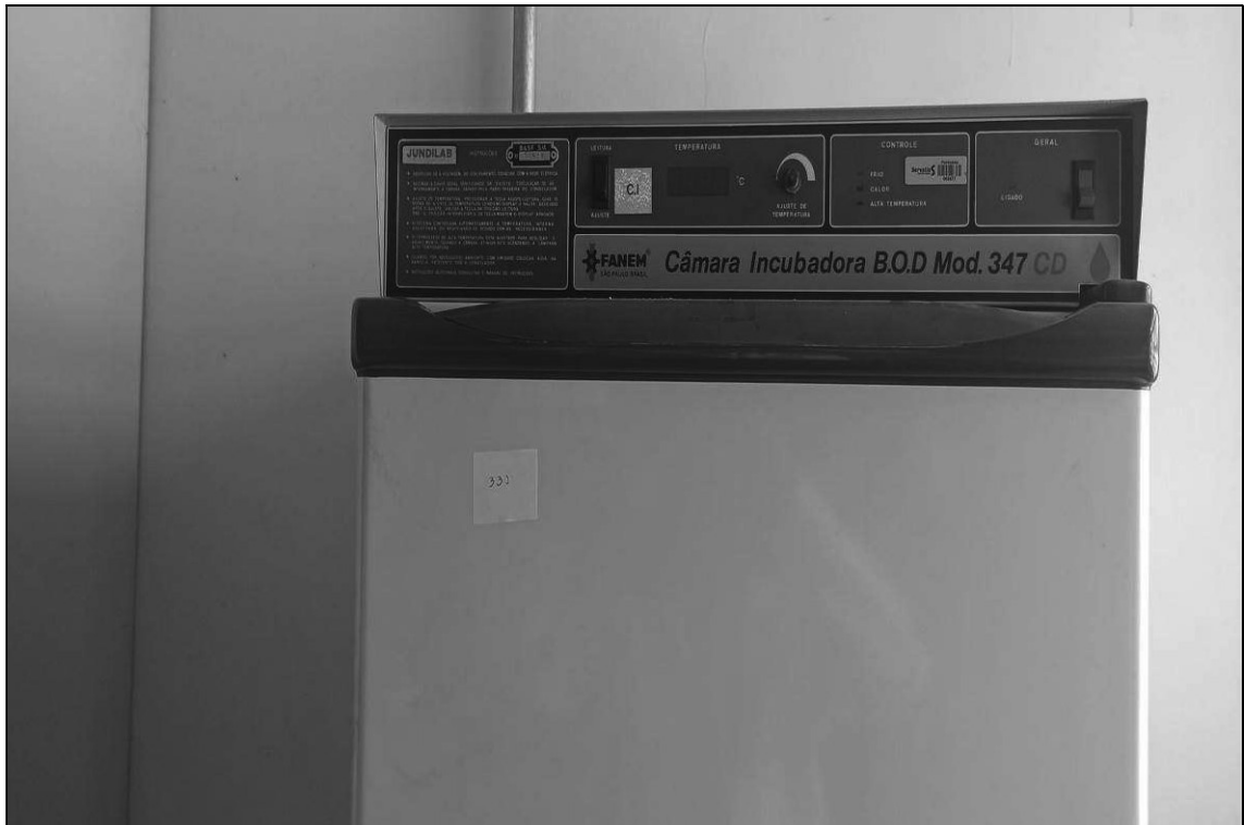
ITEM 1,103 – VISTA DA ESTUFA INCUBADORA, FAB. FANEM, MOD. 347CD, DIM. 800X900X1800 MM, N. SERIE TP3174
