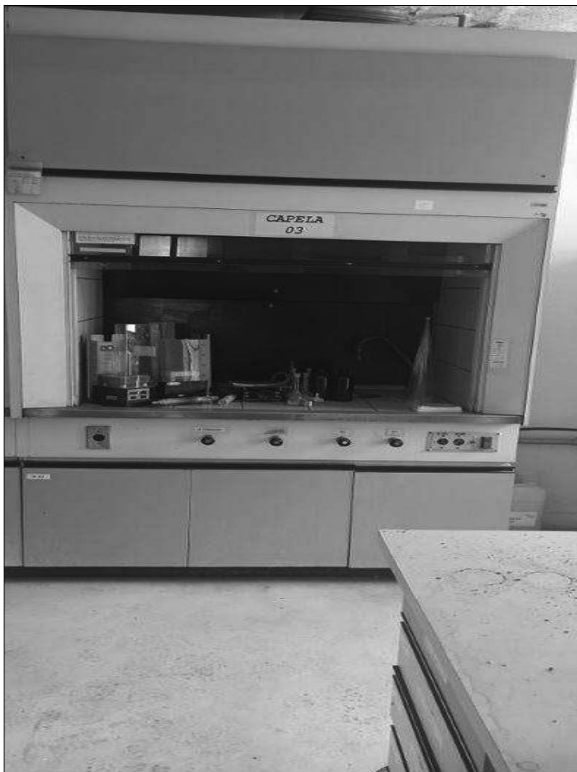
ITEM 1,105 – VISTA DA CAPELA PARA LABORATORIO, MADEIRA, REVEST. EM CEREJEIRA COM INTERIOR EM AZULEJO COM 3 PORTAS, DIM. 1500X760X2600 MM
