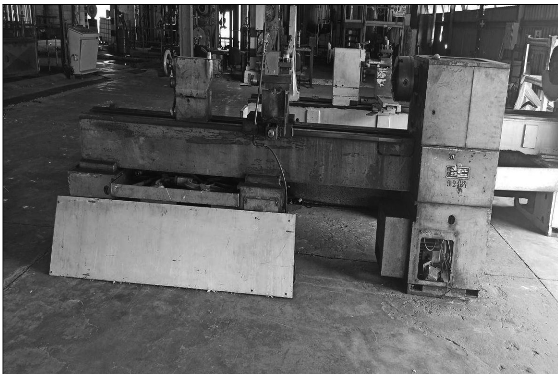
ITEM 1,094 – VISTA DO TORNO MECANICO, FAB. NARDINI, MOD. ND325 CE, DIAM. 450X2000 MM
