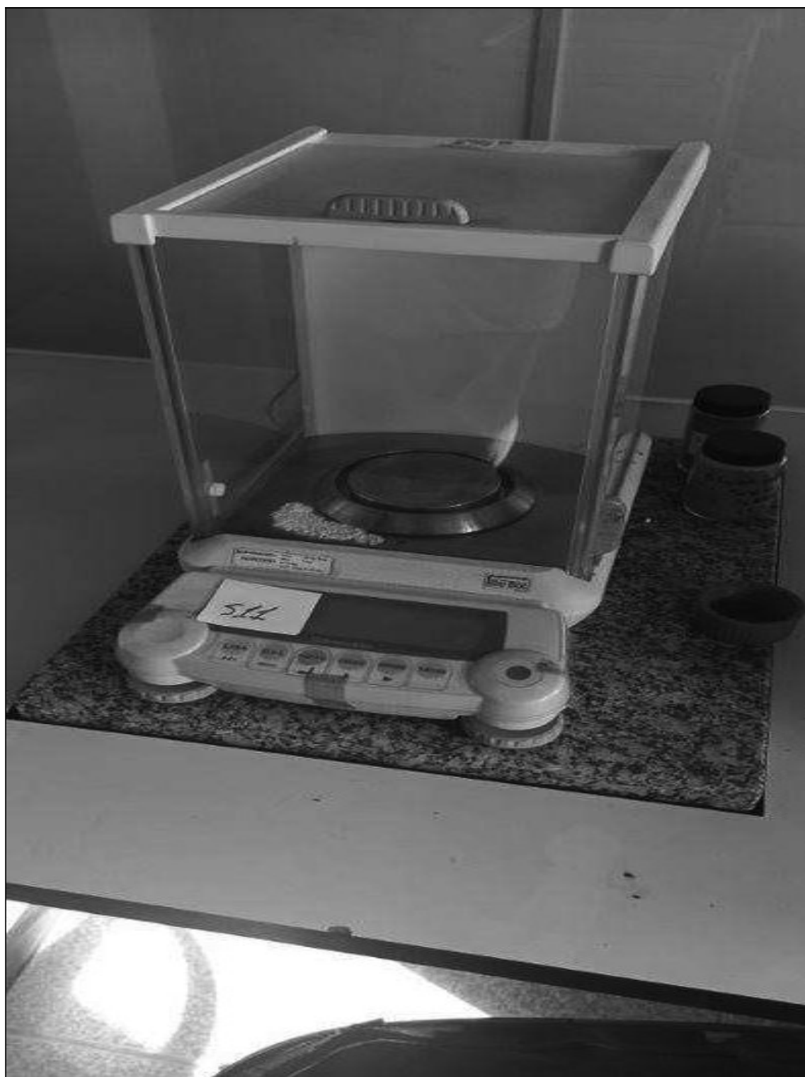
ITEM 1,159 – VISTA DA BALANCA DE PRECISAO, FAB. SHIMADZU, MOD. AUV220D, N. SERIE D305500002
