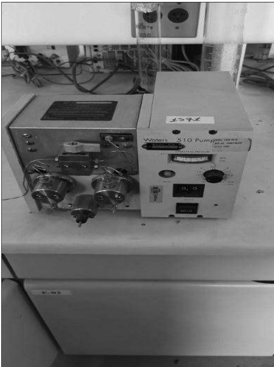
ITEM 1,220 – VISTA DA BOMBA PARA HPLC, FAB. WATERS, MOD. 510 PUMP
