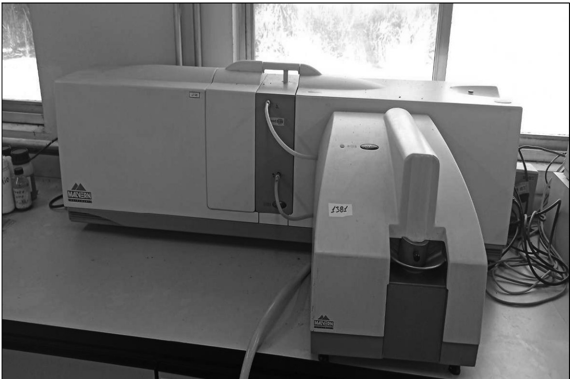
ITEM 1,230 – VISTA DO ANALISADOR DE TAMANHO DE PARTICULAS, FAB. MALVERN, MOD. HYDRO2000S
