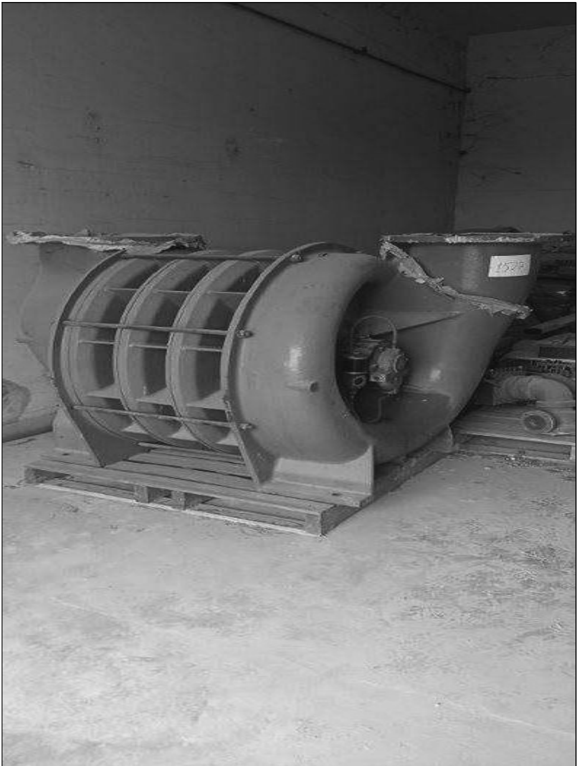
ITEM 1,010 – VISTA DA BOMBA CENTRIFUFA, FAB. SPANCER, MOD. C62624, DIAM. 800MM, CONEX. 500 MM, N. SERIE 500391
