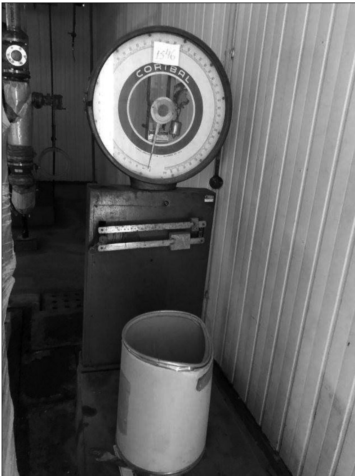
ITEM 1,029 – VISTA DA BALANCA DE PRATO, FAB. CORTBAL, CARGA MAX. 375 KG
