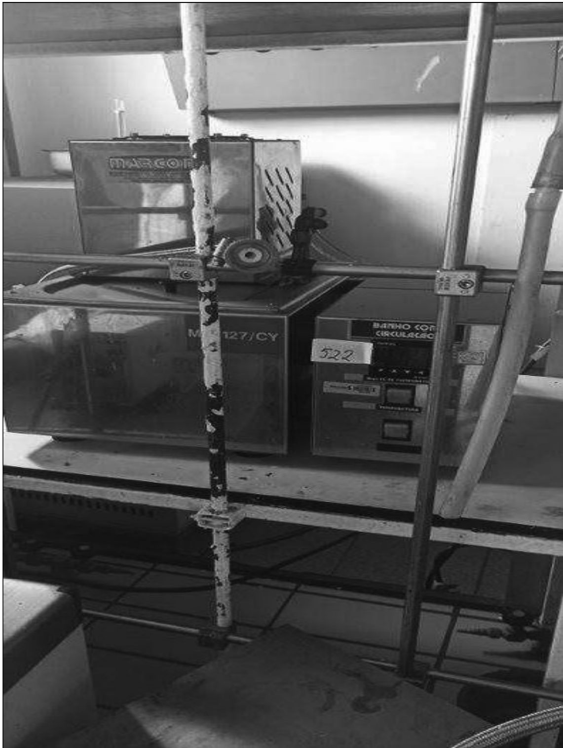
ITEM 1,170 – VISTA DO BANHO TERMOSTATICO, FAB. MARCONI, MOD. MA-127, COM CIRCULACAO
