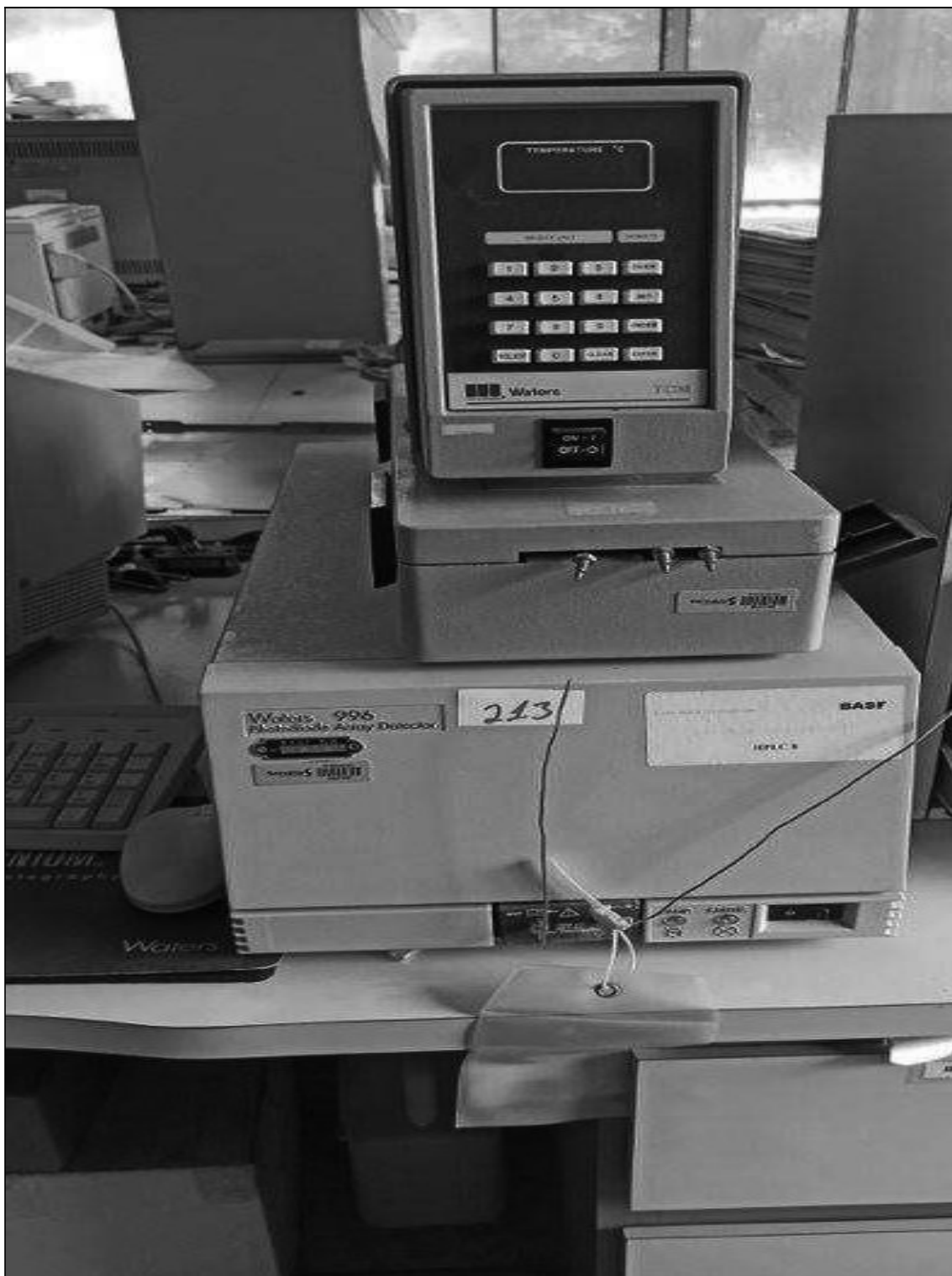
ITEM 1,056 – VISTA DO DETECTOR DE FOTODIODO, FAB. WATERS, MOD. 996
