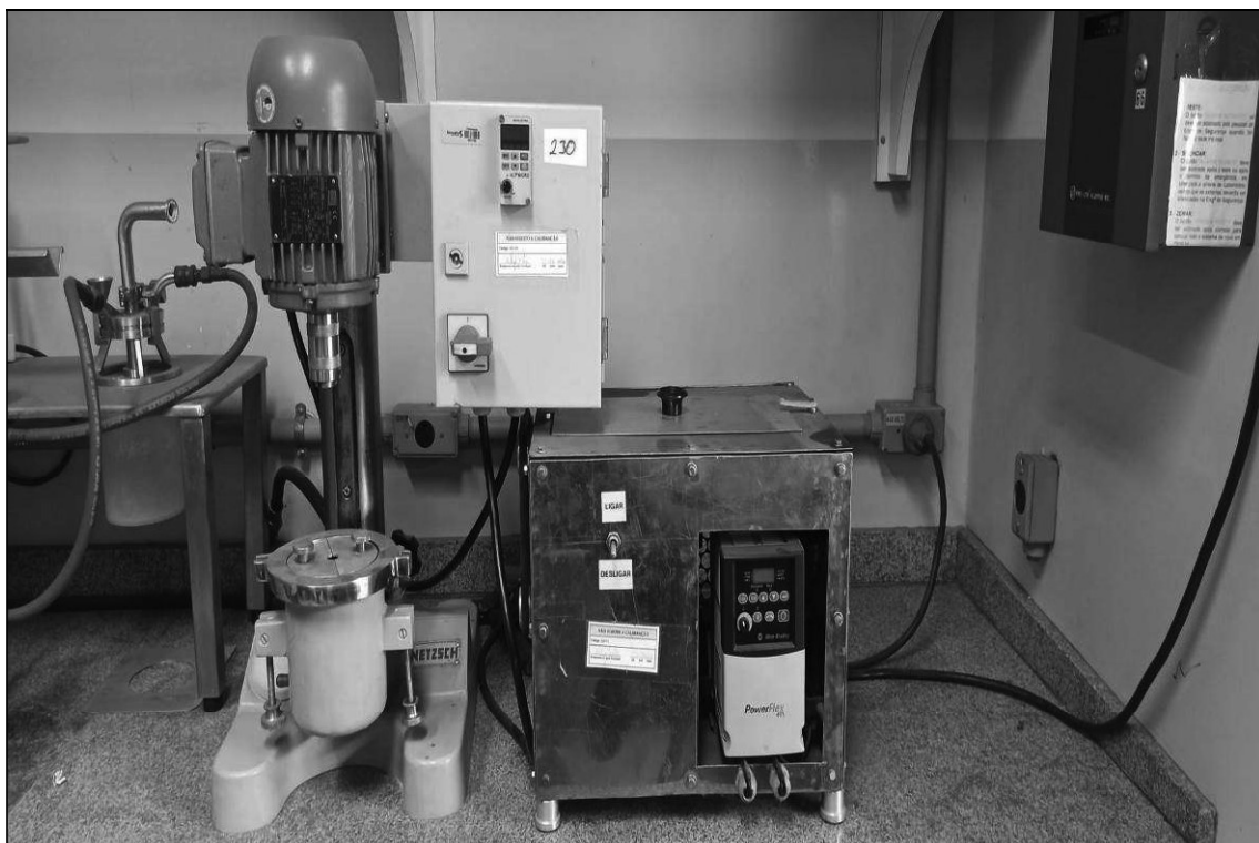
ITEM 1,066 – VISTA DO MOINHO, FAB. NETZSCH, MOD. PE075, ACIONAM. MOTOR ELETRICO, FABR. WEG, CAPAC. 0,5 CV - 1720RPM
