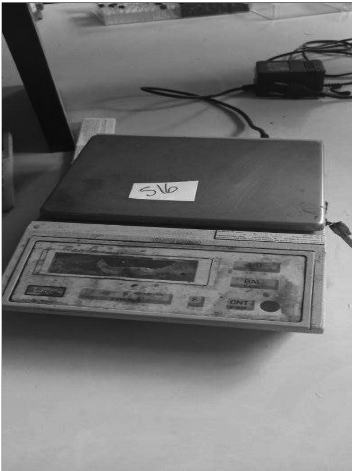
ITEM 1,164 – VISTA DA BALANCA DE PRECISAO, FAB. MARTE, MOD. AS-5000-C, CARGA MAX. 5000 G, DIV. 0.1 G, N. SERIE 20213
