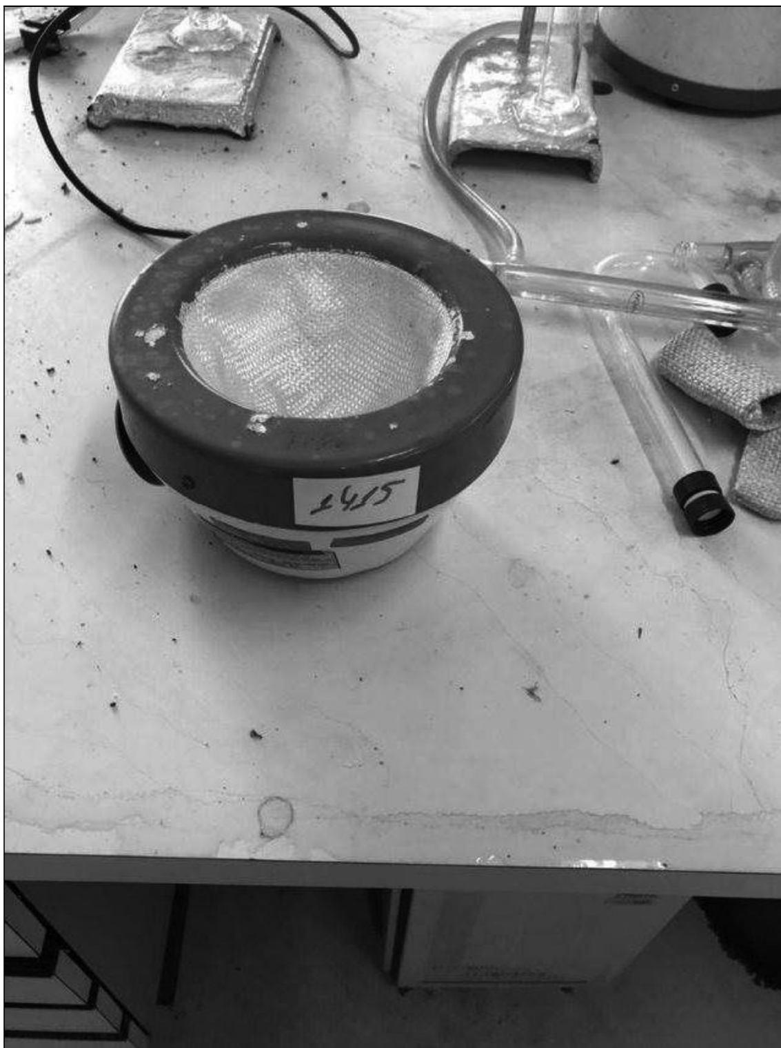
ITEM 1,263 – VISTA DA MANTA DE AQUECIMENTO, FAB. FISATON, MOD. 52
