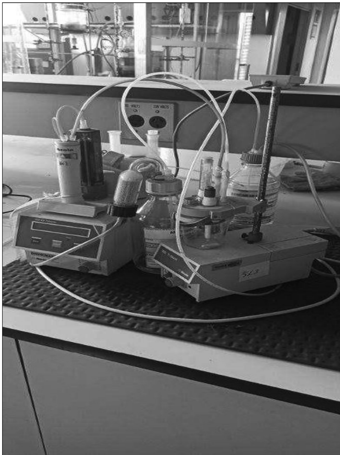
ITEM 1,161 – VISTA DO AGITADOR MAGNETICO E KARL FISHER, FAB. METROHM, MOD. TI STAND 703
