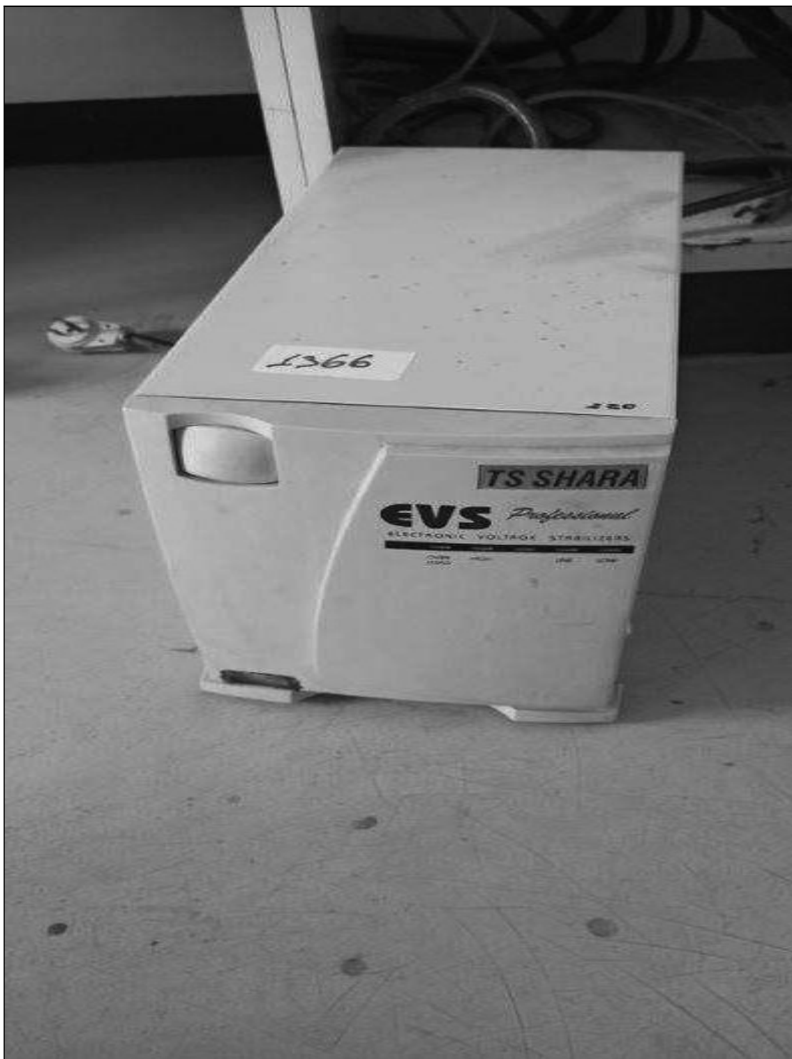
ITEM 1,215 – VISTA DO ESTABILIZADOR DE TENSAO, FAB. TS SHARA, MOD. EVS PROF 3000
