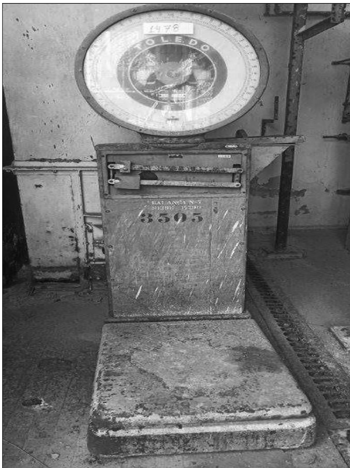
ITEM 1,038 – VISTA DA BALANCA DE PLATAFORMA, FAB. TOLEDO, MOD. 2181 FR, CARGA MAX. 750 KG
