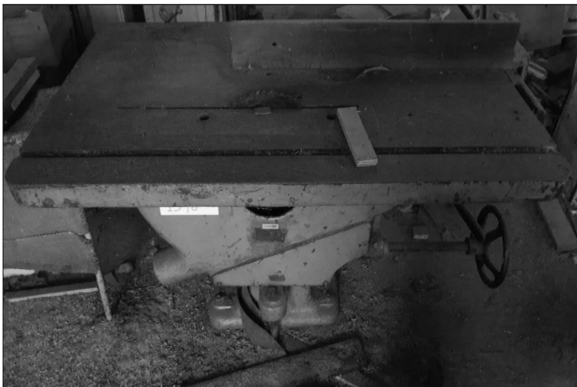
ITEM 1,040 – VISTA DA SERRA CIRCULAR, FURADEIRA HORIZONTAL E TUPIA CONJUGADA, FAB. RAIMANN, MOD. KM, DIAM. SERRA 250 MM, DIM. MESA 770X1250 MM
