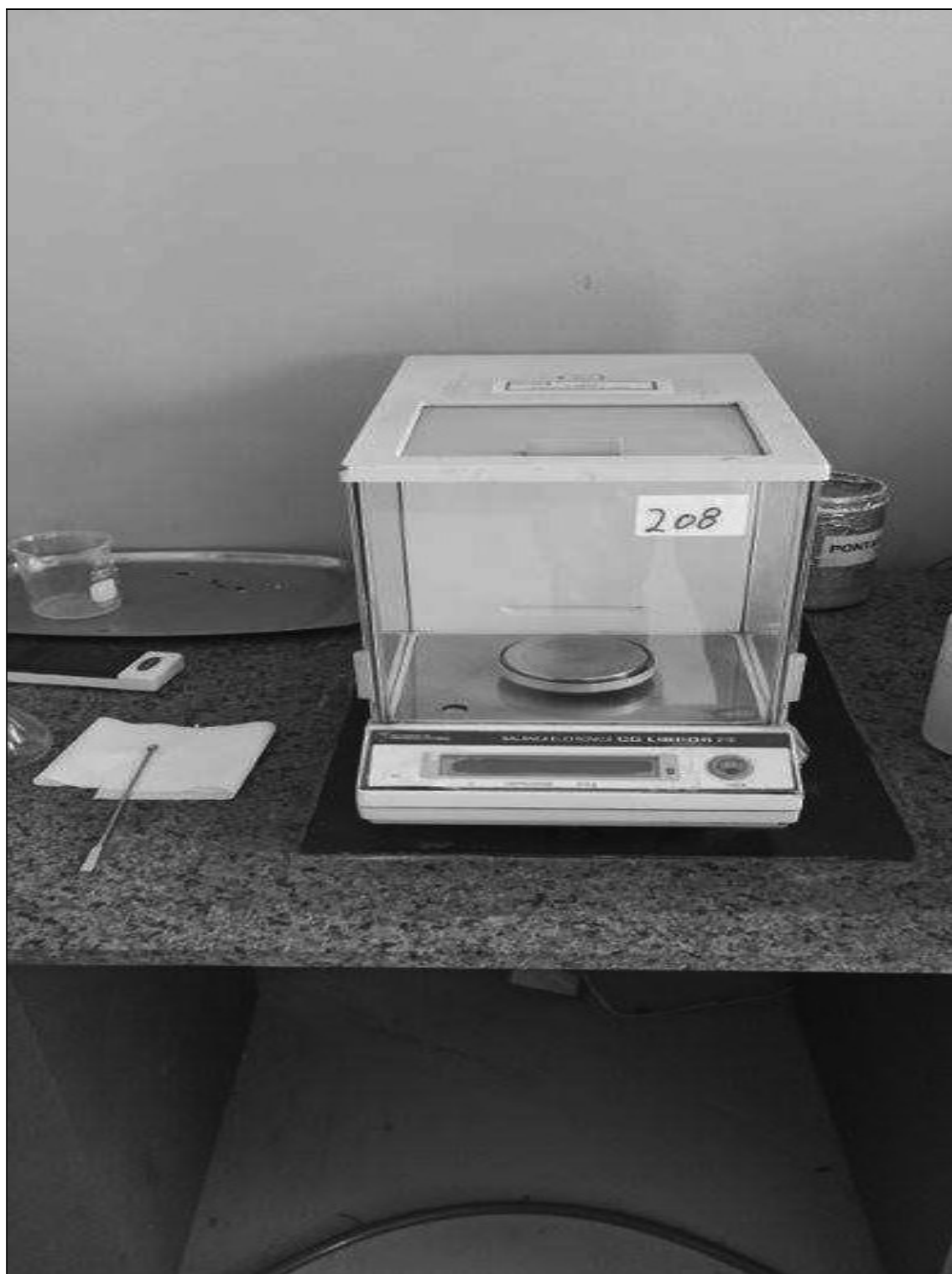
ITEM 1,054 – VISTA DA BALANCA DE PRECISAO, FAB. INSTRUMENTOS CIENTIFICOS CG, MOD. CG LIBROR 210, CAPAC. 210 G, N. SERIE 69850
