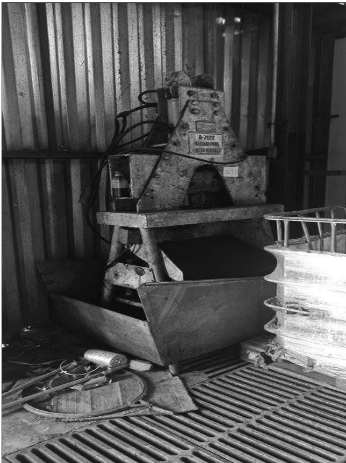
ITEM 1,026 – VISTA DA PRENSA HIDRAULICA PARA CORTE DE MAGNESIO, FAB. MEGANESES, MOD. UI, CAPAC. 8 T, ACION. MOT. ELETRICO 7.5 CV - 1745 RPM, DIM. 1100X650X2000 MM
