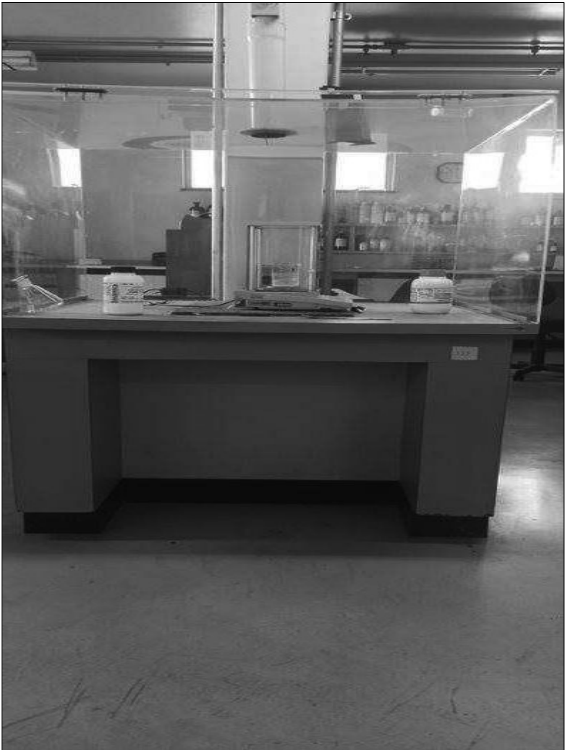
ITEM 1,106 – VISTA DA BANCADA DE MADEIRA PARA BALANCA, REVEST. EM LAMINADO MELAMINICO, DIM. 1000X800X750 MM
