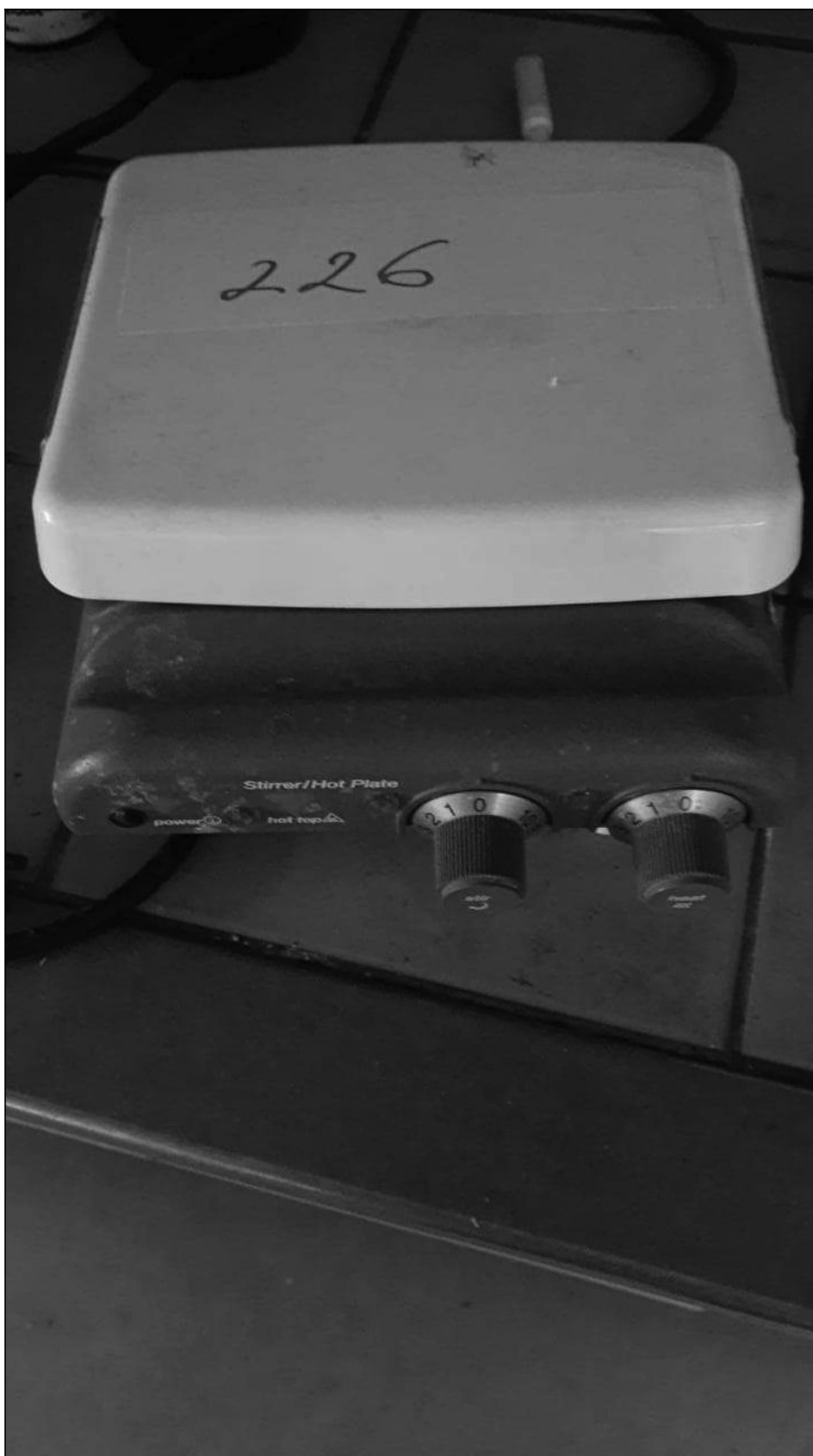
ITEM 1,064 – VISTA DO AGITADOR MAGNETICO COM AQUECIMENTO, FAB. CORNING, MOD. STIRRER/HOT PLATE
