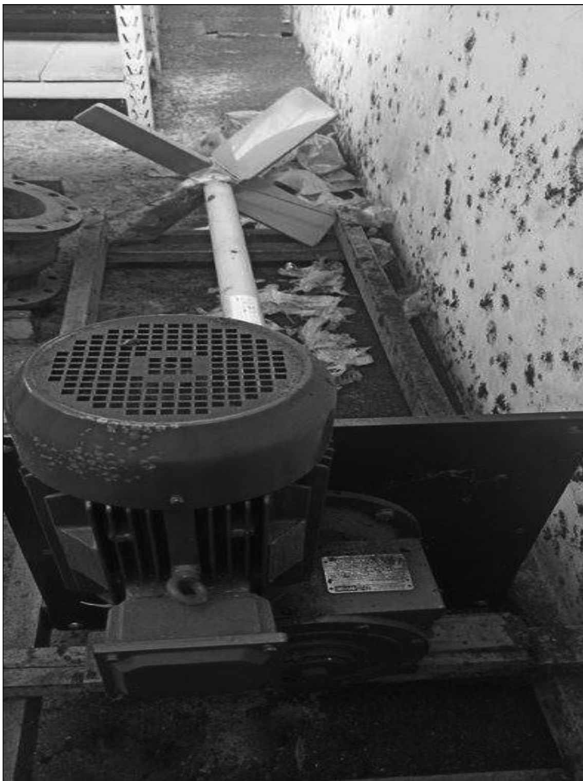
ITEM 1,033 – VISTA DO MOTOR FAB. MARATON MOD. HJN112M1-4 COM AGITADOR FAB. GRAB MOD. F4R
