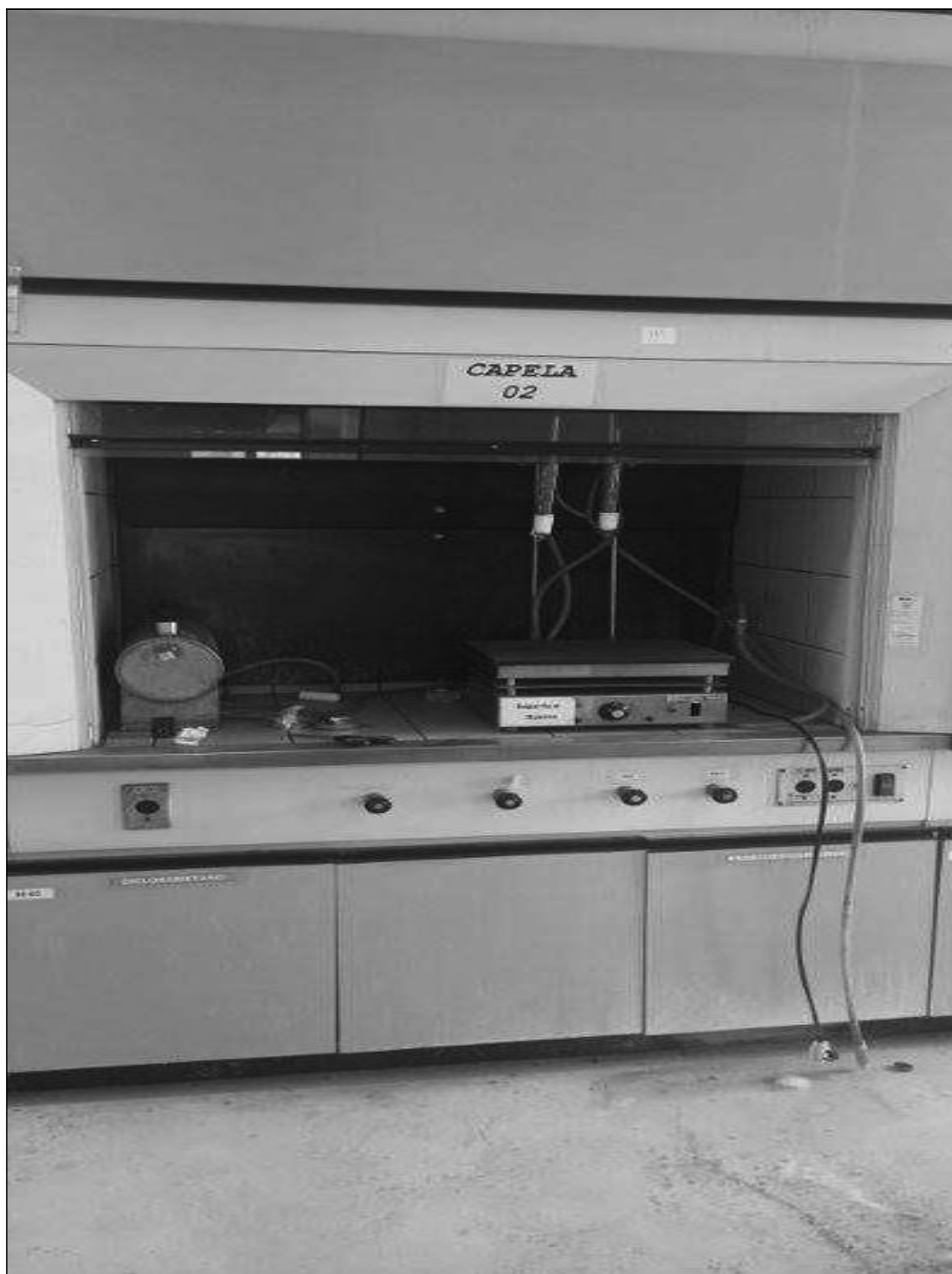
ITEM 1,104 – VISTA DA CAPELA PARA LABORATORIO, MADEIRA, REVEST. EM CEREJEIRA COM INTERIOR EM AZULEJO COM 3 PORTAS, DIM. 1500X760X2600 MM
