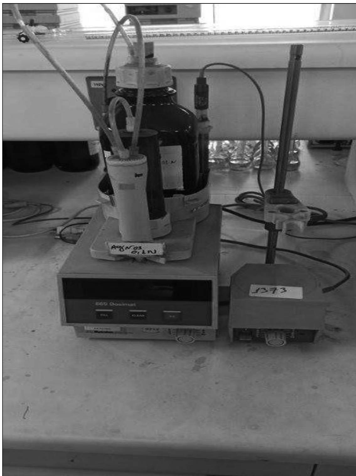
ITEM 1,222 – VISTA DO DOSIMAT, FAB. METROHM, MOD. 665 DOSIMAT, N. SERIE 8P5/193
