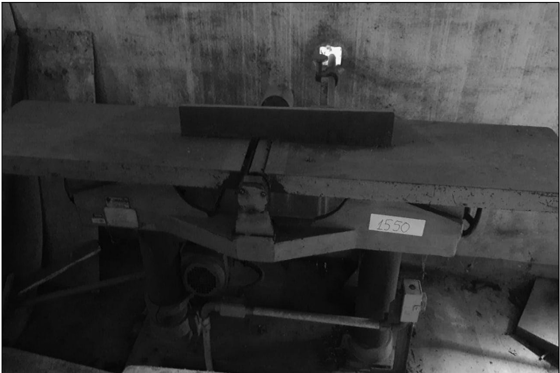
ITEM 1,042 – VISTA DA DESEMPENADEIRA, FAB. MAZUTTI, DIM. 350X1860 MM
