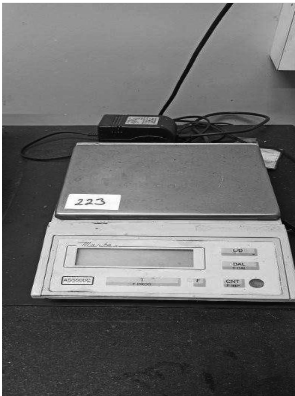
ITEM 1,062 – VISTA DA BALANCA ANALITICA, FAB. MARTE, MOD. AS5500C
