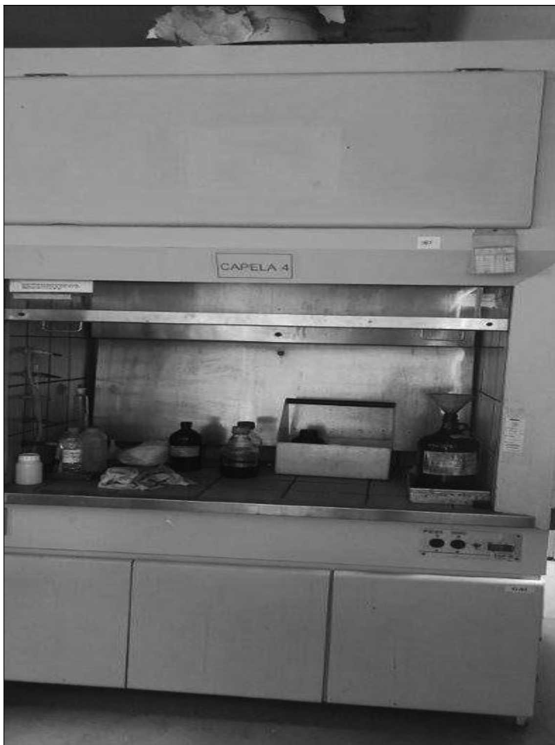
ITEM 1,124 – VISTA DA CAPELA, FAB. ENGELAB, REVEST. EM LAMINADO MELAMINICO, TAMPO EM CERAMICA, COM 1 PORTA DE VIDRO DE CORRER E 3 PORTAS DE ABRIR, DIM. 1500X800X2600 MM
