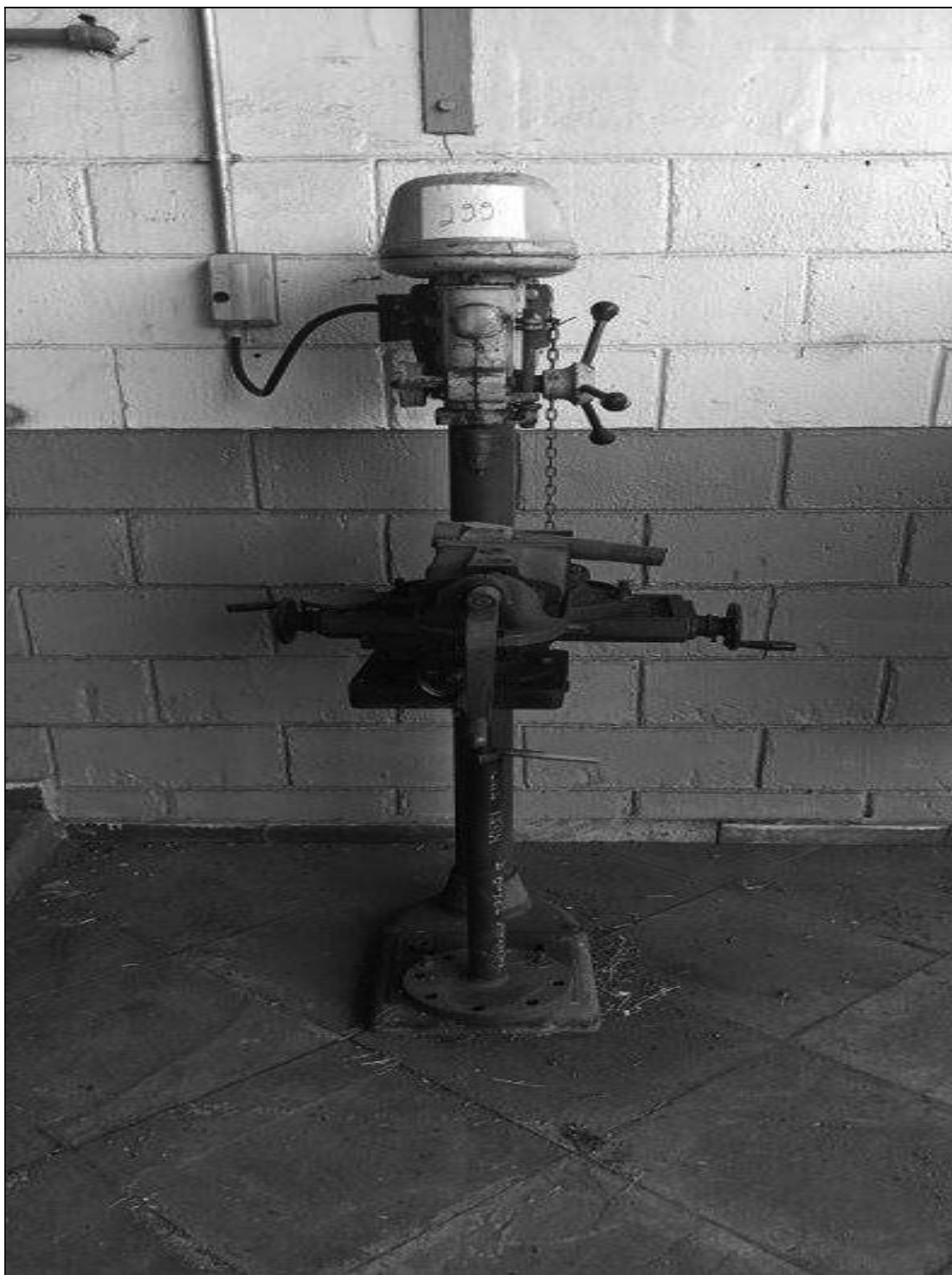
ITEM 1,099 – VISTA DA FURADEIRA DE COLUNA, FAB. ITATIAIA, AVANÇO VERTICAL 100 MM, CAPAC. 1/8-5/8 POL, N. SERIE 1038
