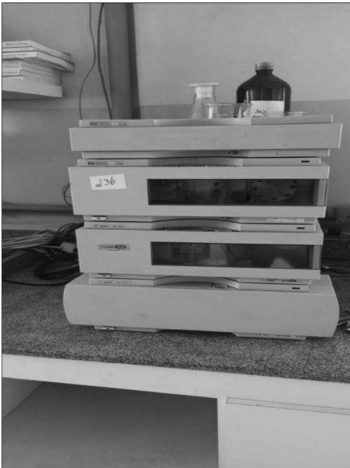
ITEM 1,070 – VISTA DO CROMATOGRACO, FAB. AGILENT, MOD. 1101 SERIES, COM DEGASSER, MOD. G1397A, NUM SERIE JP13201013, COM ISOPUMP, MOD. G1310A, NUM. SERIE DE11103800, COM COCOM, MOD. G1316A, NUM. SERIE DE11122886, COM DAD MOD. G-1315A, NUM. SERIE US72101318, COM VWD MOD. G1314A
