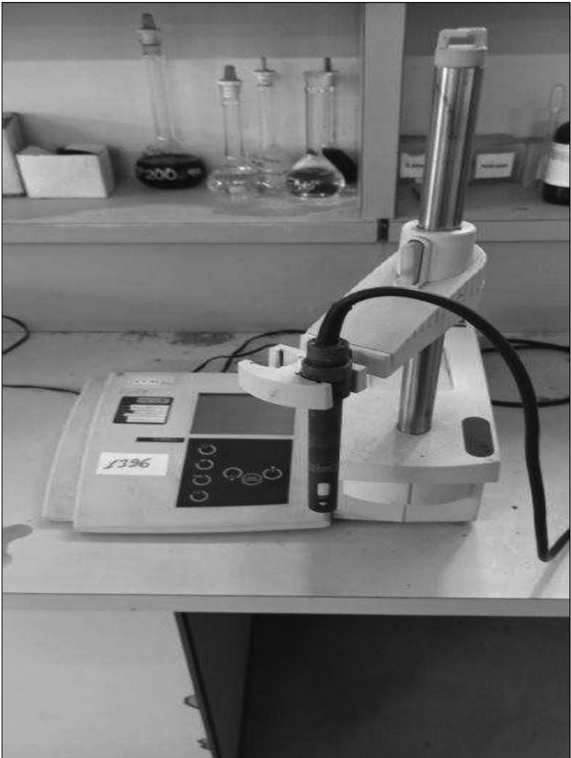
ITEM 1,245 – VISTA DO CONDUTIVIMETRO, FAB. INOLAB, MOD. LEVEL 1
