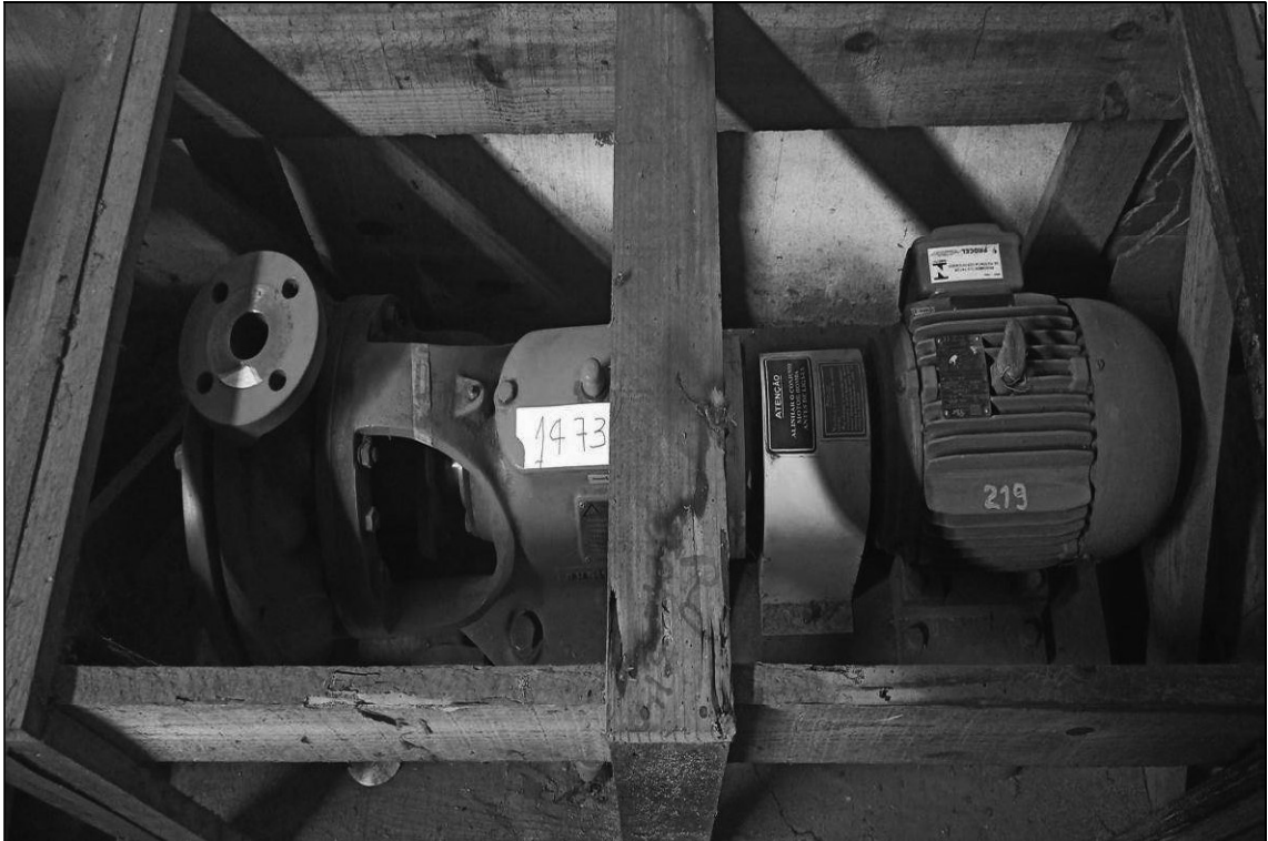
ITEM 1,034 – VISTA DA BOMBA CENTRIFUGA, FAB. FRIATEC, MOD. RCE40/200DN, VAZAO 2000 M3/H, H = 25 MCA, ACION. MOTOR ELETRICO
