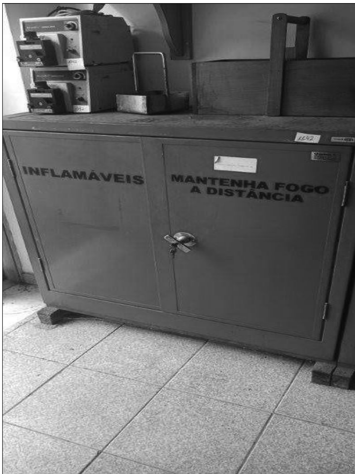
ITEM 1,186 – VISTA DO ARMARIO CORTA FOGO, 2 PORTAS, DIM. 1.00 X 0.45 X 1.00 M
