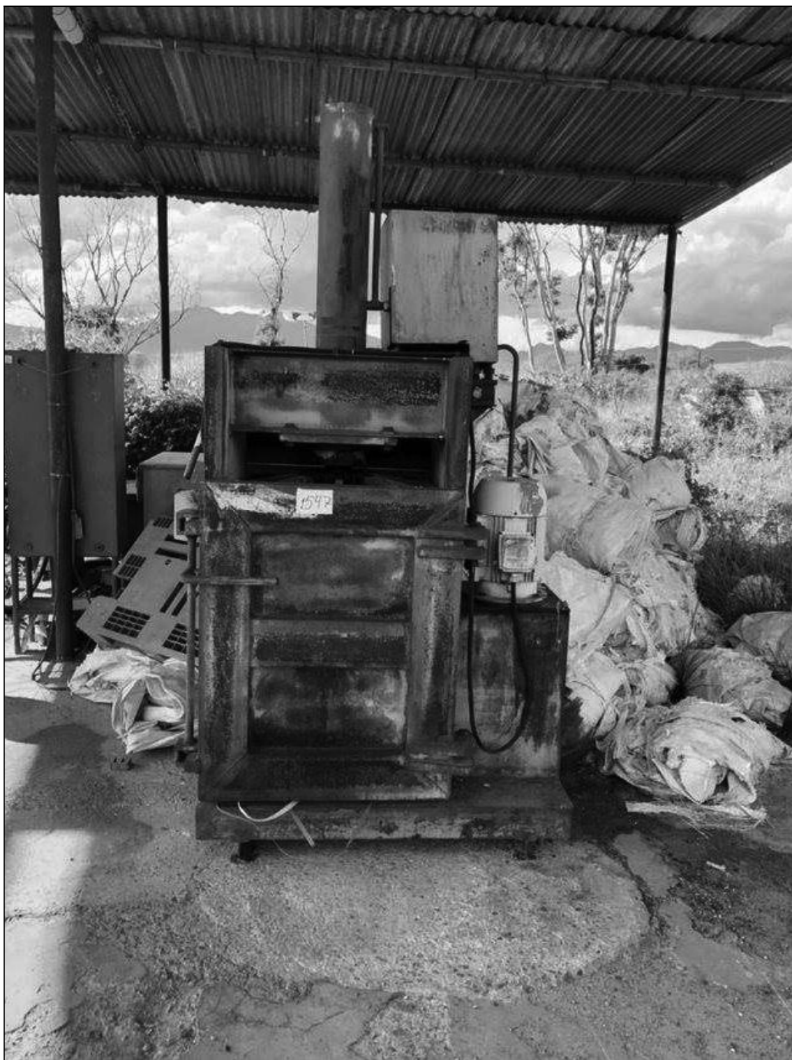
ITEM 1,037 – VISTA DA COMPACTADORA, FAB. TECNOIMPLE, MOD. TI-TB, DIM. 900X800X1500 MM, ACIONAM. MOTOR ELETRICO 15 CV, 1750RPM
