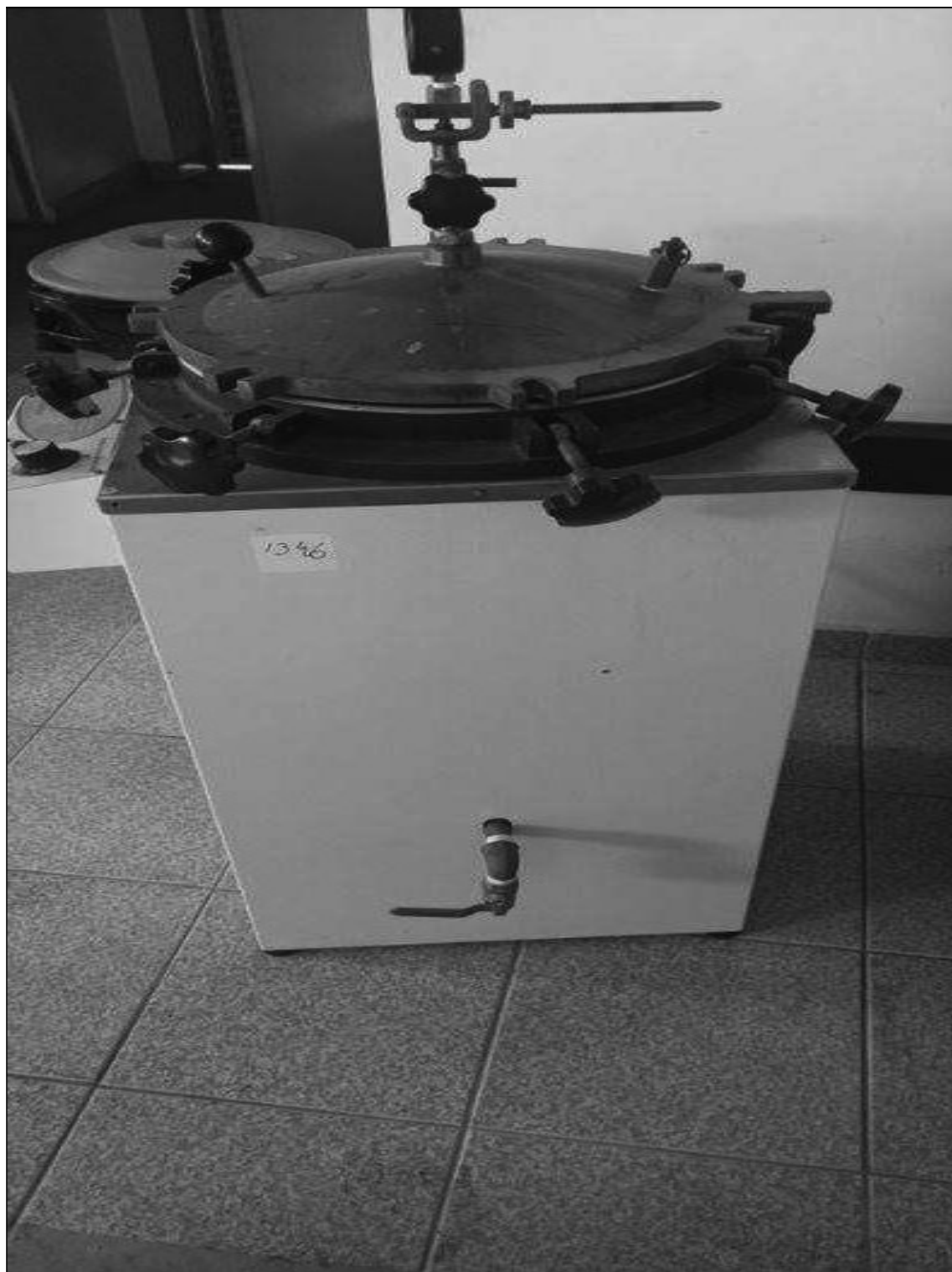
ITEM 1,195 – VISTA DA AUTOCLAVE, FAB. PHOENIX, MOD. AV-50
