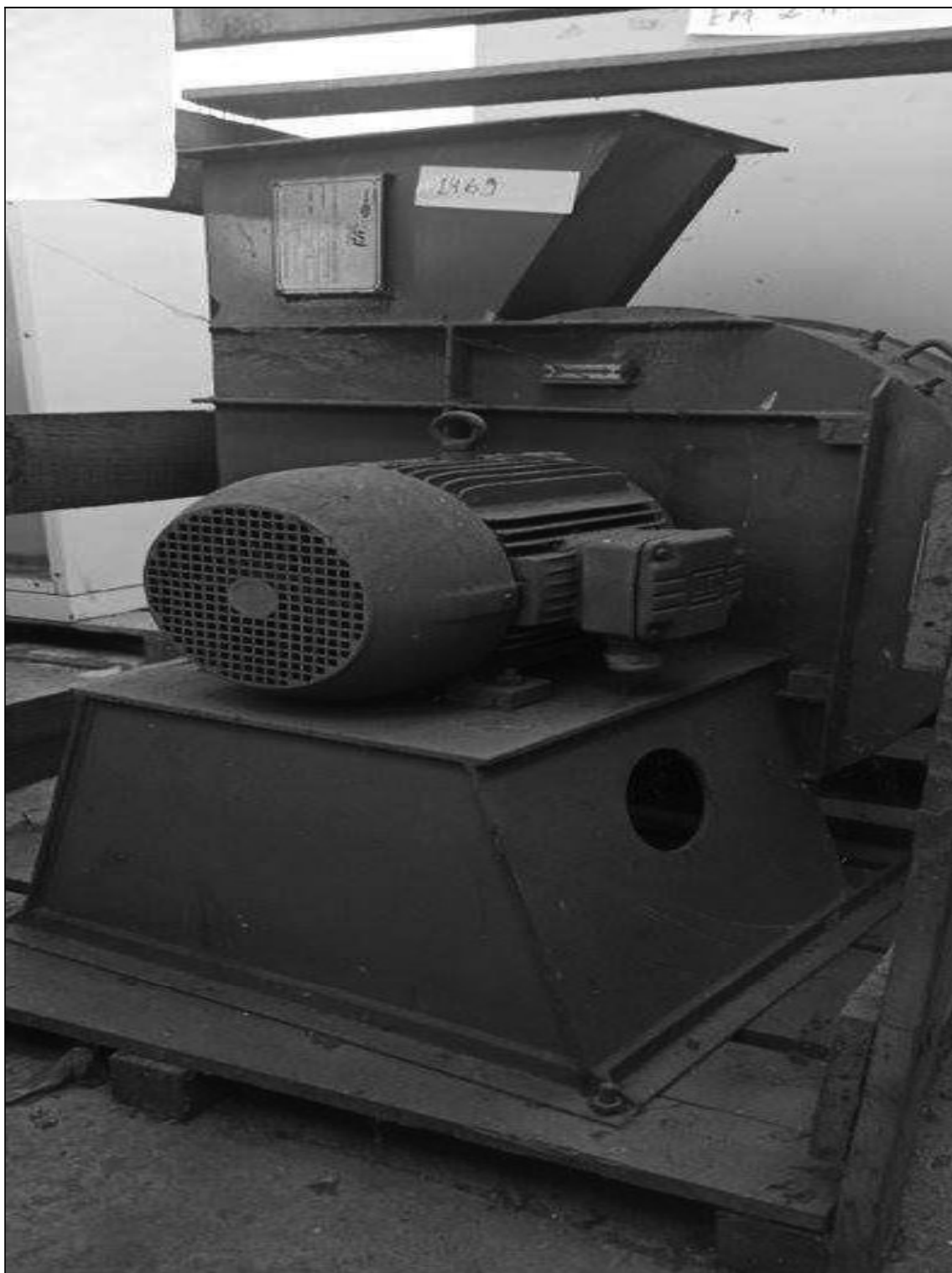
ITEM 1,030 – VISTA DO VENTILADOR CETRIFUGO, FAB. KEI-TEK, MOD. PAC16450
