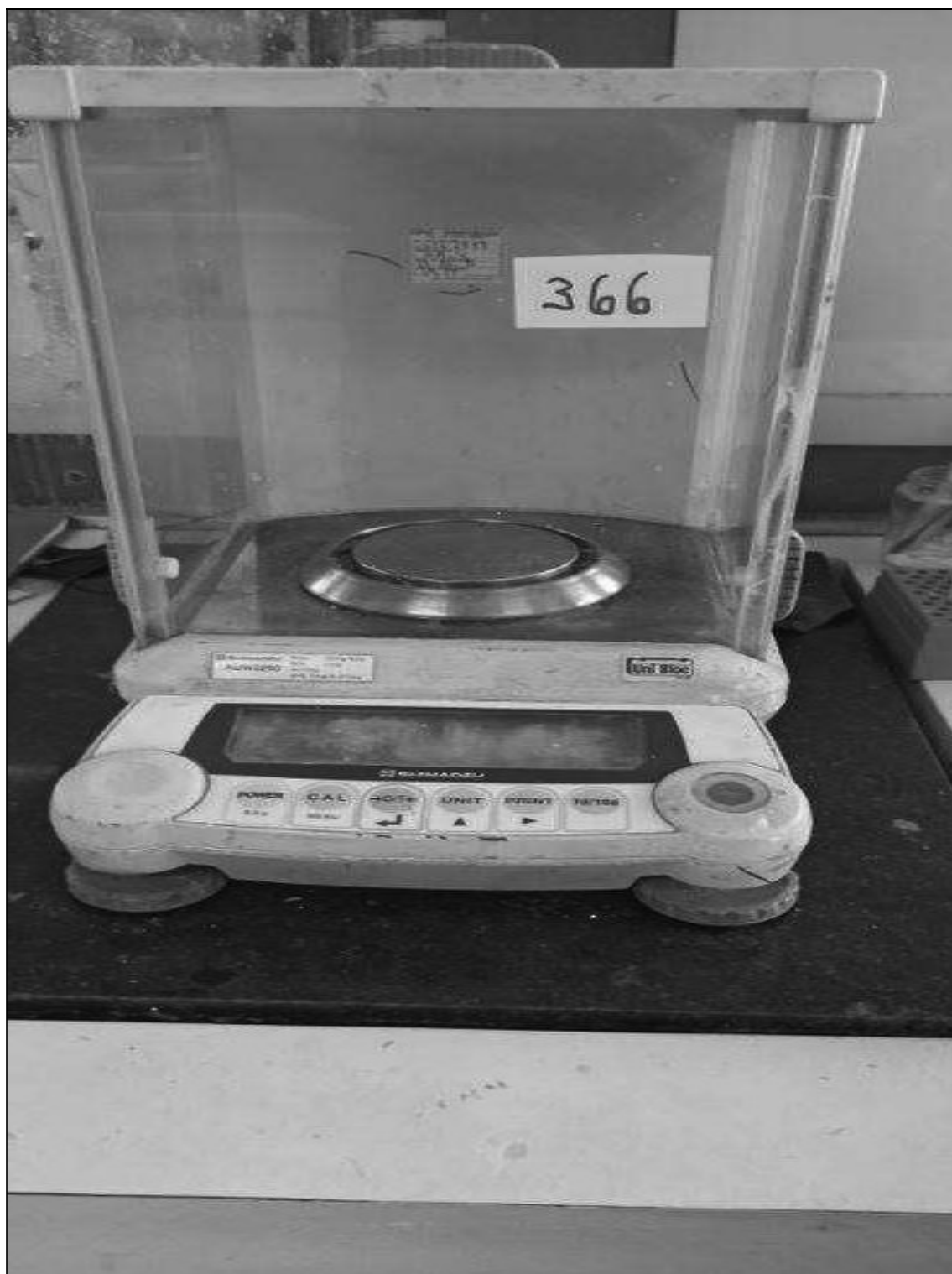
ITEM 1,109 – VISTA DA BALANCA DE PRECISAO, FAB. SHIMADZU, MOD. AUW220D, N. SERIE D450012094
