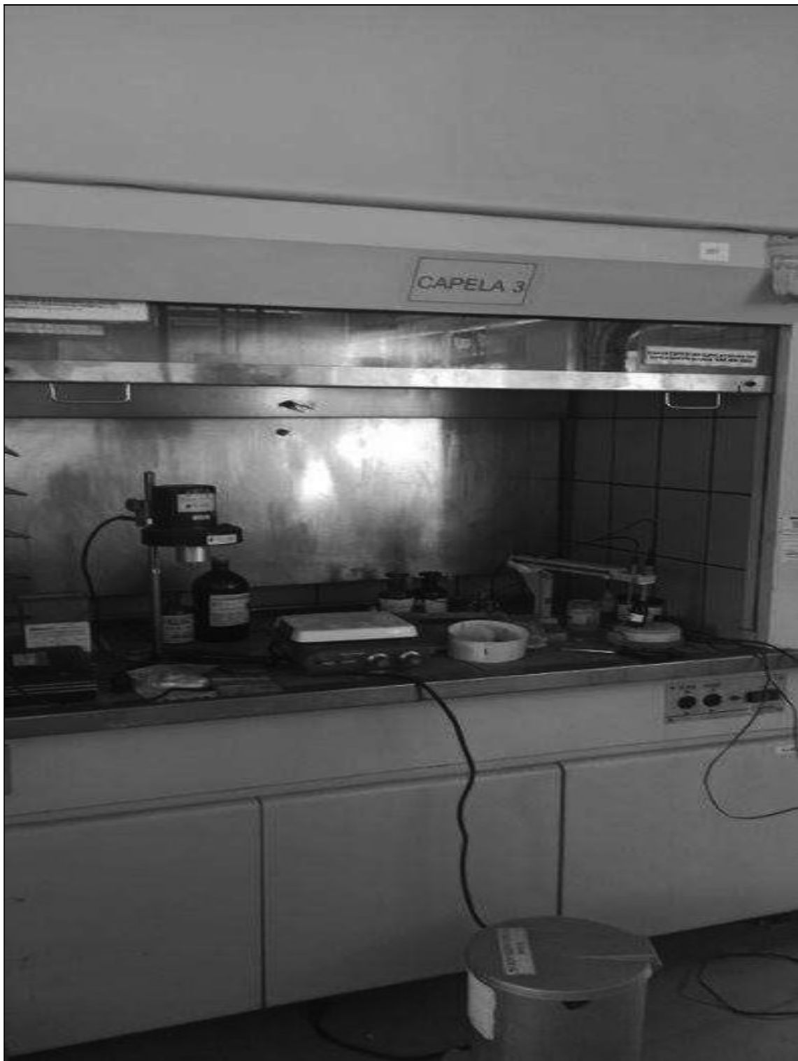
ITEM 1,123 – VISTA DA CAPELA, FAB. ENGELAB, REVEST. EM LAMINADO MELAMINICO, TAMPO EM CERAMICA, COM 1 PORTA DE VIDRO DE CORRER E 3 PORTAS DE ABRIR, DIM. 1500X800X2600 MM
