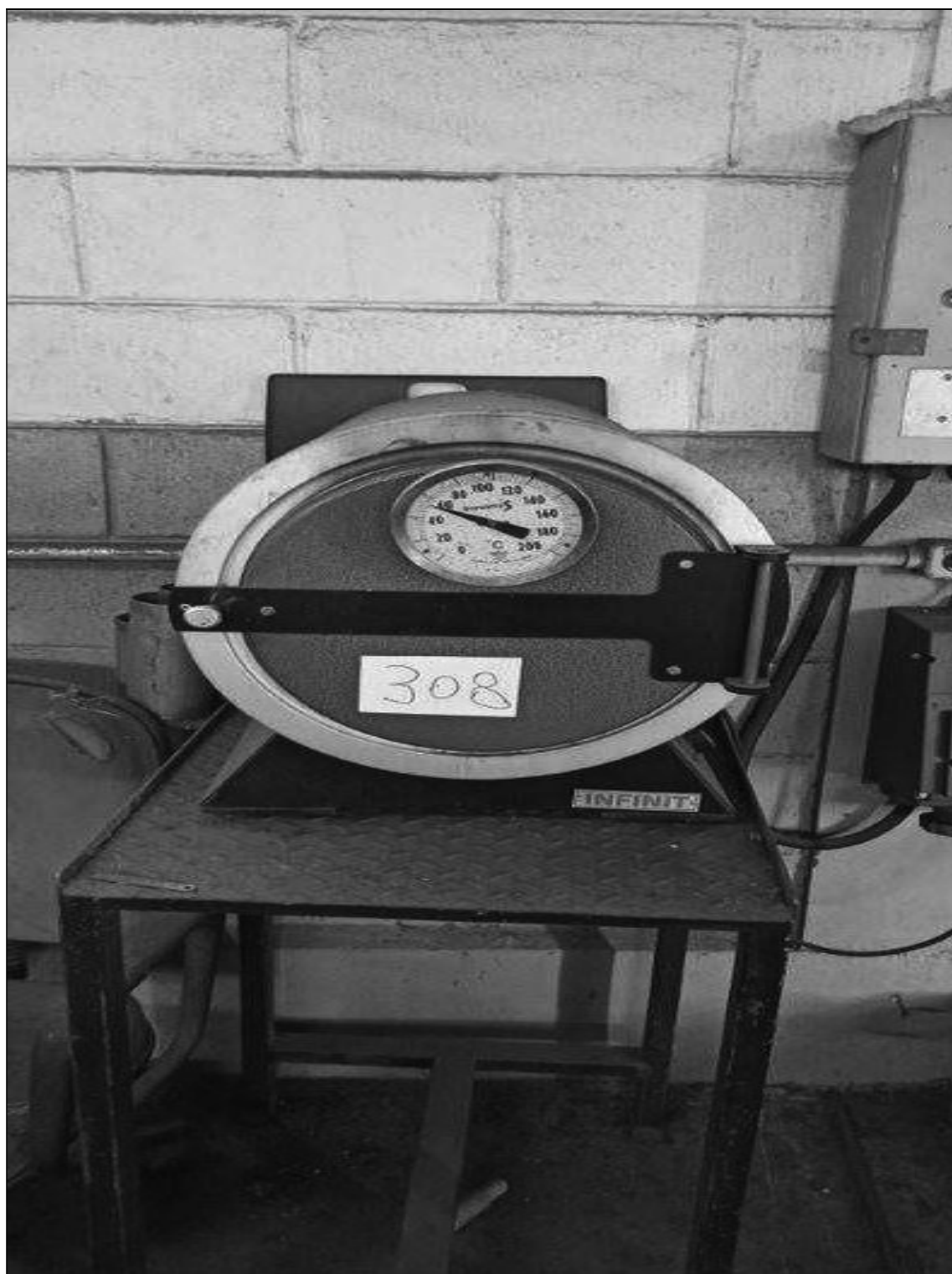
ITEM 1,100 – VISTA DA ESTUFA DE ELETRODOS, FAB. INFINIT, MOD. ER50, CAP. 50 KG
