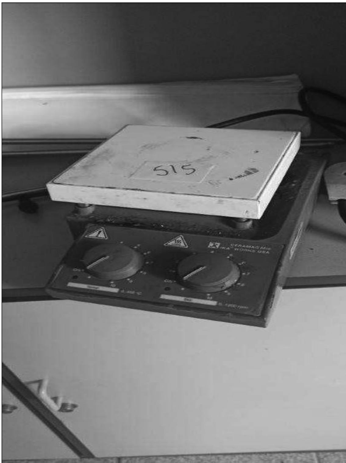
ITEM 1,163 – VISTA DO AGITADOR MAGNETICO, FAB. IKA, MOD. CERAMAG, COM AQUECIMENTO, N. SERIE 03.111607
