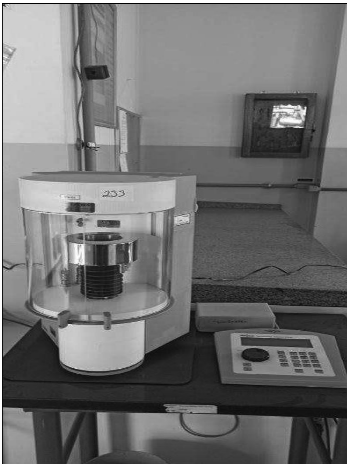
ITEM 1,068 – VISTA DO TENSIOMETRO DIGITAL, FAB. KRUSS, MOD. K11MR1, N. SERIE 20001600
