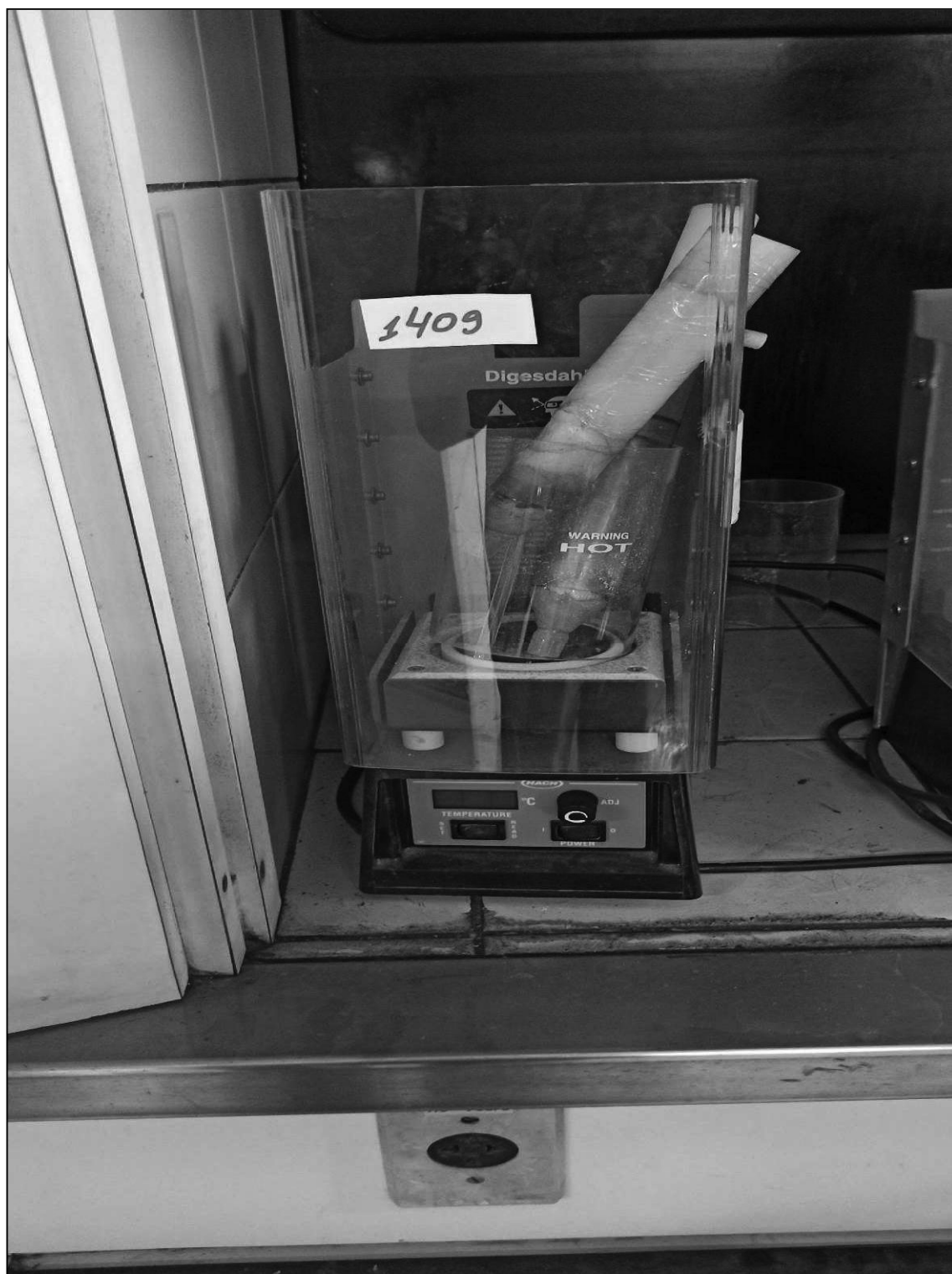
ITEM 1,257 – VISTA DO DIGESTOR DE AMOSTRA, FAB. HACH, MOD. DIGESDAHL
