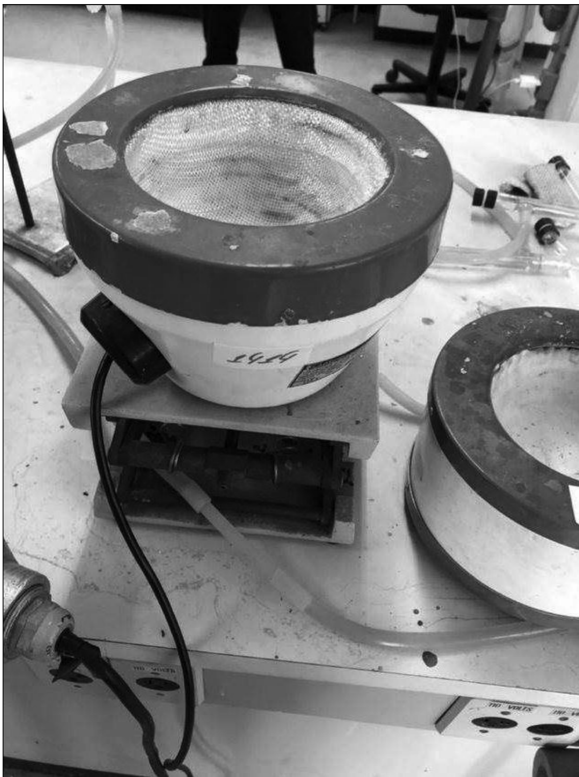
ITEM 1,262 – VISTA DA MANTA DE AQUECIMENTO, FAB. FISATON, MOD. 102
