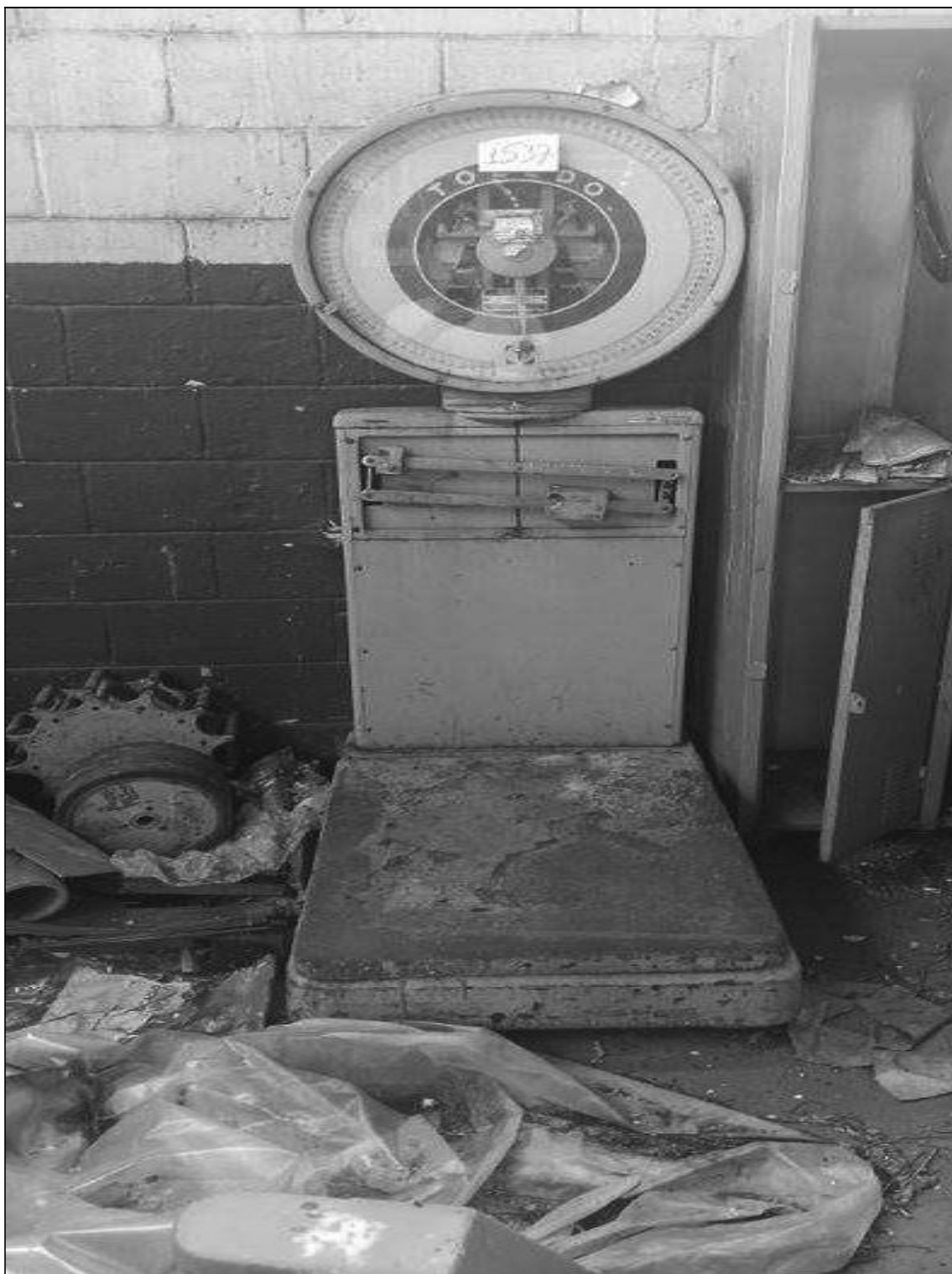
ITEM 1,020 – VISTA DA BALANCA TIPO RELOGIO, FAB. TOLEDO, MOD. 2181-FS, CARGA MAX. 150 KG, DIM. PLAT. 800 X 600 MM
