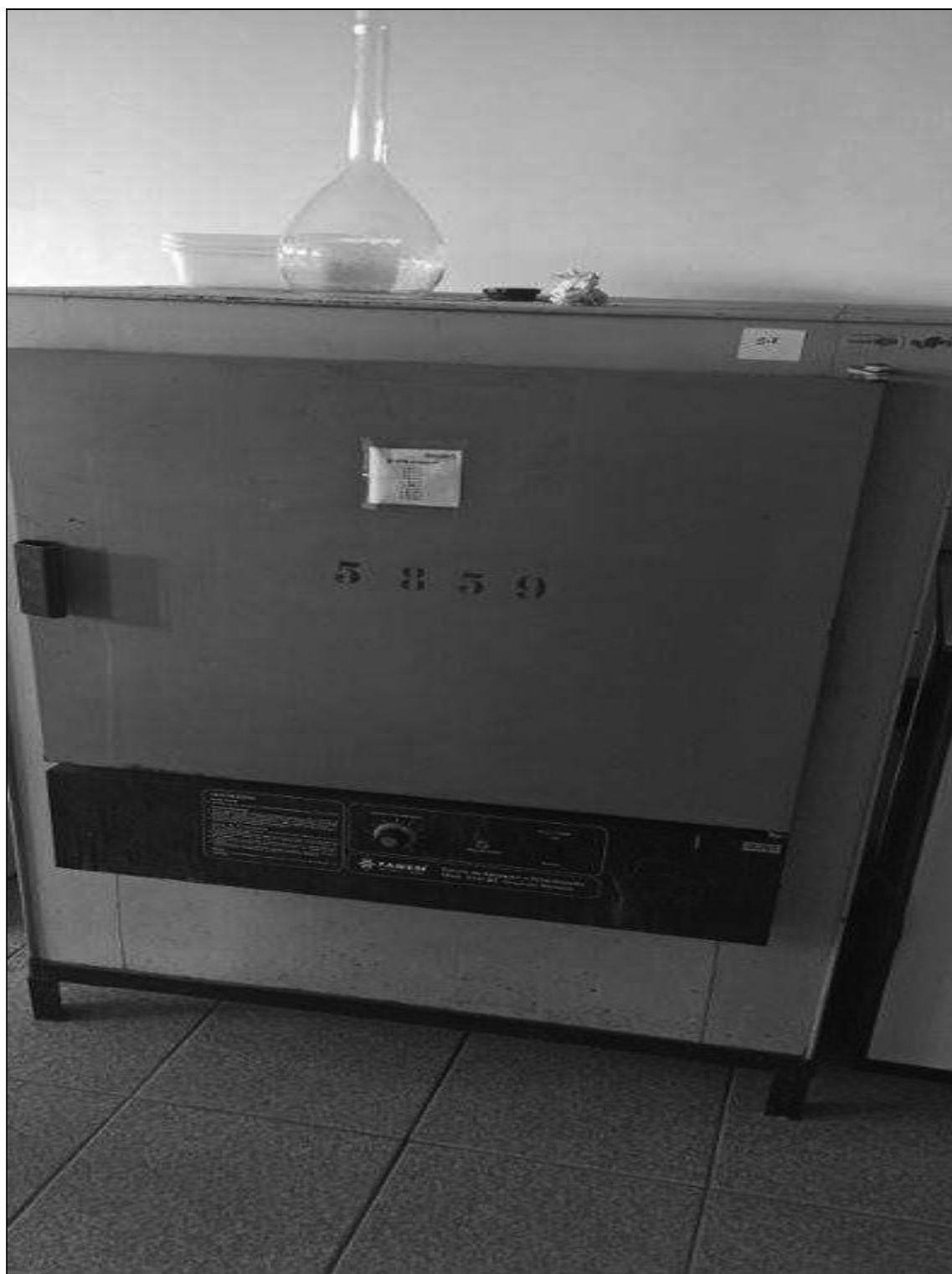
ITEM 1,166 – VISTA DA ESTUFA DE SECAGEM E ESTERILIZACAO, FAB. FANEM, MOD. 320-SE, DIM. 900X690X1240 MM
