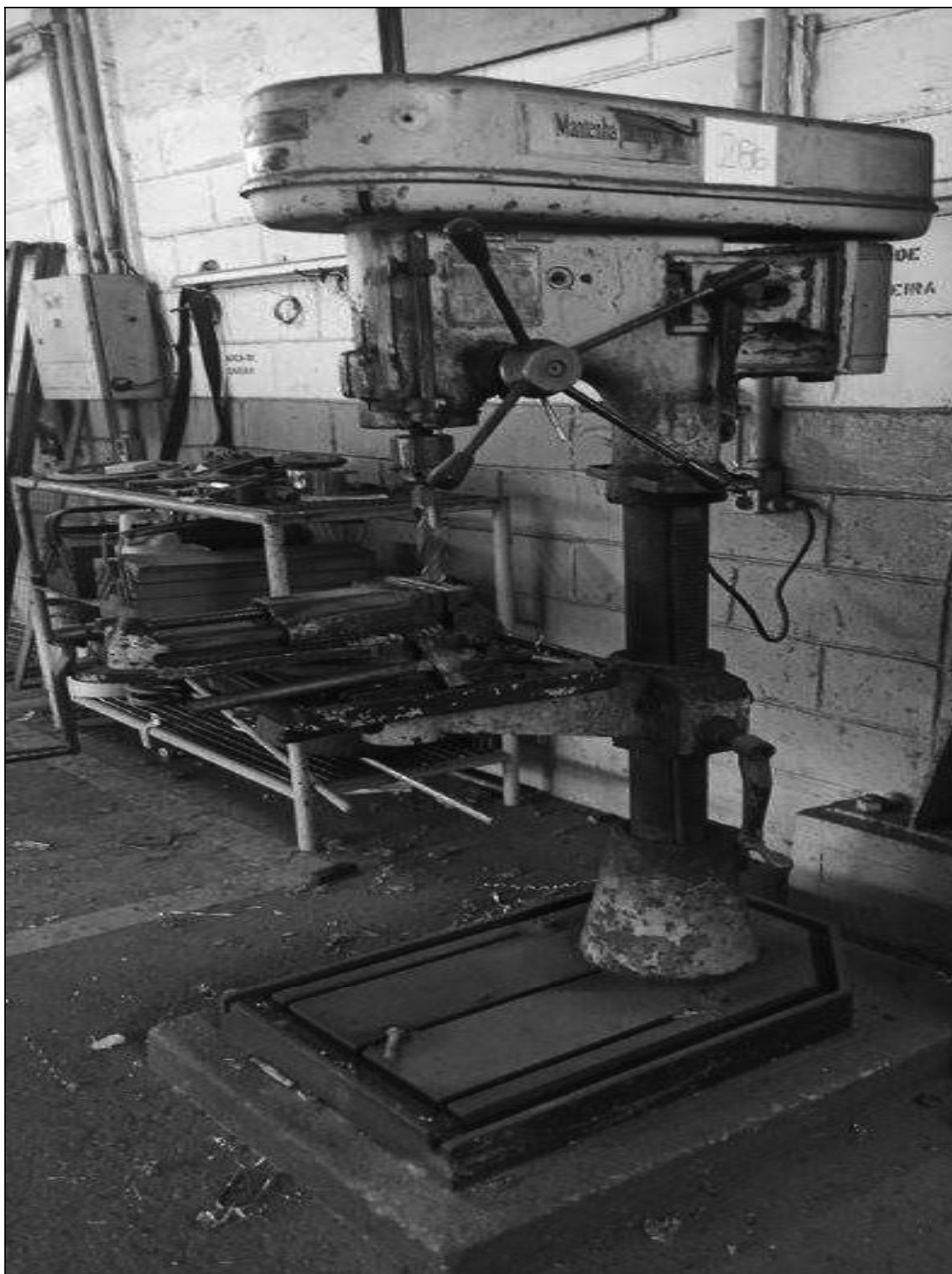
ITEM 1,087 – VISTA DA FURADEIRA DE COLUNA, FAB. KONE, MOD. K-25, CAPAC. 25 MM
