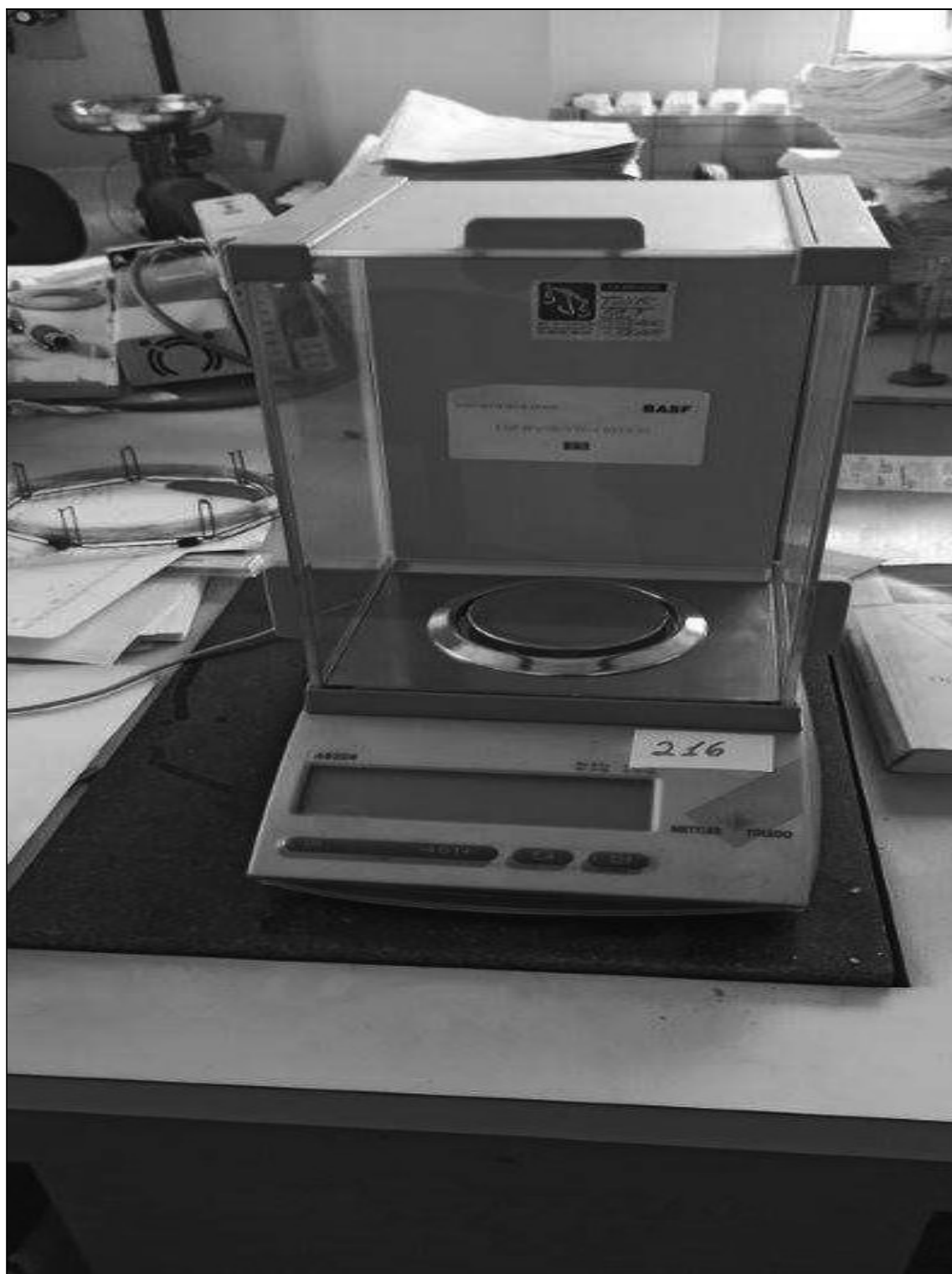
ITEM 1,058 – VISTA DA BALANCA ANALITICA, FAB. METTLER TOLEDO, MOD. AB-204
