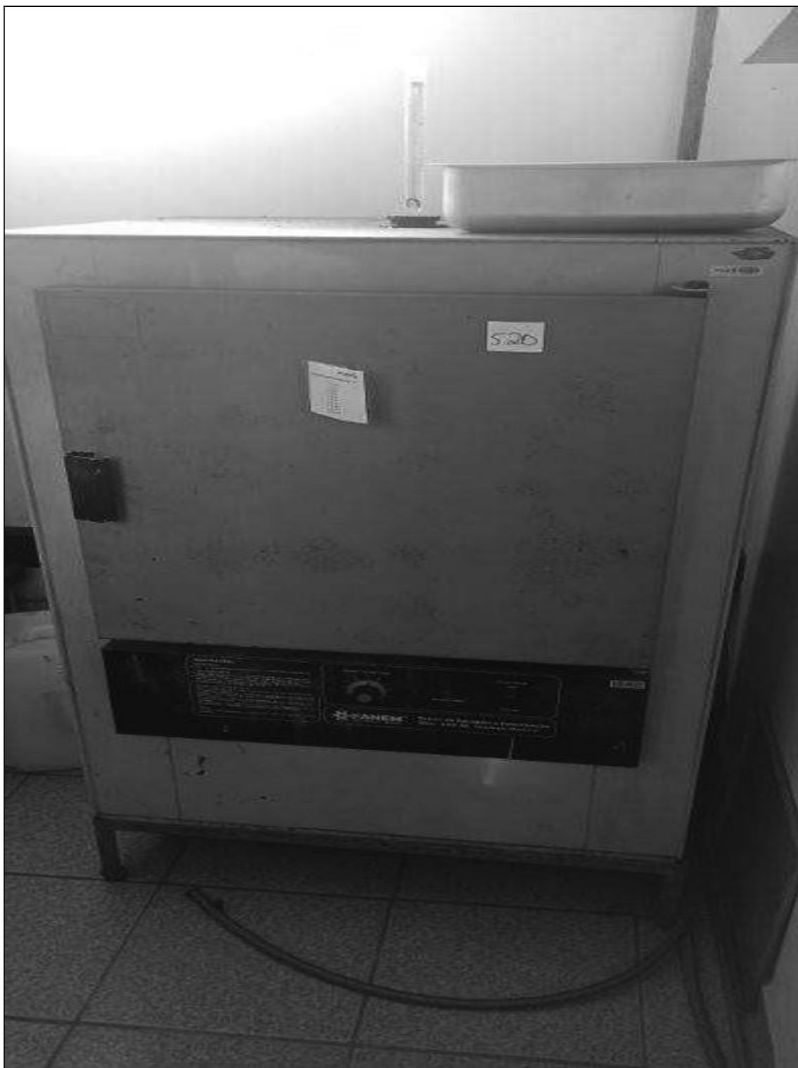
ITEM 1,168 – VISTA DA ESTUFA, FAB. FANEM, MOD. 320-SE, DIM. 750X590X1190 MM
