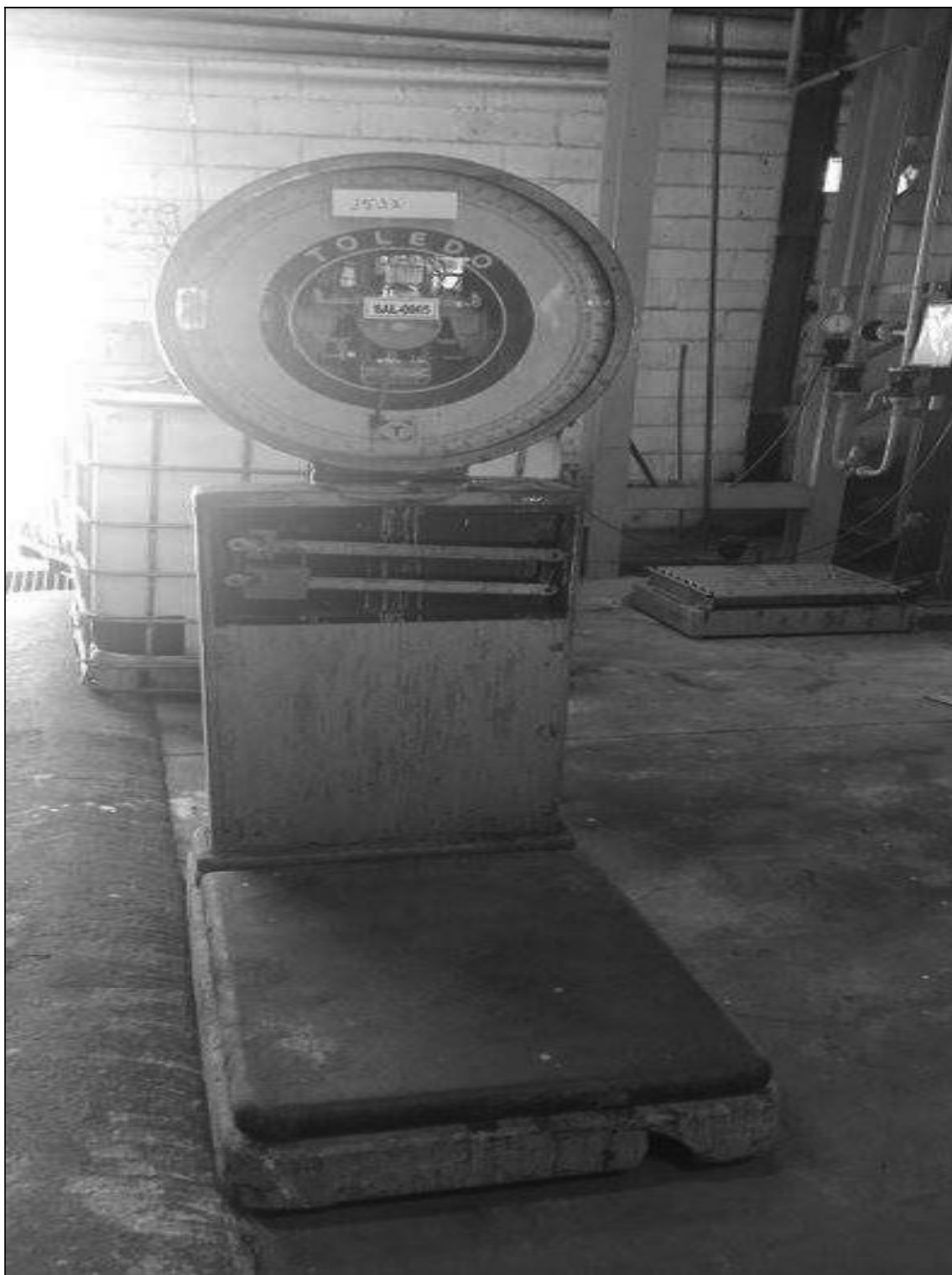
ITEM 1,005 – VISTA DA BALANCA DE PLATAFORMA, FAB. TOLEDO, MOD. 2181 FR, CARGA MAX. 375 KG, PLATAFORMA DIM. 500 X 700 MM
