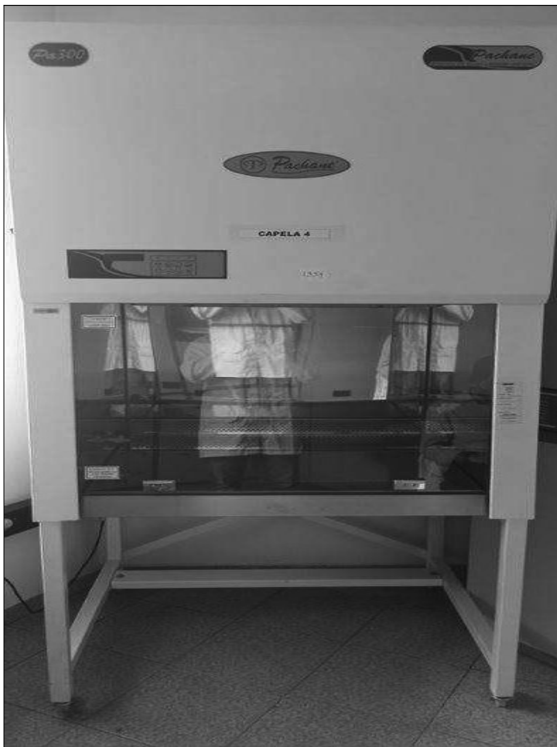
ITEM 1,203 – VISTA DA BANCADA DE FLUXO LAMINAR, FAAB. PACHANE, MOD PA300
