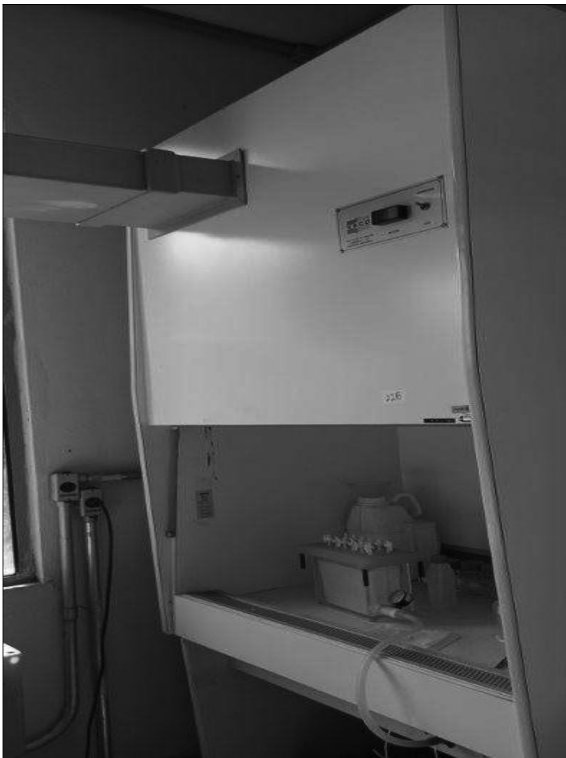
ITEM 1,065 – VISTA DA CAPELA DE MADEIRA, REVEST. EM LAMINADO MELAMINICO, 1 PORTA, DIM. 960X760X2400 MM
