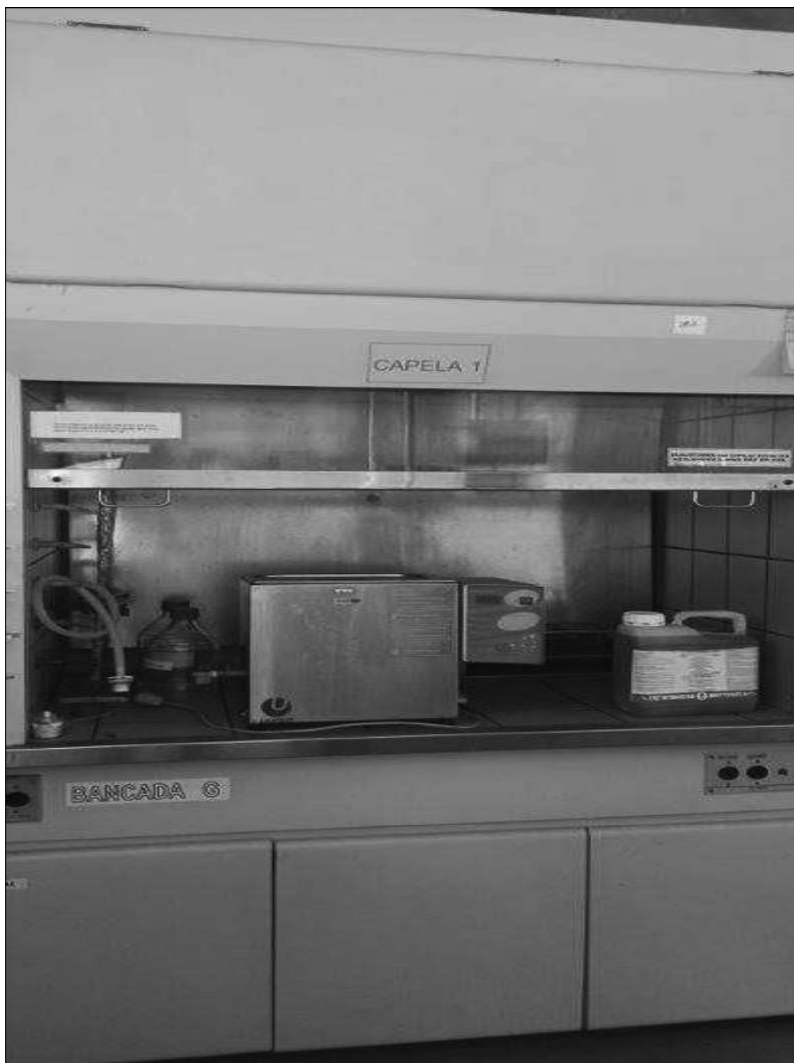
ITEM 1,121 – VISTA DA CAPELA, FAB. ENGELAB, REVEST. EM LAMINADO MELAMINICO, TAMPO EM CERAMICA, COM 1 PORTA DE VIDRO DE CORRER E 3 PORTAS DE ABRIR, DIM. 1500X800X2600 MM
