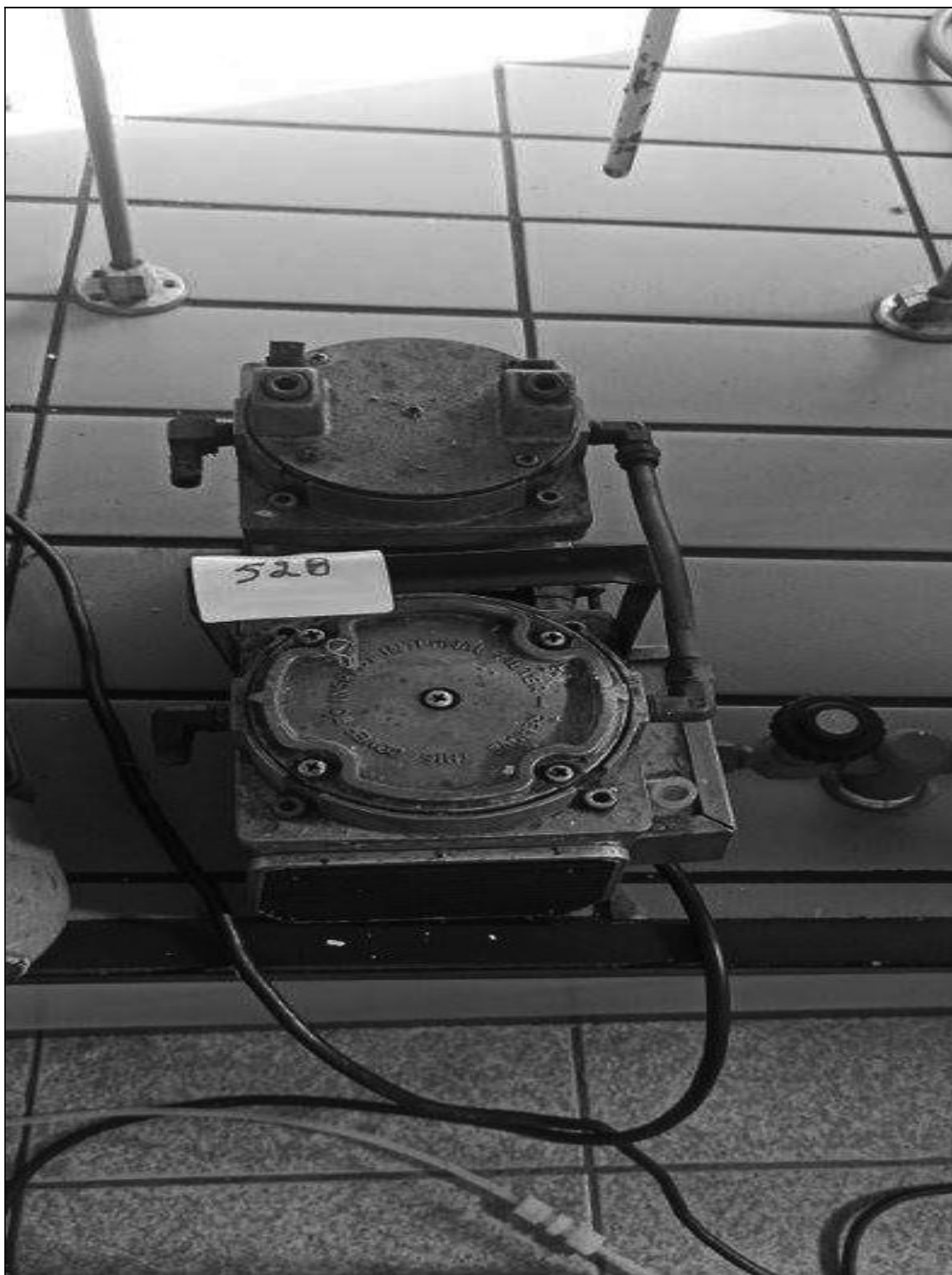
ITEM 1,176 – VISTA DA BOMBA DE VACUO, FAB. GAST, MOD. DAA-V175-B, N. SERIE 1102956235
