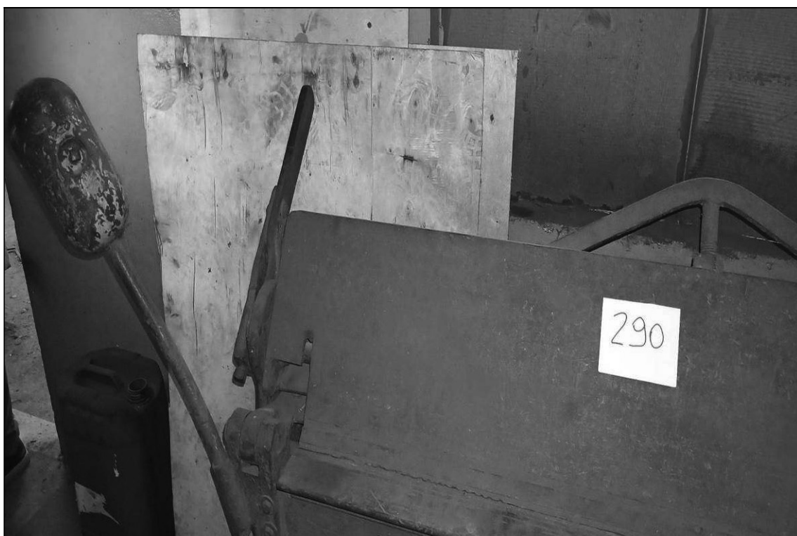
ITEM 1,091 – VISTA DA DOBRADORA DE CHAPAS, ACION. PEDAL, CAPAC. 1500X2 MM
