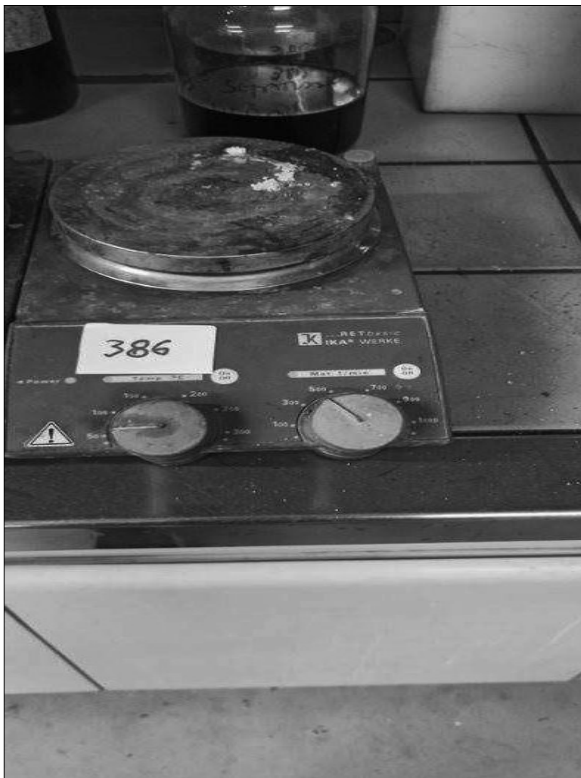
ITEM 1,125 – VISTA DO AGITADOR MAGNETICO, FAB. IKA, MOD. RET-BASIC, COM AQUECIMENTO
