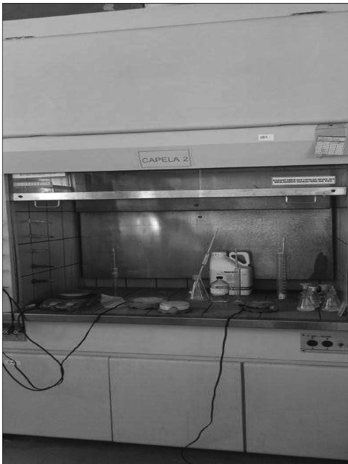
ITEM 1,122 – VISTA DA CAPELA, FAB. ENGELAB, REVEST. EM LAMINADO MELAMINICO, TAMPO EM CERAMICA, COM 1 PORTA DE VIDRO DE CORRER E 3 PORTAS DE ABRIR, DIM. 1500X800X2600 MM
