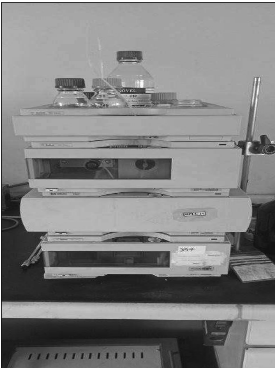
ITEM 1,132 – VISTA DO HPLC, FAB. HP, MOD. 1100 SERIES, DEGASSER MOD. G1311A, NUM SERIE JP72106730, COM QUATPUMP MOD. G1311A, NUM. SERIE US72102198, COM COLCOMP MOD. G1316A, NUM. SERIE US72102579, COM VWD MOD. G1314A, NUM. SERIE JP33321464
