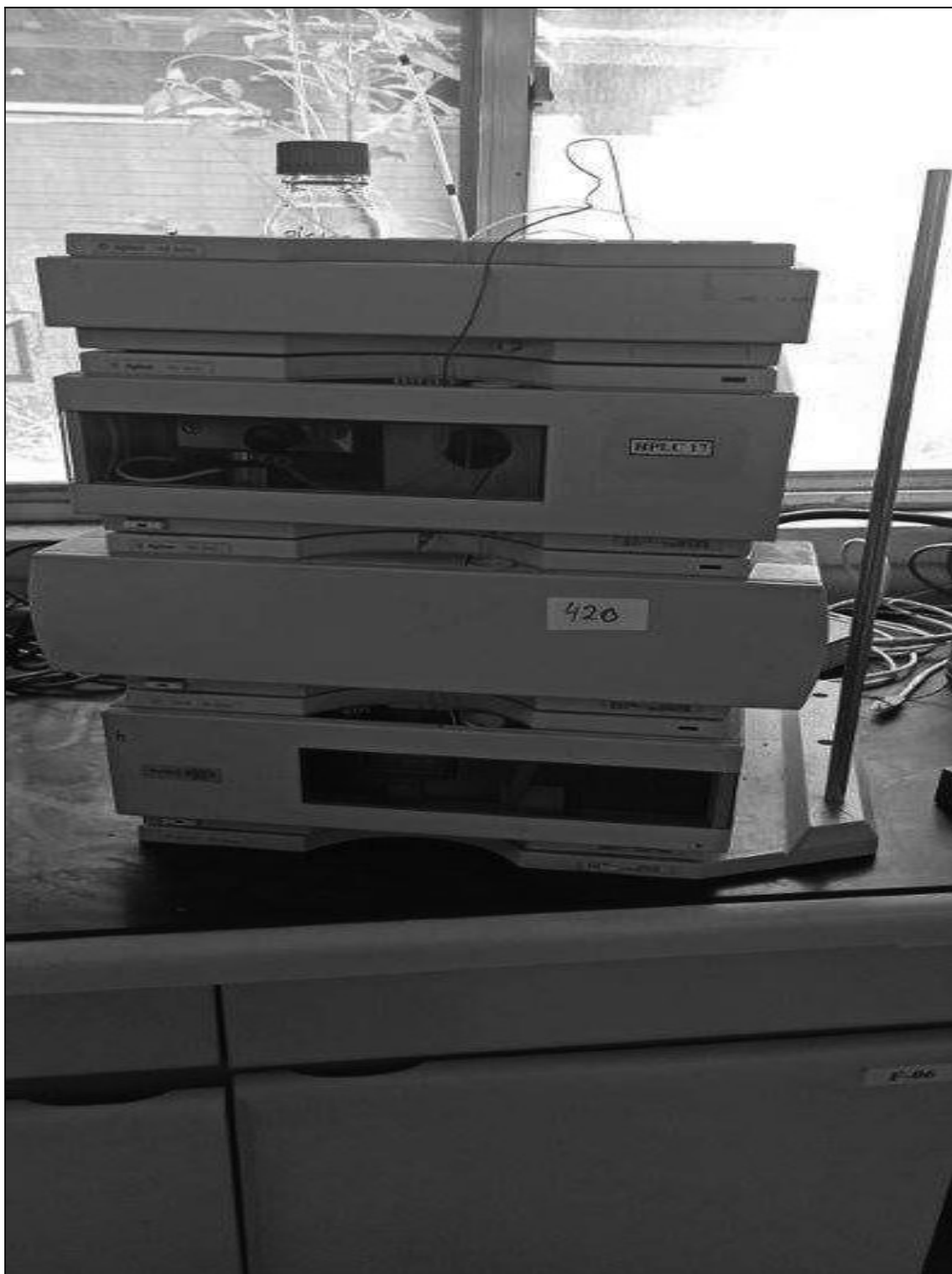
ITEM 1,138 – VISTA DO HPLC, FAB. AGILENT, MOD. 1100 SERIES, ISO PUMP MOD. G1310A, NUM. SERIE DE91602657, COM COLCAM MOD. 61316A, NUM. SERIE DE03015794, COM VWD NUM. SERIE JP92111923
