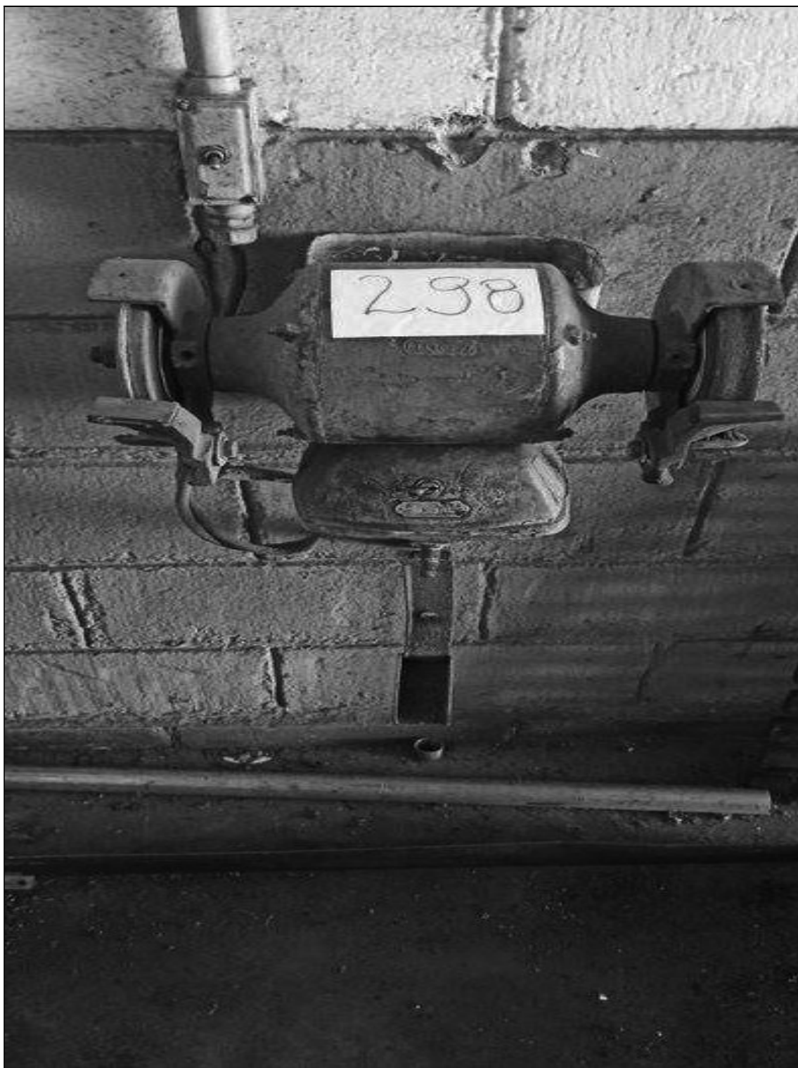
ITEM 1,098 – VISTA DA MOTO ESMERIL DE DUPLO REBOLO, MOTOR ELETRICO POT. 1,0 CV
