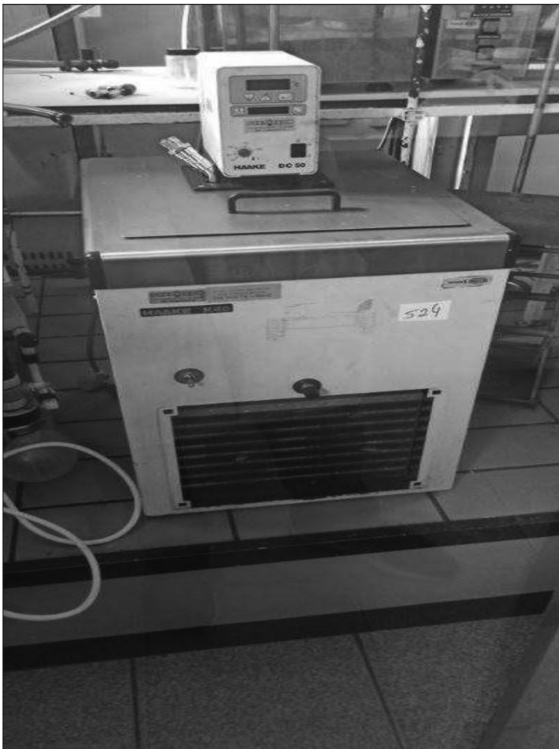
ITEM 1,172 – VISTA DO BANHO ULTRA TERMOSTATIZADO, FAB. HAAKE, MOD. K40
