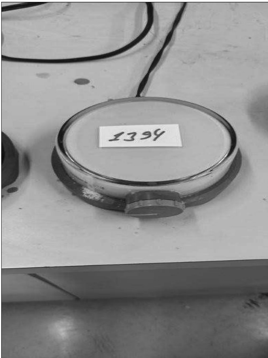
ITEM 1,243 – VISTA DO AGITADOR MAGNETICO, FAB. IKA, MOD. COLOR SQUID, DIAM. 200 MM, N. SERIE 3.209.027
