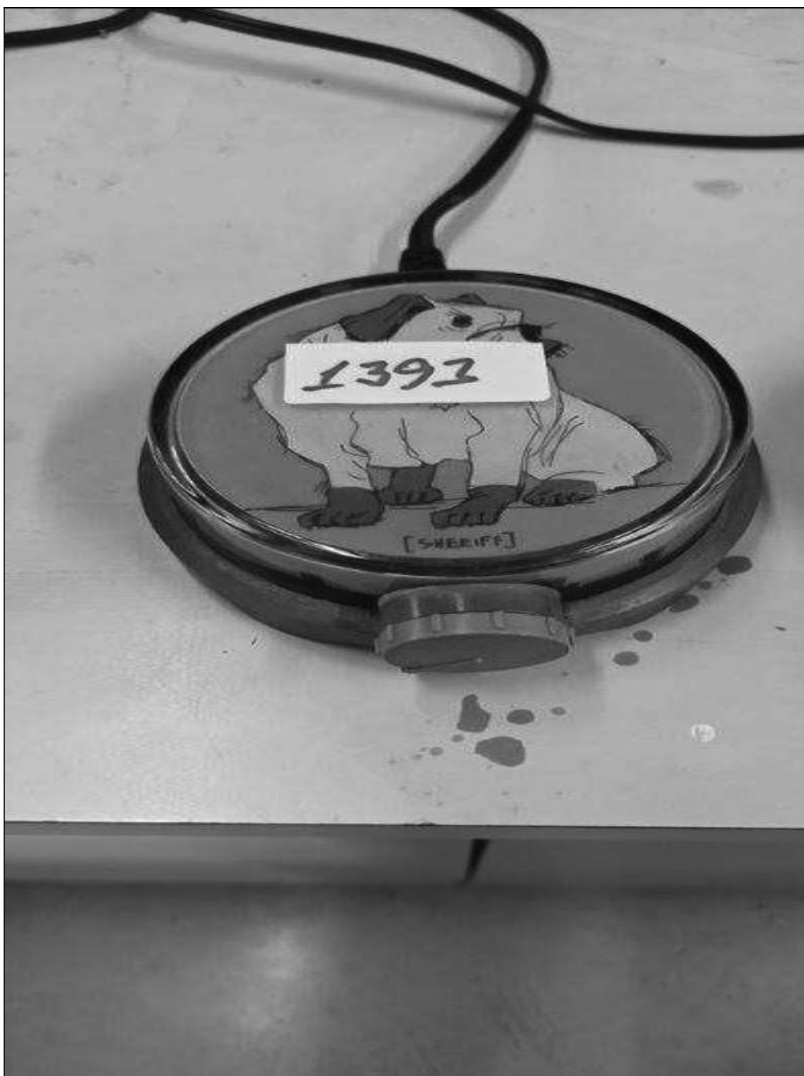
ITEM 1,242 – VISTA DO AGITADOR MAGNETICO, FAB. IKA, MOD. COLOR SQUID, DIAM. 200 MM, N. SERIE 3.209.027
