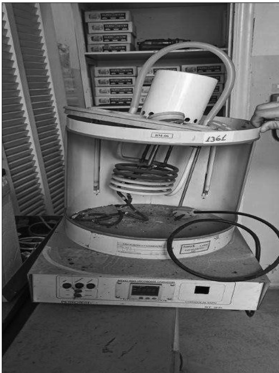
ITEM 1,210 – VISTA DO BANHO PARA VISCOSIDADE CINEMATICA, FAB. PETROTEST, MOD. ST25
