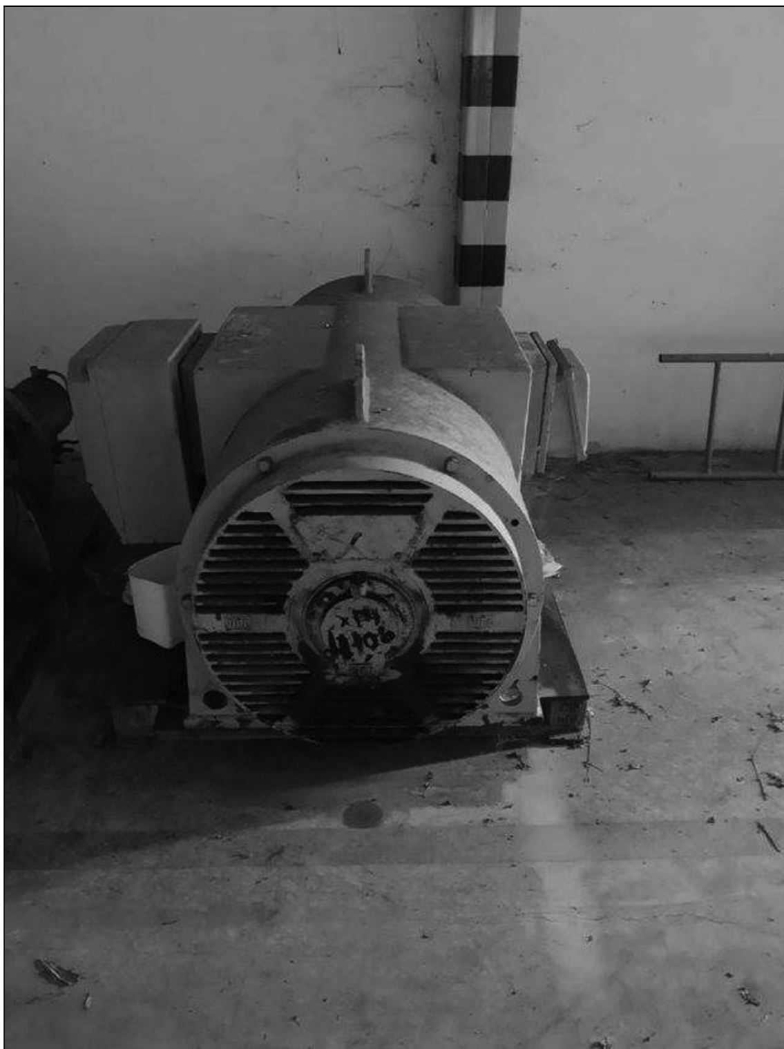
ITEM 1,044 – VISTA DO MOTOR DE INDUCAO TRIFASICO, FAB. WEG, 600 CV - 3557 RPM
