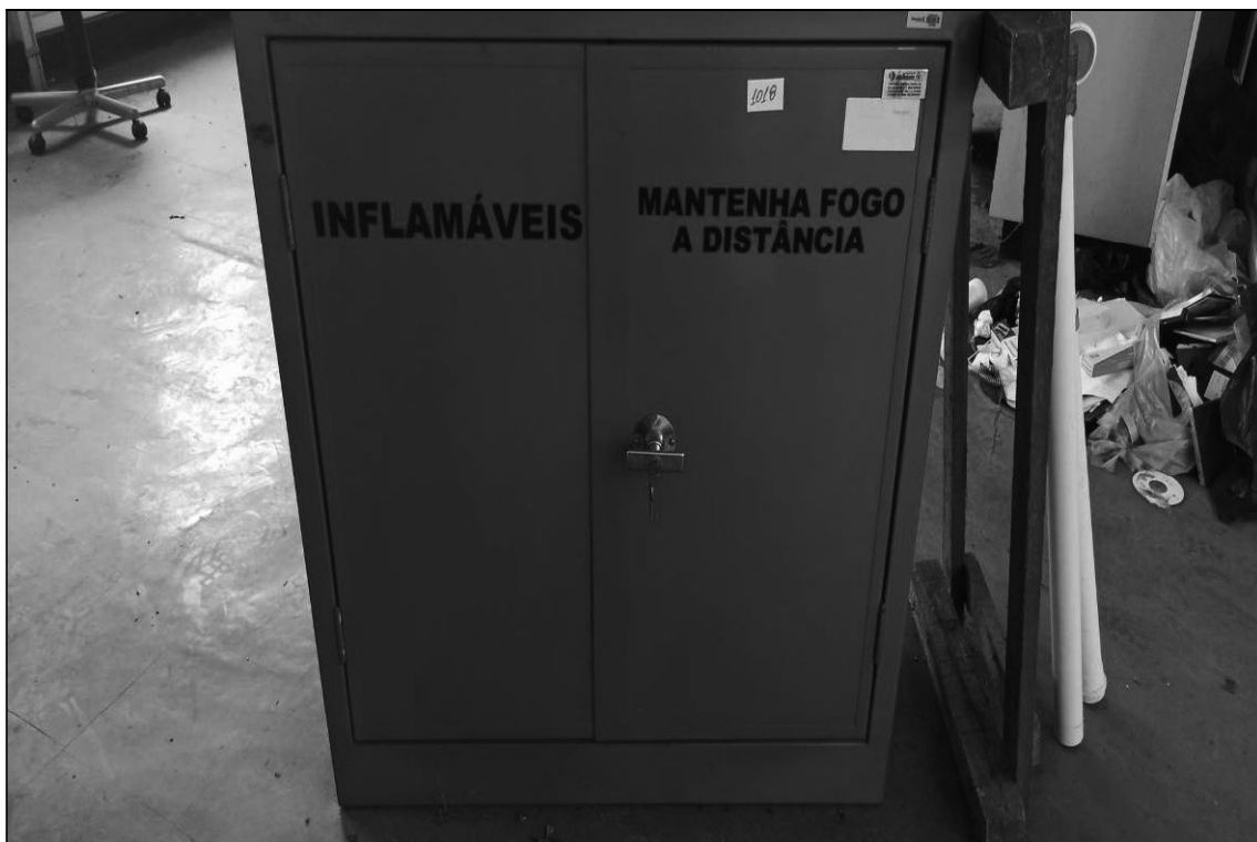
ITEM 1,179 – VISTA DO ARMARIO CORTA FOGO, EM ACO, 2 PORTAS, DIM. 1,00 X 0,50 X 1,00 M
