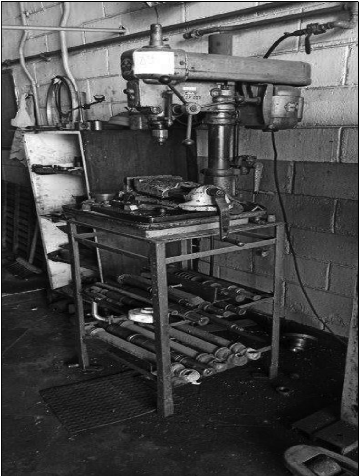
ITEM 1,095 – VISTA DA FURADEIRA DE BANCADA, FAB. WALKER TURNER, AVANCO 100 MM
