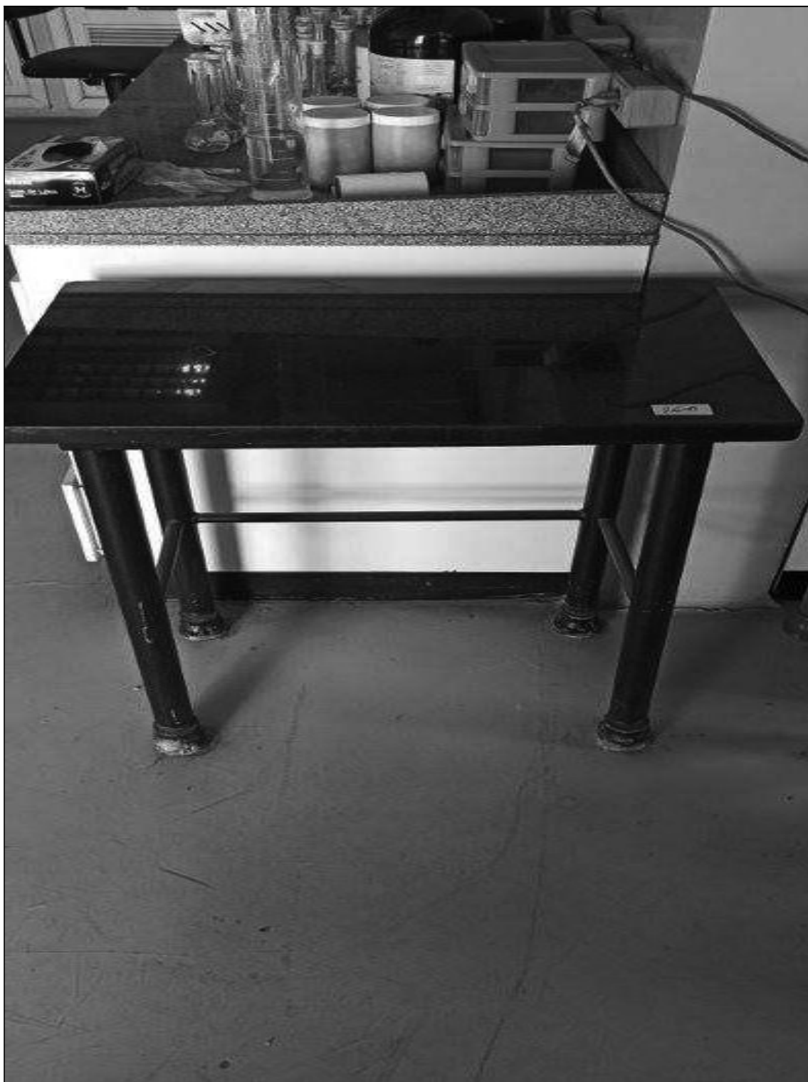
ITEM 1,081 – VISTA DA BANCADA DE ACO, TAMPO EM GRANITO, DIM. 700X450X860 MM
