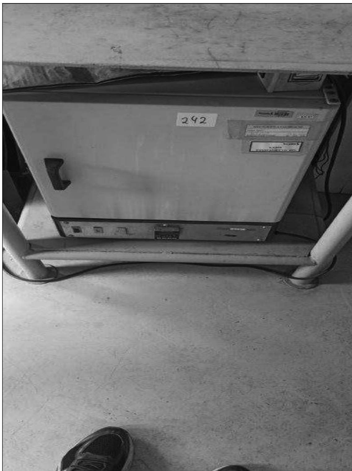
ITEM 1,075 – VISTA DA ESTUFA DE SECAGEM, FAB. ABIMO, DIM. 420X430X530 MM
