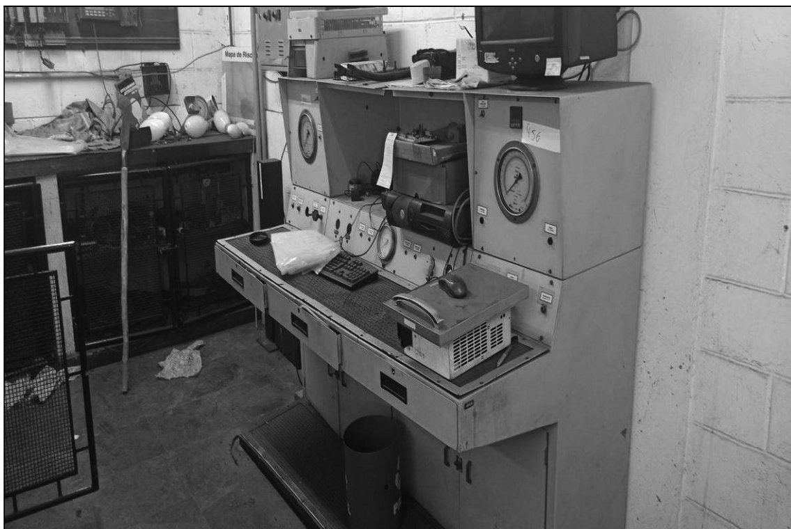
ITEM 1,150 – VISTA DA BANCADA DE TESTES DE INSTRUMENTAÇÃO, MAT. AÇO, COM 2 MANOMETROS, DIM. 1800X900X1400 MM
