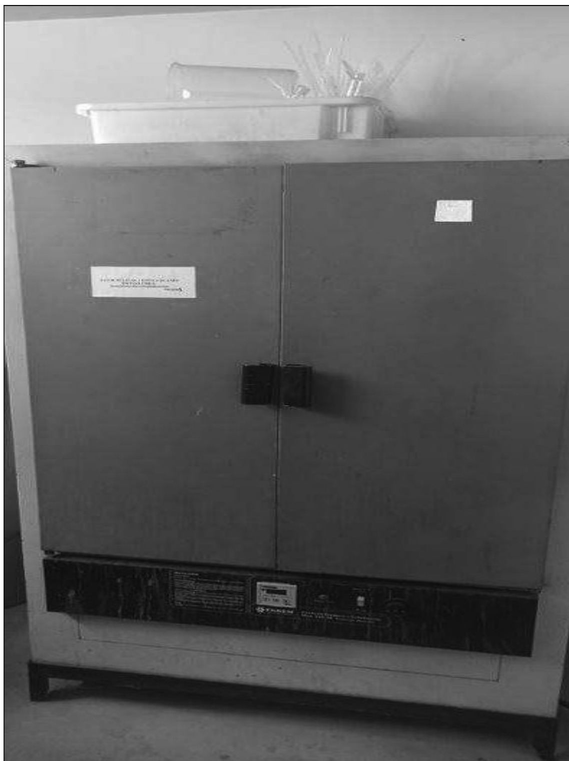
ITEM 1,114 – VISTA DA ESTUFA, FAB. FANEM, MOD. 320-SE, DIM. 1050X760X1680 MM
