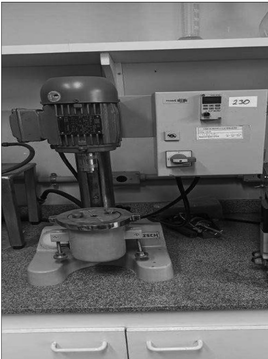
ITEM 1,066 – VISTA DO MOINHO, FAB. NETZSCH, MOD. PE075, ACIONAM. MOTOR ELETRICO, FABR. WEG, CAPAC. 0,5 CV - 1720RPM
