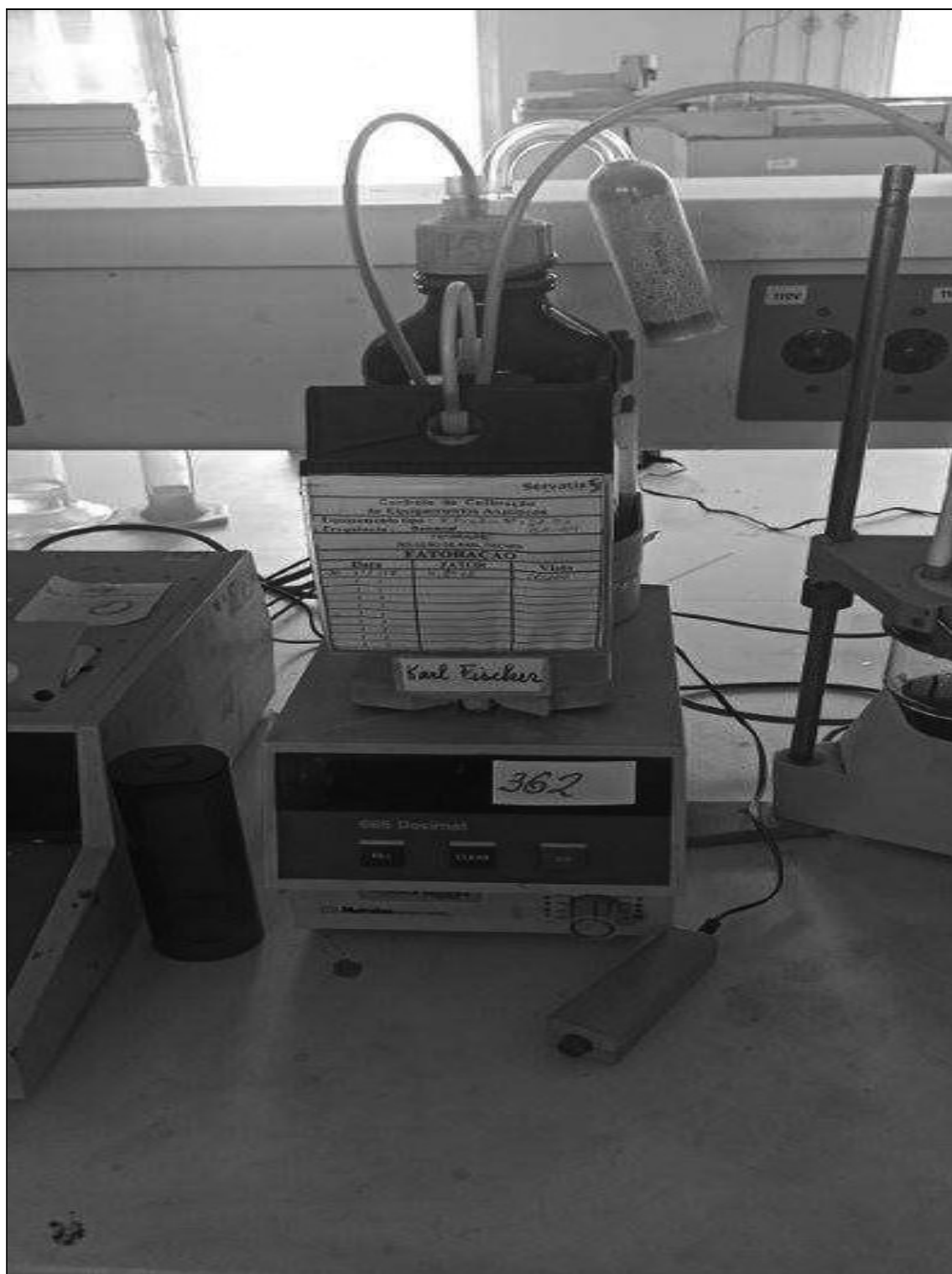
ITEM 1,107 – VISTA DO DOSIMAT, FAB. METROHM, MOD. 665 DOSIMAT, N. SERIE 8P5/193
