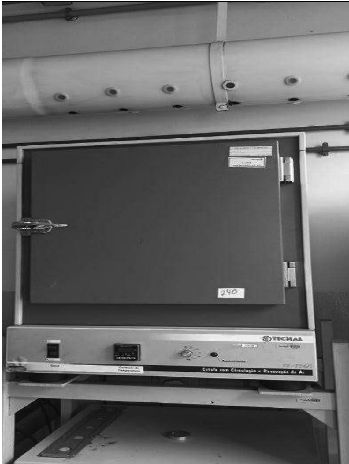
ITEM 1,073 – VISTA DA ESTUFA, FAB. TECNAL, MOD. TE-394/1, DIM. 600X460X780 MM
