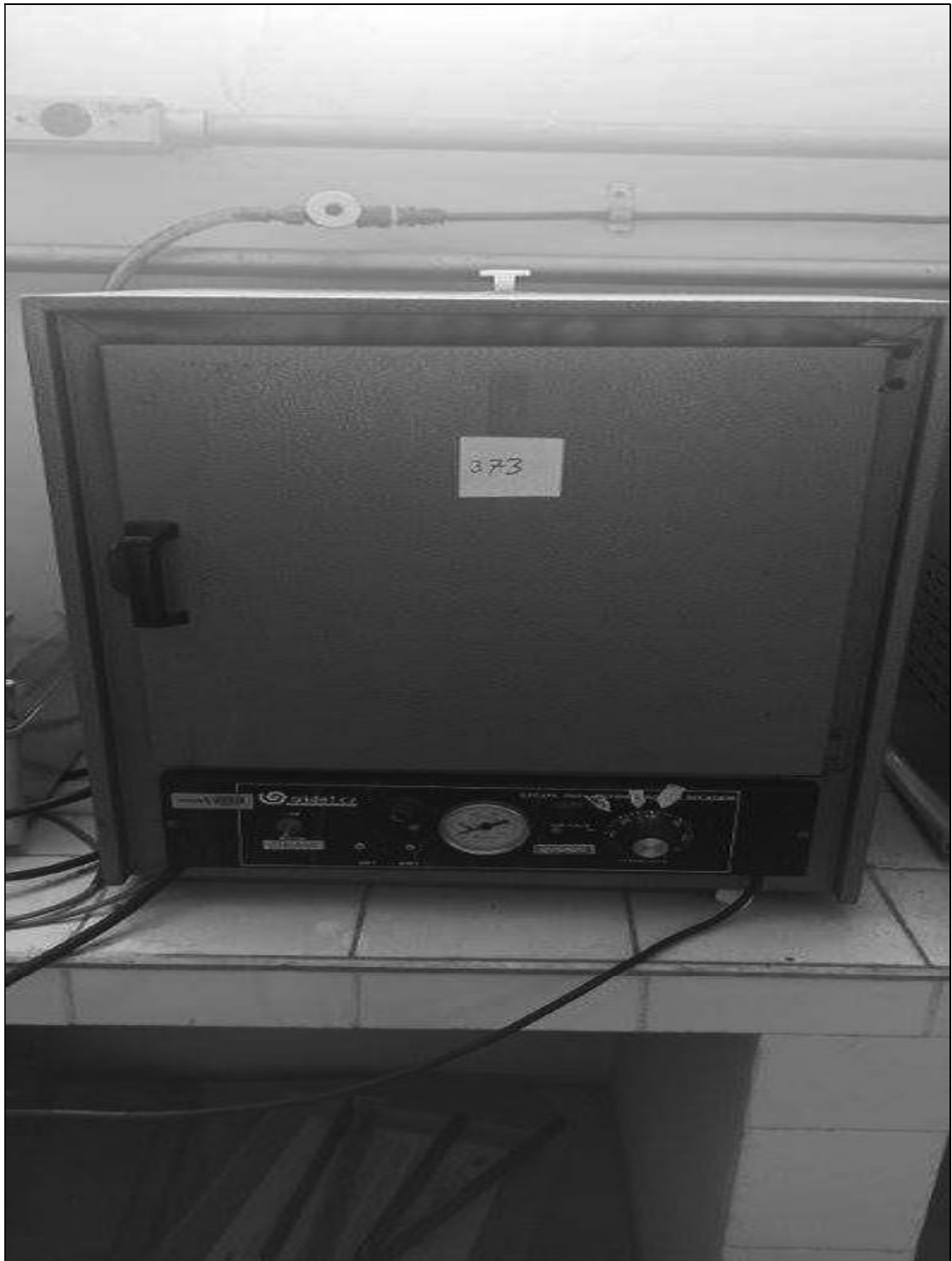
ITEM 1,115 – VISTA DA ESTUFA, FAB. OLIDEF, MOD. CZ, DIM. 430X380X540 MM
