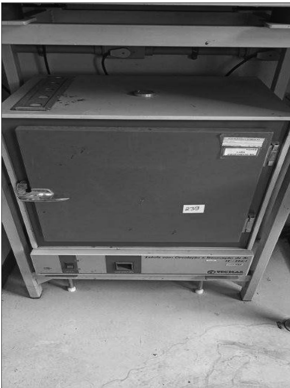
ITEM 1,072 – VISTA DA ESTUFA, FAB. TECNAL, MOD. TE-394/1, DIM. 600X460X780 MM
