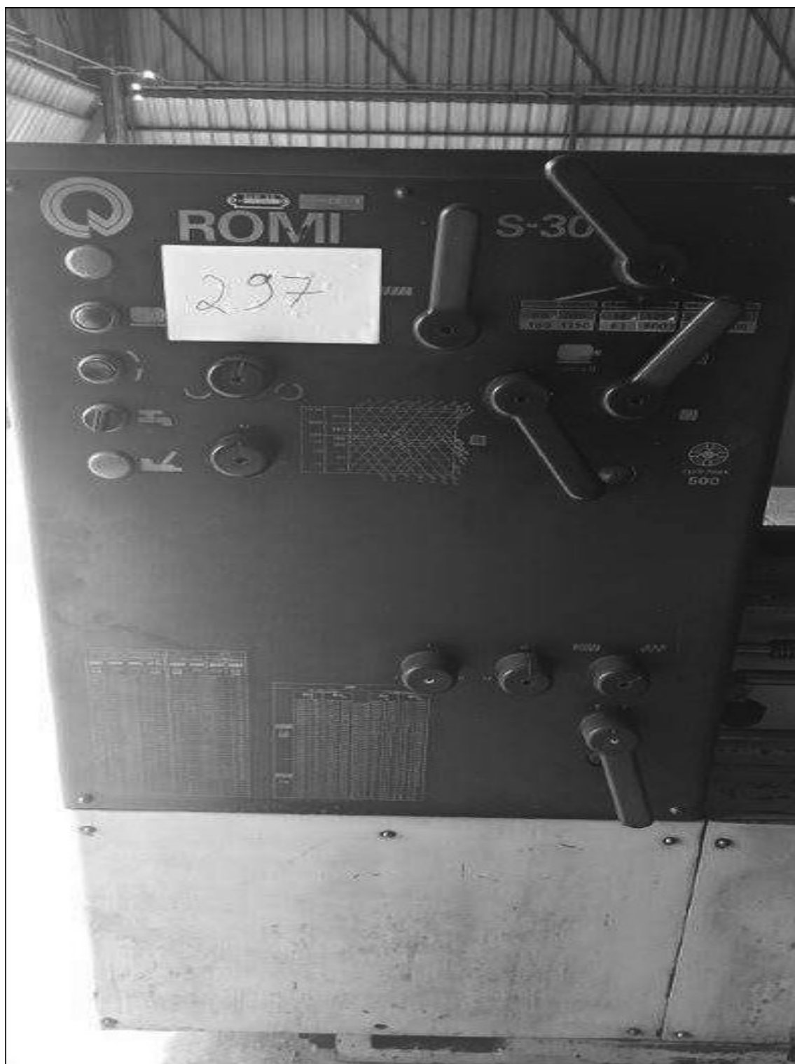
ITEM 1,097 – VISTA DO TORNO MECANICO, FAB. ROMI, MOD. S30, DIAM. 500X3000 MM
