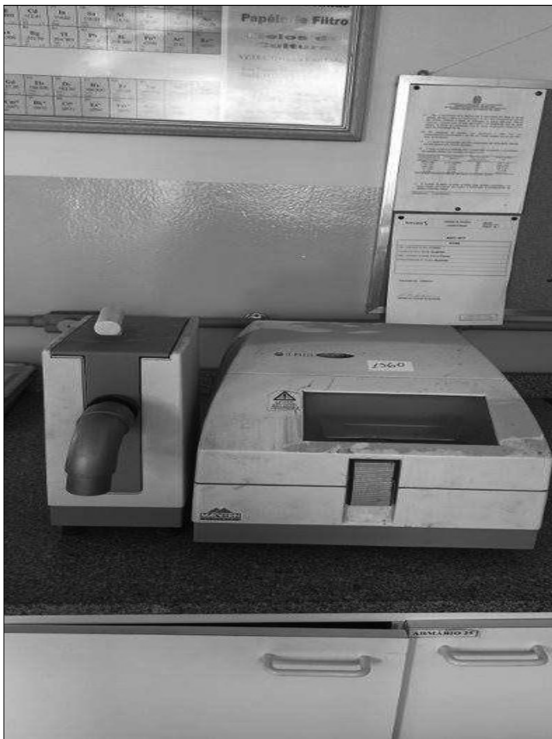
ITEM 1,209 – VISTA DO ANALISADOR DE TAMANHO DE PARTICULAS, FAB. MALVERN, MOD. ADA2000
