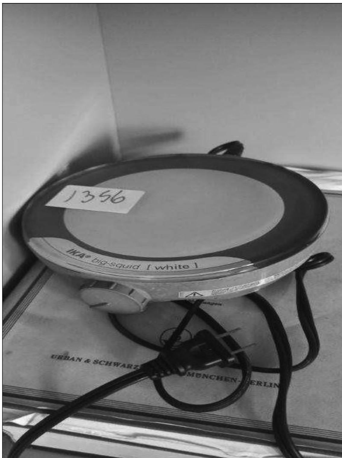
ITEM 1,205 – VISTA DO AGITADOR MAGNETICO, FAB. IKA, MOD. BIG SQUID, DIAM. 200 MM, N. SERIE 3.209.027
