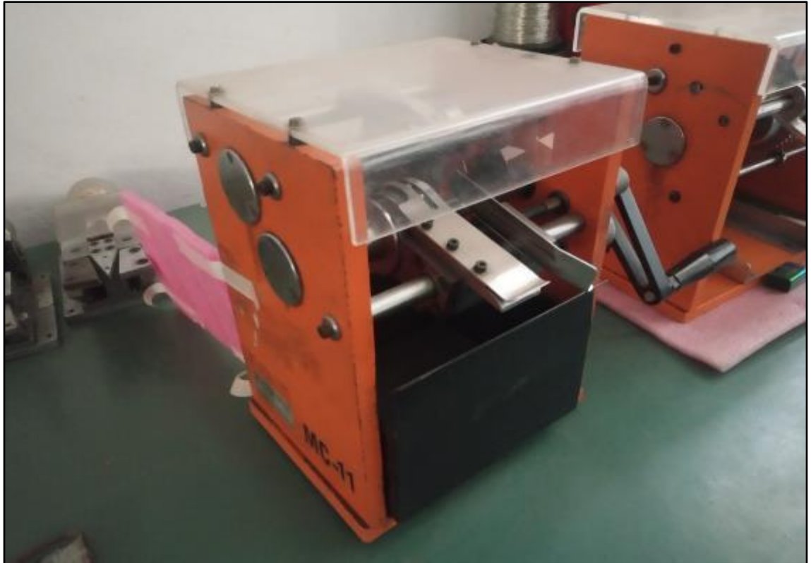
ITEM 1,040 - VISTA DA PREFORMADORA MANUAL OMTEC MC 11
