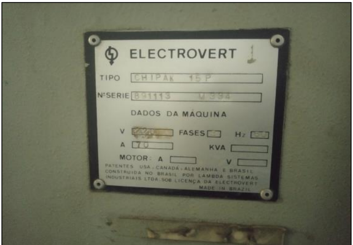
ITEM 1,011 - VISTA DA PLACA DE IDENTIFICAÇÃO DO SISTEMA DE SOLDA POR ONDA ELECTROVERT ECONOPACK CHIPAK 15P SÉRIE: 891113 M333
