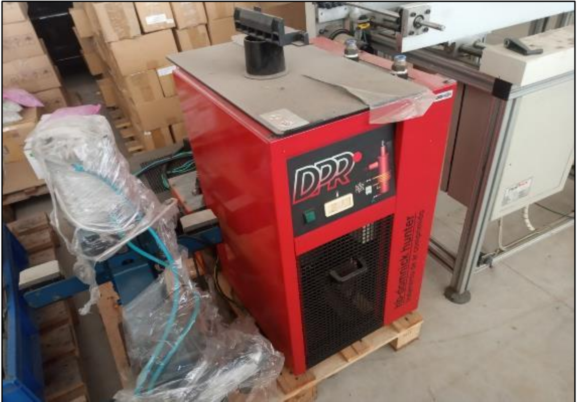
ITEM 1,025 - VISTA DO TRATAMENTO DE AR COMPRIMIDO HB DOMNICK HUNTER DPR 0020 SÉRIE: 101333/05
