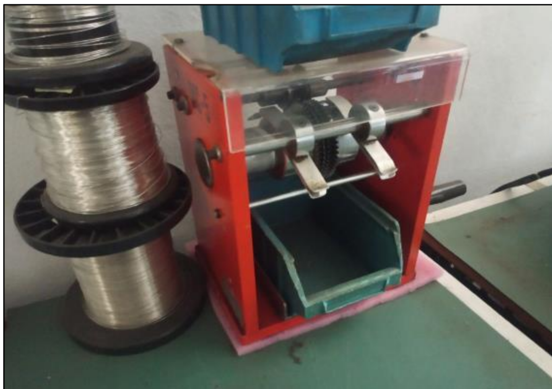
ITEM 1,042 - VISTA DA PREFORMADORA DE COMPONENTES AXIAIS OMTEC MC 5
