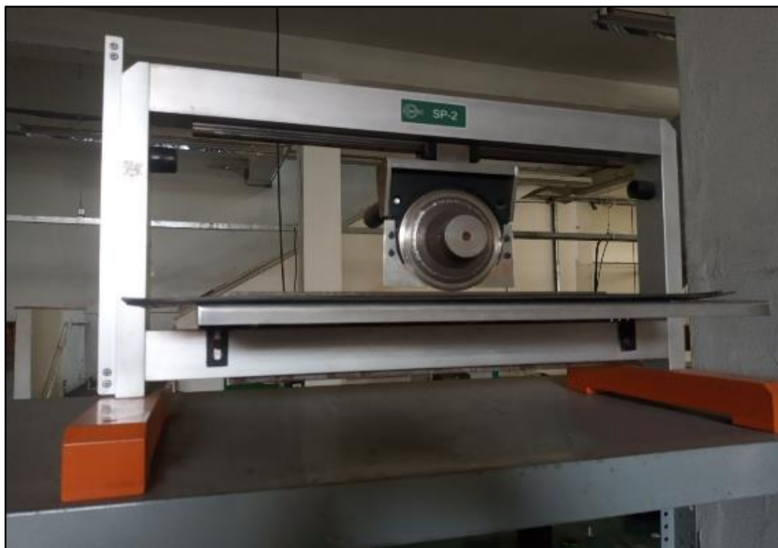
ITEM 1,029 - VISTA DO SEPARADOR MANUAL DE PLACAS DE CIRCUITO INTERNO OMTEC SP2
