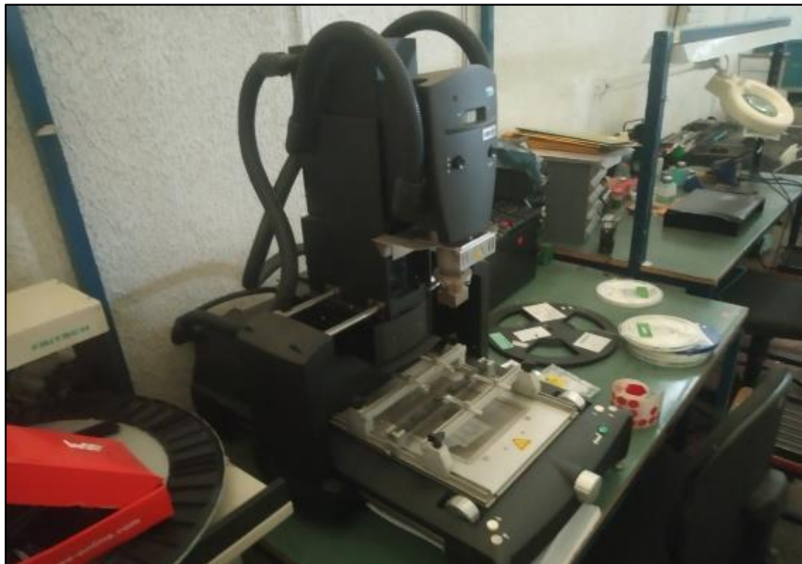
ITEM 1,015 - VISTA DO SISTEMA DE RETRABALHO DE PLACA IMPRESSA OKI APR 500 DZ
