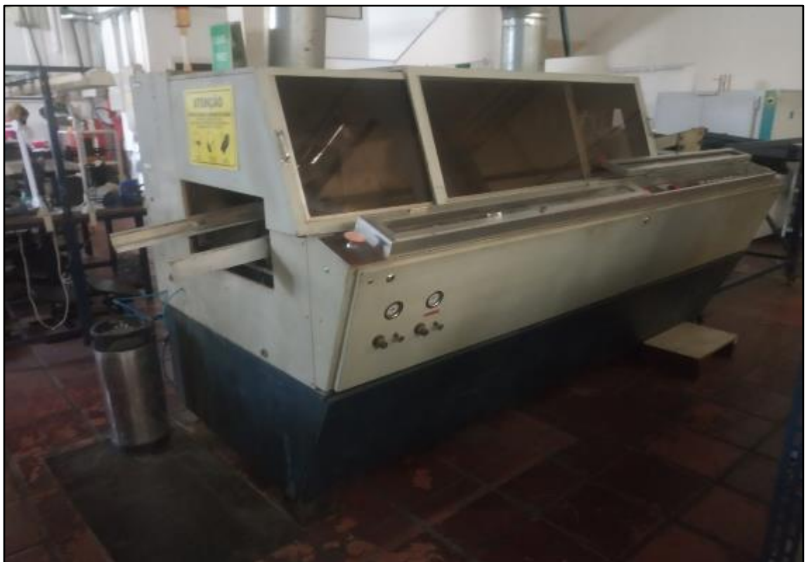
ITEM 1,011 - VISTA DO SISTEMA DE SOLDA POR ONDA ELECTROVERT ECONOPACK CHIPAK 15P SÉRIE: 891113 M333
