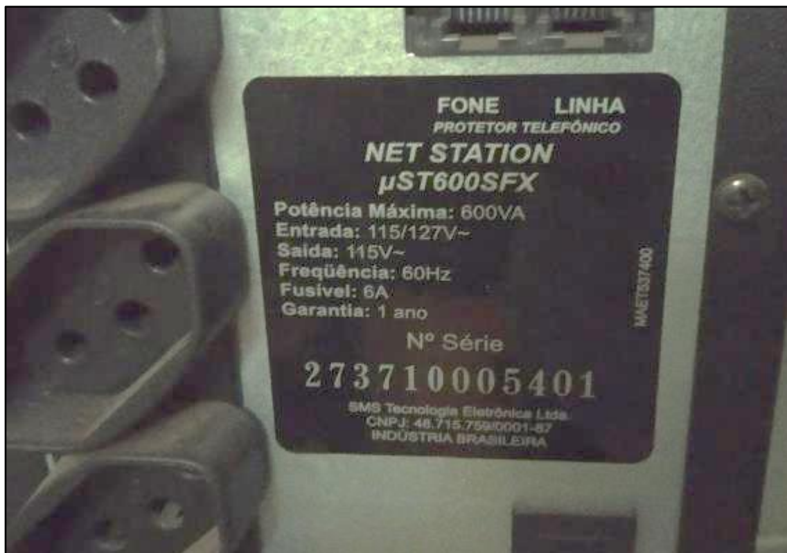
ITEM 3,006 - VISTA DA PLACA DE IDENTIFICAÇÃO DO NOBREAK SMS NETSTATION
