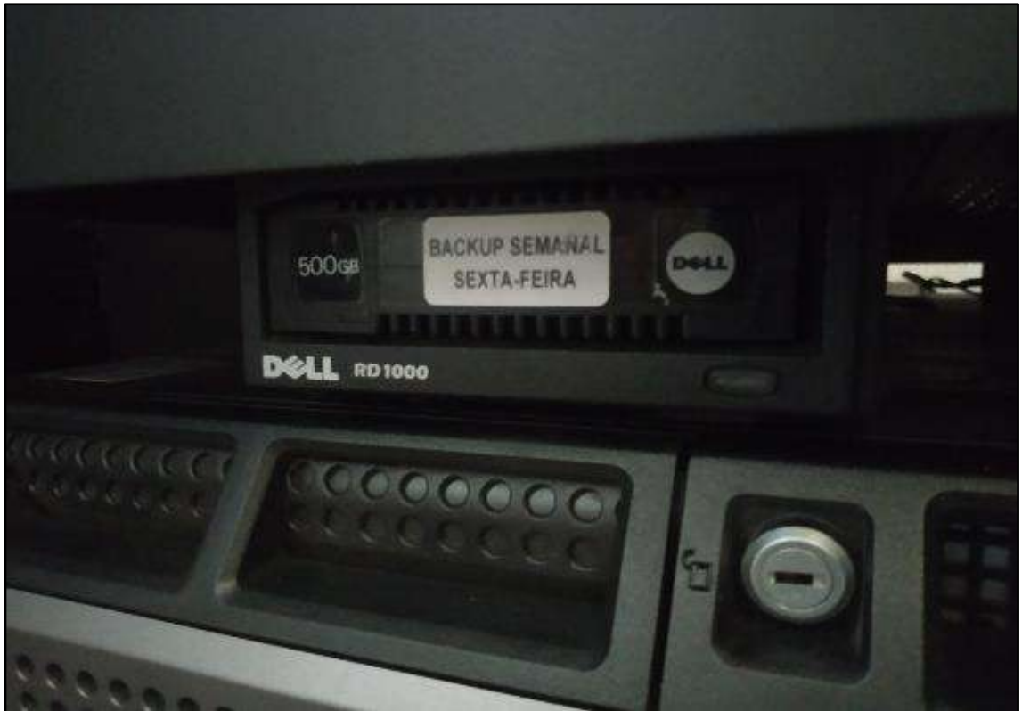
ITEM 3,055 - VISTA DO UNIDADE DE BACK UP HD BACK UP 500GB DELL RD100
