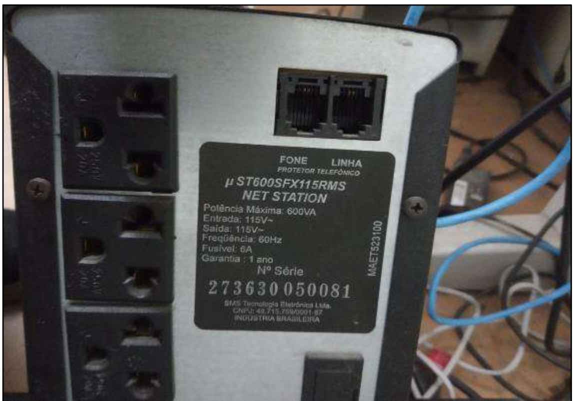
ITEM 3,128 - VISTA DA PLACA DE IDENTIFICAÇÃO DO NOBREAK SMS NETSTATION ST600SFX
