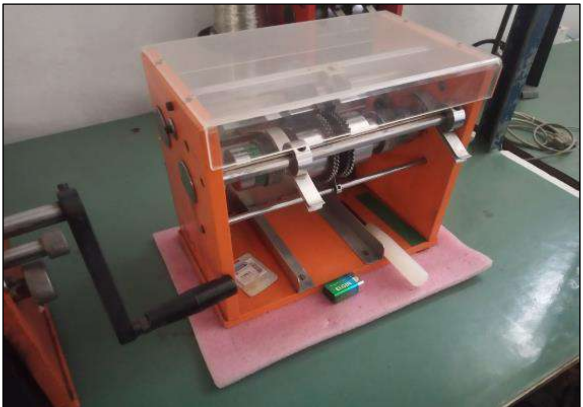
ITEM 1,041 - VISTA DA PREFORMADORA DE COMPONENTES AXIAIS OMTEC MC 7
