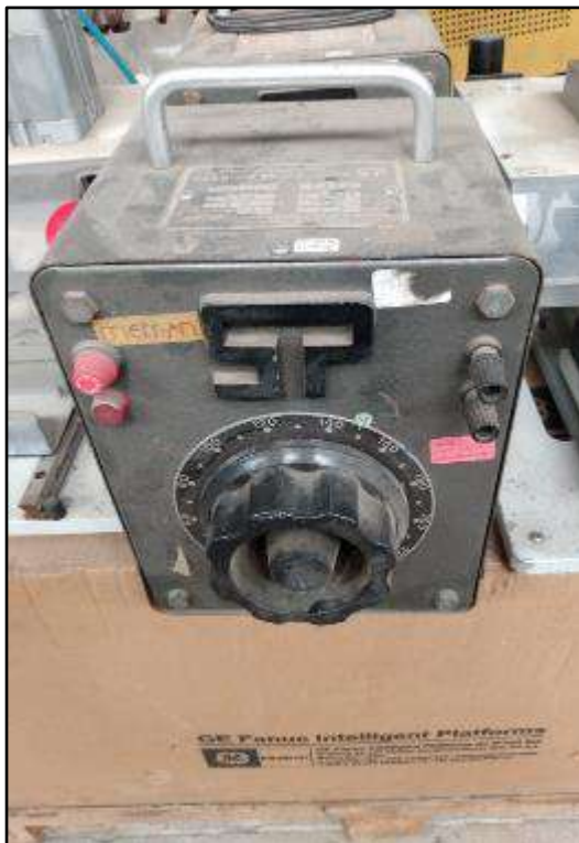
ITEM 1,060 - VISTA DO TRANSFORMADOR VARIADOR DE VOLTAGEM SP ATV-215-M SÉRIE: 2090
