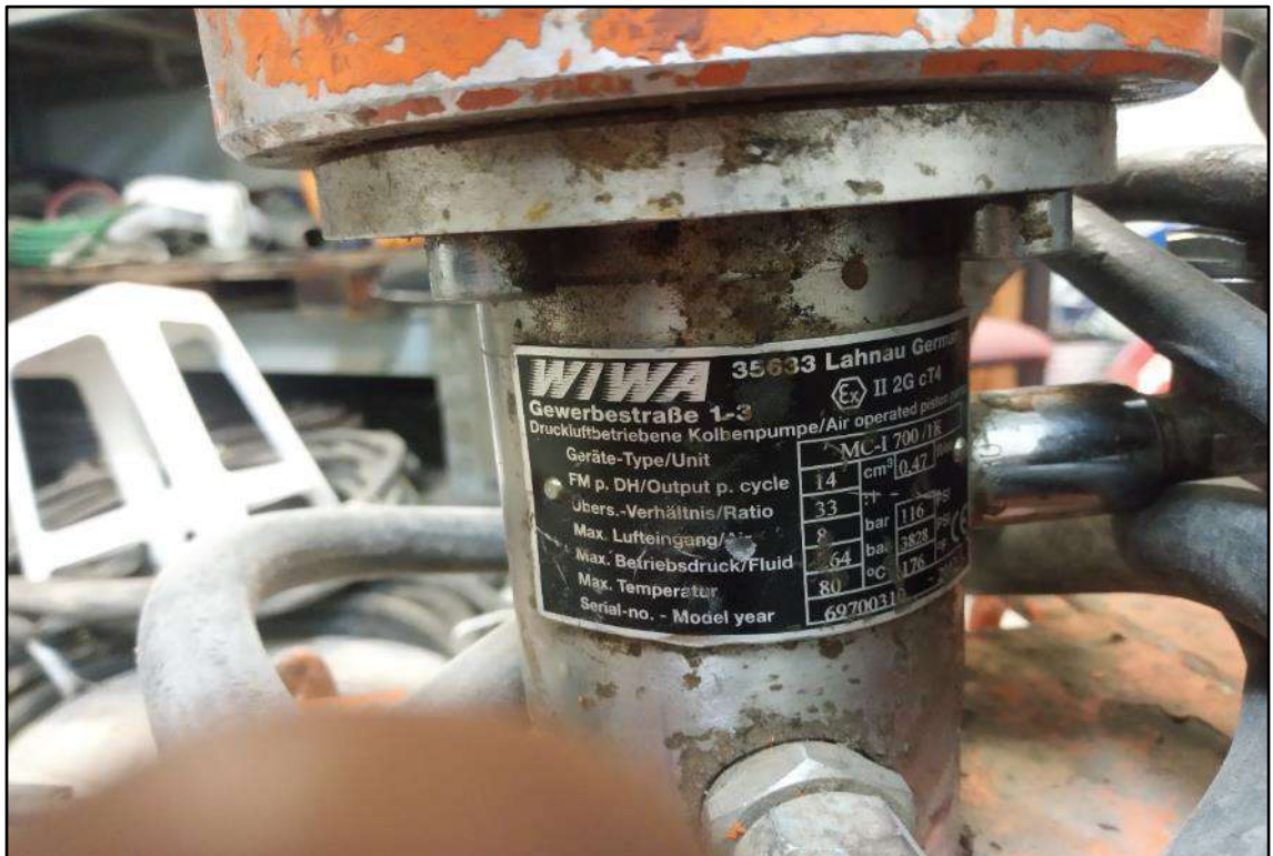
ITEM 1,008 - VISTA DA PLACA DE IDENTIFICAÇÃO DA BOMBA WIWA MC I700
