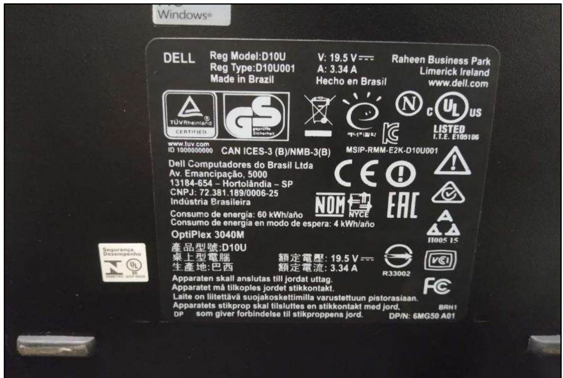
ITEM 3,006 - VISTA DA PLACA DE IDENTIFICAÇÃO DO MINI CPU DELL
