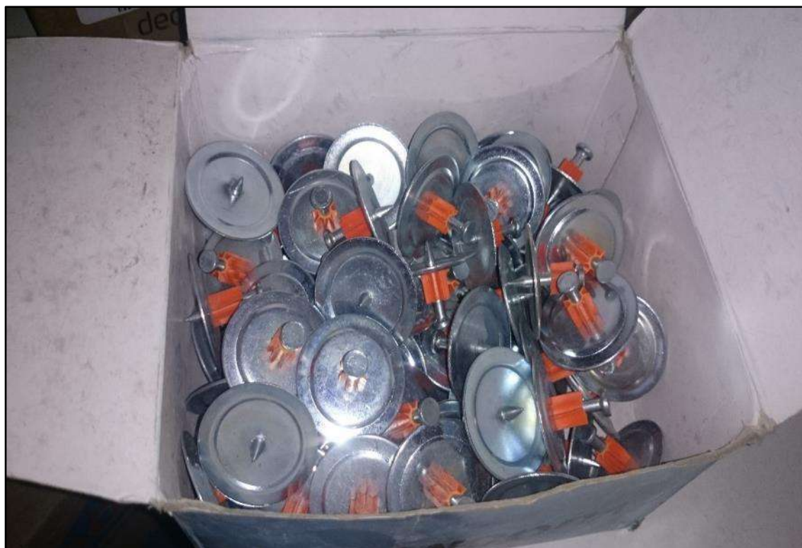
ITEM 5,059 - VISTA DAS CAIXAS DE PINOS 25MM COM ARRUELA 36mm ANCORA
