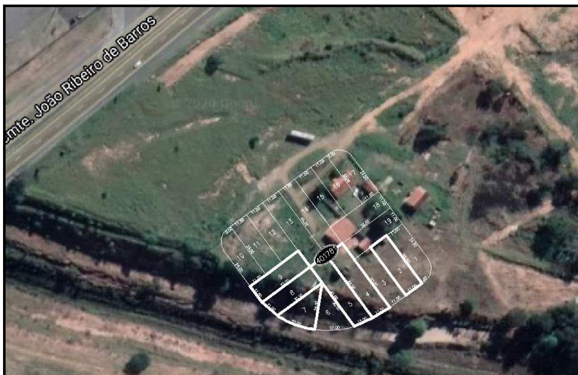
Figura 01. Imagem obtida no Google Mapa – sobreposição da quadra 1781, do setor 4 . Observa-se que grande parte dessa quadra se encontra sobre a faixa de domínio da FEPASA. Para implantação da ferrovia foi realizado escavação de aproximadamente 10,00m de profundidade. As Fotos 01 e 02 a seguir, obtidas no dia da vistoria mostram a escavação onde estão situados os lotes.
