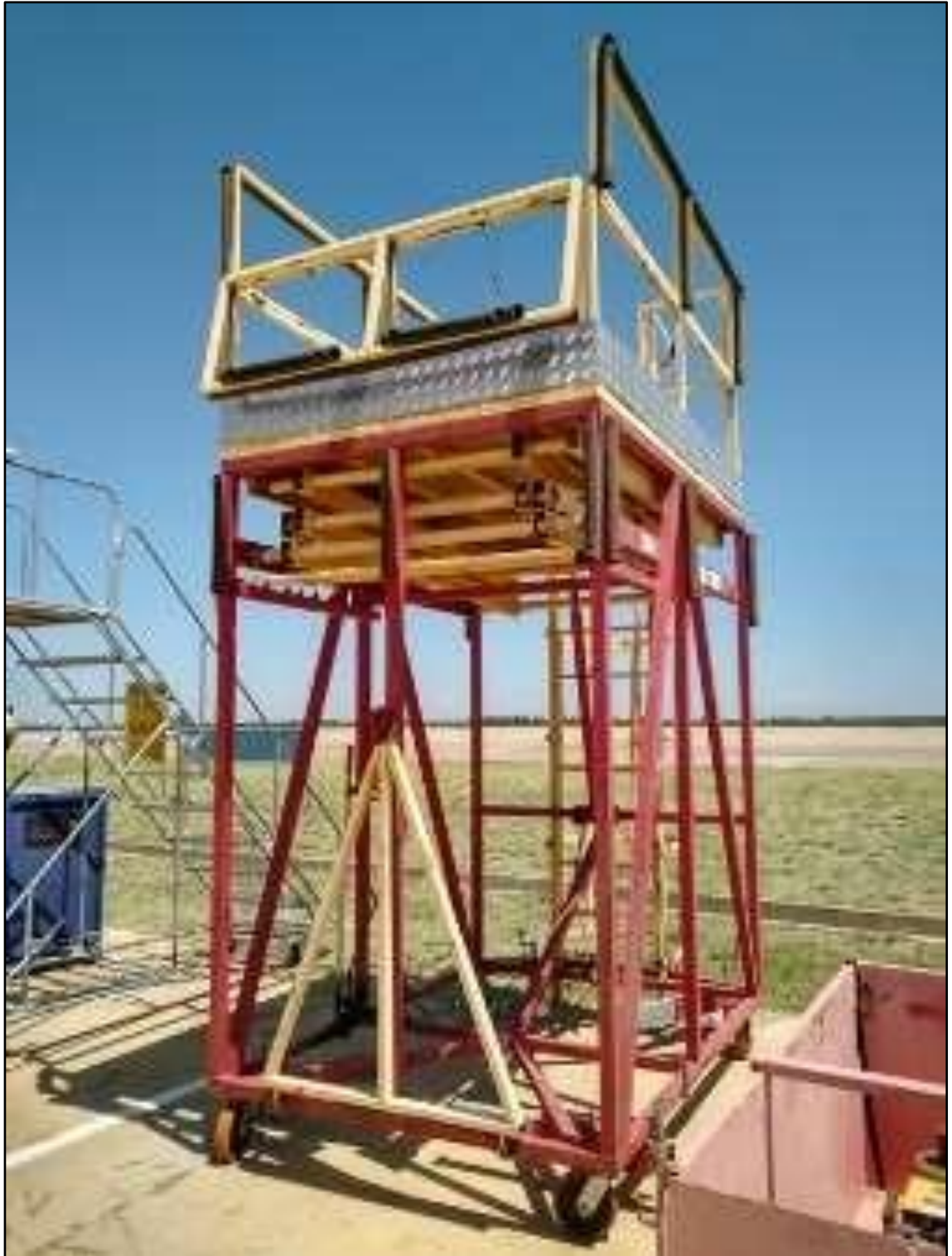
ITEM 11,010 - ESCADA DE ACESSO PARA MANUTENÇÃO DE AERONAVES
