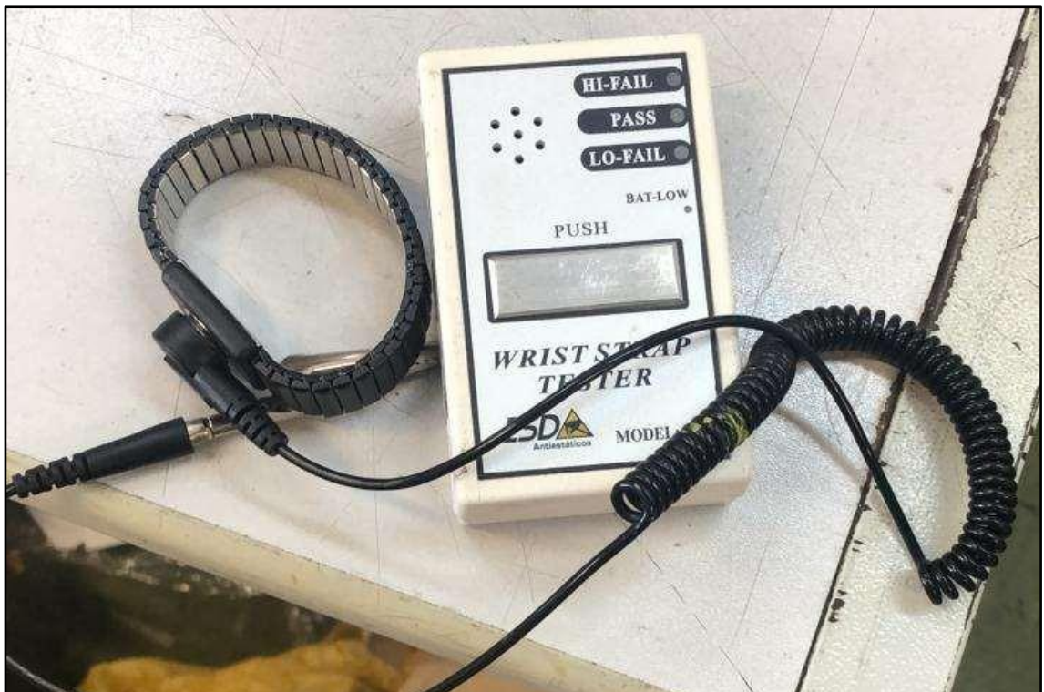
ITEM 2,027 - TESTADOR DE PULSEIRA ANTIESTÁTICA
