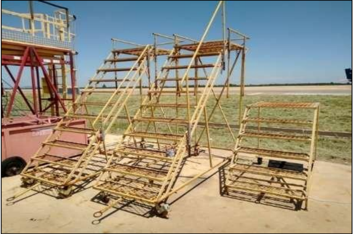
ITEM 11,011 - ESCADAS DE ACESSO PARA MANUTENÇÃO DE AERONAVES
