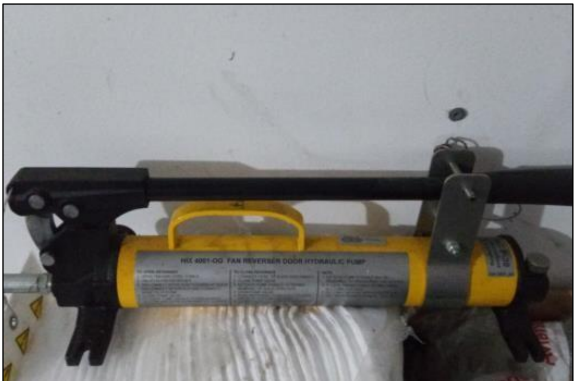
ITEM 5,040 - BOMBA MANUAL HIDRÁULICA - HIX 4001-0G
