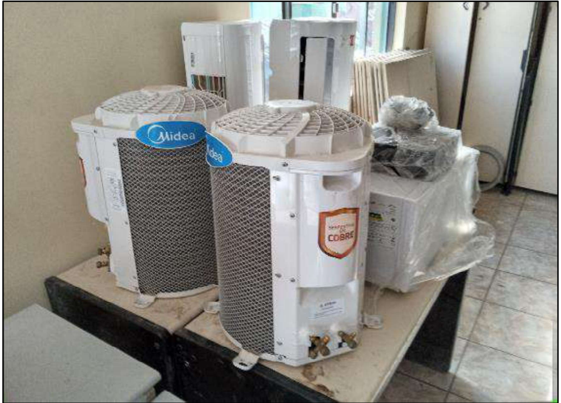
ITEM 2,003 - VISTA DO APARELHO AR CONDICIONADO SPLIT 9000 BTUS
