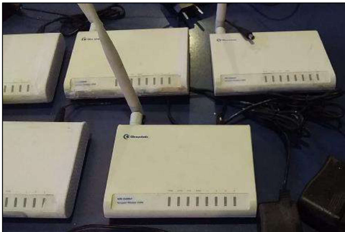
ITEM 3,015 - VISTA DOS ROTEADORES REPETIDORES DE SINAL
