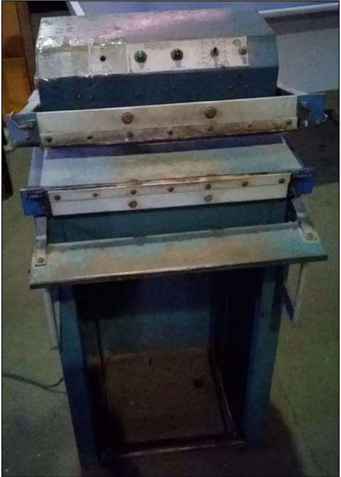
ITEM 1,009 - VISTA DA MÁQUINA SELADORA DE SACOS PLÁSTICOS IPCAL
