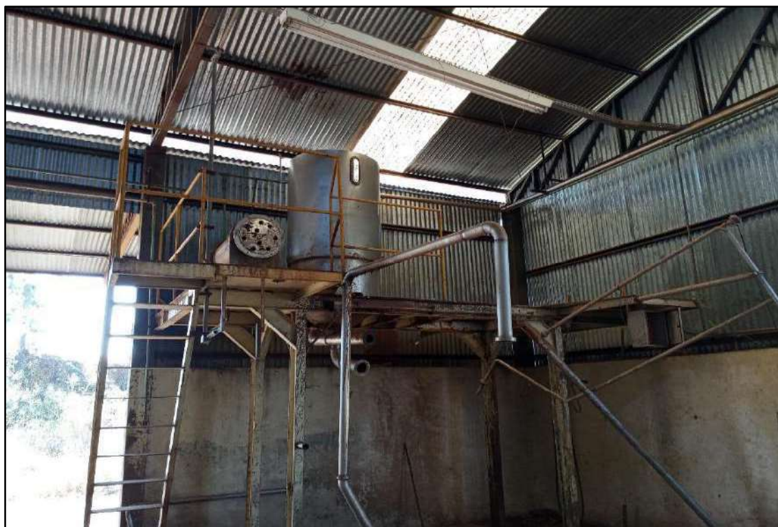
ITEM 024 - DEPÓSITOS “PULMÃO”, CONFECCIONADO EM AÇO INOX, CAPACIDADE DE ARMAZENAGEM DE 1.000 QUILOS.
