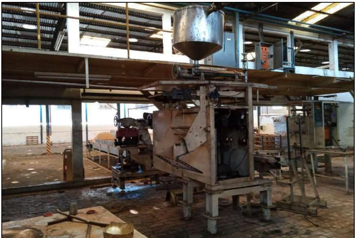
ITEM 004 - MÁQUINA DOSADORA ADAPTADA COM TEMPORIZADOR, PARA LATA REPUXADA DE 600 GRAMAS, E PARA LATA DE 830 GRAMAS, DA MARCA MAICOMAR.
