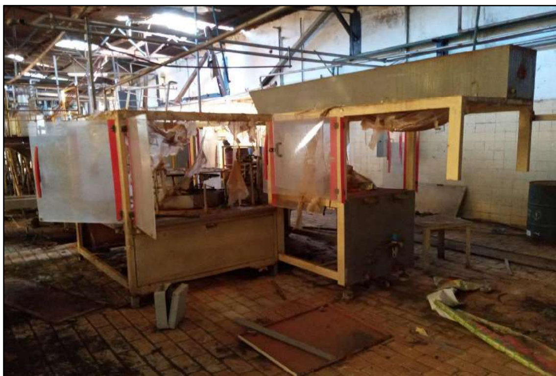
ITEM 016 - MÁQUINA “POUCH”, CAPACIDADE PARA 30 EMBALAGENS/MINUTO DE 350 GRAMAS, MARCA SERPACK, MODELO SPK 250-SUP, Nº DE SÉRIE 030, ANO FABRICAÇÃO 2007.
