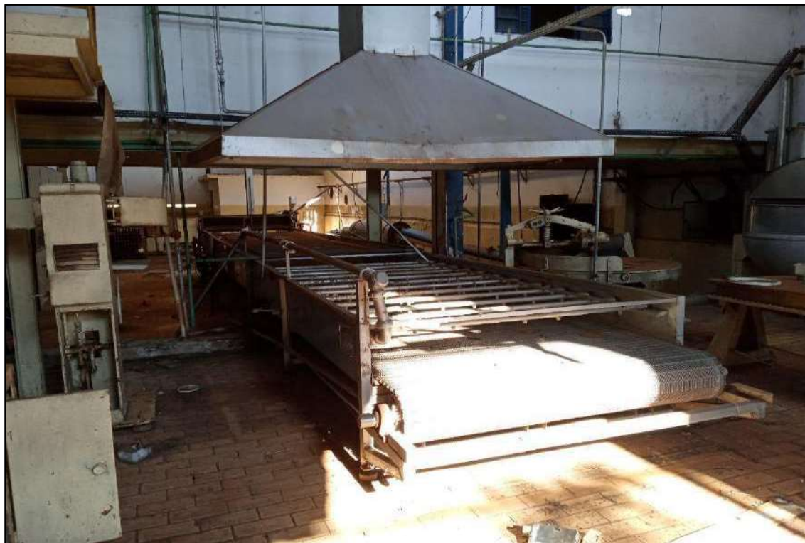
ITEM 010 - ESTEIRA DE RESFRIAMENTO, TIPO BANHO-MARIA, CONFECCIONADA EM AÇO INOX, MEDINDO CERCA DE 10 METROS DE COMPRIMENTO E 1,5 METRO DE LARGURA.
