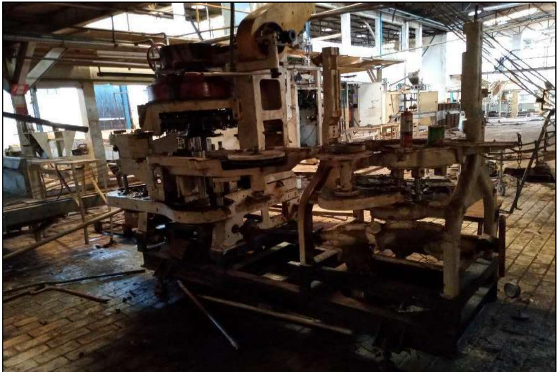
ITEM 007 - CONJUNTO DE REGRAVADEIRA DA MARCA ANGELUS, MODELO 69 P; DE SEIS CABEÇOTES, PARA LATA DE 350 GRAMAS, ACOPLADA A UMA DOSADORA DE DEZ BICOS.
