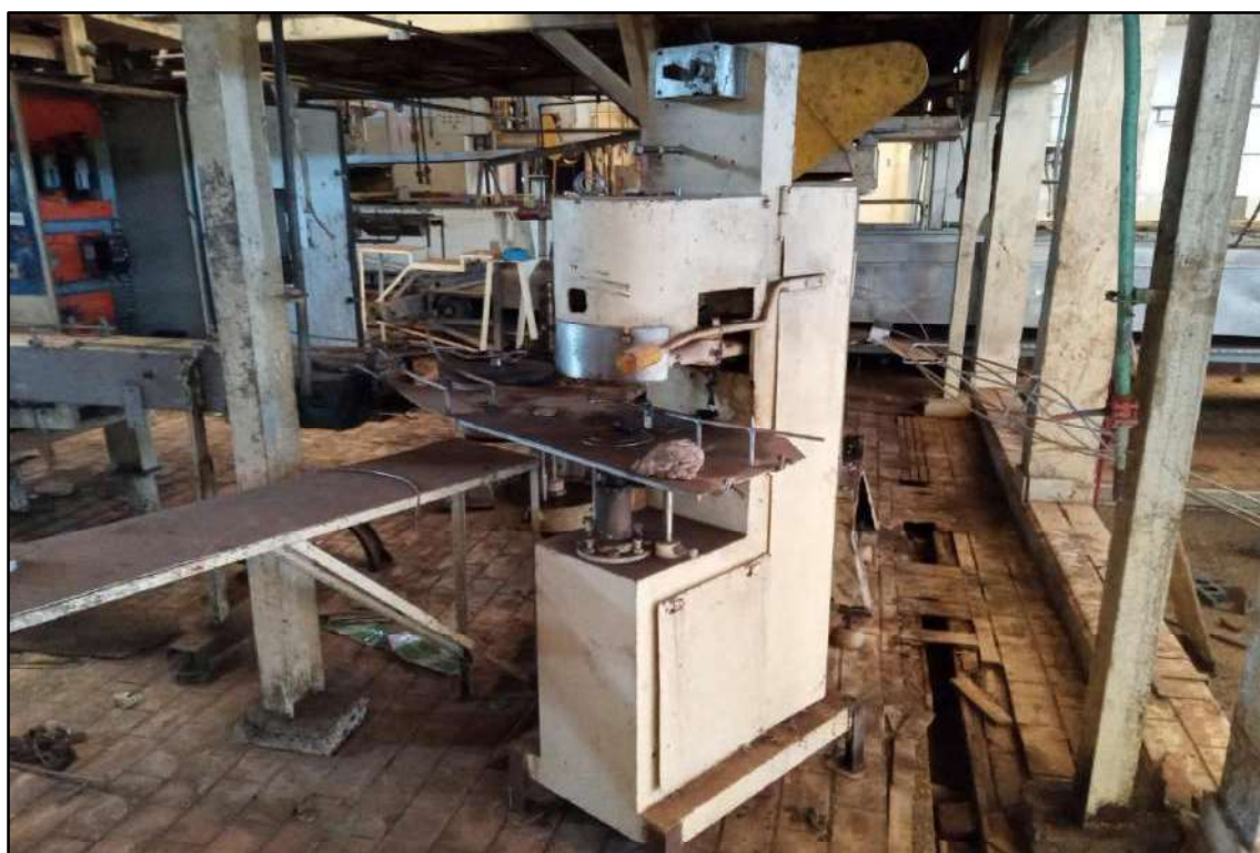
ITEM 006 - RECRAVADEIRA SEMIAUTOMÁTICA, MARCA MOCOCA, CAPACIDADE PARA 15 LATAS DE 850 GRAMAS/MINUTO.
