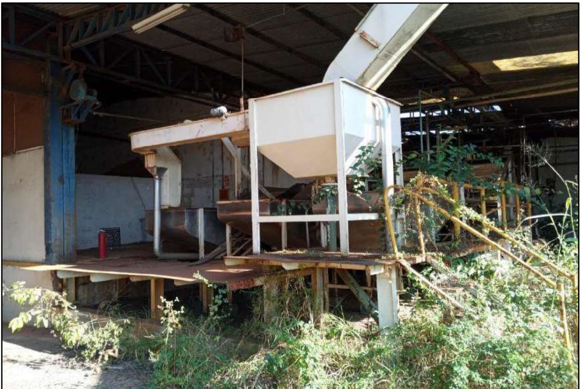
ITEM 018 - LINHAS DE MOAGEM, COM LAVADOR E MESA DE SELEÇÃO, DOTADAS DE ROLETES DE PVC DE 3 POLEGADAS, CAPACIDADE PARA 4.00 KG/HORA, ESTANDO ACOPLADAS A UM SISTEMA HÍDRICO DE ESTEIRA DE ELEVAÇÃO E BICA DE ALIMENTAÇÃO.
