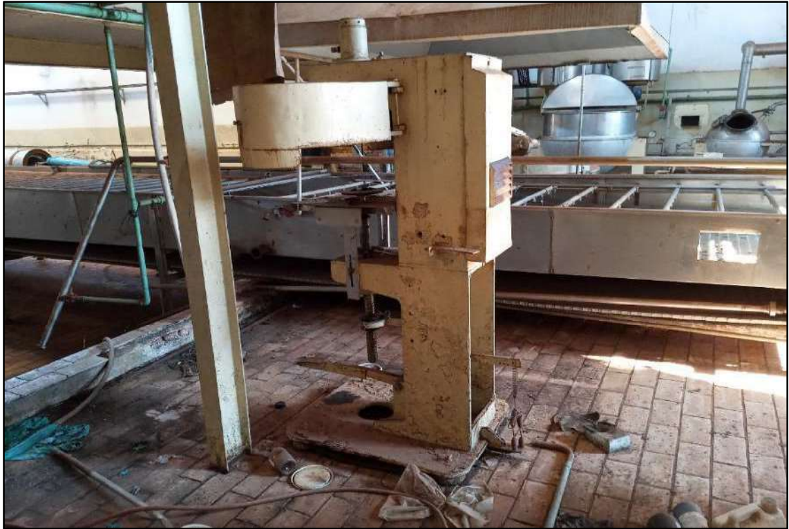
ITEM 013 - RECRAVADEIRA DA MARCA GUTMANN, A PEDAL, PRÓPRIA PARA LATA DE TRÊS QUILOS E DE 150MM DE DIÂMETRO, CAPACIDADE DE DEZ LATAS/MINUTO.
