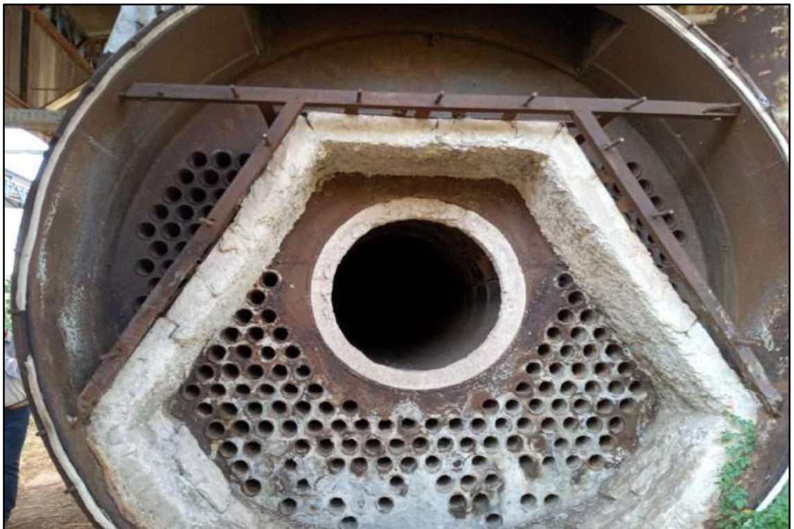
ITEM 020 - CALDEIRA DA MARCA ATA 30, MODELO H3, TRANSFORMADA A LENHA, CAPACIDADE PARA 10.000 KG DE VAPOR/HORA.
