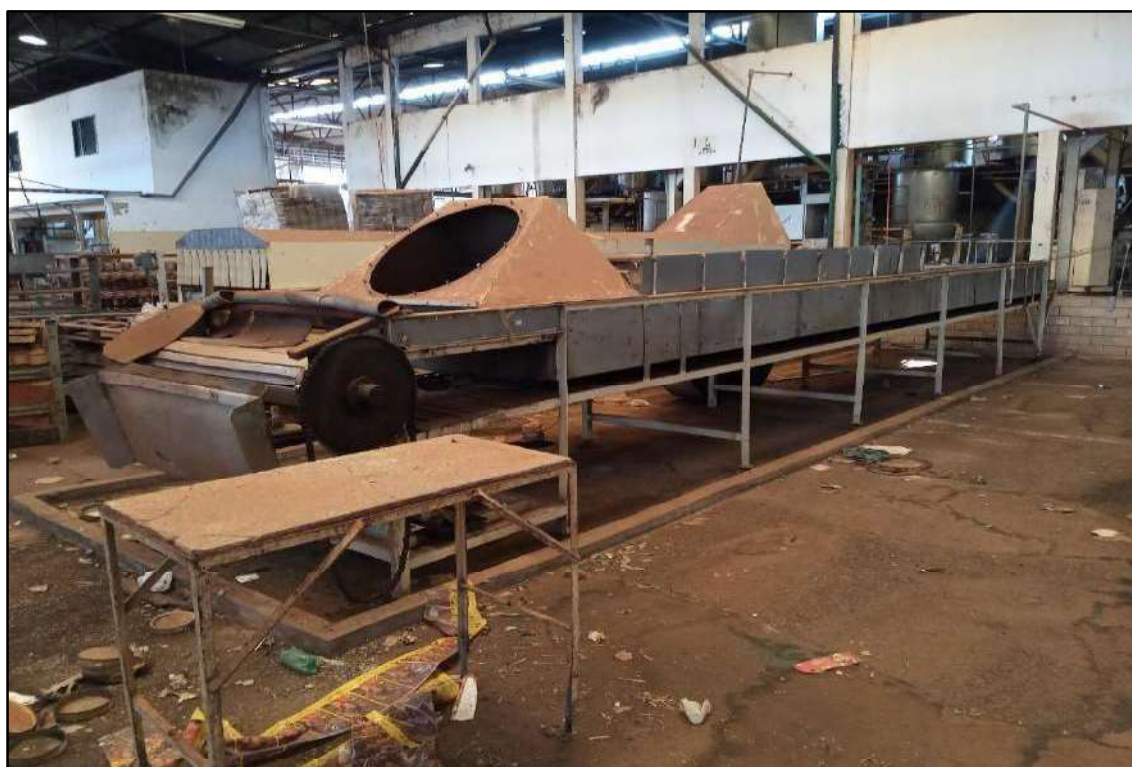
ITEM 009 - ESTEIRAS DE RESFRIAMENTO, TIPO BANHO-MARIA, CONFECCIONADA EM AÇO INOX, MEDINDO CERCA DE 10 METROS DE COMPRIMENTO E 1,5 METRO DE LARGURA.
