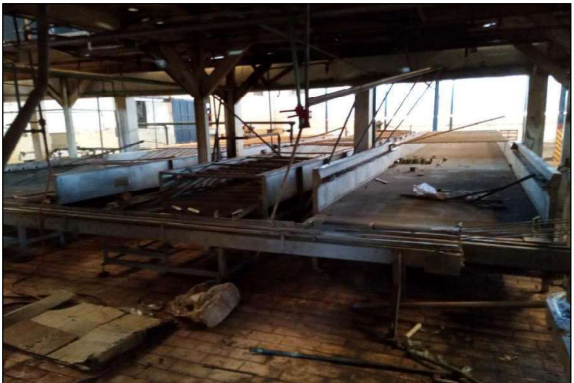
ITEM 008 - ESTEIRAS DE RESFRIAMENTO, TIPO BANHO-MARIA, CONFECCIONADA EM AÇO INOX, MEDINDO CERCA DE 10 METROS DE COMPRIMENTO E 1,5 METRO DE LARGURA.
