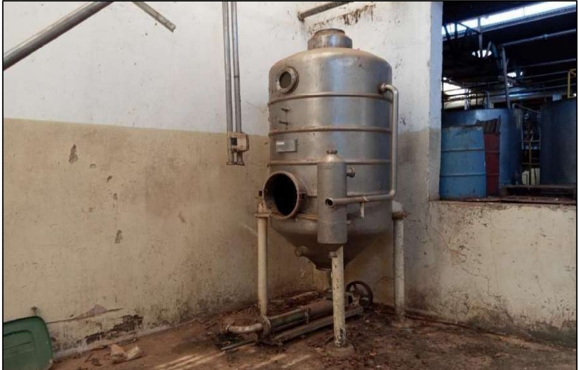
ITEM 017 - LINHA DE DESENVASE DE TAMBORES E PREPARAÇÃO DE POLPA DE GOIABA, EXTRATO DE TOMATE E MARROM -GLACÊ, CONSTITUÍDA DE QUATRO (4) DEPÓSITOS À VÁCUO, CONFECCIONADO EM AÇO INOX, CAPACIDADE PARA 1.500 QUILOS CADA UM E 1 DEPÓSITO DE PREPARAÇÃO, CONFECCIONADO EM AÇO INOX, CAPACIDADE PARA 2.000 QUILOS.
