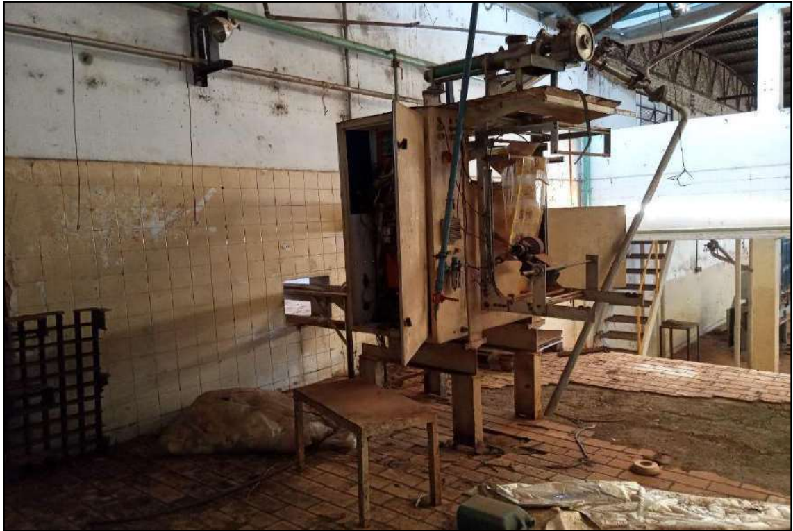
ITEM 002 - MÁQUINA ENVASADORA DE PRODUTO DE GOIABA, PRÓPRIA PARA EMBALAGENS DE 300G 1.000G, DE UMA VIA DE EMBALAGEM, DOSAGEM POR BOMBA POSITIVA, DA MARCA SÃO CAETANO, SENDO O CORPO CONFECCIONADO EM AÇO INOX, E ESTRUTURA EM AÇO CARBONO
