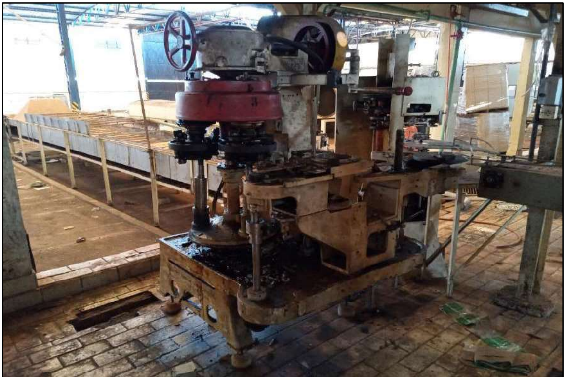
ITEM 005 - RECRAVADEIRA AUTOMÁTICA, MARCA ANGELUS, MODELO 59 P, DE TRÊS CABEÇOTES.
