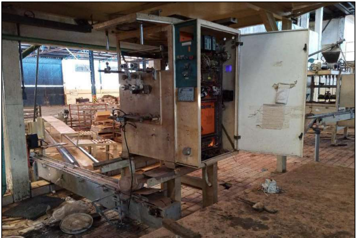
ITEM 003 - MÁQUINA ENVASADORA DE PRODUTO DE GOIABA, PRÓPRIA PARA EMBALAGENS DE 300G 1.000G, DE UMA VIA DE EMBALAGEM, DOSAGEM POR BOMBA POSITIVA, DA MARCA SÃO CAETANO, SENDO O CORPO CONFECCIONADO EM AÇO INOX, E ESTRUTURA EM AÇO CARBONO
