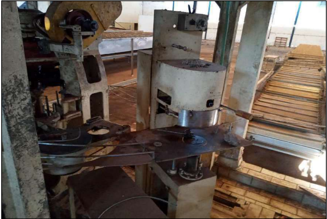
ITEM 006 - REGRAVADEIRA SEMIAUTOMÁTICA, MARCA MOCOCA, CAPACIDADE PARA 15 LATAS DE 850 GRAMAS/MINUTO.
