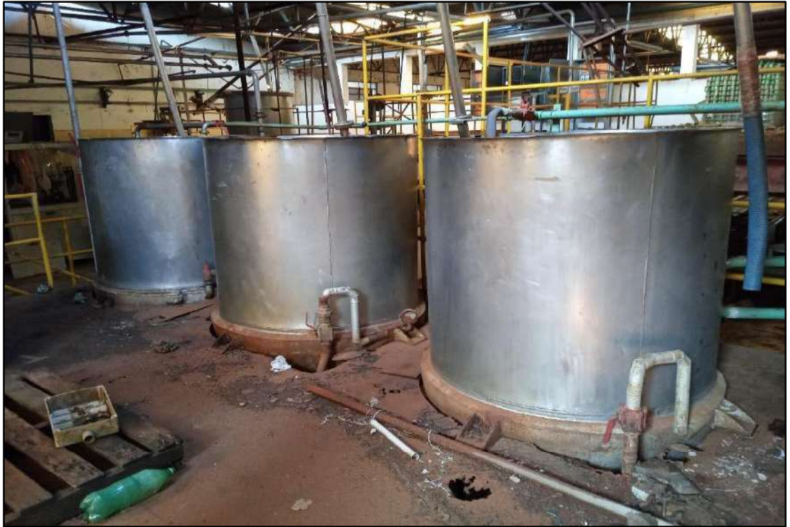
ITEM 011 - DEPÓSITOS DE PREPARAÇÃO DE PRODUTOS, SENDO O CORPO E MEXEDOR CONFECCIONADOS EM AÇO INOX E CAMISA EM AÇO CARBONO, CAPACIDADE PARA 1.500 QUILOS.
