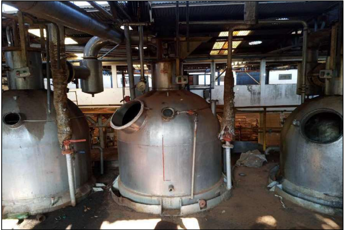
ITEM 012 - BULES DE CONCENTRAÇÃO DE POLPA À VÁCUO, SENDO O CORPO E MEXEDOR CONFECCIONADOS EM AÇO INOX E CAMISA E REDUTOR EM AÇO CARBONO, CAPACIDADE DE ARMAZENAGEM PARA 1.500 QUILOS.
