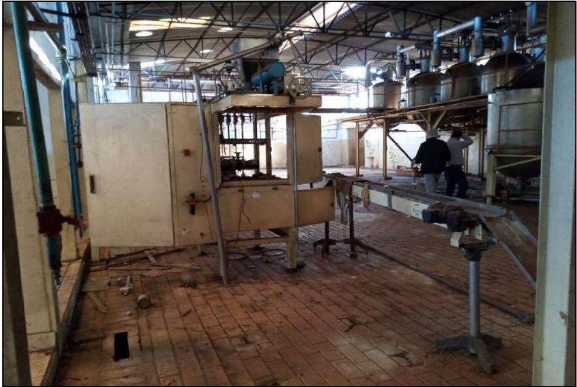
ITEM 001 - MAQUINA ENVASADORA DE PRODUTO DE GOIABA EM SACHÊ DE 40G, QUATRO VIAS DE EMBALAGEM, DOSAGEM POR INTERMÉDIO DE PISTÃO, DA MARCA SÃO CAETANO; SENDO O CORPO CONFECCIONADO EM AÇO INOX, E ESTRUTURA EM AÇO CARBONO.
