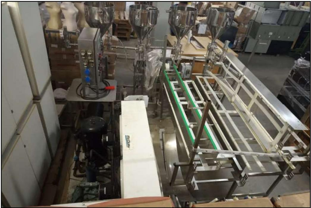
**ITEM 1,001 - VISTA DA LINHA DE PRODUÇÃO DE MASSA PRONTA COMPREENDENDO: 4 DOSADORES MARCA DELGO TIPO: DG451, 1 PAINÉL DE COMANDO MARCA: DELGO SCHNEIDER, ESTRUTURA DE ESTEIRA DE AÇO INOX COM 3 MÓDULOS RETOS E 1 CURVA**
