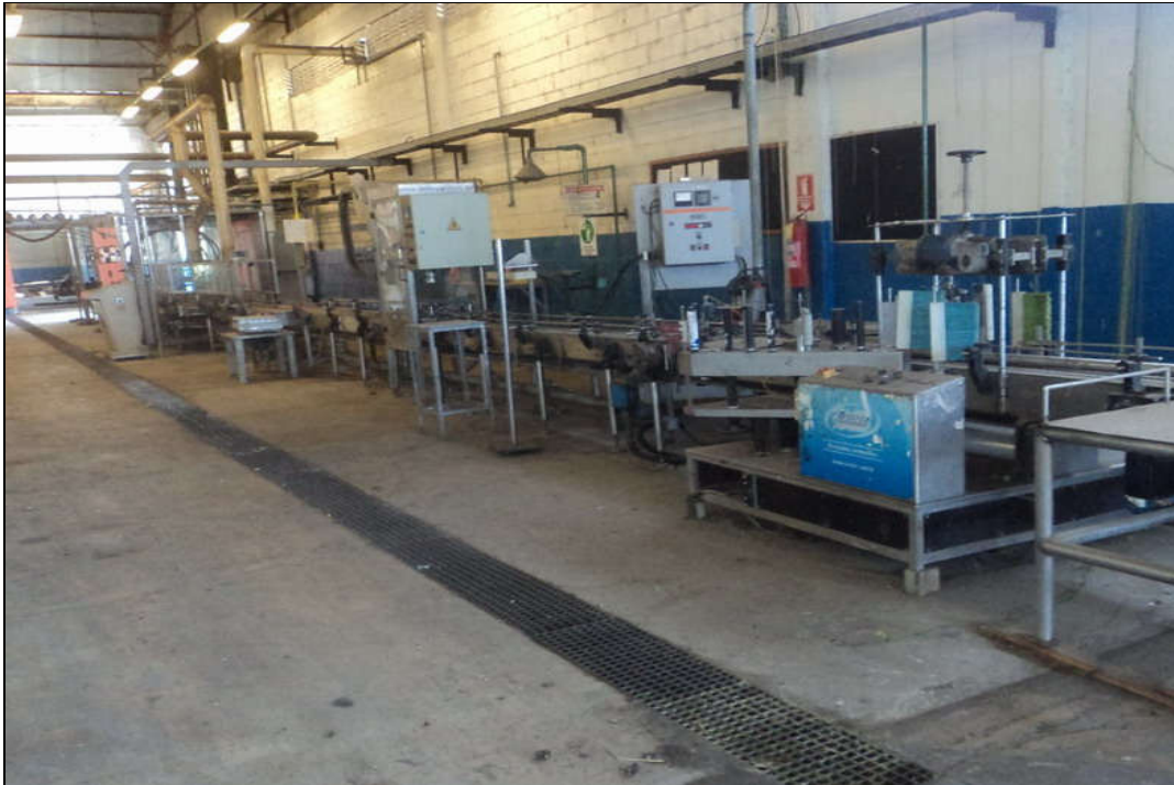
FORMULAÇÃO SUL - ENVASADORA DE LÍQUIDOS, FAB. INNOVAR, 8 BICOS DE ENVASE
