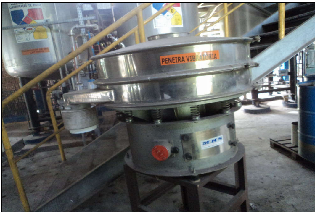
FORMULAÇÃO SUL - PENEIRA VIBRATÓRIA, FAB. MHS, MOD. LS-1000, MAT. AÇO INOX, DIM. 900 MM, ACIONAM. MOTOR ELÉTRICO 2 CV
