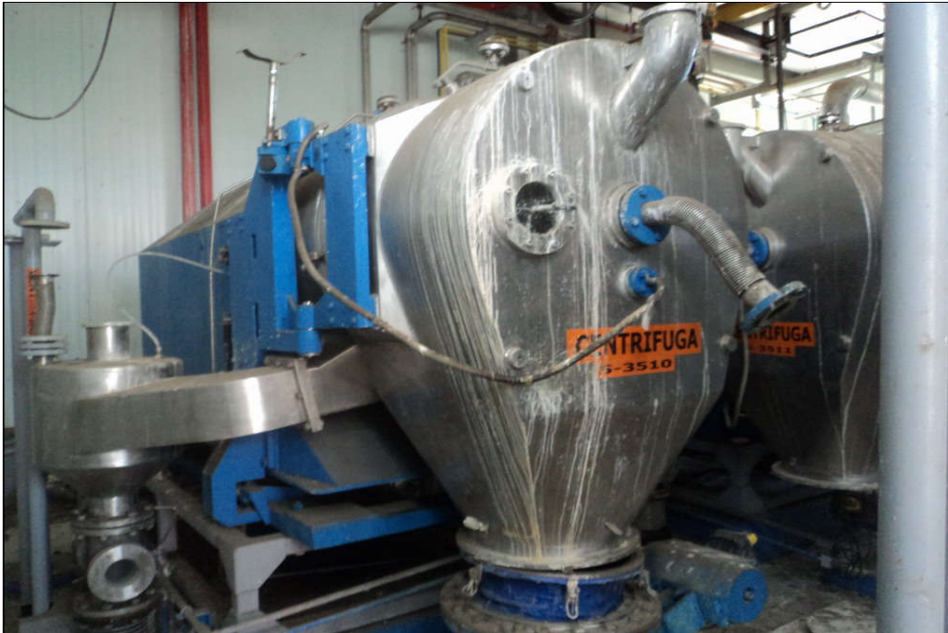
ITENS 1,0656; 1,0658 - SÍNTESE - TIN SHOP - CENTRIFUGAS VERTICAIS, FAB. HEINKEL, MAT. AÇO INOX 316, ACION. HIDRÁULICO, TIPO HF800, CAPAC.149 KG / 119 L
