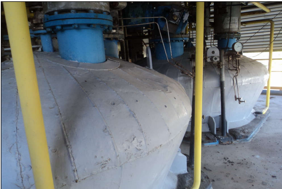
ITENS 1,0266; 1,0267 - SÍNTESE - JOB SHOP - SECADORES CÔNICOS, FAB. KRAUSS MAFFEI, MOD. MT8/300, CAPAC. 8.0 M3
