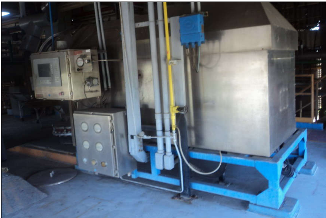
ITEM 1,0228 - SÍNTESE - JOB SHOP - CENTRIFUGA, FAB. HEINKEL, MOD. HE3001, CAPAC. 149 KG / 119 L, MAT. AÇO INOX 316 SÍNTESE JOB SHOP
