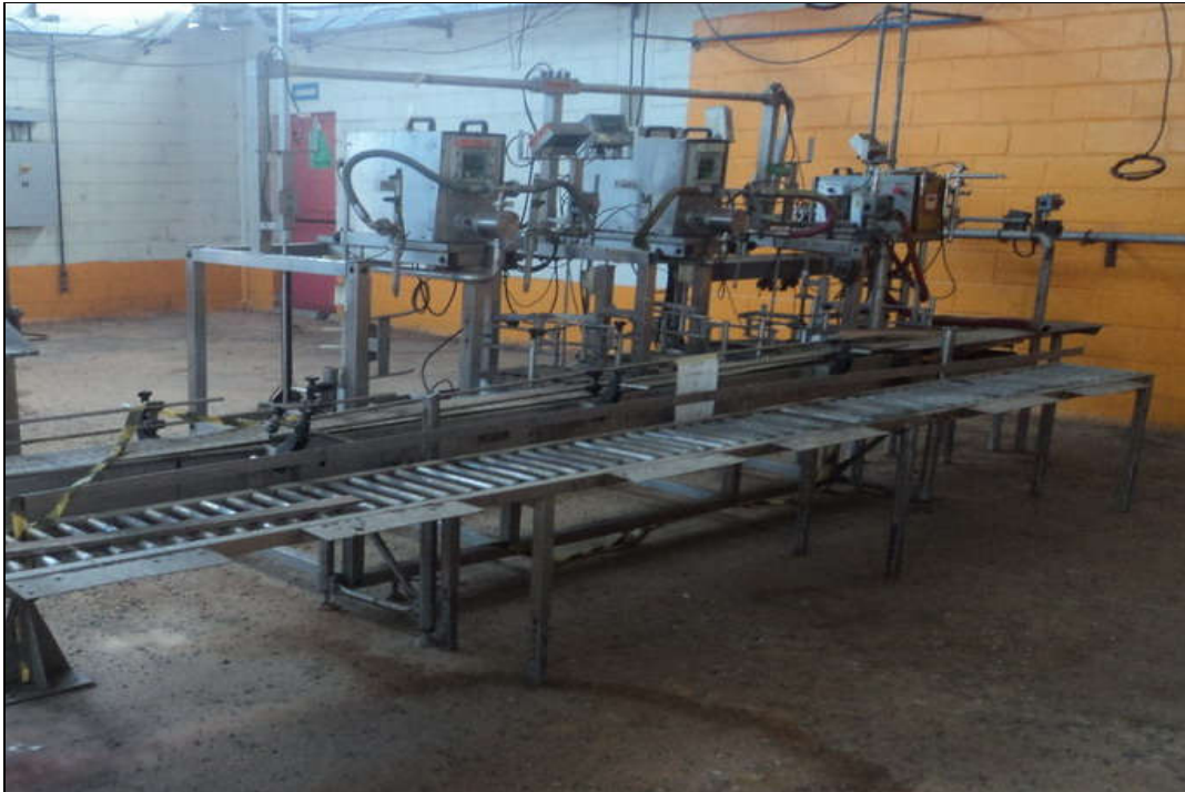
ITEM 1,0013; 1,0064 - FORMULAÇÃO NORTE HERBICIDA - MÁQUINAS DE ENVASE, FAB. REALIZA, MOD. BP-M1B1, CAPAC. 20 L
