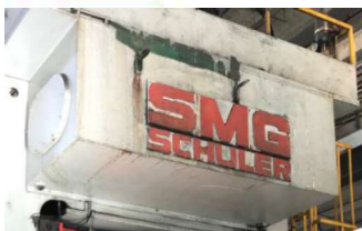
(Fig 07 – Reservatório óleo hidráulico)
