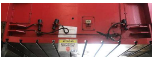
(Fig 04 – Sistema de macaqueamento auxiliar hidráulico)
