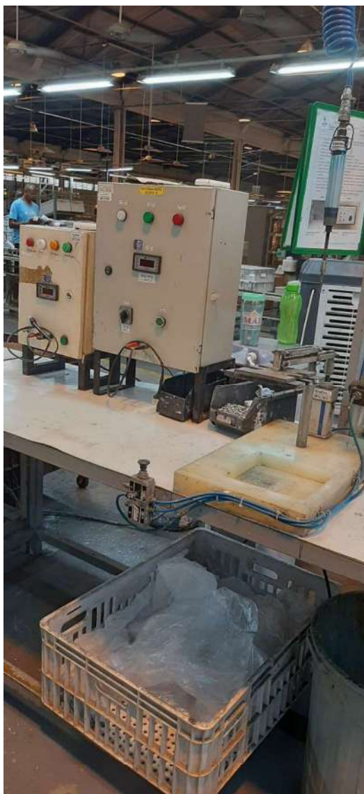
TESTE DE ESTANQUEIDADE
