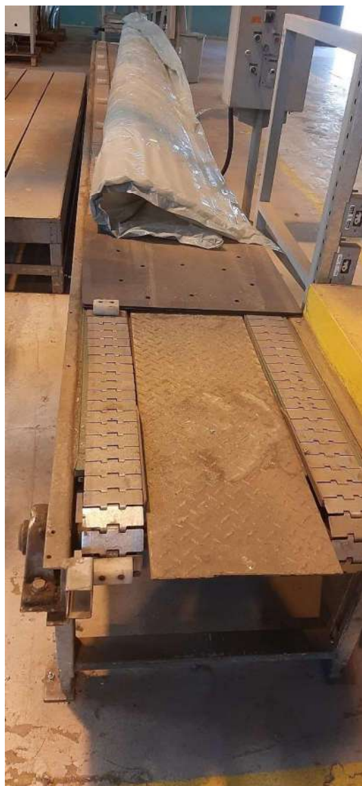
ESTEIRA MECÂNICA 6 METROS
