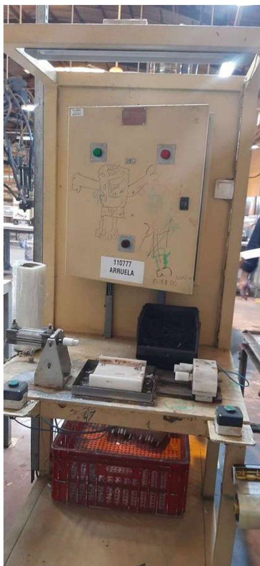
CONTROLE DE INJEÇÃO DE POLIURETANO
