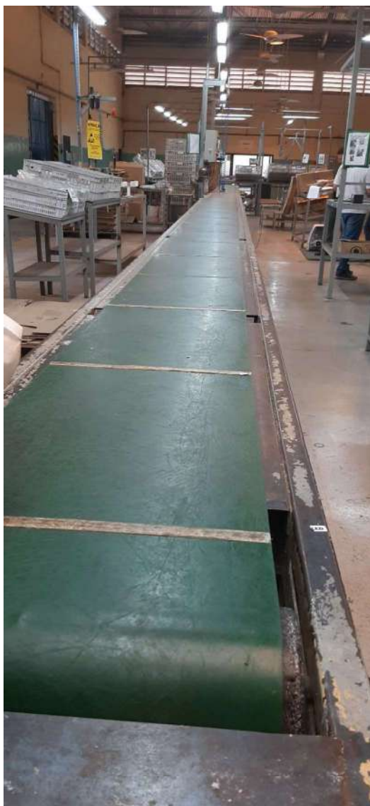
ESTEIRA MECÂNICA 20 METROS
