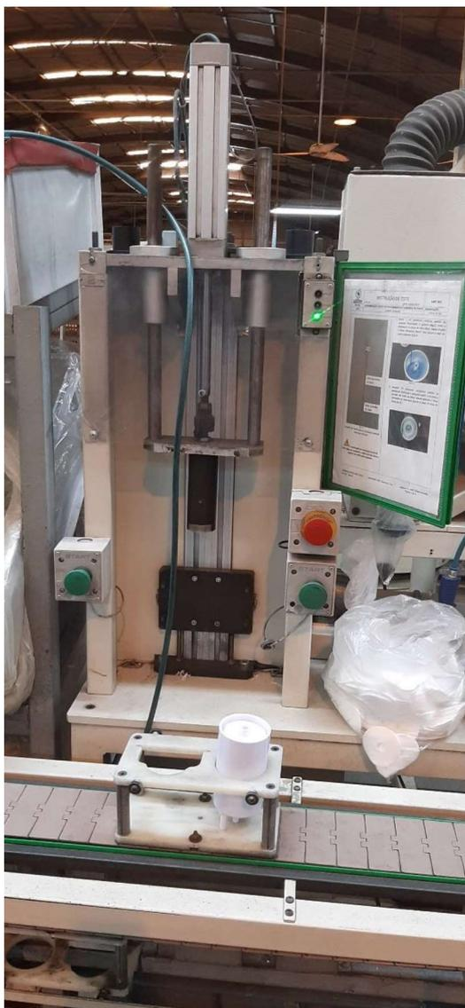
PRENSA PNEUMÁTICA MINERAIS
