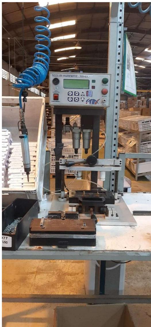
TESTE DE VAZAMENTO TEX-G3 e EQUIPAMENTO GUIA PARA FURAÇÃO
