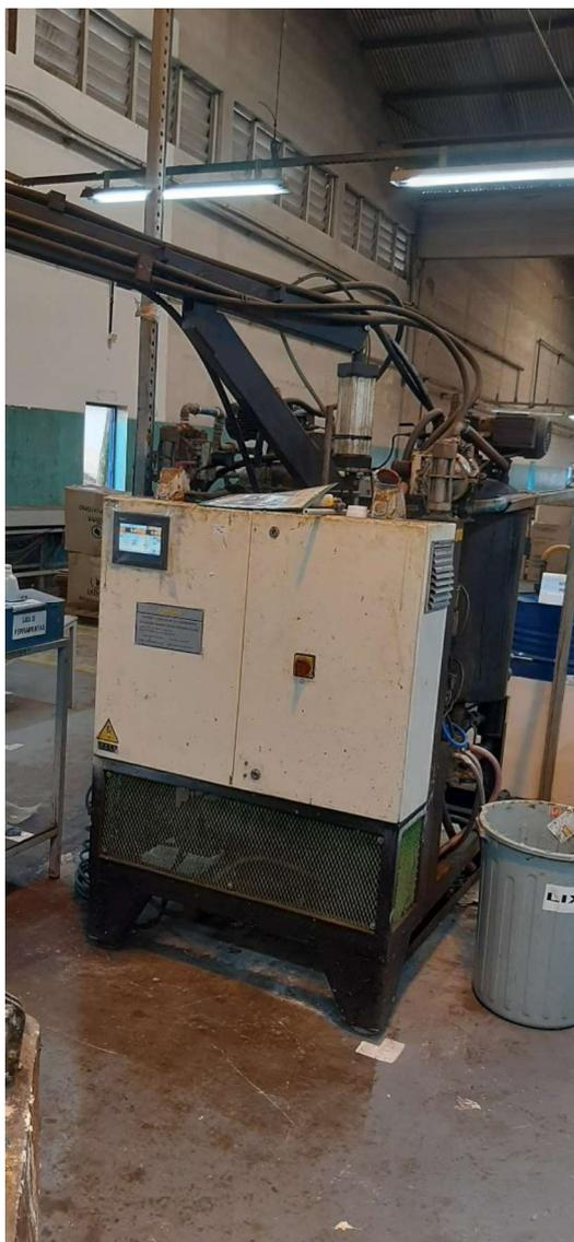
MÁQUINA DE INJEÇÃO COM TRANSFORMADOR SULPOL
