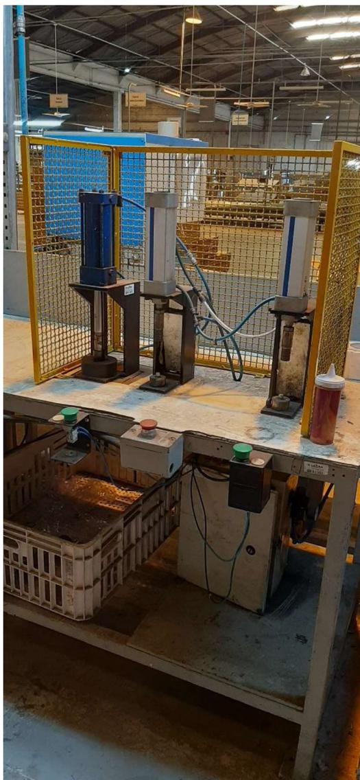
BANCADA PARA PRENSA PNEUMÁTICA
