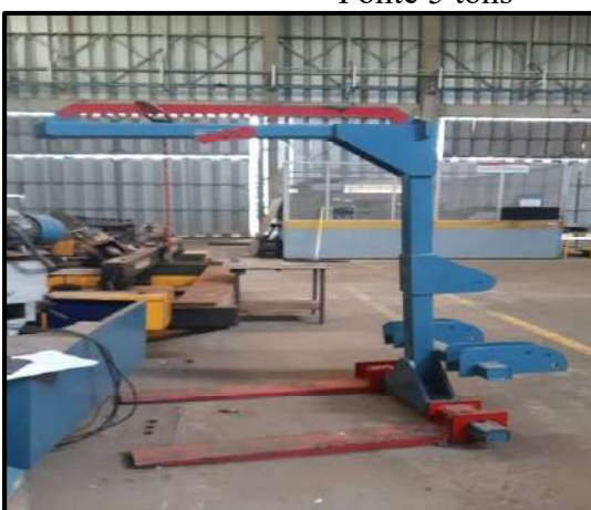
Girafa catraca para levantamento de carga
