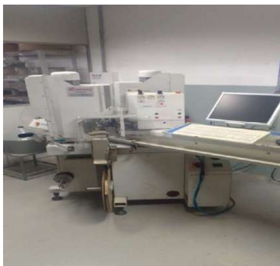
Máquina para cravação de cabos
