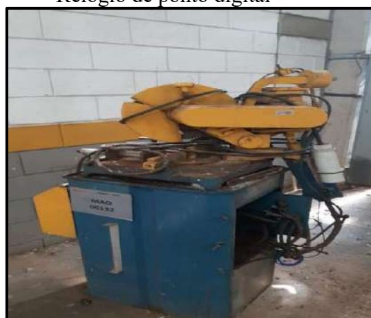
Serra policorte adaptado a dispositivo
