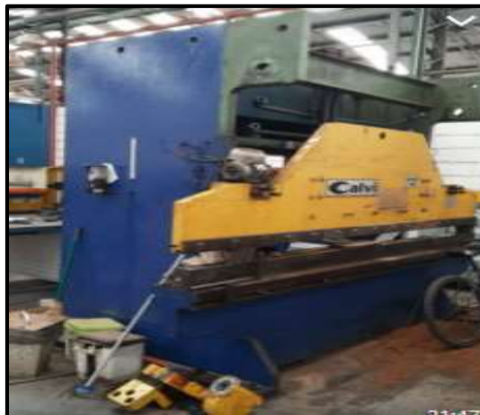
Dobradeira de chapa (desmontada)
