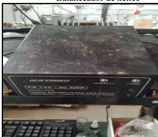
Fonte estabilizada ventilada
