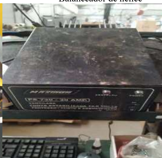
Fonte estabilizada ventilada
