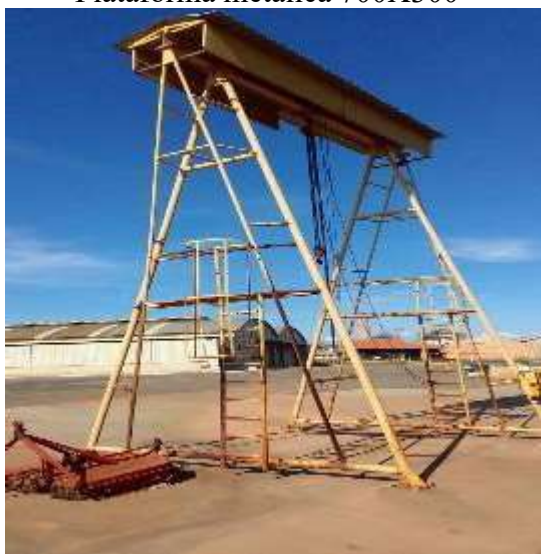
Pórtico com talha
