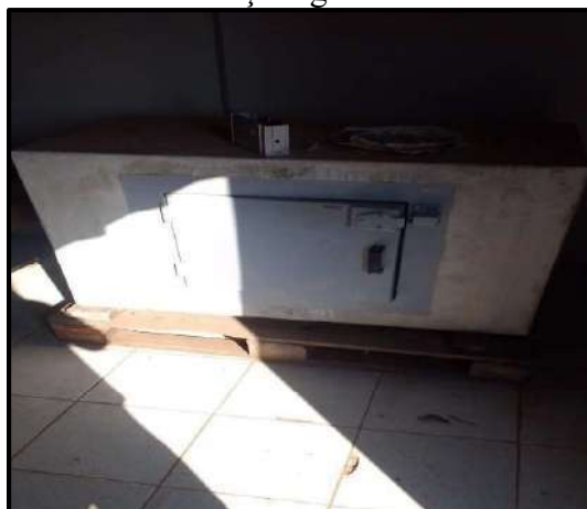
Cofre concreto com porta em aço
