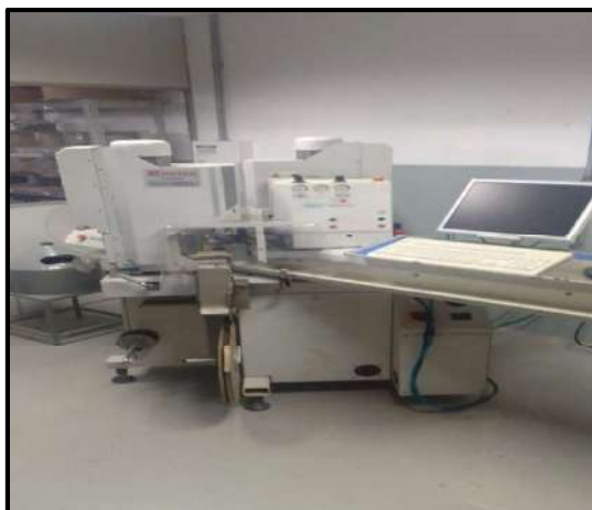
Máquina para cravação de cabos
