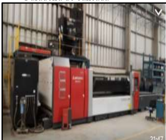
Cortadora de chapa a laser Mitsubishi
