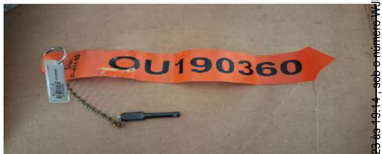
ITEM 162 Descrição: PIN-RIGGING,THS ACTUATOR,MECHANICAL INPUT LEVER PN: OU190360 S/N: G-1720 Quantidade: 1
