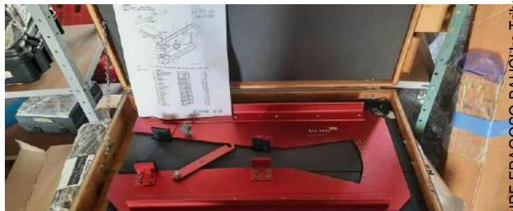
ITEM 150 Descrição: AILERON TAB RIGGING PN: 28-0-3948 Quantidade: 1
