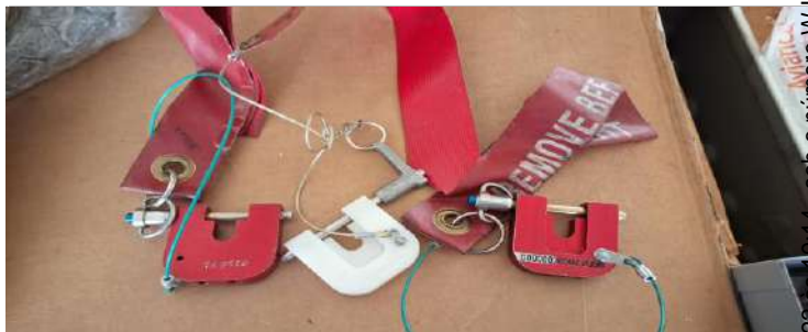
ITEM 178 Descrição: LOCKING TOOL-FLAP SLAT LEVER,INT. POSITION PN: 98D27803000000 Quantidade: 3
