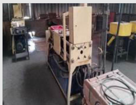
PRENSA HIDRÁULICA HORIZONTAL COM ACIONAMENTO ELÉTRICO RESERVATÓRIO DE ÓLEO E MOTOR DE 15CV | Item: 350 |
