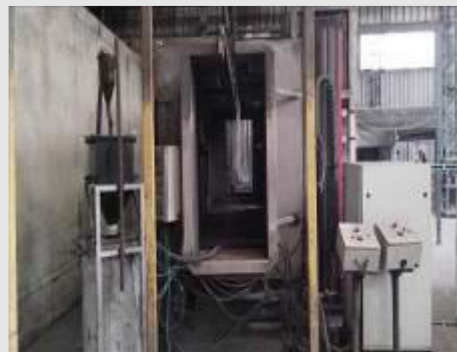
CABINE DE PINTURA A PÓ MARCA DELTEC COM SISTEMA DE TRANSPORTE AÉREO POR CORRENTE POT 32KW PROJETO 1718-021 E PAINEL TECNOAVANCE ANO 2006 | Item: 357 |
