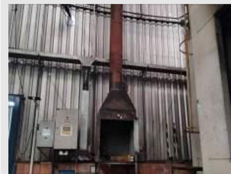
CABINE DE PINTURA EM AÇO CARBONO DIM 0.80X1.00X1.40 M COM DUTO DE EXAUSTÃO DIAM 0.50X7.00M | Item: 360 |
