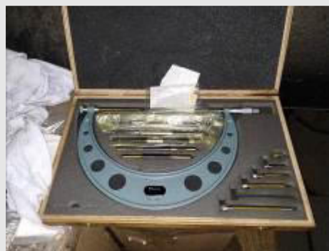
MICRÔMETRO MARCA MITUTOYO 150-300 MM COM ESTOJO | Item: 328 |
