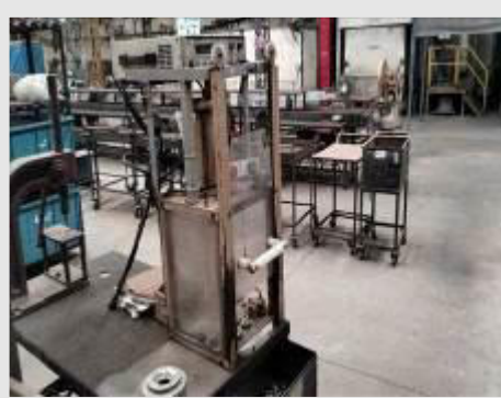
PRENSA PNEUMÁTICA PARA MONTAGEM DE COMPONENTE | Item: 479 |
