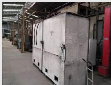
CABINE MOVEL DE EXAUSTÃO PARA A LINHA DE PINTURA A PÓ MARCA DELTEC DIM 2.10X1.25X2.10 M | Item: 355 |
