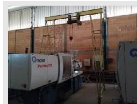
PÓRTICO ROLANTE COM TALHA ELÉTRICA CAP 3T VÃO 2.50X4.00 M ALTURA | Item: 44 |
