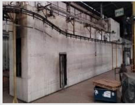
CABINE DE SECAGEM MARCA DELTEC DIM 30.0X4.0X4.0 M COM SISTEMA DE VENTILAÇÃO E EXAUSTÃO (1751) | Item: 361 |
