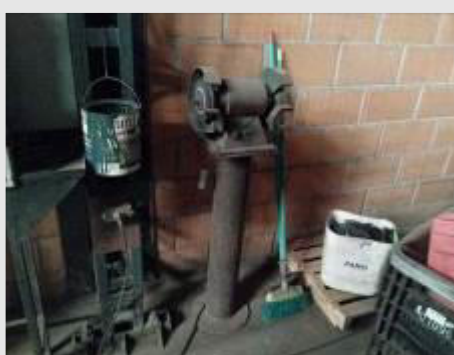
ESMERIL DE COLUNA COM MOTOR DE 1/2 CV | Item: 341 |
