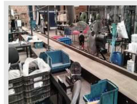
ESTEIRA DE TRANSPORTES COM LONA COM MOTOR E REDUTOR E APOIO LATERAL DIM 9.20X0.35 M | Item: 472 |
