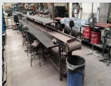
ESTEIRA DE TRANSPORTADORA COM LONA COM MOTOR E REDUTOR E APOIO LATERAL DIM 8.20X0.35 M | Item: 514 |
