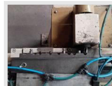
FRESADORA HORIZONTAL PNEUMÁTICA PARA ACABAMENTO EM EIXO (FABRICAÇÃO PRÓPRIA) | Item: 340 |
