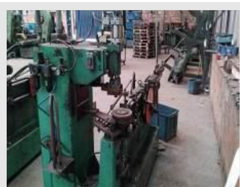
SOLDADOR DE PONTO DE ROTAÇÃO AUTOMÁTICA COM ENDIREITADOR DE ARAME MARCA SEASON MOD SA-1-154S | Item: 649 |
