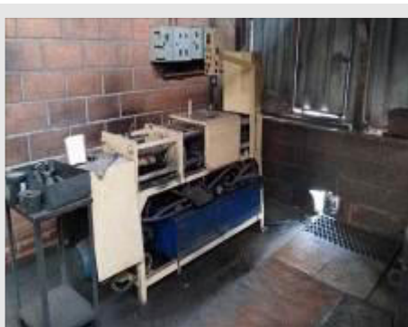
PRENSA HIDRÁULICA HORIZONTAL COM ACIONAMENTO ELÉTRICO RESERVATÓRIO DE ÓLEO E MOTOR DE 15CV | Item: 313 |
