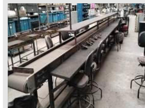
ESTEIRA DE TRANSPORTADORA COM LONA COM MOTOR E REDUTOR E APOIO LATERAL DIM 8.20X0.35 M | Item: 514 |
