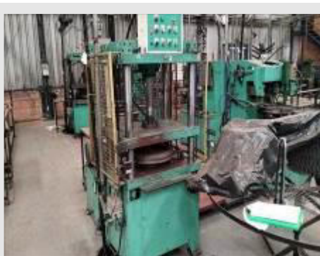
PRENSA HIDRÁULICA COM RESERVATÓRIO DE ÓLEO E MOTOR DE 7.5 CV | Item: 657 |
