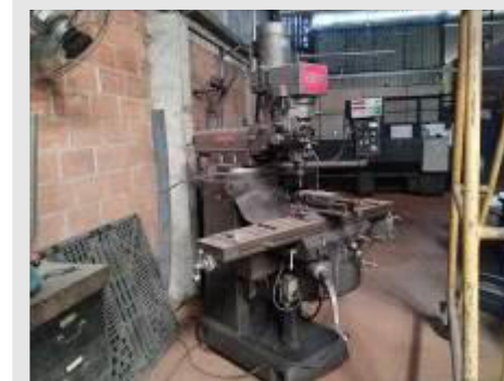
FRESADORA FERRAMENTEIRA MARCA VEKER MOD 450 C MESA DE 1.375X0.25 M ANO 2006 | Item: 68 |
