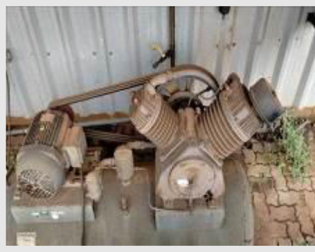
COMPRESSOR DE AR MARCA SCHULZ COM MOTOR DE 15 CV RESERVATÓRIO DE 400L 20 BAR | Item: 910 |
