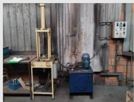
PRENSA HIDRÁULICA DE ACIONAMENTO ELÉTRICO COM RESERVATÓRIO DE ÓLEO E MOTOR DE 10 CV | Item: 349 |
