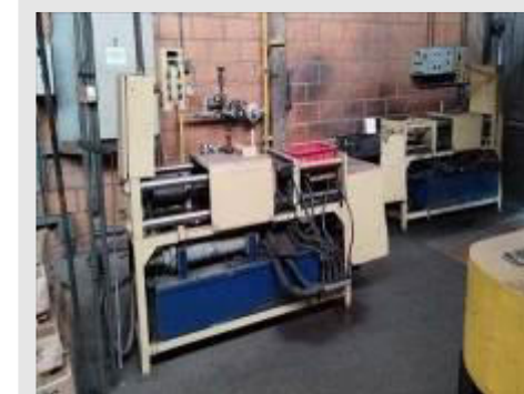
PRENSA HIDRÁULICA HORIZONTAL COM ACIONAMENTO ELÉTRICO RESERVATÓRIO DE ÓLEO E MOTOR DE 15CV | Item: 350 |
