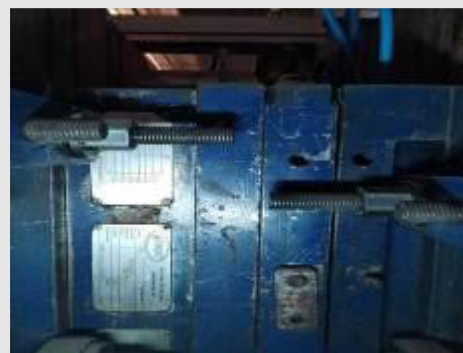
MOLDE PARA INJEÇÃO MARCA NOVAPAR PARA HÉLICE 50 TWISTER NS 3282 | Item: 8 |
