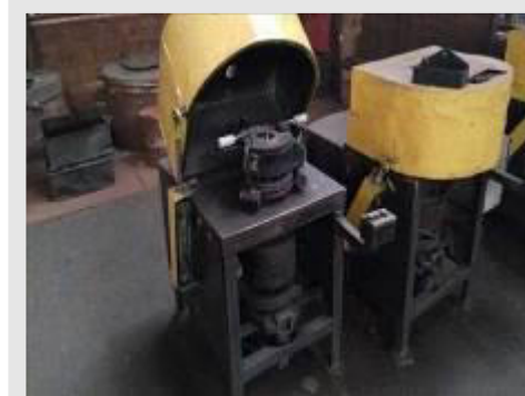
CENTRÍFUGA PARA BANHO DE PEÇA EM ALUMÍNIO (COQUILHAS) | Item: 351 |
