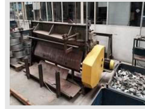
GUILHOTINA PARA CHAPA MARCA CALVI COM MOTOR DE 5 CV CAP DE CORTE 2.050X2.5 MM ANO 1994 | Item: 621 |
