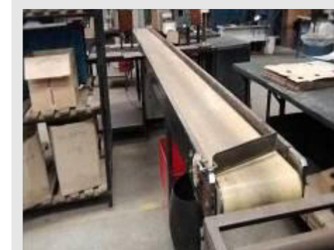
ESTEIRA TRANSPORTADORA COM LONA COM MOTOR E REDUTOR DIM 5.00X0.35 M | Item: 517 |
