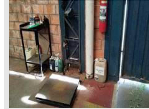
BALANCA DE PLATAFORMA MARCA TOLEDO MOD 26-2180 CAP 250 KG NS 10348 DIM 0.70X0.70 M | Item: 933 |
