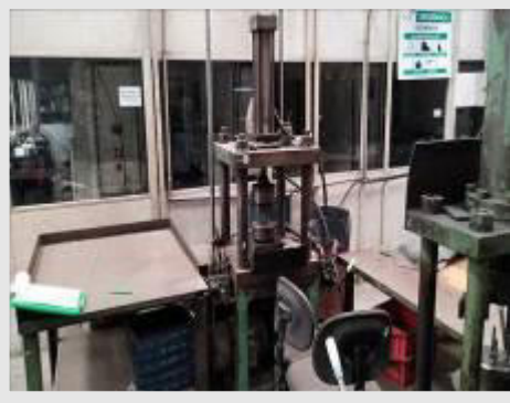
PRENSA HIDRÁULICA REBITADORA COM COMANDO DUPLO | Item: 628 |
