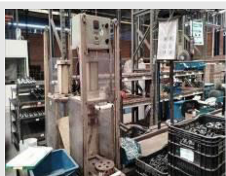
PRESA PNEUMÁTICA PARA MONTAGEM DE COMPONENTE (CAMPANA SELANTE) | Item: 471 |
