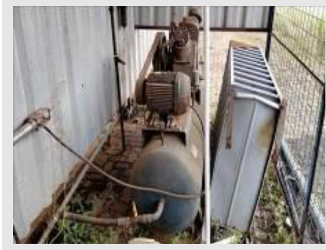
COMPRESSOR DE AR MARCA SCHULZ COM MOTOR DE 15 CV RESERVATÓRIO DE 400L 20 BAR | Item: 910 |
