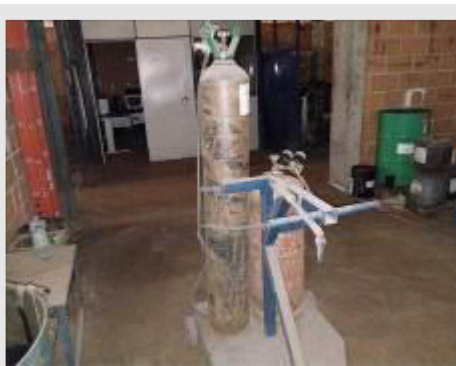
CONJUNTO OXI-ACETILENO PARA CORTE E SOLDA COM CILINDROS. | Item: 336 |
