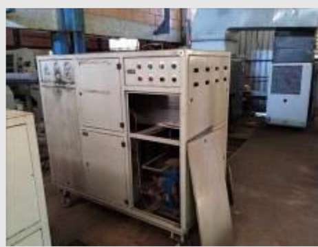
UNIDADE DE AGUA GELADA MARCA REFRIAC MOD RAI100-2HC CAP 30.000 KCAL/H NS 3161 ANO 2006 | Item: 47 |
