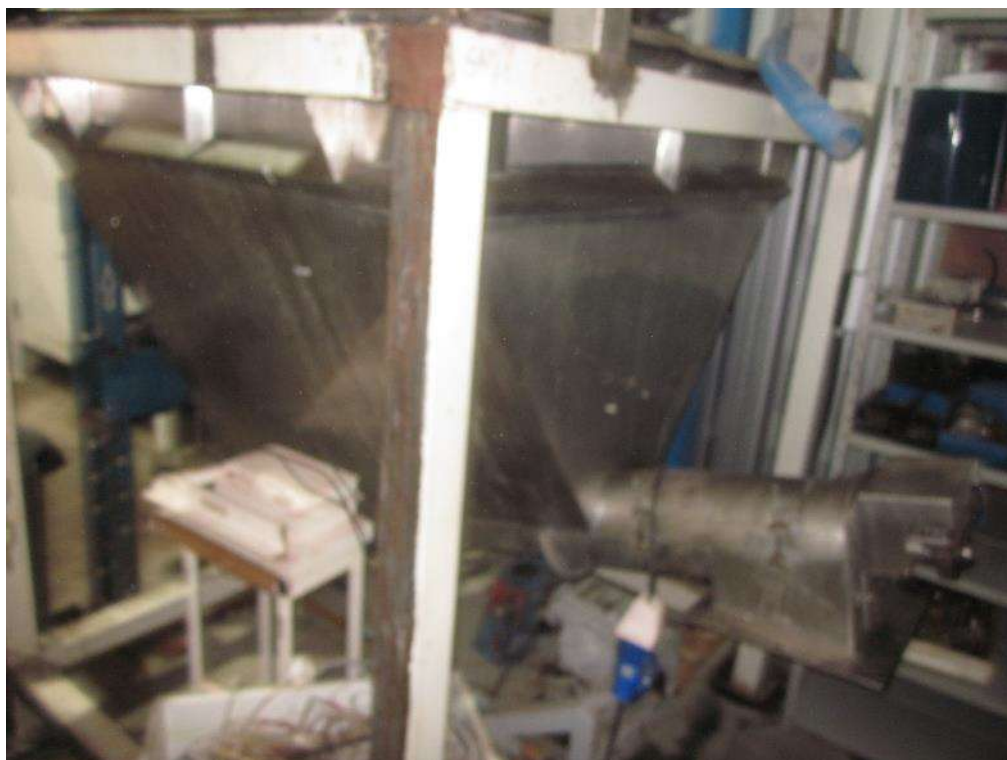
ITEM: 1,018 - MOEGA EM AÇO INOX, C/ ROSCA TRANSPORTADORA EM AÇO INOX - P/ AÇUCAR
