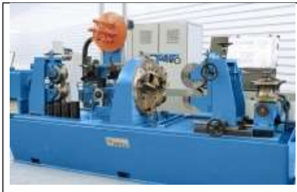
Figura 07 – Soldagem longitudinal do tubo e Rebobinador do Refilo
