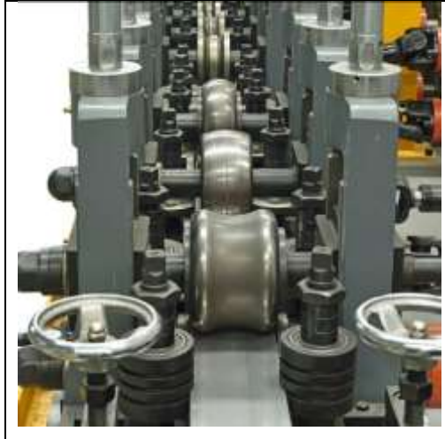
Figura 06 – Rolos de conformação da fita de aço em tubo
