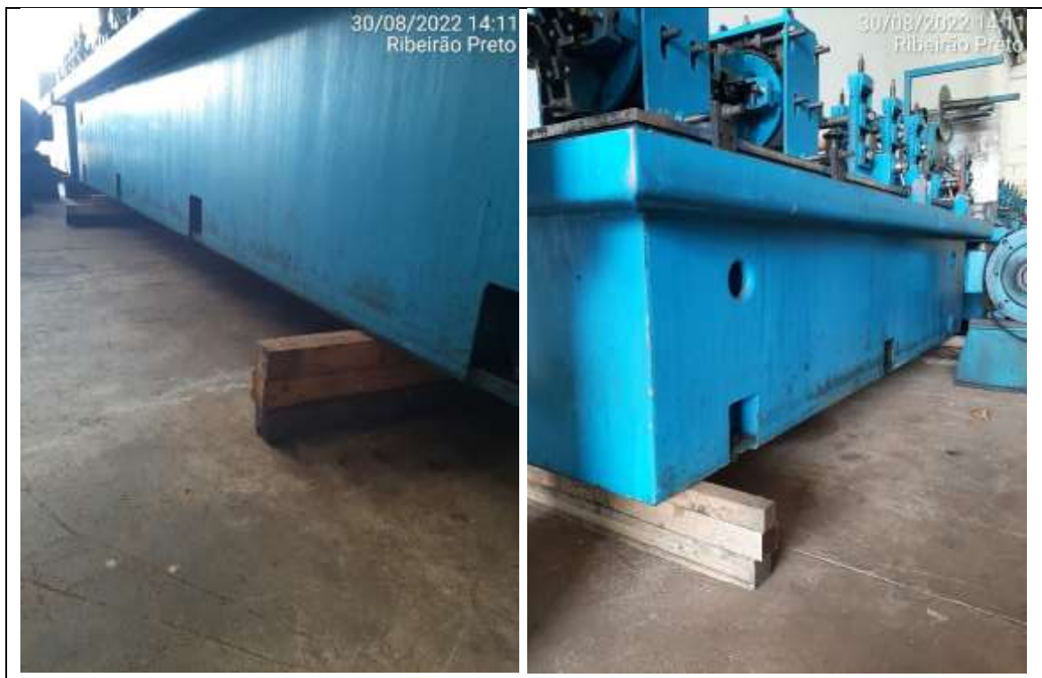
Fotos 02 e 03 – Estruturas da Máquina não operacional, apoiadas sobre calços de madeira.
