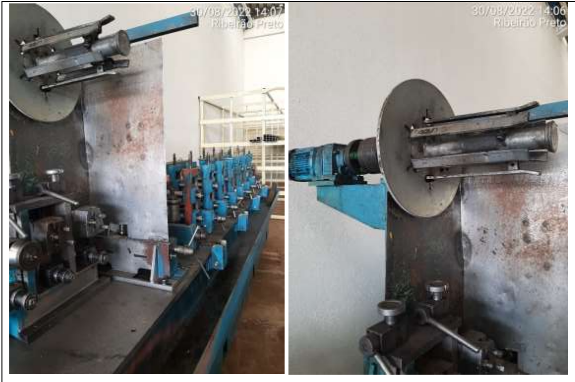
Fotos 09 e 10 – Estação de soldagem do Tubo após sua conformação (foto 9) e o Rebobinador do Refilo decorrente da soldagem (foto 10). A estação de soldagem encontra-se desmontada e somente suas partes estruturais estavam presentes na máquina durante a perícia.
