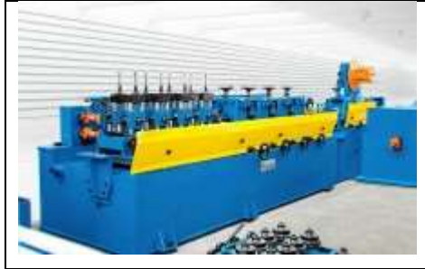
Figura 09 – Etapa de Calibração dimensional do tubo
