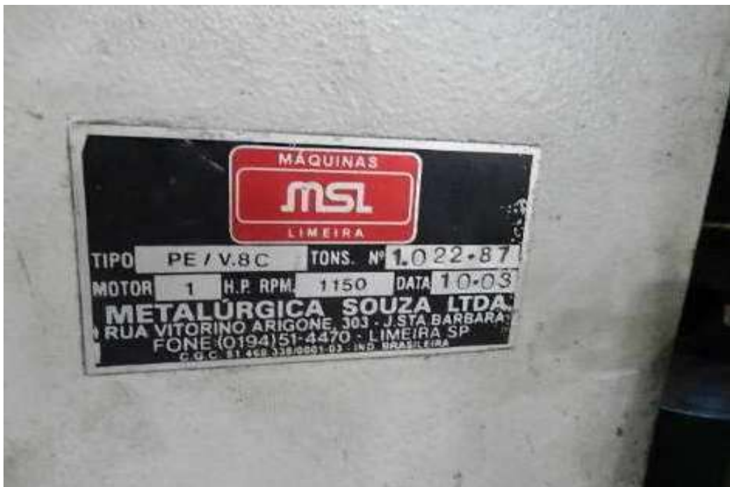
ITEM 1,051 - VISTA DA PLACA DE IDENTIFICAÇÃO DA PRENSA EXCENTRICA CAP: 8 TON MARCA: MSL MODELO: PE/V-8C
