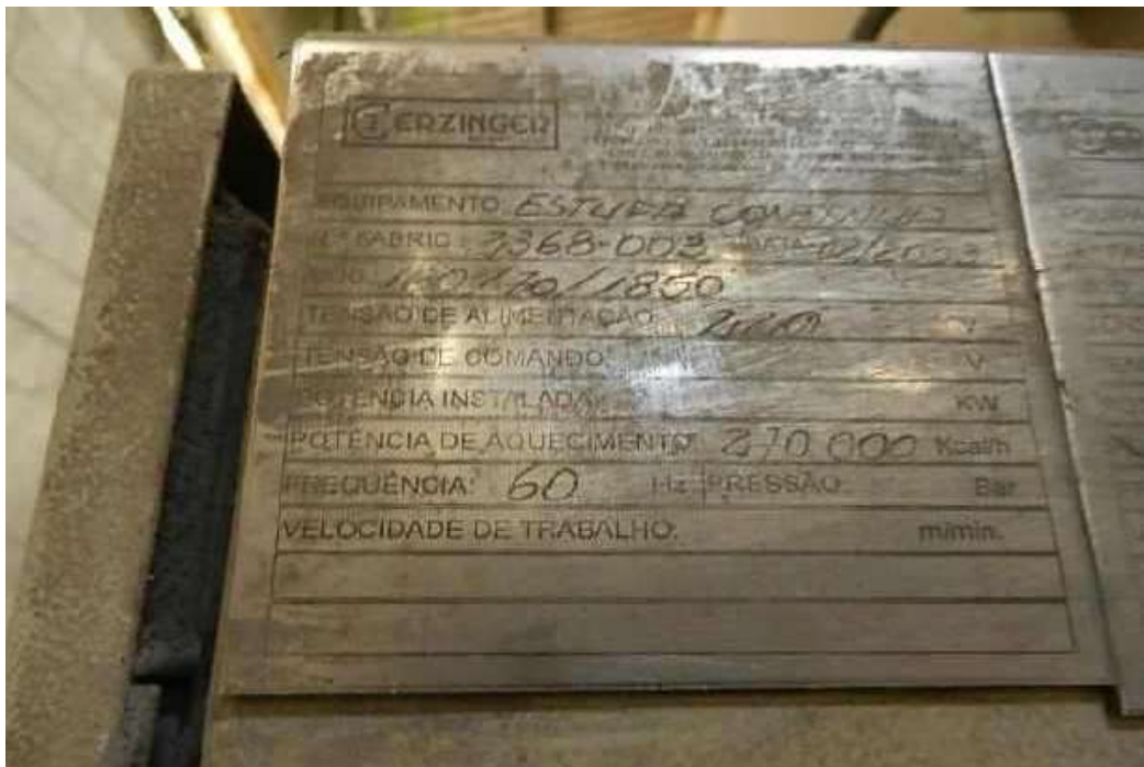
ITEM 1,038 - VISTA DA PLACA DE IDENTIFICAÇÃO DA ESTUFA PARA SECAGEM COM 2 CAMARAS MODELO: 160170/1850 N° FAB: 2368-003 DA LINHA DE PINTURA
