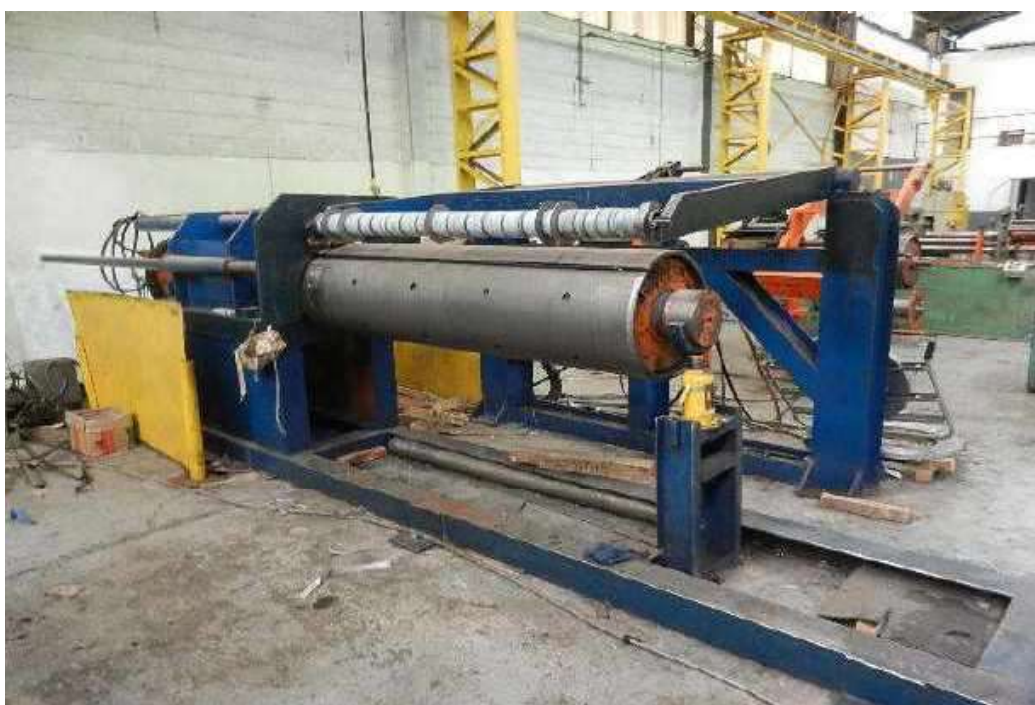
ITEM 1,022 - VISTA DO BOBINADOR ACIONADO POR MOTOR E REDUTOR COM BRACO PARA EMPURRAR A BOBINA DA LINHA DE CORTE
