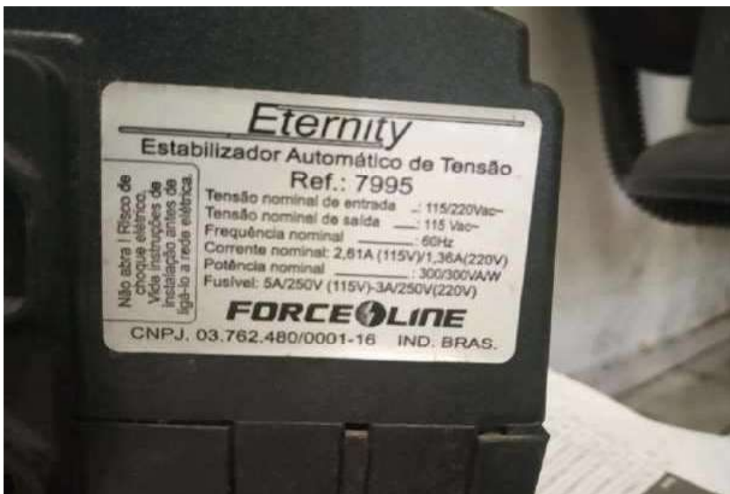
ITEM 3,036 - VISTA DA PLACA DE IDENTIFICAÇÃO DO ESTABILIZADOR AUTOMÁTICO DE TENSÃO MARCA: FORCE LINE MOD: ETERNITY 7995
