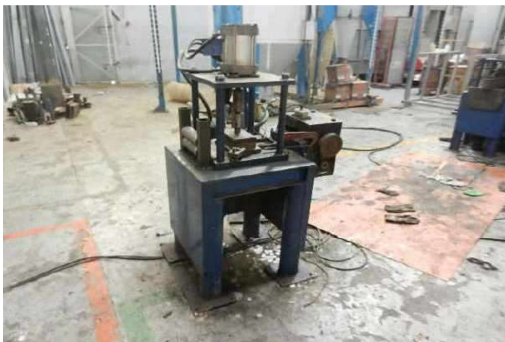
ITEM 1,045 - VISTA DO DISPOSITIVO DE FURAÇÃO PNEUMÁTICO DA MAQ Nº 4
