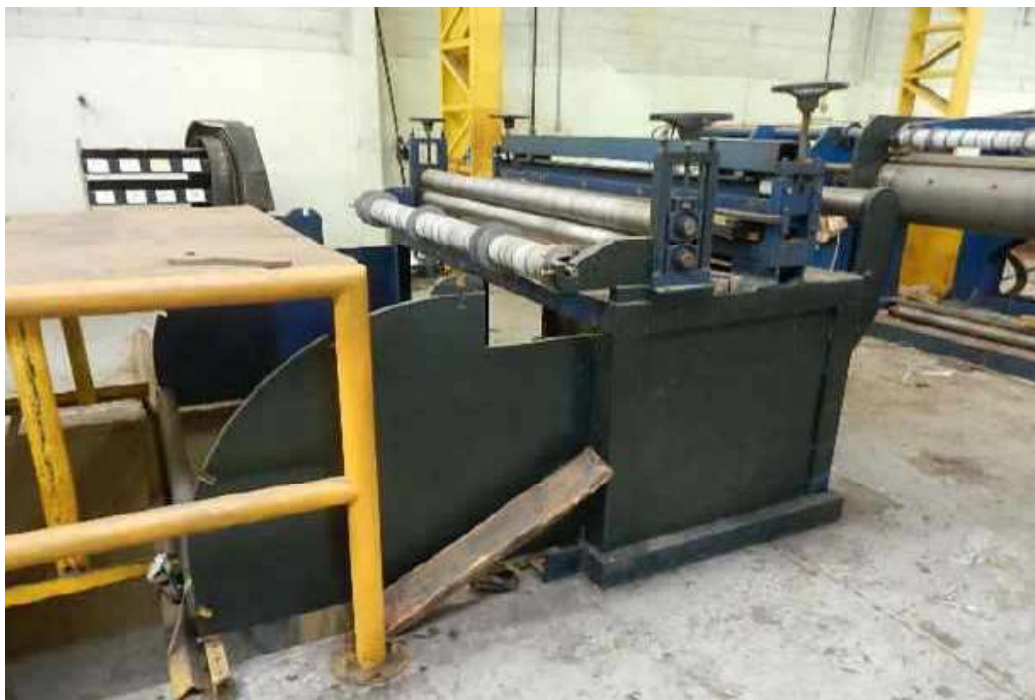
ITEM 1,022 - VISTA DO ENDIREITADOR DE CHAPA DA LINHA DE CORTE
