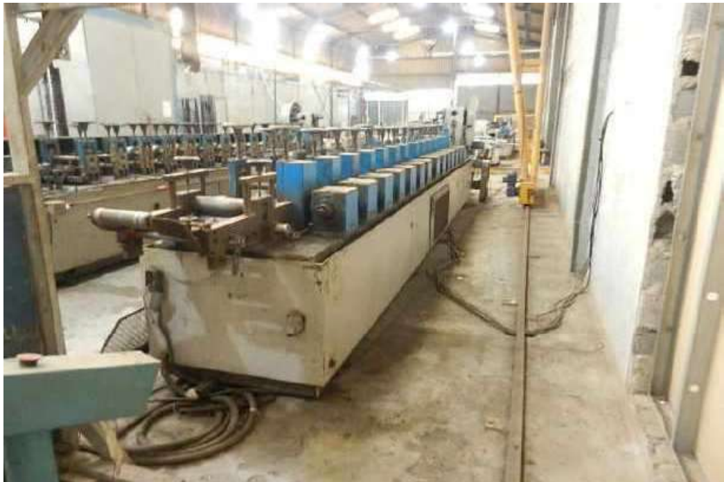
ITEM 1,043 - VISTA DA MAQ Nº 3 - COMPREENDENDO: DESBOBINADOR ACIONADO POR MOTOR E REDUTOR, PAINEL DE COMANDO, PERFILADEIRA COM 14 CASTELOS
