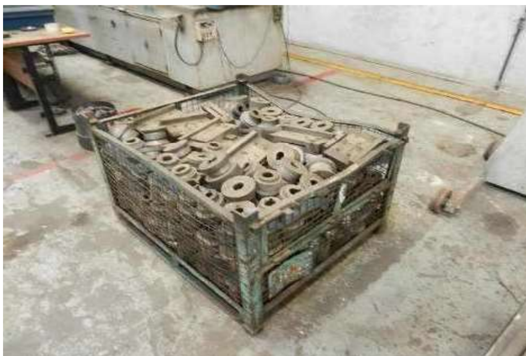
ITEM 5,041 - VISTA DA CAIXA COM DIVERSOS ROLETES PARA PERFILADEIRA
