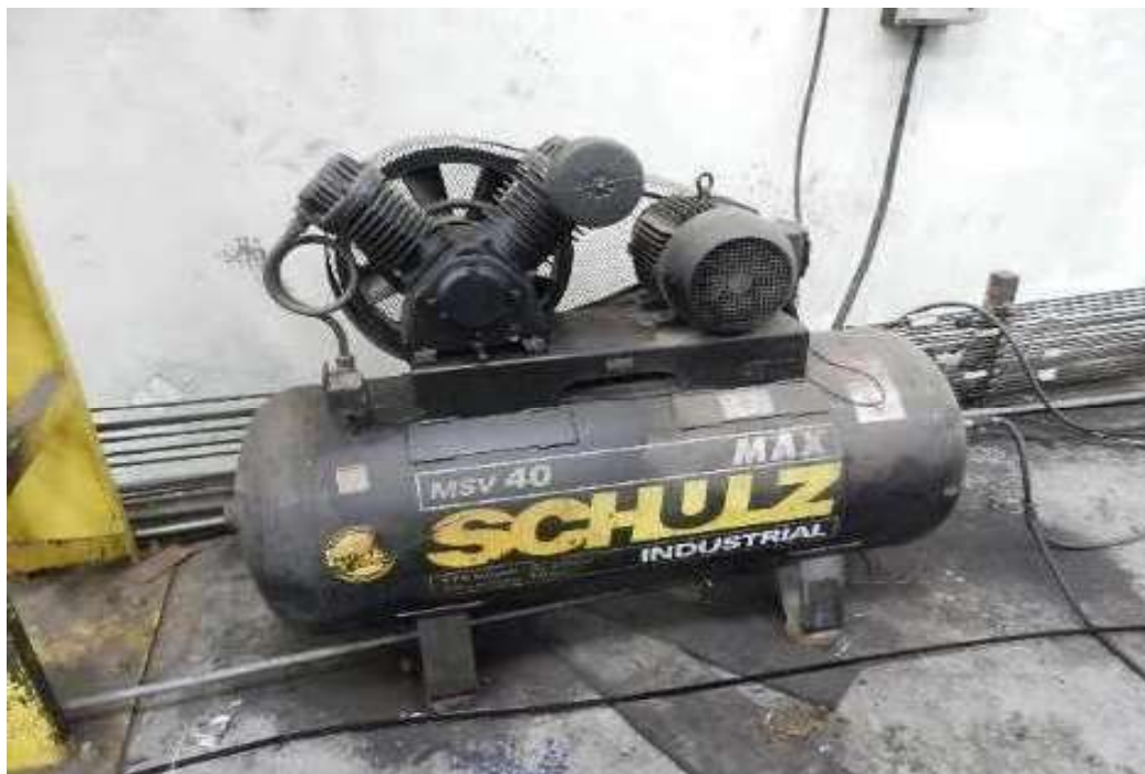
ITEM 1,028 - VISTA DO COMPRESSOR DE AR SCHULZ MSV-40 MAX
