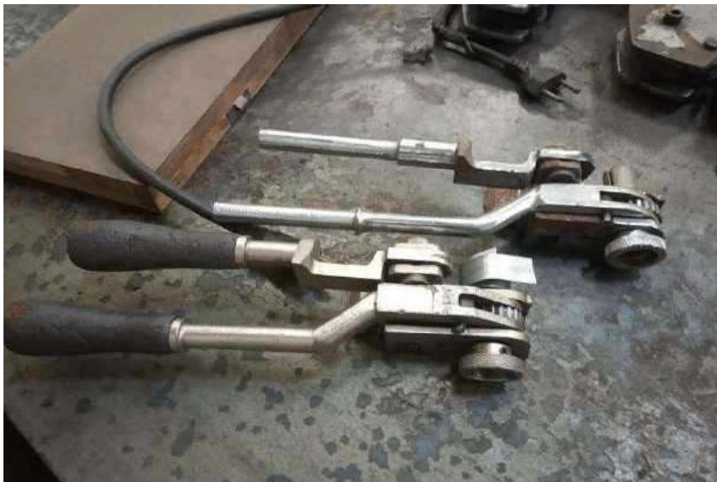
ITEM 1,005 - VISTA DO TENSIONADOR DE FITA
