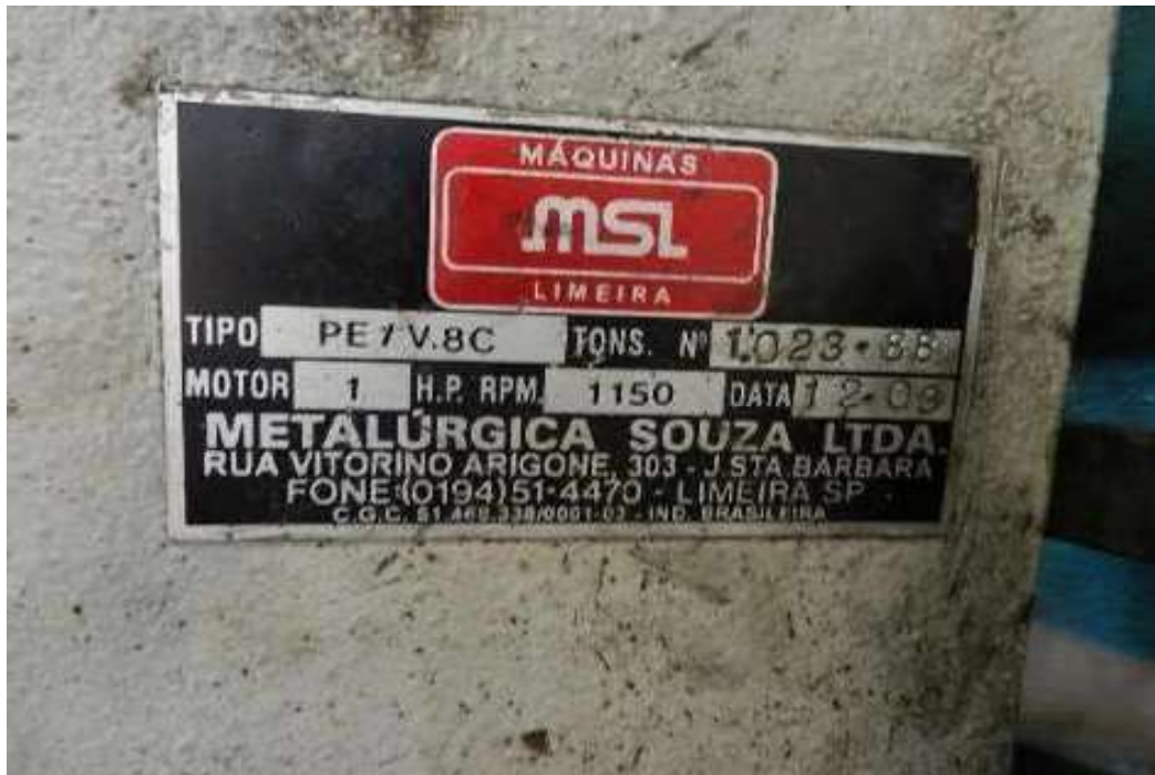
ITEM 1,046 - VISTA DA PLACA DE IDENTIFICAÇÃO DA PRENSA EXCÊNTRICA CAP: 8 TON MSL PE/V.8C
