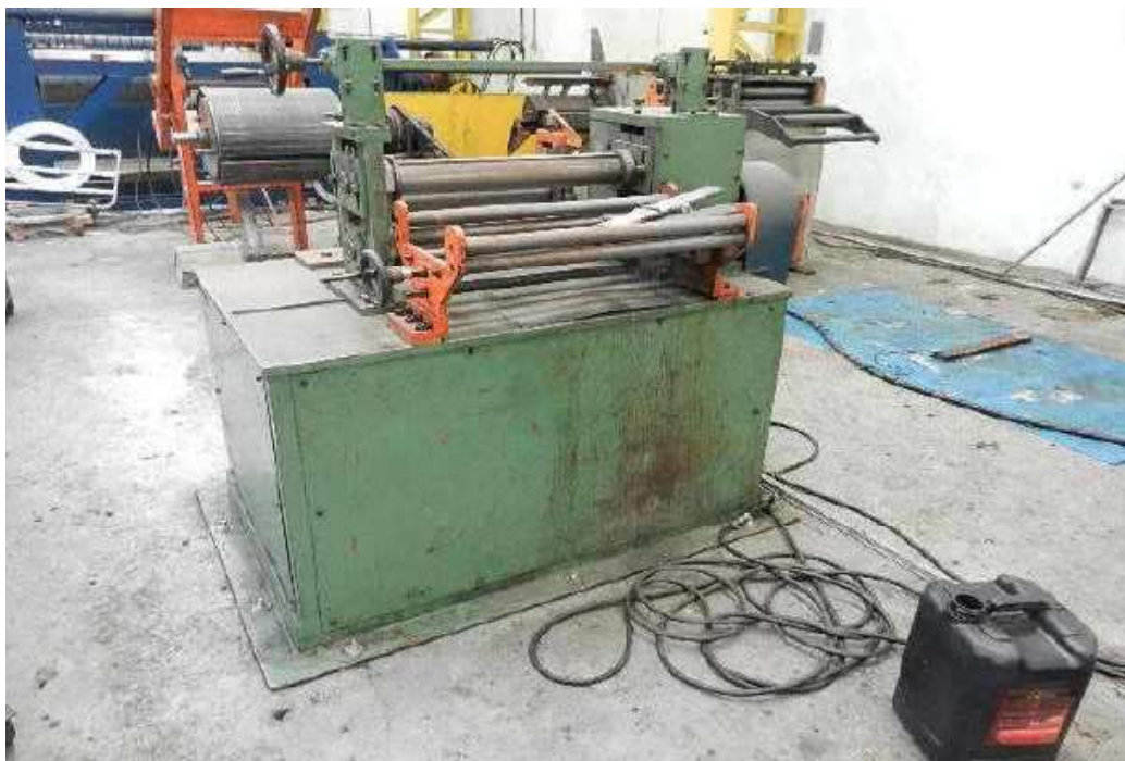
ITEM 1,018 - VISTA DA ENDIREITADEIRA E FRIZADEIRA COM 2 ROLOS CADA ACIONADO POR MOTOR E CORRENTE DA LINHA DE CORTE
