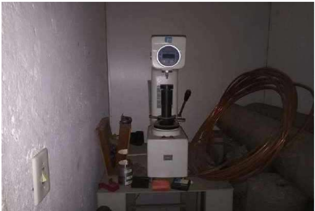
ITEM 1,068 - VISTA DO DURÔMETRO MARCA: MITUTOYO MODELO: DT10D
